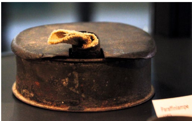
Bevor Lauscha an die Gasversorgung angeschlossen wurde, schmolzen die Glasbläser die Glasstäbe an einer Paraffinlampe
