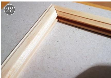
Nun geht es an die Konstruktion der Frontscheibenhalterung. Die entsprechenden Leisten sind bereits abgelängt und auf Gehrung geschnitten. So kann man sie einfach auf die Frontseite der Box leimen
