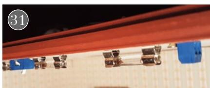
Um die indirekte Beleuchtungsleiste zu verbergen, empfiehlt Mini Mundus, eine Zierleiste auf die Scheibe zu kleben. Das Ergebnis überzeugt, muss aber im eingebauten Zustand erfolgen, damit der Abstand zur oberen Führung passt
