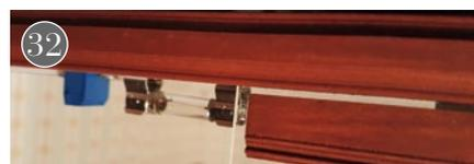
Die Leiste verdeckt die Beleuchtung perfekt. Schiebt man die Scheibe allerdings auf, kommt man perfekt an die Beleuchtungseinheiten heran
