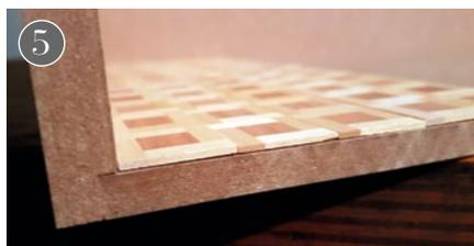
Achten Sie darauf, dass die Elemente vorne mit der Modulbox bündig schließen. Alles andere schadet nicht nur der Optik, sondern führt auch dazu, dass sich die Frontscheibe nicht installieren lässt
