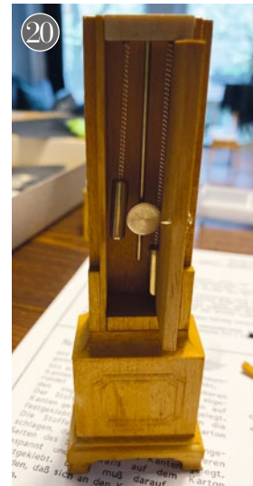
18) Dann werden alle Oberflächen mit dem Lasur-Lack bearbeitet und die Ziersäulen angebracht. 19-20) Die Tür kann eingesetzt werden, bevor das Oberteil drauf gesetzt wurde. Dann wird der Holzklotz mit dem eingeleimten Pendel und Gewichten eingeleimt. 20) Das Ziffernblatt und die Zeiger werden angeleimt. Dann ist die Standuhr fertig
