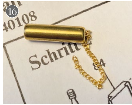
15) Die Scharnierstufen werden in die Nut der Tür eingeleimt. 16-17) Die Gewichte, die beim Öffnen der Tür zu sehen sind, werden mit den unterschiedlich langen Ketten verleimt, ebenso wie das Gewicht mit dem Pendel der Uhr
