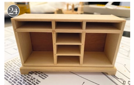
22) Bei der Anrichte wird zunächst der Grundkorpus zusammengeleimt. 23-24) Danach wird der Fuß der Anrichte gelehmt und unter den Korpus gesetzt
