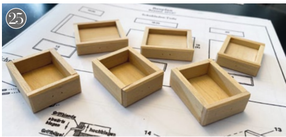
25) Danach werden alle Schubladen für die Anrichte verleimt. 26) Nach der Oberflächenbehandlung aller Teile können die Türen und die Schubladen in die Anrichte eingesetzt werden. Eventuell muss noch etwas geschliffen werden, damit alles ineinander passt. Voilà
