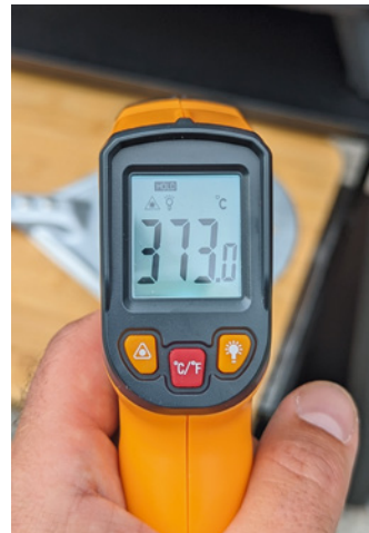
... nach weiteren 10 Minuten sind dann über 370°C erreicht. Der Ofen ist nun bereit für die erste Pizza
