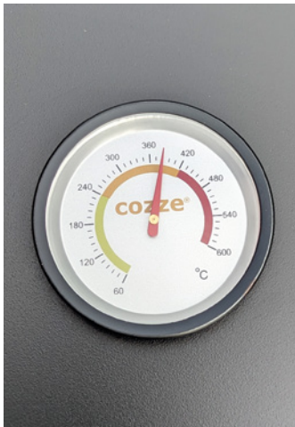
Nach 20 Minuten Aufheizphase zeigt das Thermometer im Deckel bereits über 360°C ...
