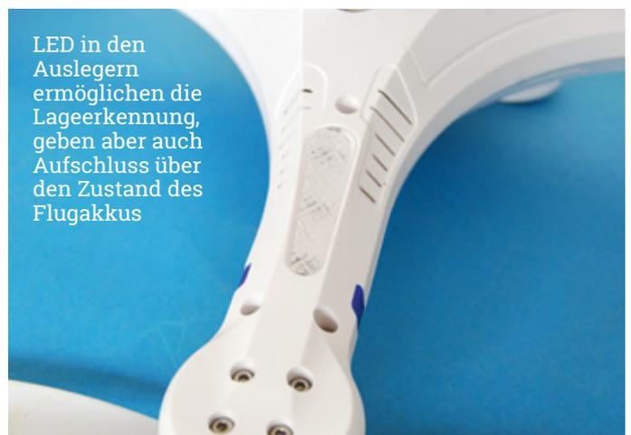
LED in den Auslegern ermöglichen die Lageerkennung, geben aber auch Aufschluss über den Zustand des Flugakkus
