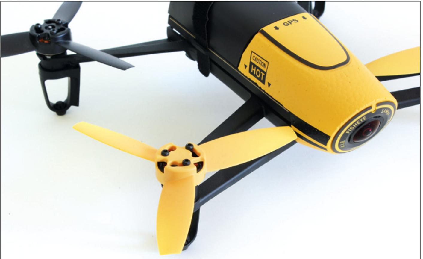
Dreiblatt-Propeller sorgen bei der Bebop Drone für Auftrieb. Sie sind werkseitig bereits installiert
