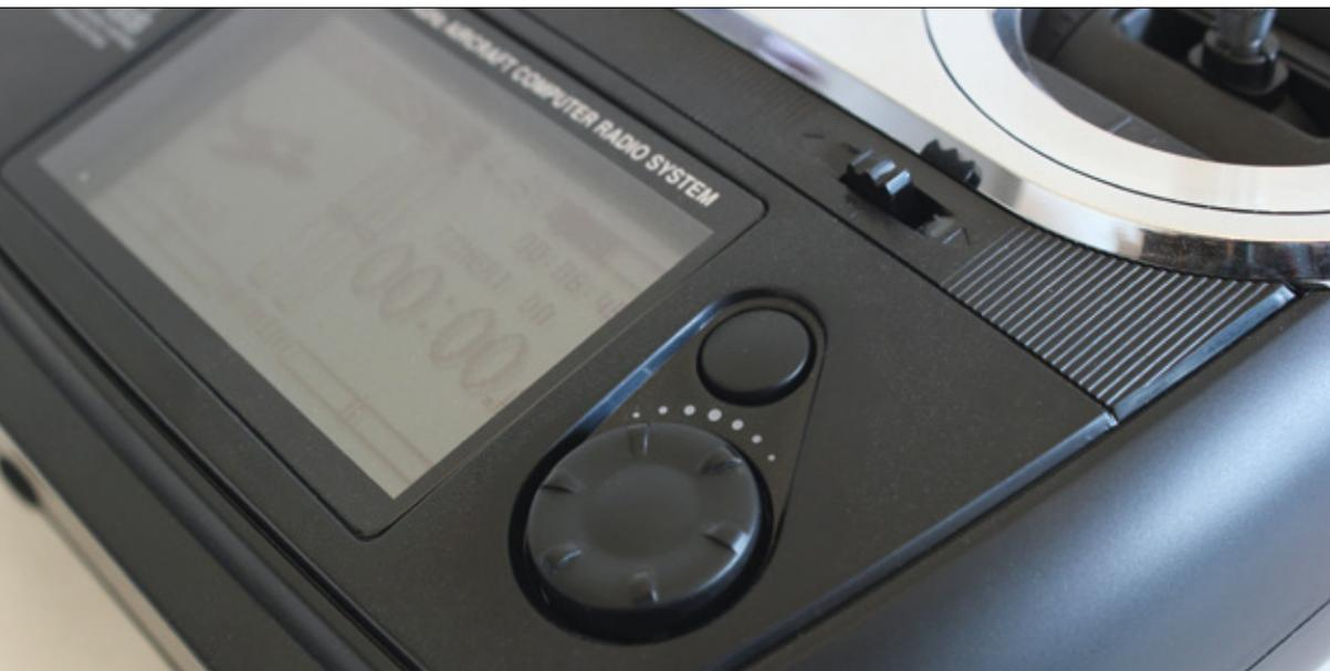
Die Menüführung erfolgt über einen 3D-Button sowie einen weiteren Schalter
