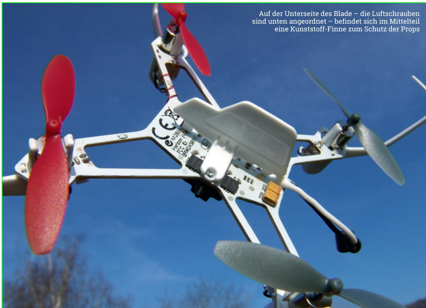
Auf der Unterseite des Blade – die Luftschrauben sind unten angeordnet – befindet sich im Mittelteil eine Kunststoff-Finne zum Schutz der Props
