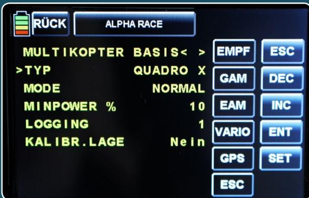
Setup übers Sender-Display: Gestartet wird im Multikopter-Basis-Menü (siehe Text)
