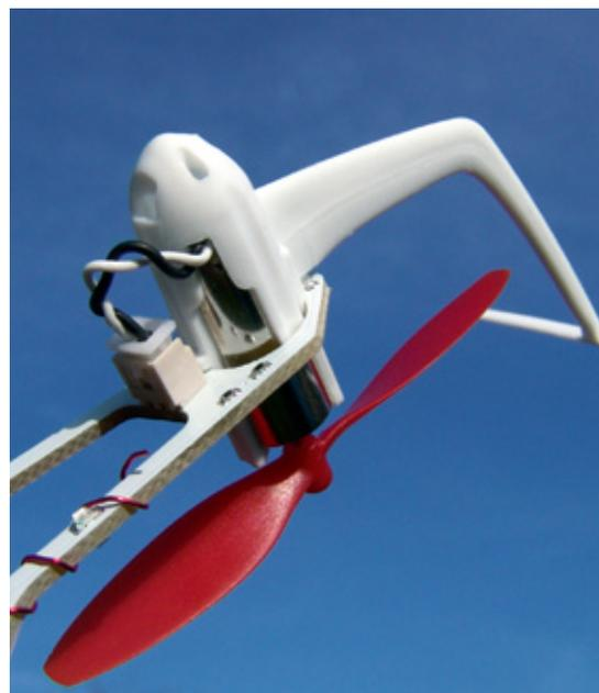
Deutlich zu erkennen ist die Klemmbefestigung der Motoren, die dank des Anschlusssteckers schnell gewechselt werden können. Sehr praktisch sind die Bumper an den Enden der Auslegerarme, mit denen die Props vor Berührung geschützt werden
