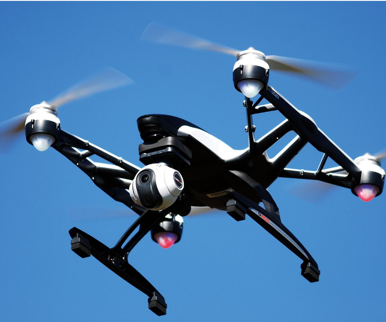
Schalter. Unmittelbar dahinter befindet sich die Status-LED, die im Zusammenspiel mit allen weiteren LED unter den Motoren permanent während des Betriebs durch unterschiedliche Farben und Blinkfrequenzen über den aktuellen Betriebsmodus informiert und vor leer werdendem Akku warnt.
