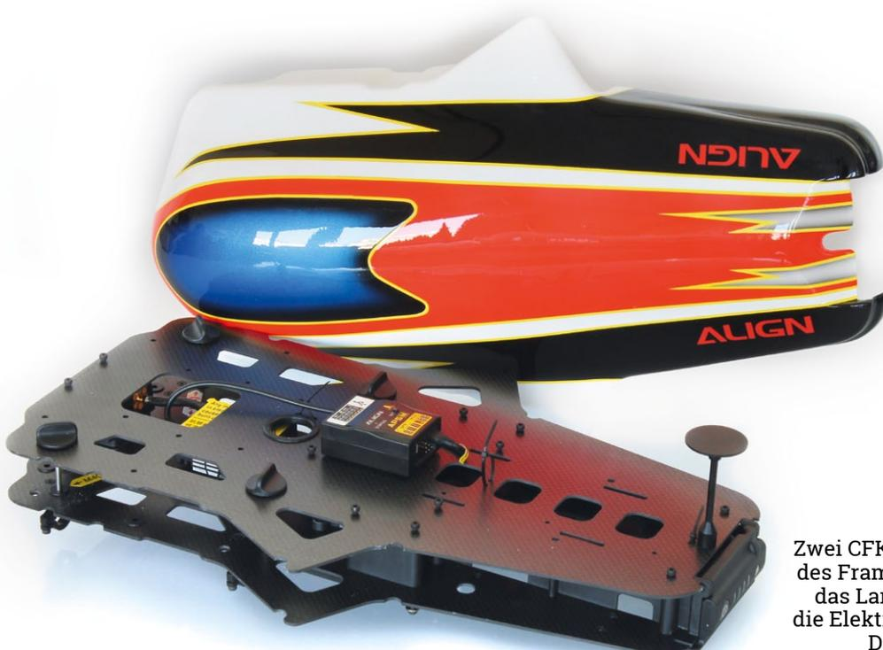
Zwei CFK-Platten bilden die Basis des Frames, der die vier Ausleger, das Landegestell, den Akku und die Elektronikkomponenten trägt. Die GFK-Haube ist lackiert
