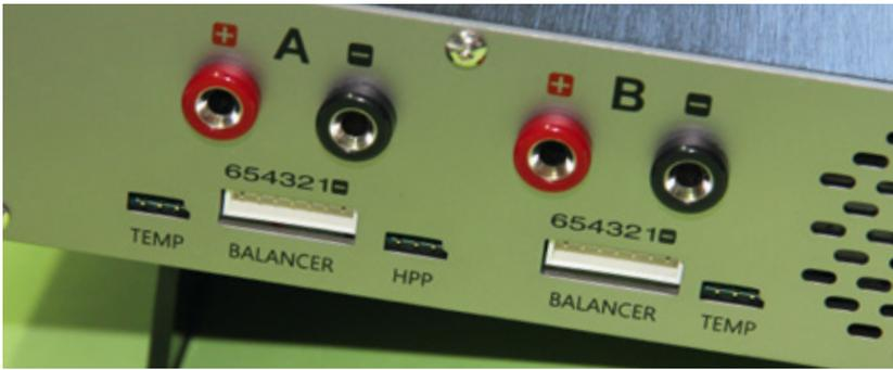
Auf der linken Gehäusesseite befindet auch der HPP-Anschluss für Software-Updates
