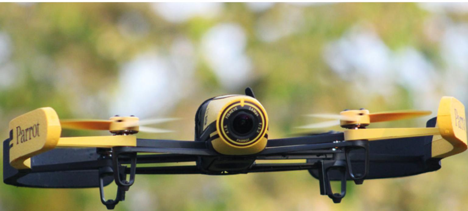
Ohne Skycontroller beträgt die Reichweite des WLANs rund 250 Meter
