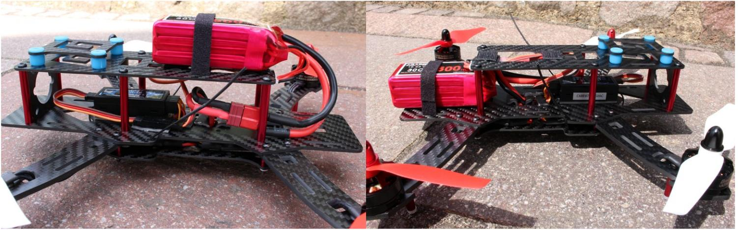
Der Alpha ist sehr aufgeräumt und man hat nicht viele Kabel, was dem GR-18 zu verdanken ist. Der Antriebsakku kann – je nach FPV-Ausrüstung und verwendeter Flycam – an verschiedenen Positionen befestigt werden. So hat man immer einen optimalen Schwerpunkt
