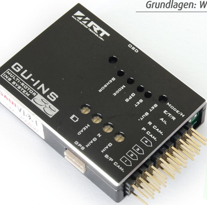
**Abbildung 3:** Flightcontroller GU-INS für Multikopter von Gaii, hier vom 540H
