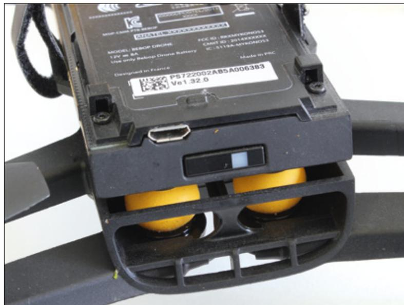
Zum Schutz der Elektronik ist sie auf Gummi-Dämpfern gelagert
