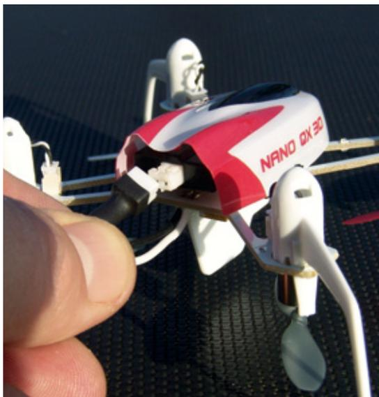
Einfach Steckverbindung vornehmen, und schon ist der Micro-Quad nach der Initialisierungsphase bereit zum Start
