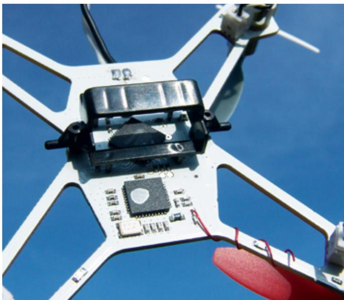
Auf der Oberseite des Kopters befindet sich die Kunststoff-Akkuaufnahme. Bei dem am rechten Ausleger umgewickelten Kupferlackdraht handelt es sich um die Empfangsantenne
