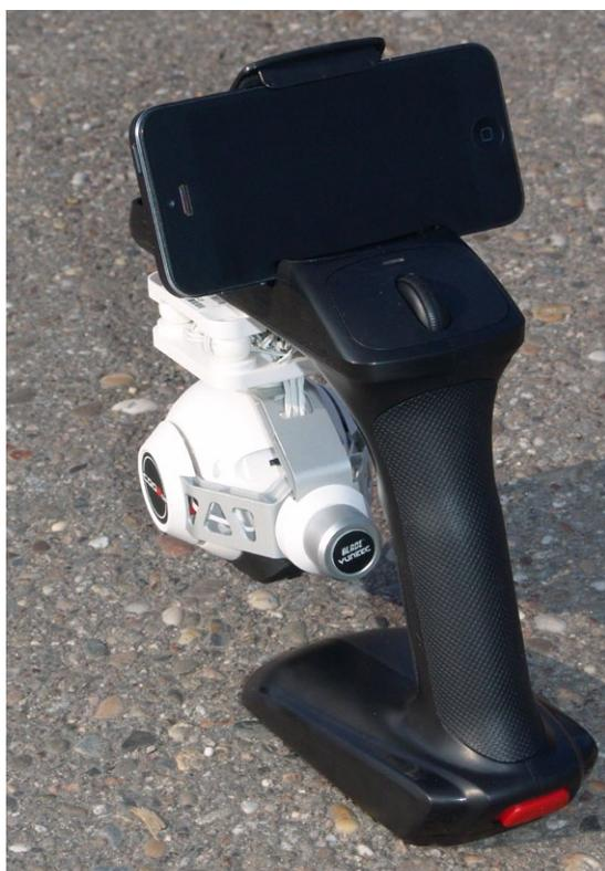
Oben: Positionsgenaues, autonomes Verharren auf dem Punkt – eine der Stärken des Q500. Unten: Wer möchte, kann das Gimbal auch mit dem Steadygrip Handheld-Gimbal (Lieferumfang) kombinieren. Die Bedienung der Cam erfolgt dann über ein Smartphone mit passender App
