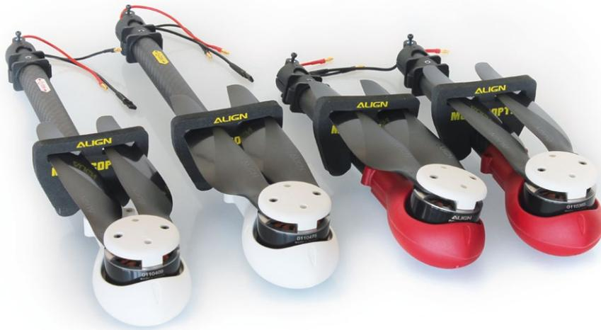
Alle vier Rohausleger sind einbaufertig vorbereitet und gegen Verwechslungsgefahr mit der korrekten Einbauposition markiert
