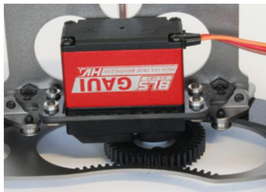
Das BLS GS503-Servo für die horizontale Steuerung ist im Auslieferungszustand bereits mit einem Zahnkranz versehen
