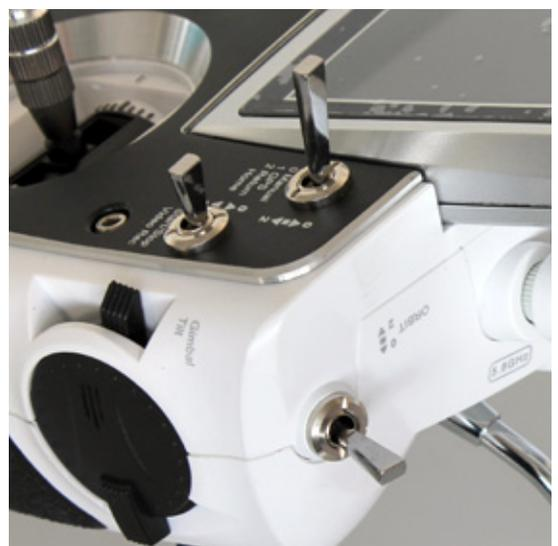
Über zahlreiche Geber und Schalter lassen sich Features wie GPS-Mode, Gimbal-Steuerung, Aufnahme-Start und mehr steuern
