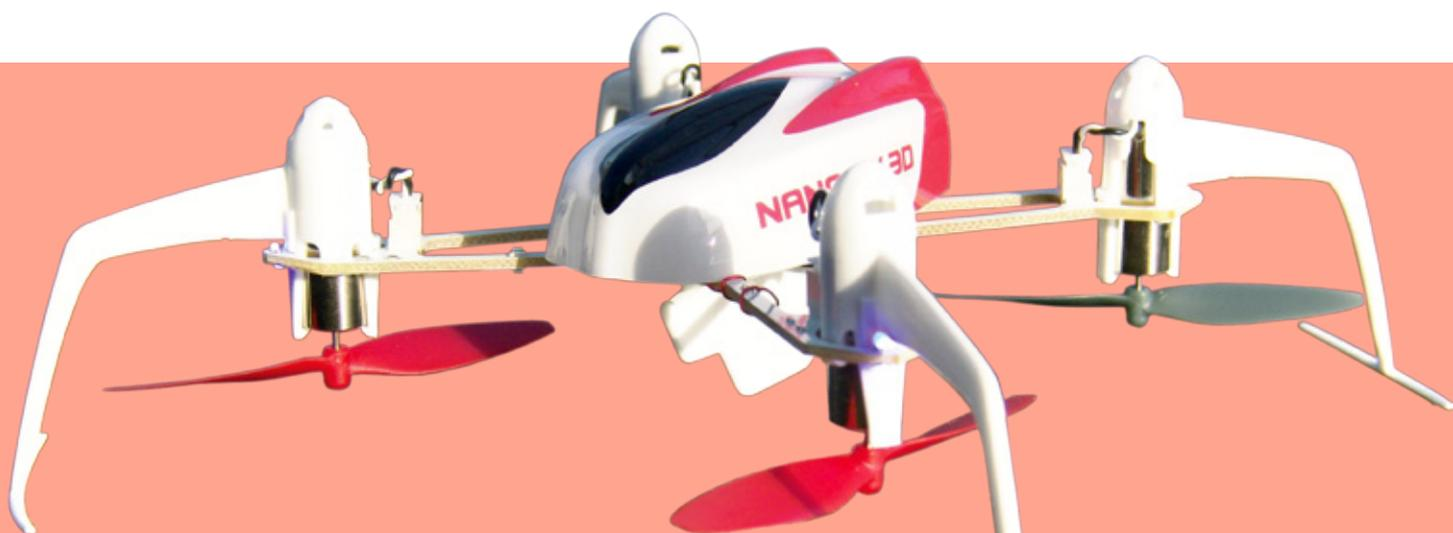
„Wesentlicher Unterschied zum Nano QX: Der 3D startet und fliegt normalerweise quasi auf dem Kopf mit den Rotoren nach unten.“
