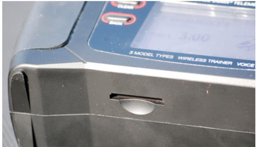
Der SD-Kartenslot ist bequem von außen zugänglich. Mit der SD-Karte kann der Speicher erweitert, aber auch Modellsicherungen und Updates durchgeführt werden
