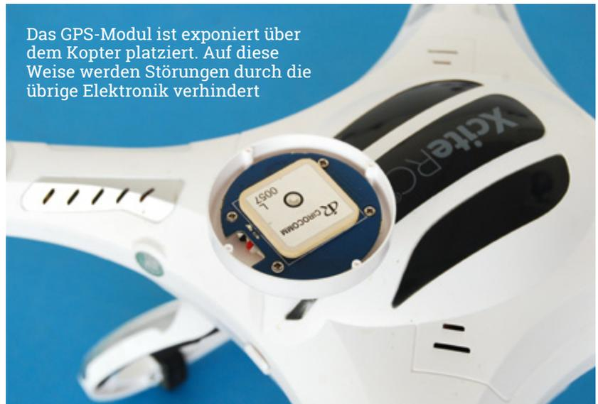
Das GPS-Modul ist exponiert über dem Kopter platziert. Auf diese Weise werden Störungen durch die übrige Elektronik verhindert
