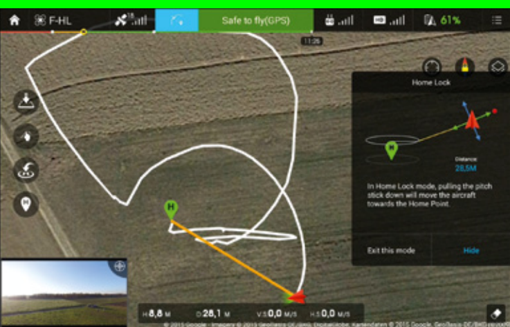
Abbildung 4: Testflug im F-Home Lock Mode zeigt eine nicht perfekte Funktion bei Home Lock. Halten von Roll liefert nur angedeutet Kreise um Home
