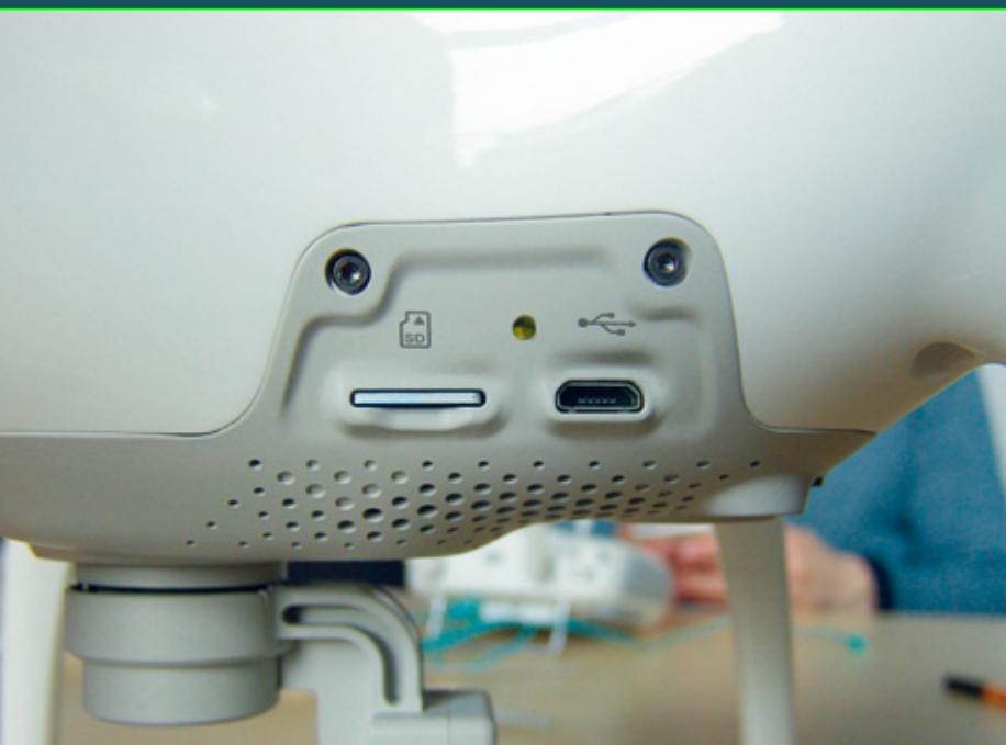
Kamera-SD-Card-Slot und USB-Buchse befinden sich gut zugänglich an der Seite des Korpus
