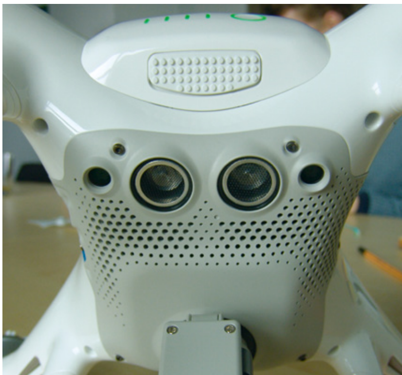
Kameras und Ultraschall-Sensoren im Bodenbereich, mit denen das Ultraschall-Vision-Positioning-System realisiert wird
