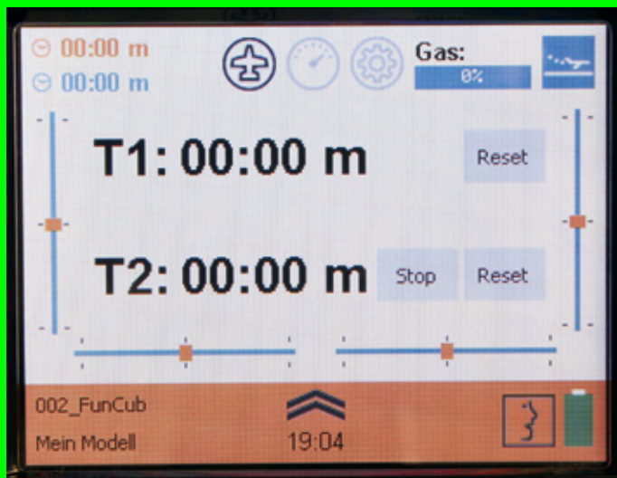
Hauptbildschirm nach dem Einschalten des Senders. Icons geben Auskunft über die aktive Flugphase (oben rechts), Sprachausgabe und Batteriezustand (unten rechts). Mit einem Klick auf den Doppelpfeil gelangt man ins Programmiermenü
