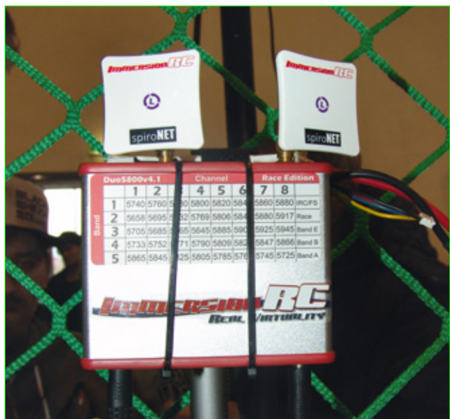
Blick von der Zuschauertribüne auf die Pilotensitze. Unmittelbar davor sind die acht FPV-Empfangsmasten zum Anschluss der FPV-Brillen aufgestellt. Einer der acht Duo 5800v4.1-Video-Empfänger von ImmersionRC, hier mit L-SpiroNet-Antennen
