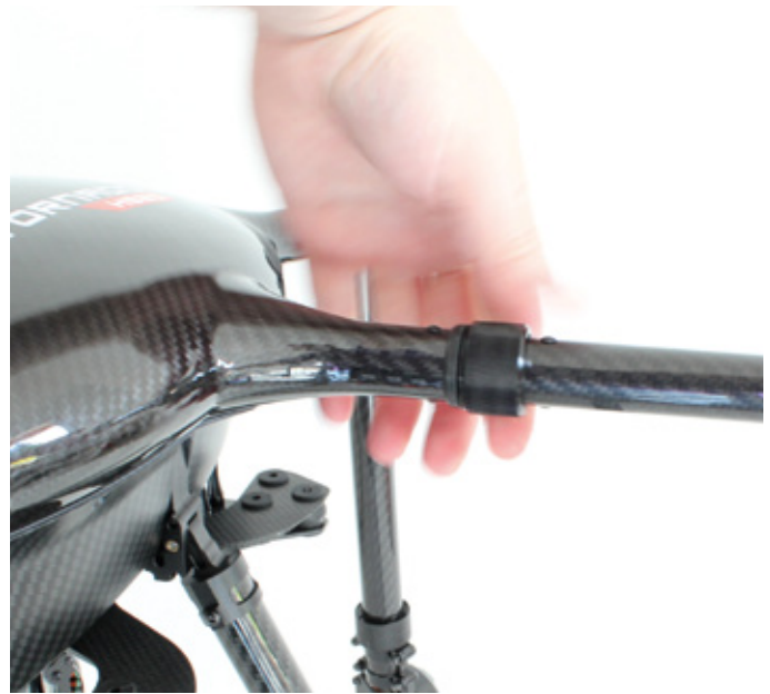
Ausleger hochklappen und die Sicherheitsmuffe fest aufschrauben. So entfaltet sich der Tornado langsam
