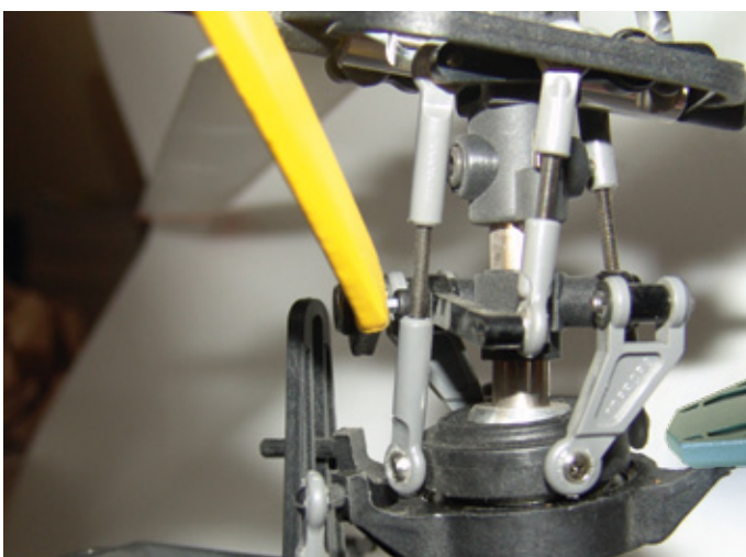
Durch die flache Bauweise und Abwinkelung der Tools kommt man auch bequem an schwer zugängliche Schrauben heran, beispielsweise wie hier am Rotorkopf
