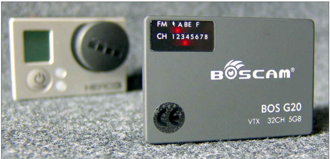
Rote LED zeigen während des Betriebs den jeweiligen Kanal an
