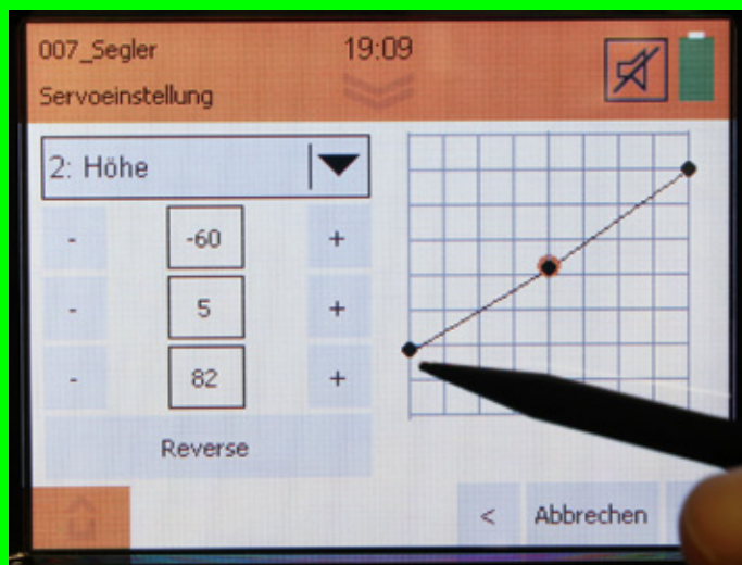
Bei einigen Einstelloptionen ist der Eingabestift eine wertvolle Hilfe, wie hier beim Begrenzen der Servo-Wege
