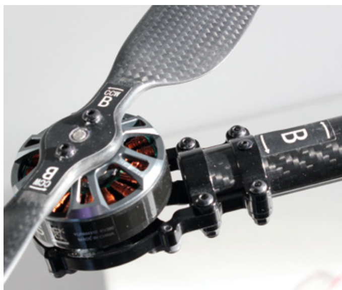
A zu A, B zu B: Buchstaben auf den Props sowie den Auslegern geben Aufschluss über die richtige Montage
