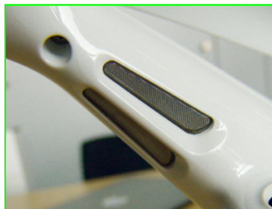
Mit Streckmetall-Gittern verschlossene Korpus-Öffnungen sorgen für gute Luftzirkulation innerhalb des Kopters
