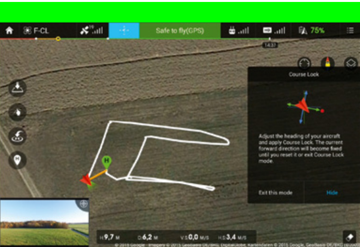
Abbildung 3: Testflug im F-Course Lock-Mode zeigt eine ordentliche, aber nicht perfekte Funktion bei Course Lock
