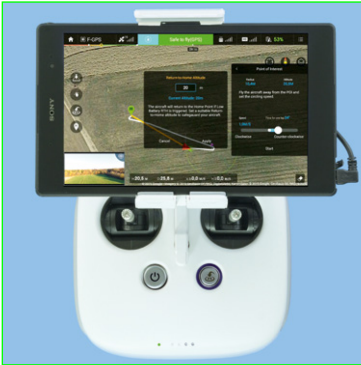
Kompakte, auch bei hellem Licht noch nutzbare Bodenstation. Die Helligkeit des Video Downlinks unbedingt mit dem rechten Drehrad am Sender einstellen
