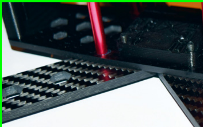
Die in den Armen befindlichen Sechskant-Ausfräsungen lassen sich auch als Propeller-Wechseltool verwenden
