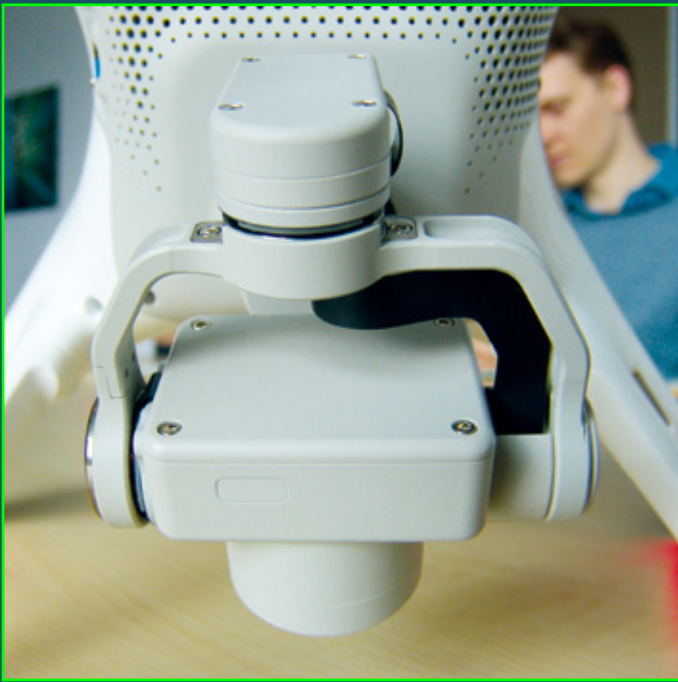
Die Kamera sitzt mittels einer U-förmigen Halterung symmetrisch im neuen Dreiachs-Gimbal
