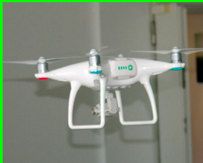
Um vor allem die „künstliche Intelligenz“ des Phantom 4 mit Hinderniserkennung kennenzulernen, wurde er bewusst gegen die Wand gesteuert – und bremste vollautomatisch vor dem Hindernis
