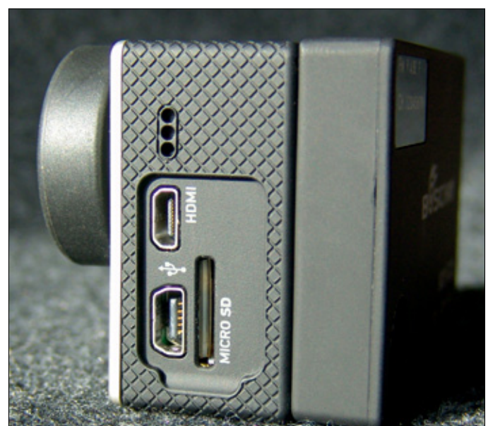
Die GoPro-Anschlüsse bleiben weiterhin zugänglich
