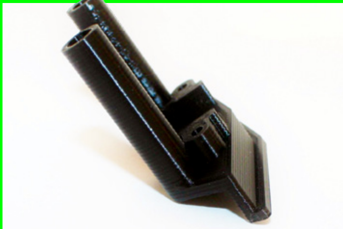
Das Kunststoff-Heckteil mit Ausfräsung für den XT60-Stecker stammt aus dem 3D-Drucker
