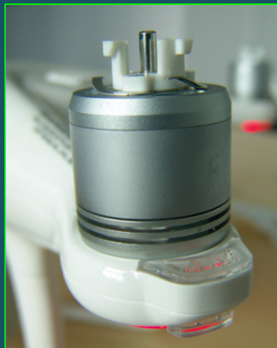
Gut für die Kühlung: Die neuen Außenläufer sitzen nahezu völlig frei
