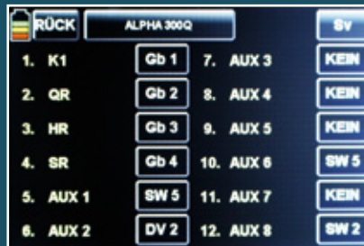
Im Gebermenü wird Kanal 5 auf den Flugphasenschalter gelegt
