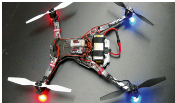
Optional wurde der Ninja noch zusätzlich mit Beleuchtung in Form von LED ausgestattet, um die Erkennbarkeit nochmals zu steigern
