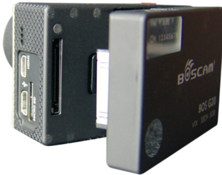
Die Boscam BOS G20 5.8G wird einfach auf die Rückseite der GoPro aufgesteckt
