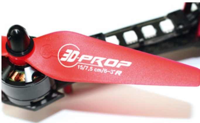
Die Graupner 3D-Props in 6x3 Zoll funktionieren perfekt und sind sehr stabil
