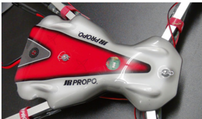
Mitgedacht: Die drei LED des Power-Board lassen sich durch ein klares Sichtfenster in der Karosserie einsehen. Die Befestigung der Haube erfolgt mittels Karosserie-Klammern
