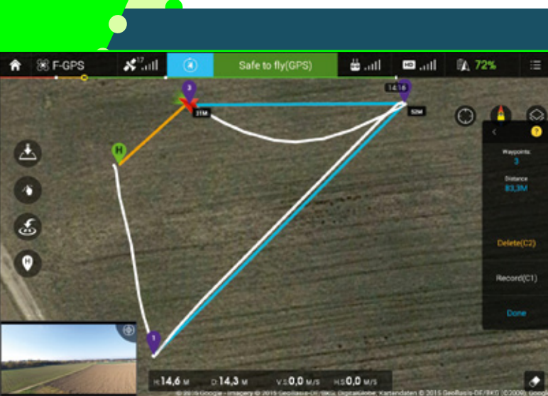
Abbildung 8: So wird eine Mission gespeichert (Route erzeugt). Der Phantom 3 macht das perfekt
