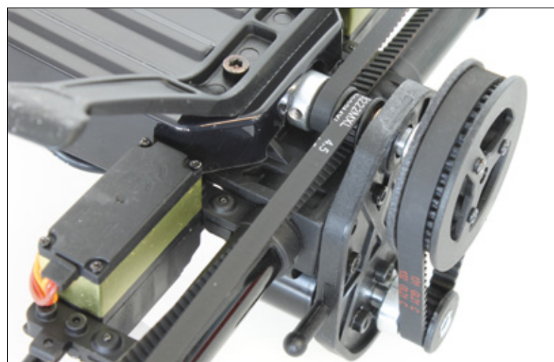
Der No-Name-Regler verträgt laut Herstellerangabe einen Strom von maximal 50 Ampere. Über Zahnriemen gelangt die Motorkraft von der zentralen Antriebswelle zu den Rotoren
