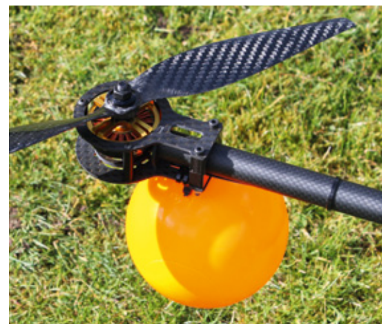
Zur besseren Lage-Erkennung dient eine orangefarbene Kunststoffkugel. Diese wurde am hinteren Ende eines Auslegers mittels Kabelbinder fixiert. Der Oktokopter MD8-800 kann mit Propellern von maximal 12 Zoll Durchmesser bestückt werden
