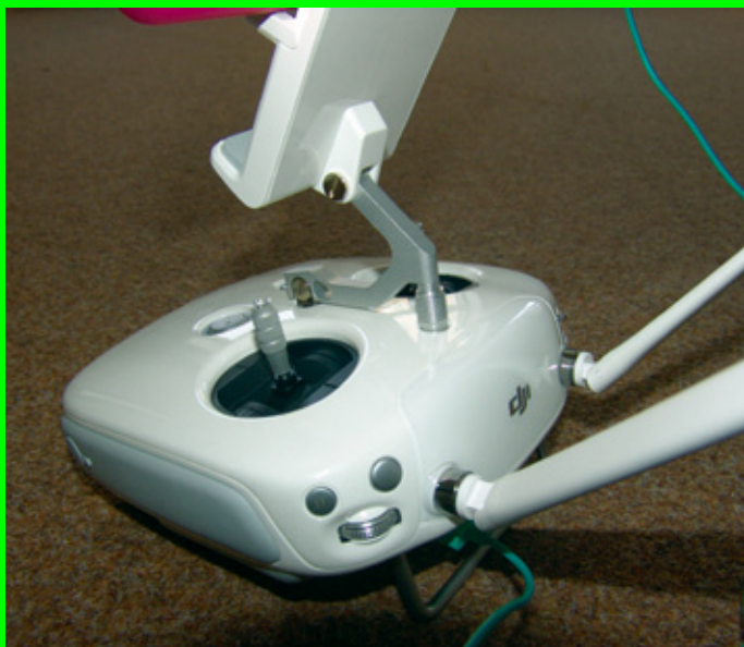
Der Haltebügel fürs Tablet/Smartphone besteht jetzt aus Aluminium
