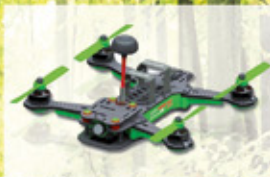
Blade Vortex Pro (BLH9250) • 7x ARM 32-bit Prozessoren • Fusion F3 mit Clean Flight • Programmierbare LEDs • Regler mit OneShot125 • EzOSD-Display • 4mm CFK Motorarme
