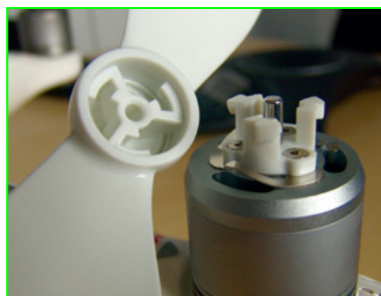
Die Montage der Props erfolgt über ein Bajonett-System – Schrauben gehört der Vergangenheit an
