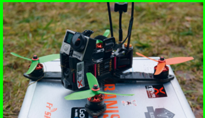
Ready for Race! Kopter mit Actioncam, FPV-Cam und Videosender
