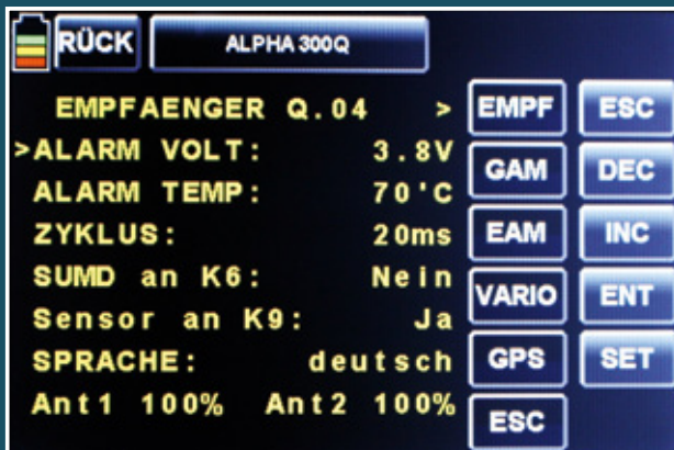
GR-18-Menü über Telemetrie: Neu in der Software-Version Q04 ist die Anzeige der Signalstärke je Antenne. Ist ein Telemetrie-Sensor verbaut, wird er an K9 aktiviert
