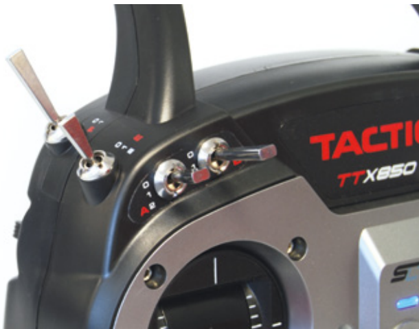
Die TTX850 wartet mit einem Taster, einem Zweizeige-, sechs Dreizeige-Schaltern und zwei seitlichen Drehgebern auf
