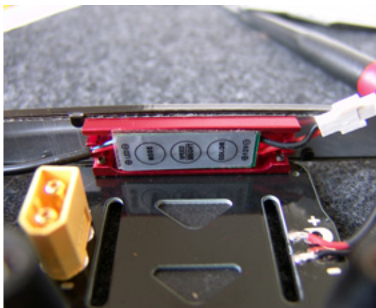
Die hintere Lichtleiste kann mit Hilfe dieser drei Taster programmiert werden
