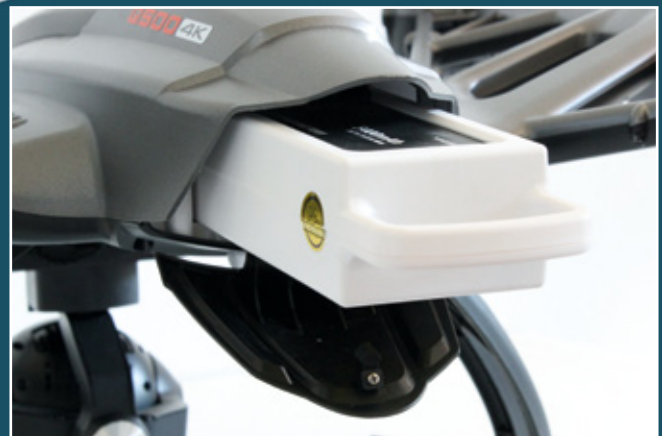
Der Flugakku, der saugend in den Schacht passt, lässt sich am Haltebügel wieder herausziehen. Feste Kontakte im Kopter und am Akku sorgen für eine sichere Verbindung
