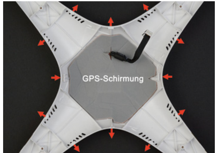
Der GPS-Empfänger befindet sich im Deckel. Die Pfeile markieren die Druck/Zugrichtung an der Oberschale zum Öffnen, wovon wir aber dringend abraten
