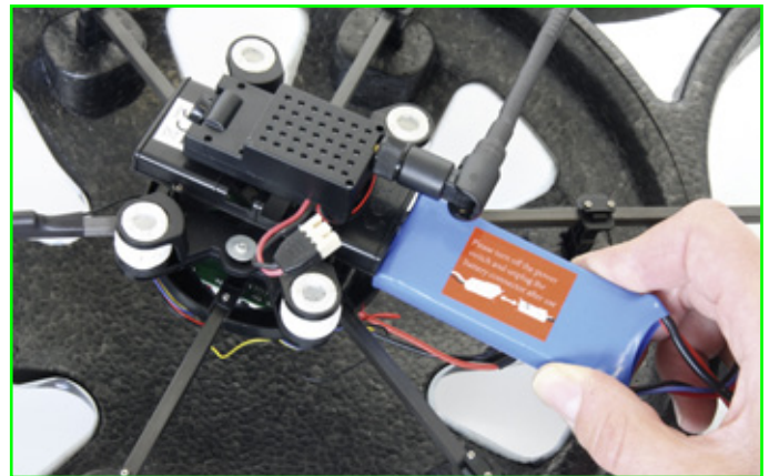
Der Akku sitzt sicher und fest in einem Schacht
