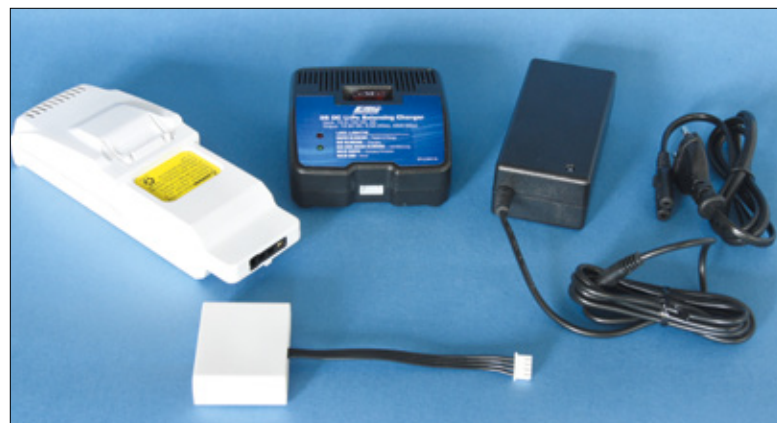
Zum Laden des Flugakkus liegen ein Balancerlader plus Steckernetzteil und Adapter bei
