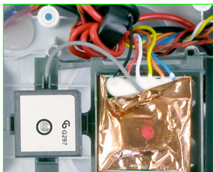
GPS-Antenne und Empfänger im Blade 350QX von Horizon Hobby. Im Bild ist oben ein Ferritring zum Abblocken von Motorstörungen zu erkennen
