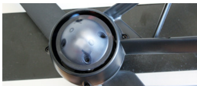
Unter den Motorgondeln befinden sich LED. Diese geben über Blinkfolgen Informationen zum Betriebszustand des Kopters
