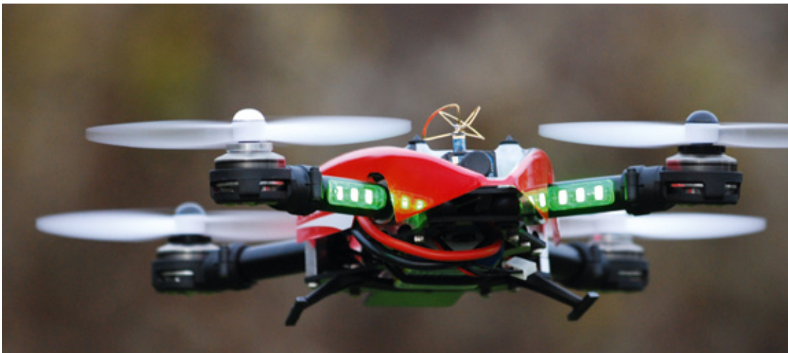
Die innen halbrund profilierten und am Alu-Rohr verklebten LED-Streifen helfen sehr gut bei der Lageerkennung
