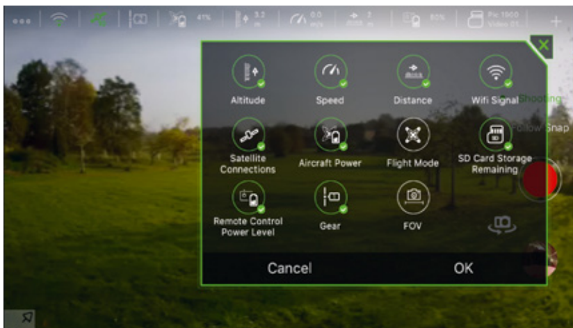
Oben auf dem Display sind die Telemetrie-Daten zu sehen. Welche man angezeigt bekommen möchte, lässt sich auswählen
