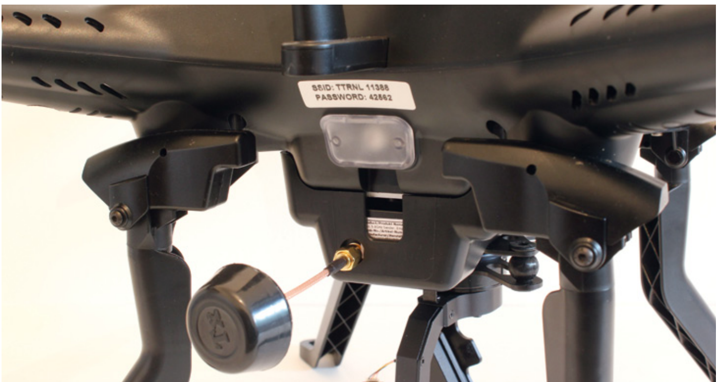
Die Rückenansicht des Kopters. Zentral die LED, darüber die Zugangsdaten fürs W-Lan. In den Boxen an den Beinen befinden sich die Motoren samt Getriebe zum Heben und Senken des Landegestells
