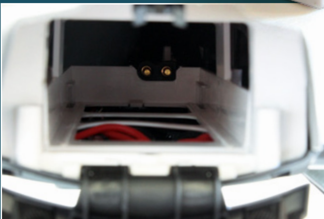
Der Flugakku, der saugend in den Schacht passt, lässt sich am Haltebügel wieder herausziehen. Feste Kontakte im Kopter und am Akku sorgen für eine sichere Verbindung
