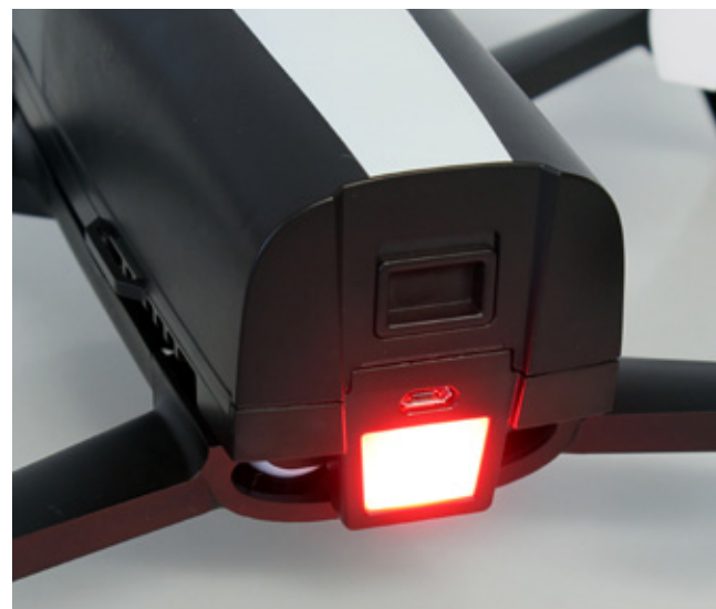
Der große Ein-aus-Schalter ist mit einer LED versehen, die während des Fluges die Lageerkennung vereinfacht
