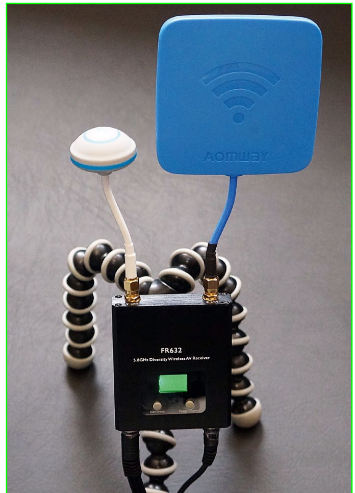
5,8-Gigahertz-Diversity-Empfänger mit einer omnidirektionalen und einer gerichteten CP-Antenne
