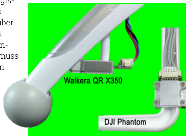
Beispiele für serienmäßige, in Multikoptern verbaute Magnetkompass. Links Walkera QR X350, daneben Phantom von DJI, jeweils an den Landebeinen befestigt
