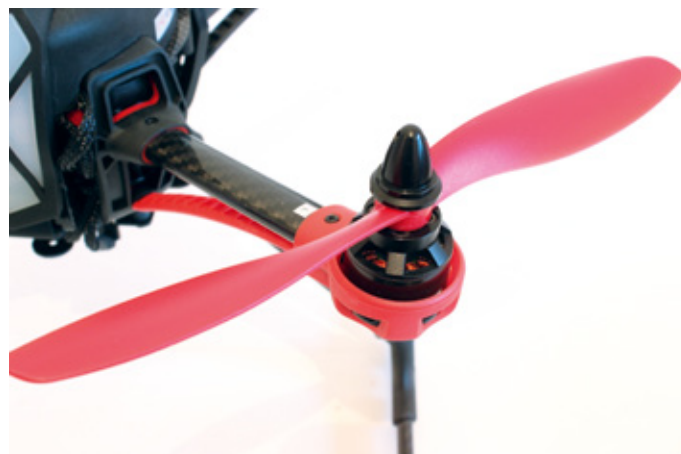
Die 203 Millimeter langen Props werden auf den Wellen der 1.400-kv-Motoren verschraubt
