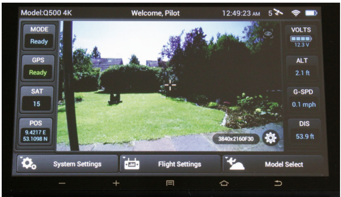
Neben dem Live-Bild der Kamera werden eine Reihe von Telemetriedaten auf dem Display der ST10+ ausgegeben. Hier zu sehen, der Kopter empfängt das Signal von 15 Satelliten und befindet sich 2,1 Fuß über Grund
