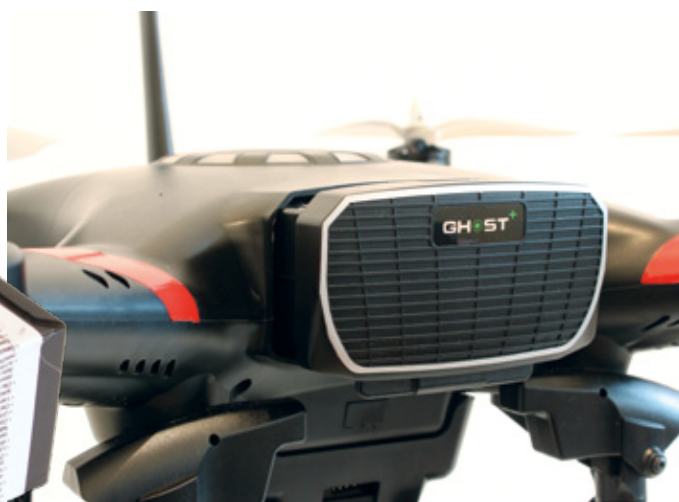
Der Flugakku ist in einer Box verstaub, kann jedoch gewechselt werden. Die Box ist mit dem passenden Anschluss versehen und der Kontakt wird beim Einschieben hergestellt
