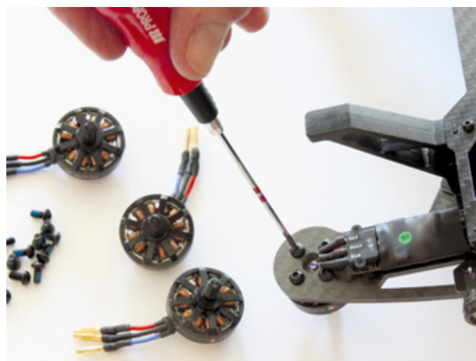
Kurze Schrauben sichern die hochdrehenden Brushless-Antriebe. Über Kabel sind sie mit den gesteckten Reglern kontaktet
