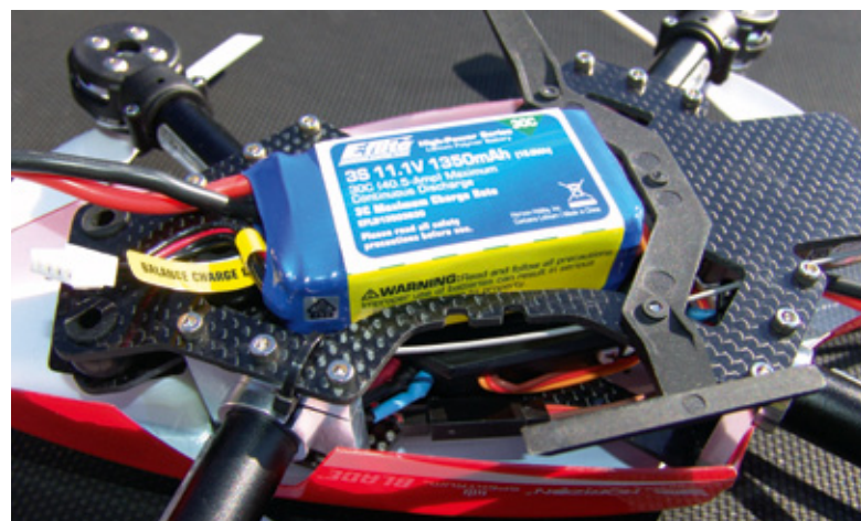
So sitzt der Akku im Schacht. Auf dem Bild fehlt nur noch der sichernde O-Ring (gehört zum Lieferumfang)
