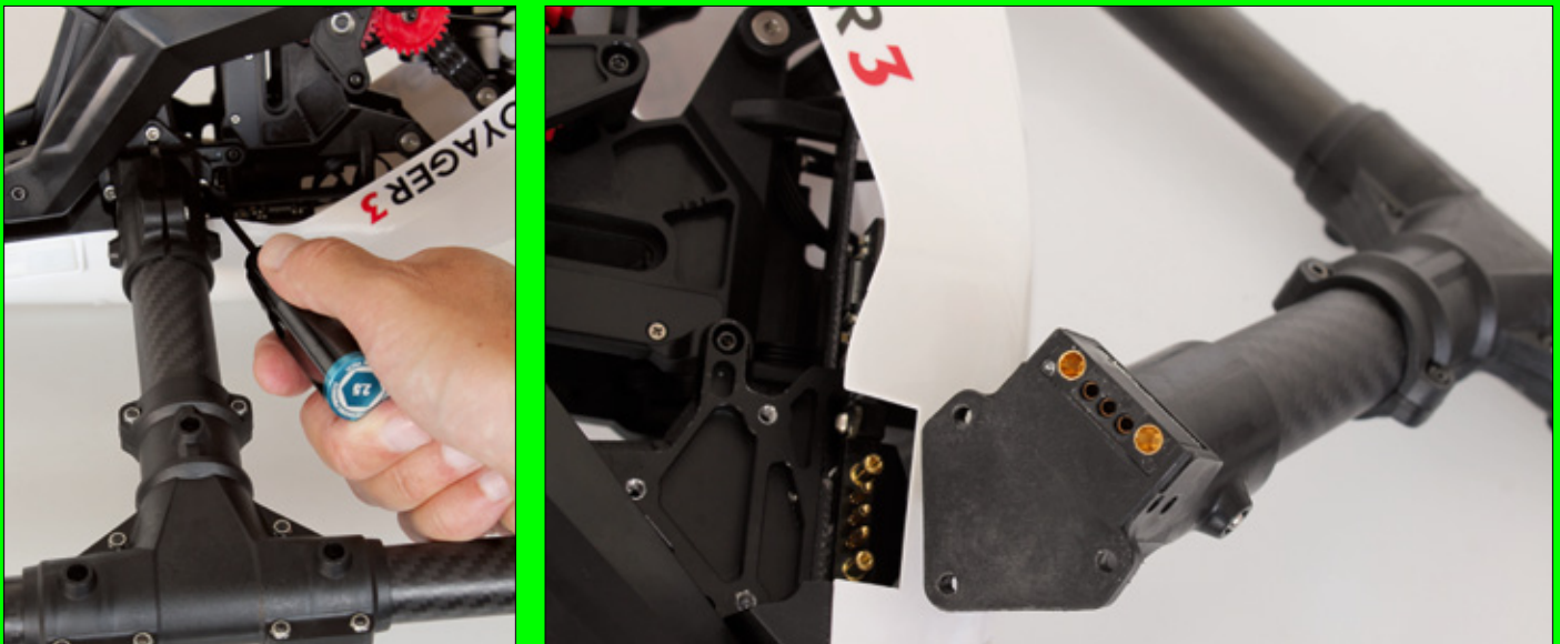
Sichere Stift- und Kontakt-Verbindungen garantieren absolute Betriebssicherheit. Befestigt werden die Ausleger allein über drei Inbusschrauben, was absolut ausreicht
