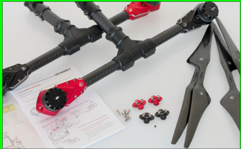
Ein hoher Vorfertigungsgrad und hochwertige Komponenten kennzeichnen die Voyager 3. Brushless-Motor und -Regler sind in den aus Alu erstellten Gondeln bereits eingebaut. Aus CFK sind die Blätter und Auslegerrohre
