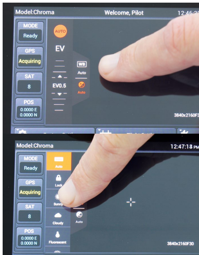
Über den Touchscreen der ST10+ lassen sich beispielsweise der Weißabgleich ändern oder die Blende steuern
