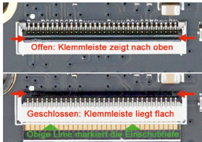
Große Vorsicht ist beim Öffnen/Schließen der Verriegelungen angebracht. Leitungen müssen bis zur Markierungslinie eingeschoben werden
