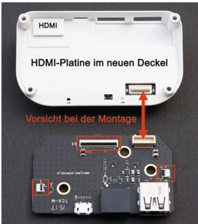
Der zweiteilige HDMI-Umrüstsatz erfordert große Vorsicht bei der Montage
