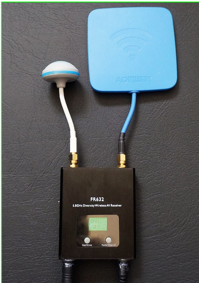
5,8-Gigahertz-Diversity-Empfänger mit einer omnidirektionalen und einer gerichteten CP-Antenne
