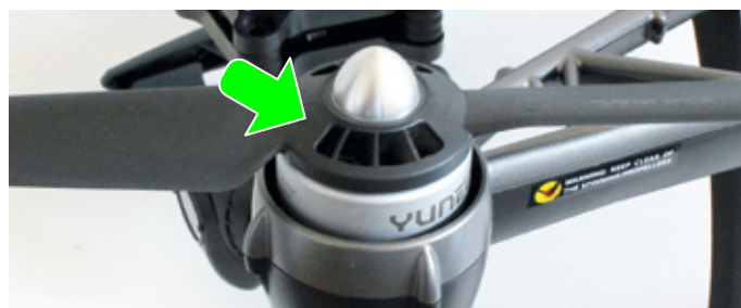
Die großdimensionierten Luftschrauben verfügen über Lüfterschaufeln, die die Motoren zusätzlich kühlen
