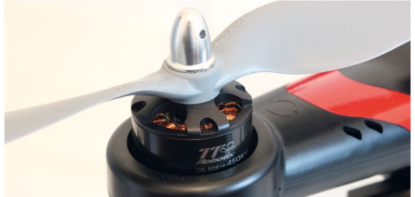
Die spezifische Drehzahl der Motoren beträgt 450 kv. Bestückt sind sie mit 11 x 5 Zoll-Props
