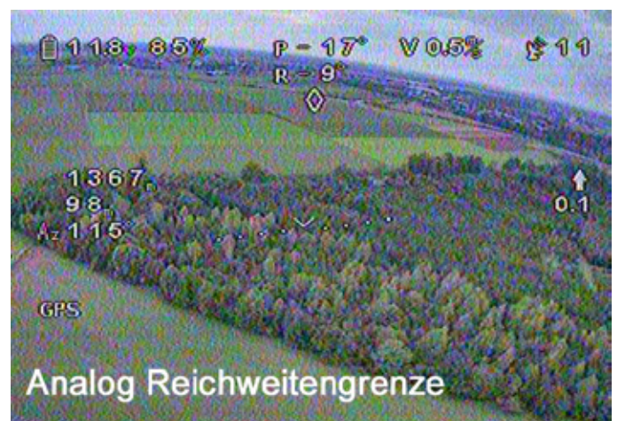
Das analoge Bild fällt nicht schlagartig aus, sondern wird mit wachsender Entfernung immer stärker verpixelt
