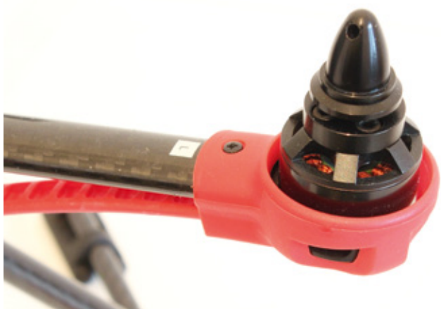
Die 203 Millimeter langen Props werden auf den Wellen der 1.400-kv-Motoren verschraubt
