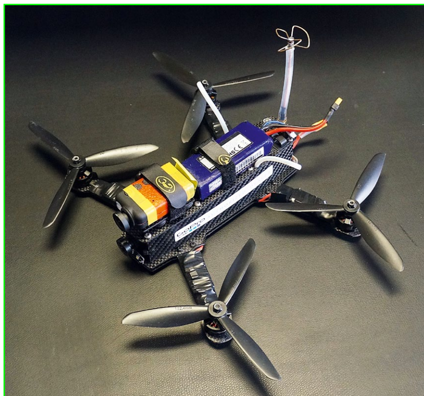
250er-Race-Copter komplett mit HD Mobius Kamera. Trotz unzähliger Abstürze ist dieser dank der robusten Bauweise noch gut in Schuss
