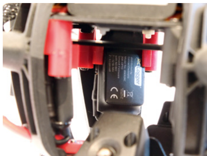
Die Motoren werden von 20-Ampere-Reglern angesteuert. Diese sind mit dem zentralen Power Board verbunden und stehend verbaut
