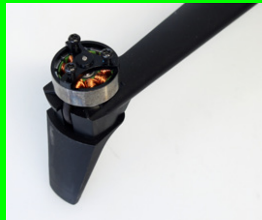
Die Propeller können schnell und einfach gewechselt werden. Einfach aufsetzen und durch Drehen arretieren
