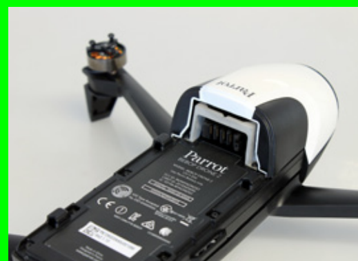
Die Buchse zum Akku-Anschluss ist nun fest im Kopter integriert. Bei der Version 1 gab es noch ein flexibles System mit Kabel
