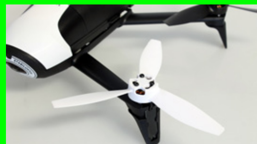
Die Propeller können schnell und einfach gewechselt werden. Einfach aufsetzen und durch Drehen arretieren
