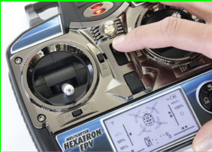
Über einen Schalter erfolgt der Mode-Wechsel. Beim Umschalten des Gasknüppels auf rechts wird der linke Stick automatisch in Neutralposition gebracht
