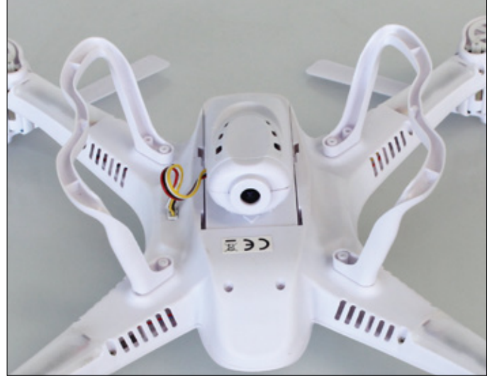
Montiert ist die Kamera auf der Akkufach-Abdeckung auf der Unterseite des Kopters.
