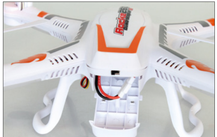
Der Energiespender hat reichlich Platz im Kopter. Er wird über die rückwärtige Klappe eingeschoben. Darüber sitzt der Ein-aus-Schalter
