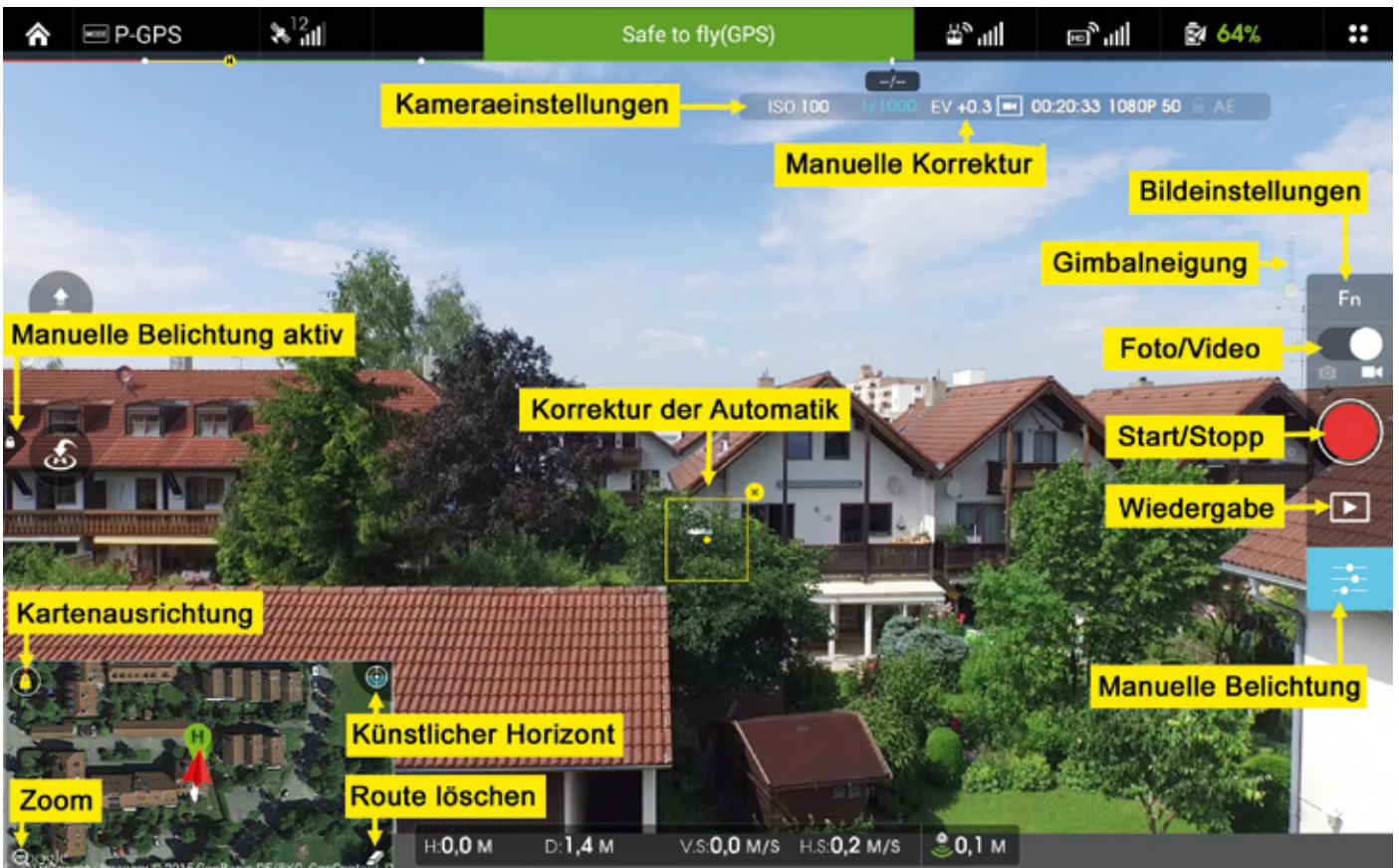
Die Bildseite zeigt das digitale Video-Downlink – hier beim Professional – mit hoher Bildqualität und ermöglicht Steuerung und Einstellung der Kamera. Antippen des kleinen Bilds unten links maximiert die Kartenseite
