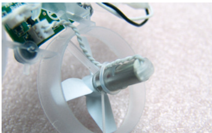
Mit winzigen O-Ringen werden die mit Stecker versehenen Anschlusskabel am Motorgehäuse fixiert
