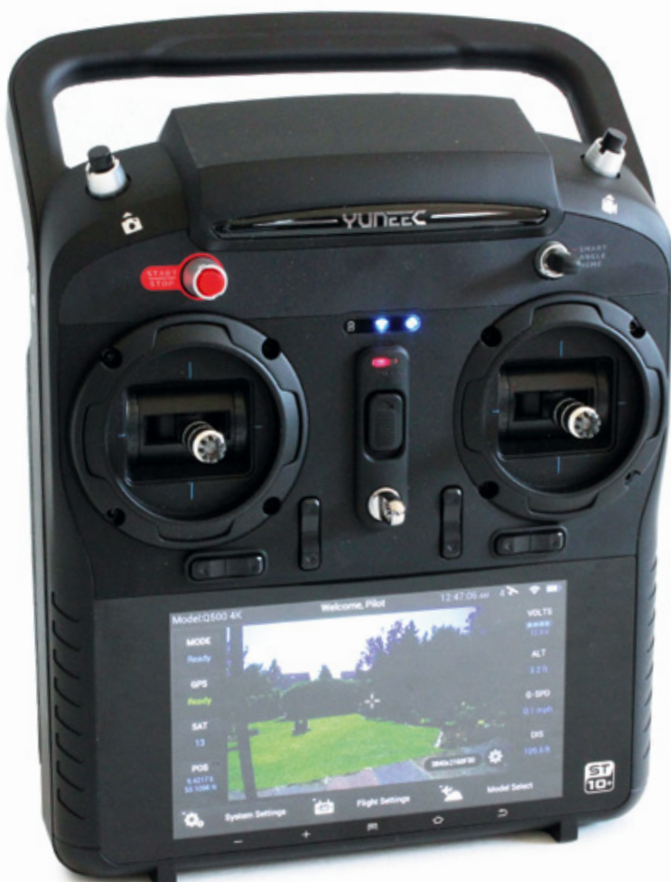
Das große 5,5-Zoll-Display ist das Kernstück der ST10+. Der Sender mit Android-Betriebssystem verfügt über zehn Kanäle
