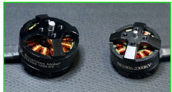
Deutlich sieht man den Größenunterschied zwischen dem kleinen 1806- (rechts) und dem wesentlich kräftigeren 2206-Motor (links)
