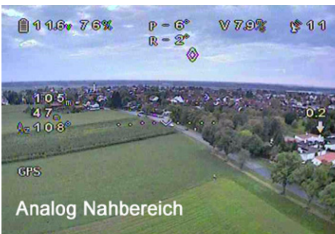
Das analoge Bild fällt nicht schlagartig aus, sondern wird mit wachsender Entfernung immer stärker verpixelt
