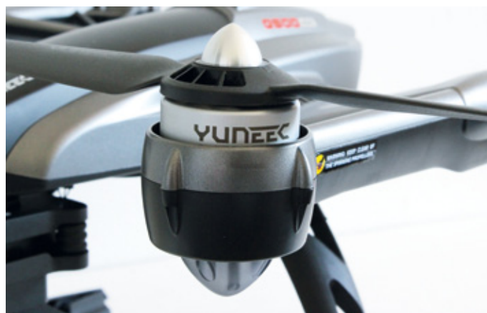
Die Motoren verfügen jeweils über eine spezifische Drehzahl von 700 Umdrehungen pro Minute und Volt
