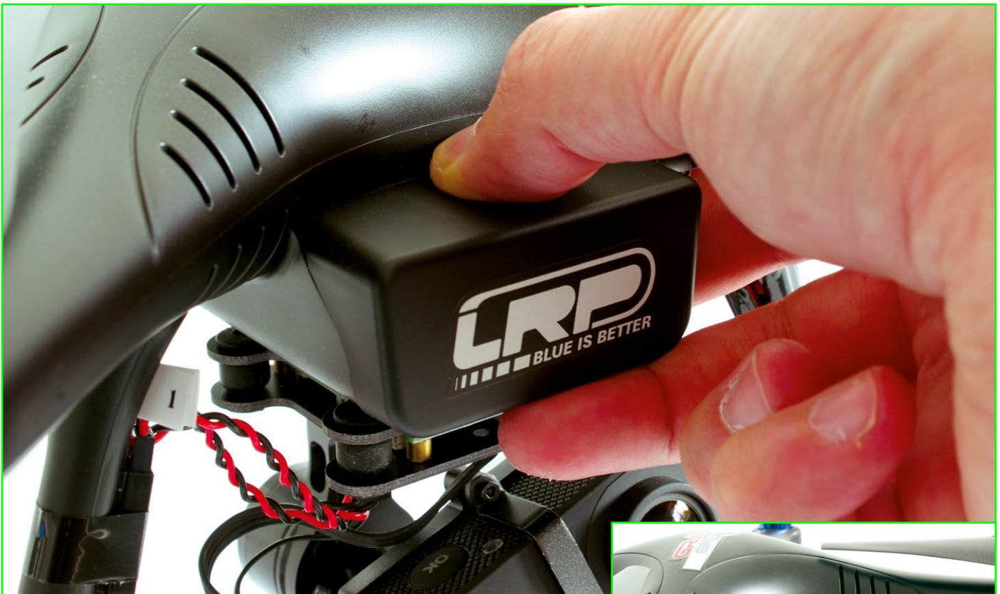
Der Akku-Schacht ist auf der Vorderseite und bietet nicht nur Platz für den Standard-, sondern auch den Tuning-Akku
