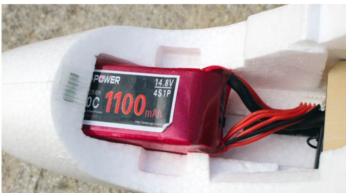
Bei der Wahl der Akkus muss auf die maximale Größe geachtet werden. Wir haben AGA-Power 4s mit 1.100 und 1.300 Milliamperestunden Kapazität verwendet
