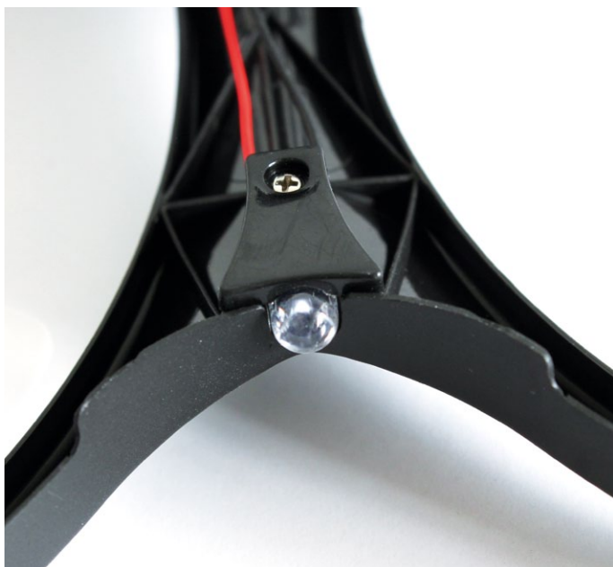
Eine Status-LED gibt Aufschluss über den gewählten Mode oder Unterspannung
