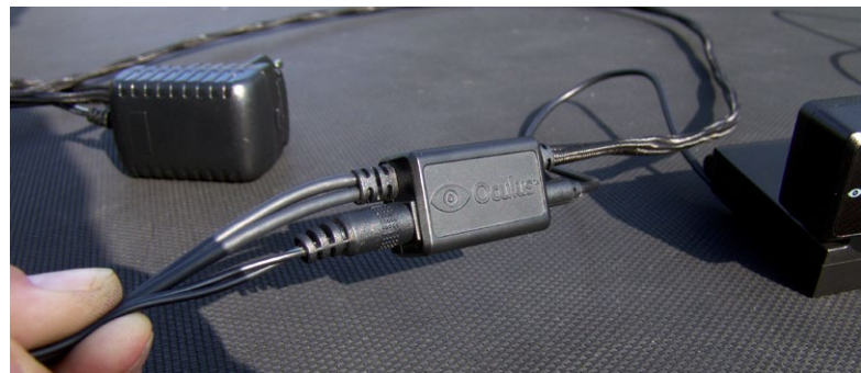
Am Splitter muss das Signalkabel des Positional Trackings (rechts unten) berücksichtigt werden. Der Stecker links gehört zum Netzteil und ist nur erforderlich, wenn die USB-Versorgung des Rechners zu schwach auf der Brust sein sollte
