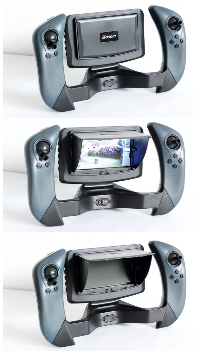
Der Sender erinnert an ein Formel 1-Lenkrad. In der Mitte ist der FPV-Monitor mit klappbarer Blende platziert. Das dargestellte Bild ist ruckelfrei und gut erkennbar
