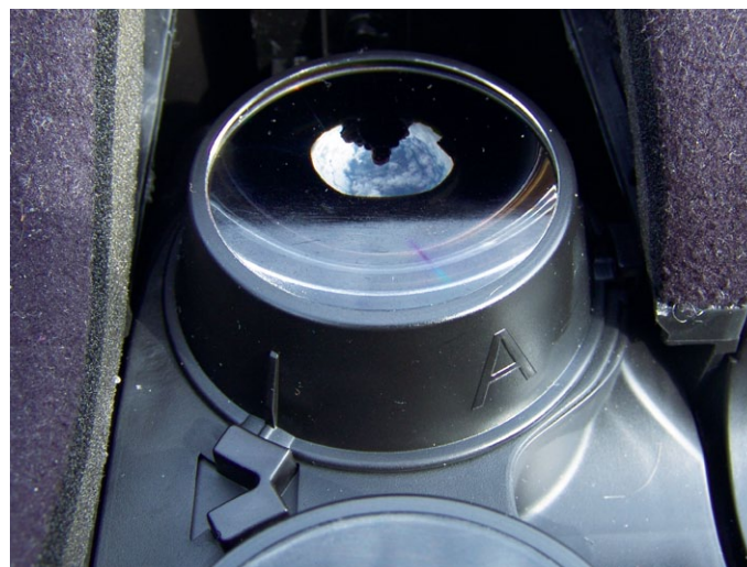
Die Lupenlinsen sind auswechselbar (A- und B-Version). Die Demontage erfolgt durch Drehen (Bajonett-Verschluss)
