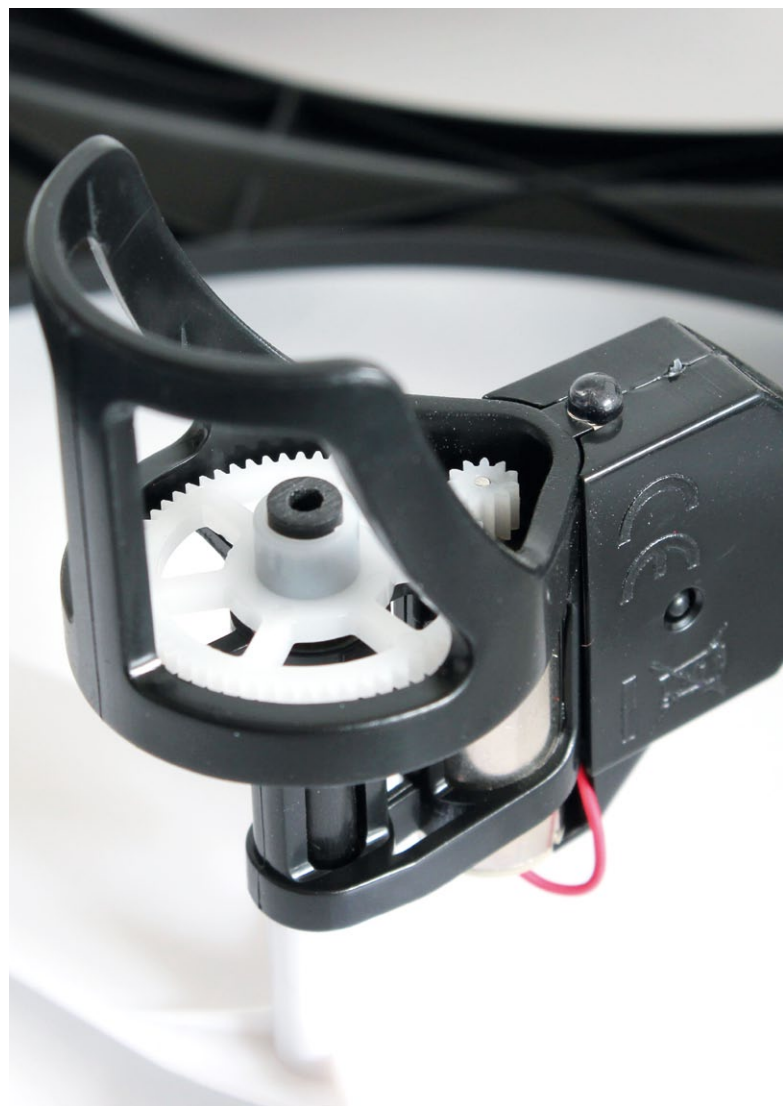
In Zeiten von Brushlessantrieben scheint die Verwendung von Bürstenmotoren mit Getriebe antiquiert zu sein: Die Performance des Kopters kann jedoch überzeugen
