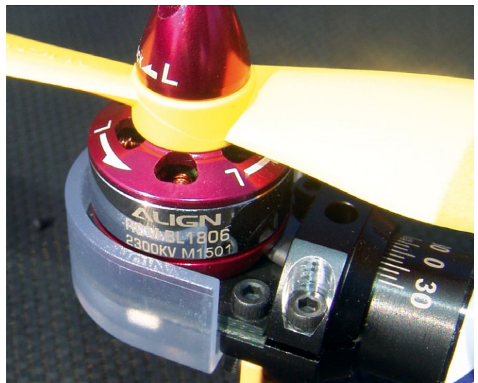
Auf Spinnerkappen und Außenläufern sind die Drehrichtungen markiert. Die Motoren lassen sich im Anstellwinkel beliebig verdrehen (Markierung)
