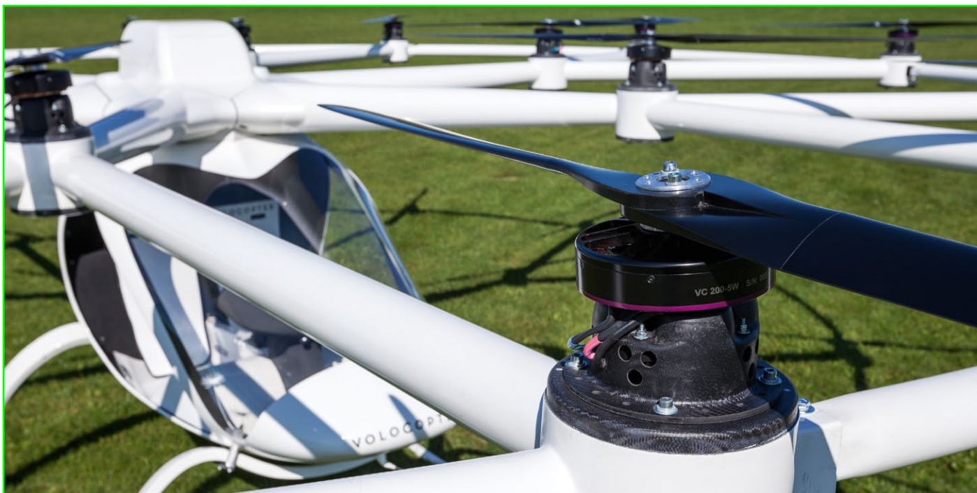
18 Elektroantriebe treiben den Volocopter an. Diese verteilen sich auf der 7.600 Millimeter durchmessenden Rotorebene
