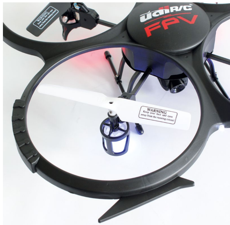
Propellerschutzrahmen sorgen dafür, dass der Kopter Feindberührungen unbeschadet übersteht
