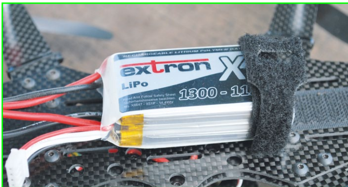
Der von Pollin bezogene Extron 3s-LiPo wird festgeklettet
