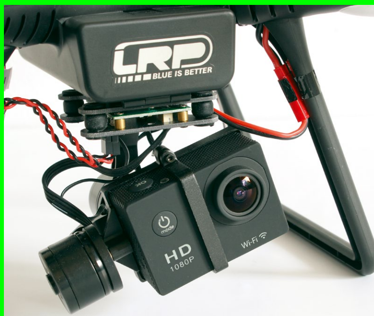
In der Pro-Version verfügt der Gravit über ein Zweiachsigimbal, das bereits betriebsfertig montiert ist. In der Standardausführung ist eine starre Kamerahalterung dabei
