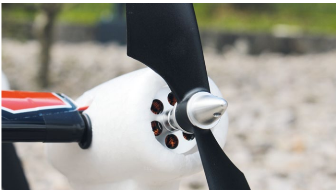
Die Brushless-Außenläufer sitzen in den vier Motorgondeln. Die Propeller werden mittels Klemmkonus am Motor montiert
