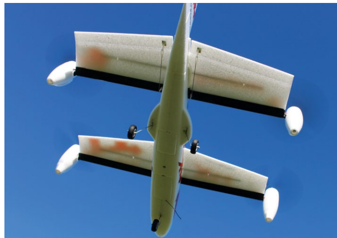
Deutlich zu erkennen sind die beiden an der hinteren Fläche angeordneten Ruder, die im Flugmodus über Delta-Mix die Höhen- und Querruderfunktion übernehmen
