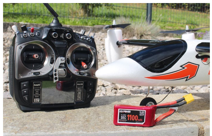
HoTT-Connection: der Graupner X44 VOTL mit dem passenden 4s-LiPo und der MZ-24
