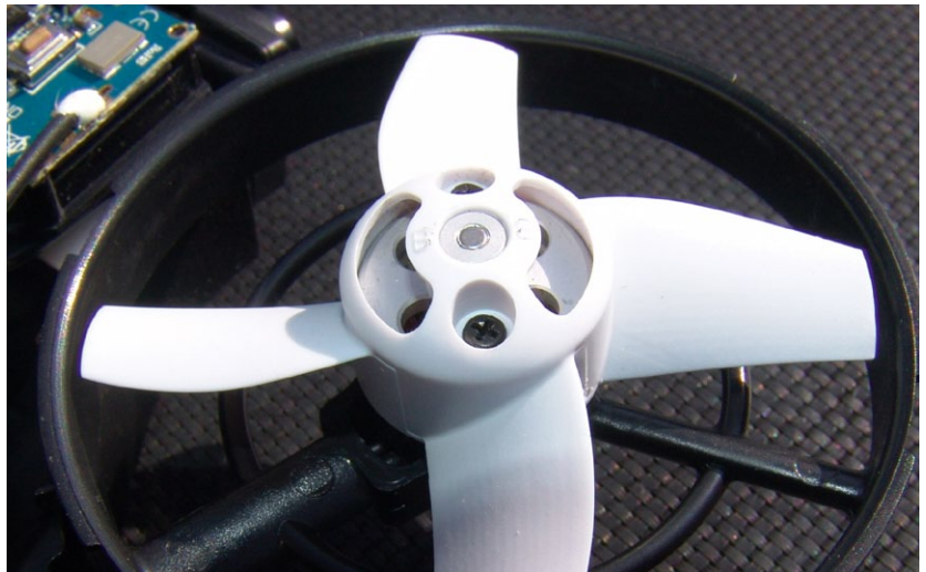
Die Vierblatt-Props mit ihrer außergewöhnlichen Blattform sind auf den Rotorglocken der Außenläufer verschraubt
