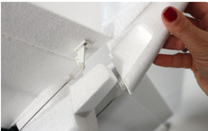
Die serienmäßigen Passungen an Seitenleitwerk und Rumpf garantieren einen perfekten Sitz und eine stabile Verbindung
