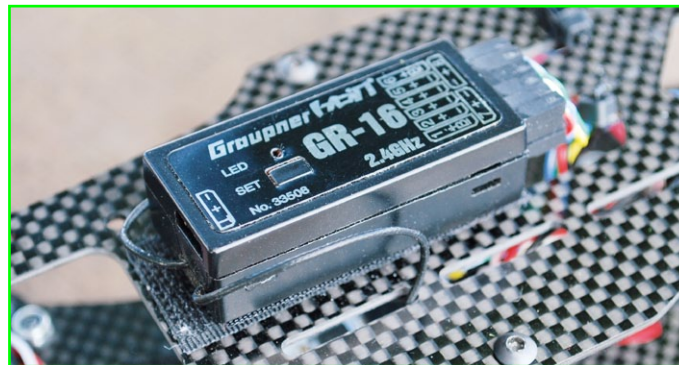
Der Graupner-Empfänger GR-16 sitzt auf dem Oberdeck
