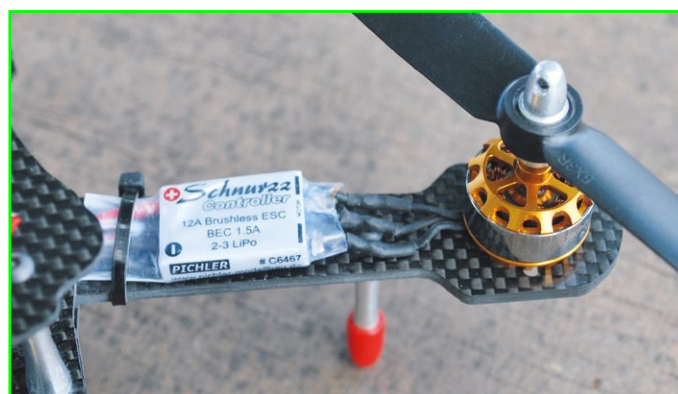
Auf den Auslegerarmen sind jeweils die mit Mitnehmer und 5 x 3-Luftschrauben versehenen Schnurzz-Motoren montiert. Die Schnurzz-Controller sind mit dem Motor verlötet und mit Kabelbinder befestigt
