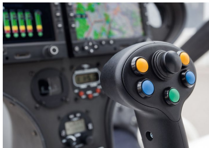
Geflogen wird der VC200 mittels Joystick. Lässt man diesen los, hält das System automatisch Position und Höhe
