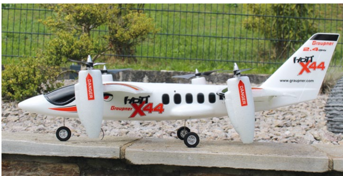
Im Helimodus (links) stehen die Motorgondeln etwa 90 Grad nach oben, im Flugmodus stehen die Motorgondeln je nach Einstellung fast parallel zu den Tragflächen
