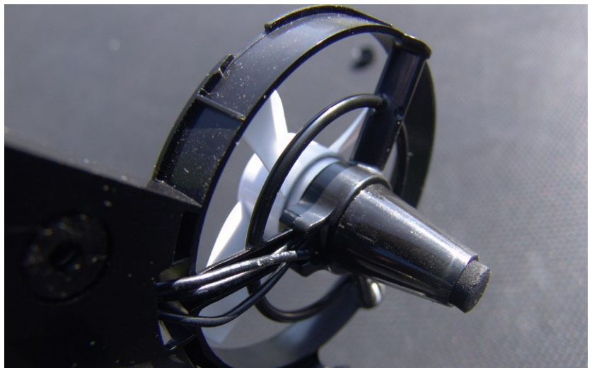
Die fest am Chassis angeformten Motorenaufnahmen dienen auch als Landebeine
