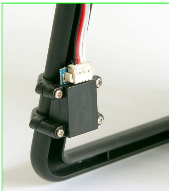
Unten am Landegestell, weit weg von Störungen durch die Elektronik, ist das Kompass-Modul platziert
