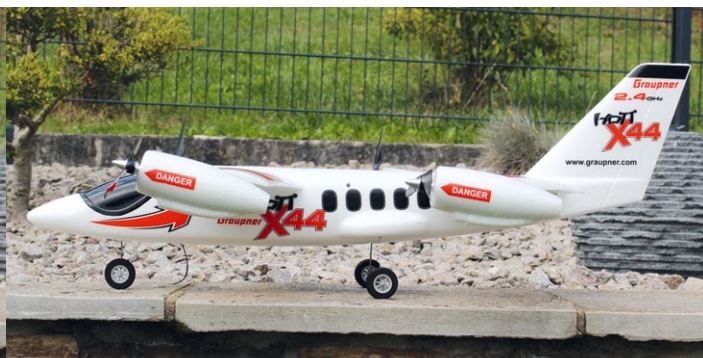
Im Helimodus (links) stehen die Motorgondeln etwa 90 Grad nach oben, im Flugmodus stehen die Motorgondeln je nach Einstellung fast parallel zu den Tragflächen
