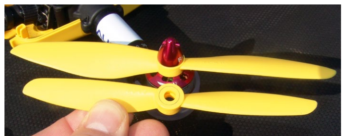
Zum Lieferumfang gehören 5- und 6-Zoll-Luftschauben. Rechtsläufer sind mit einem schwarzen Ring markiert
