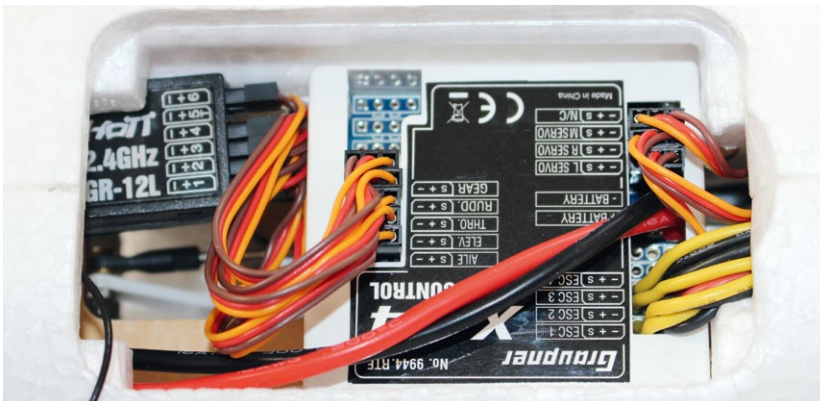
Die über fünf Anschlusskabel mit dem HoTT-Empfänger verbundene X44 Gyro/Controller-Einheit
