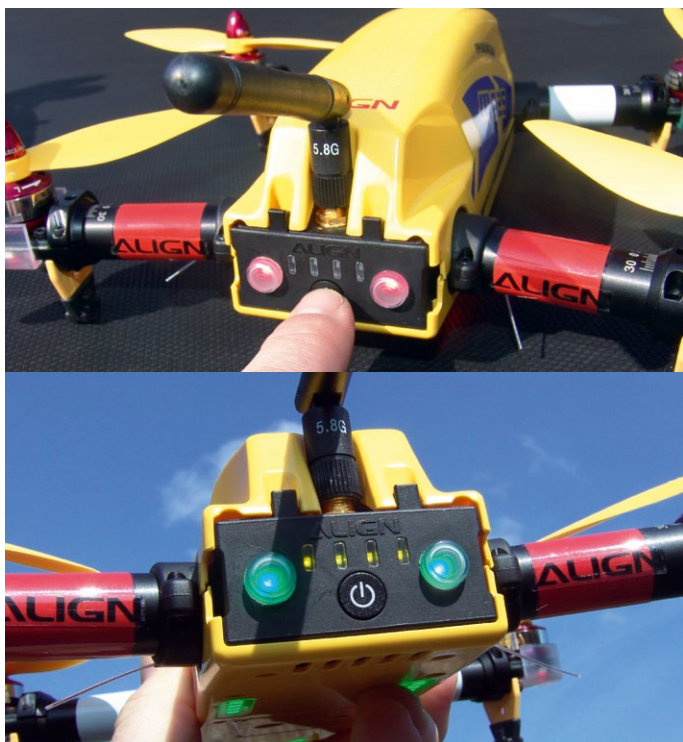
Sehr gut gelöst: Das Ein- und Ausschalten erfolgt am Akku-Management-Board, das auch über die vier LED-Balken den Ladestatus anzeigt
