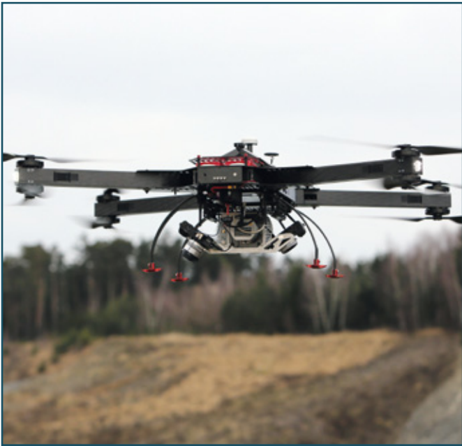
Riegl gibt die Flugzeit des System mit mehr als einer halben Stunde an
