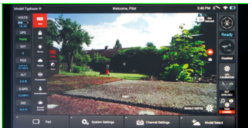
Die Bedienung des Senders erfolgt intuitiv. Der Bildschirm ist berührungsempfindlich, die Bedienoberfläche basiert auf Android
