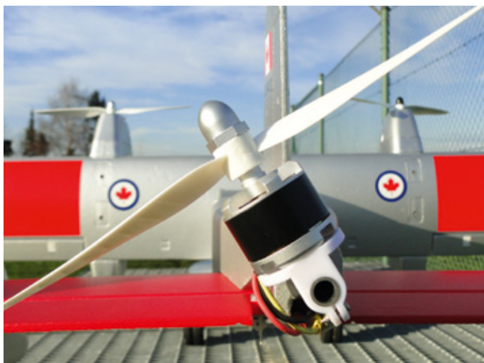
Der Heckrotor wird seitlich ausgelenkt, so dreht die CL-84 im Schwebeflug um die Hochachse
