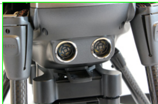
Ein Herzstück des Kopters sind die beiden Ultraschall-Sensoren, die Teil des Anti-Kollisions-Systems sind
