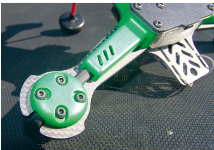
Blick auf die Unterseite mit den grünen Kunststoff-Verkleidungen von Motor-Unterseite und Auslegern
