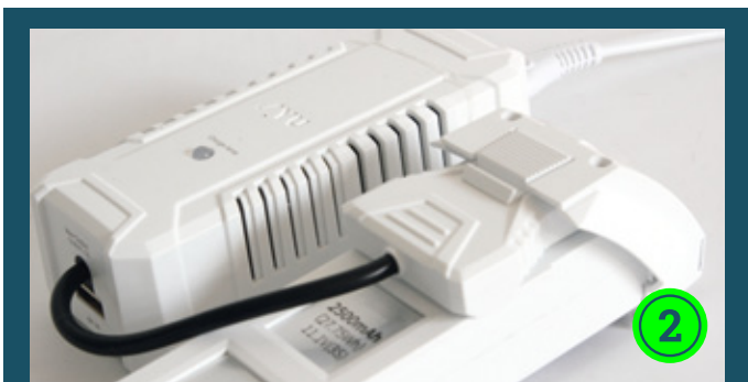
Vor dem Ladevorgang muss der Akku eingeschaltet werden. (1) Schließt man ihn im deaktivierten Modus an, gibt der Charger eine Fehlermeldung aus (2)
