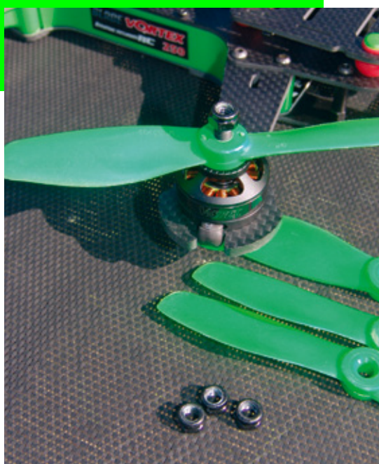
Die Props werden mit normalen M5-Stopmmuttern auf den Motorwellen befestigt
