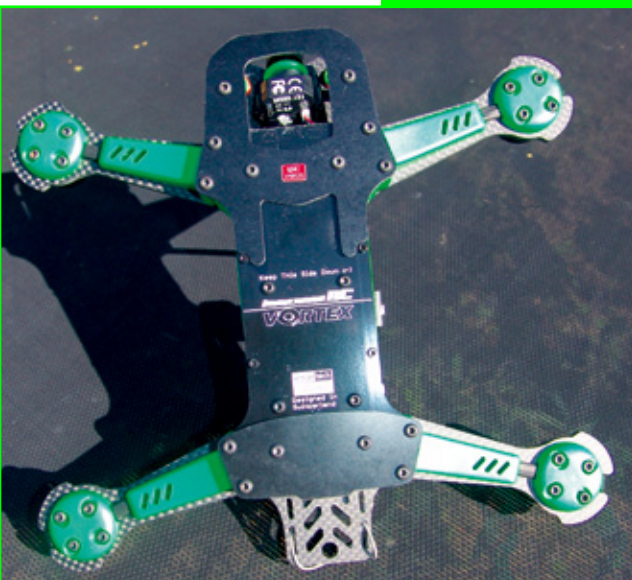
Deutlich zu erkennen sind die CFK-Aufdoppelungen an der Bodenplatte im Bereich der Auslegerarme, was die Konstruktion extrem stabil macht
