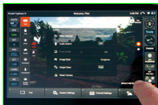
Die Bedienung des Senders erfolgt intuitiv. Der Bildschirm ist berührungsempfindlich, die Bedienoberfläche basiert auf Android
