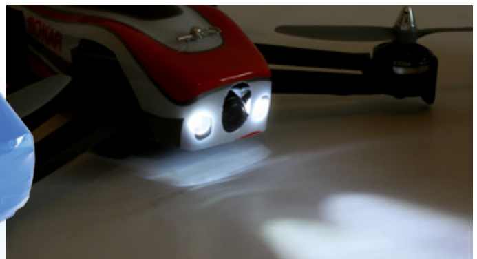
Die LED an der Front des Kopters sind hell. Ein Lichtbalken am Heck – gut für die Lagerkennung und im Rennen – fehlt hingegen
