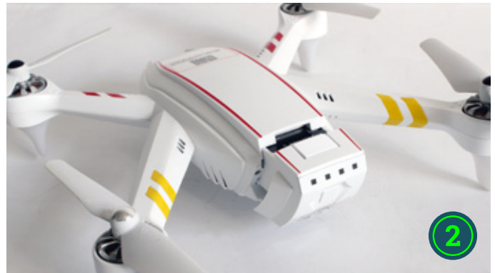
Am Heck des Hornet S befindet sich der große Akkusacht (1). Der Systemakku passt saugend hinein und lässt sich dort arretieren (2)
