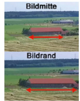
Winzige Ausschnitte aus Bildmitte/Bildrand. Sehr gute Optik und Bildqualität, kein „Durchbiegen“ von geraden Linien, aber kräftige Änderung der Objektgröße an den Bildrändern
