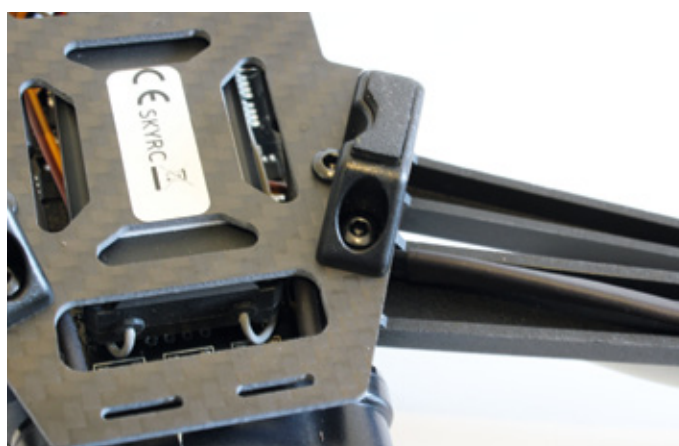
Anstelle eines Landegestells kommen beim Sokar FPV kleine Kunststoffklötze zum Einsatz
