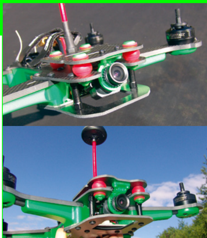
Die montierte FPV-Kamera des Typs FatShark 700TVL CMOS V2 ist an der oberen Platte verschraubt und lässt sich im Neigungswinkel verstellen
