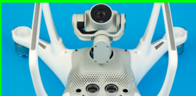
Das aus Magnesium gefertigte Unterteil mit Gimbal/Kamera macht einen hervorragenden Eindruck. Es enthält auch die Bodenkameras und die Ultraschall-Abtastung
