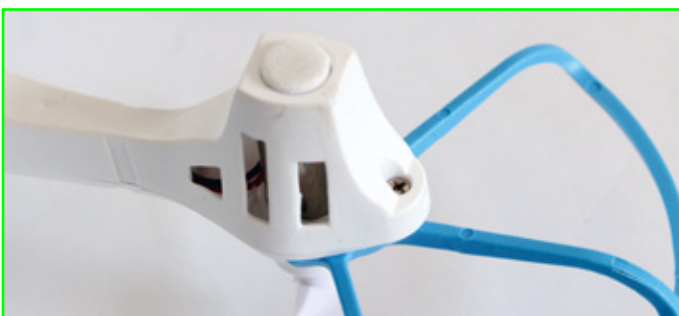
Dämpfergummis an den Motorgondeln sorgen für ein weiches Aufsetzen bei der Landung
