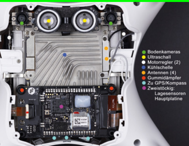
Modernste Elektronik auf engem Raum macht einen Vertrauen erweckenden Eindruck
