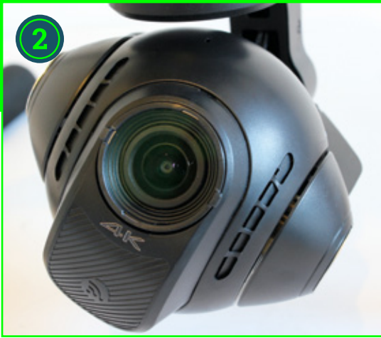
Die Gimbal-Kamera CGO3+ ist um 360 Grad drehbar und nimmt Videos in 4K-Qualität auf. Ausgeliefert wird sie mit einer arretierenden Halterung (1). Ausgerüstet ist sie mit einer 14-Millimeter-115-Grad-Linse mit einer Blende von F2.8 (2). Angesteuert wird die Kamera von Brushlessmotoren, die sie in der Waage halten (3)
