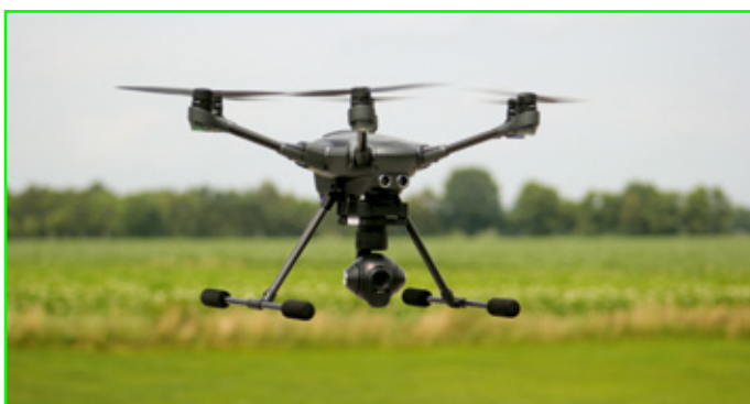
Das Landegestell des Typhoon H wird über die ST16 gesteuert. Innerhalb weniger Sekunden fährt es ein und wieder aus
