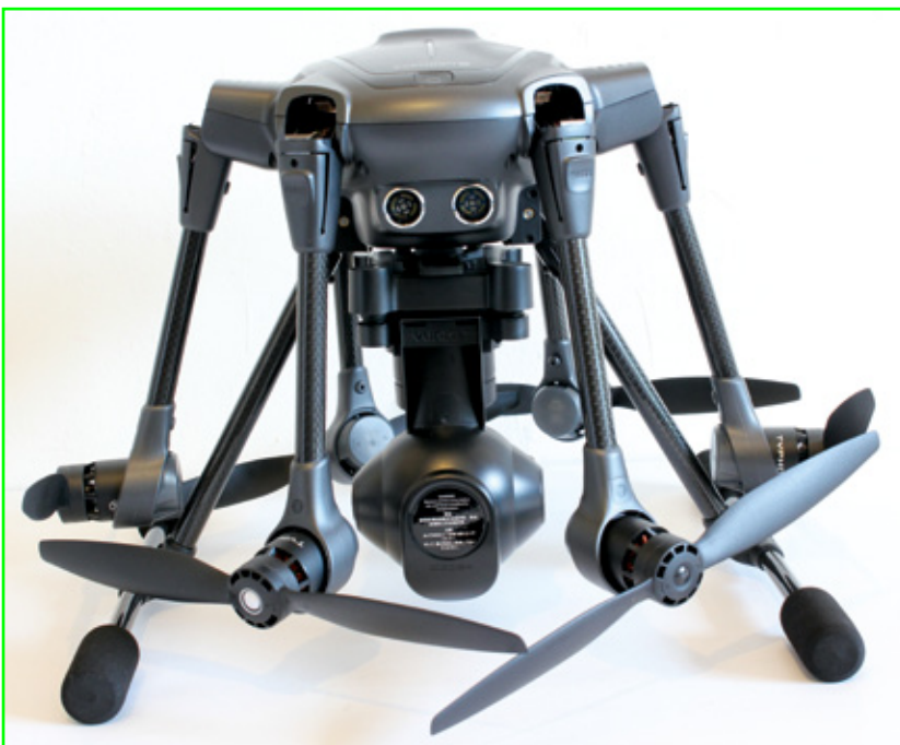
Dank der klappbaren Ausleger lässt sich der Typhoon H auf ein transportfreundliches Packmaß zusammenfallen
