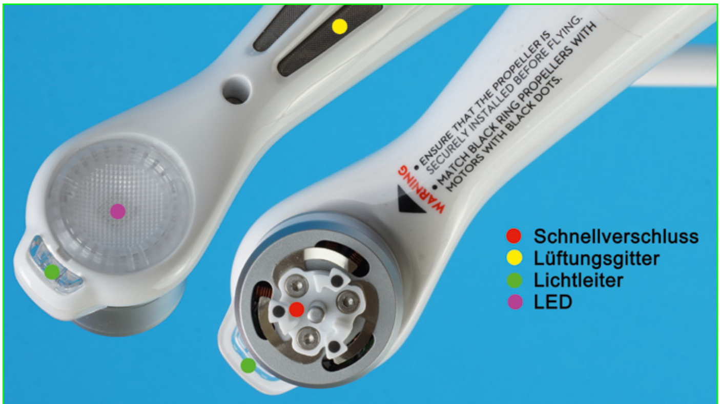
Genialer Schnellverschluss an den Motoren. Die LED sind hell – noch mehr Licht würde aber nicht schaden
