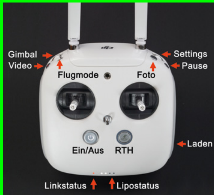
Der bewährte Sender ermöglicht Fliegen auch ohne Tablet
