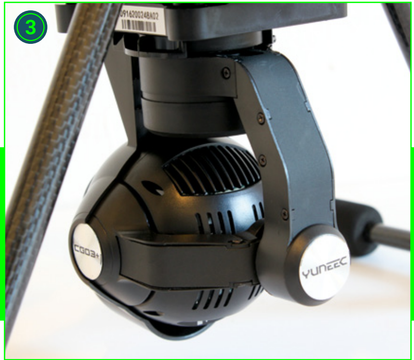
Die Gimbal-Kamera CGO3+ ist um 360 Grad drehbar und nimmt Videos in 4K-Qualität auf. Ausgeliefert wird sie mit einer arretierenden Halterung (1). Ausgerüstet ist sie mit einer 14-Millimeter-115-Grad-Linse mit einer Blende von F2.8 (2). Angesteuert wird die Kamera von Brushlessmotoren, die sie in der Waage halten (3)
