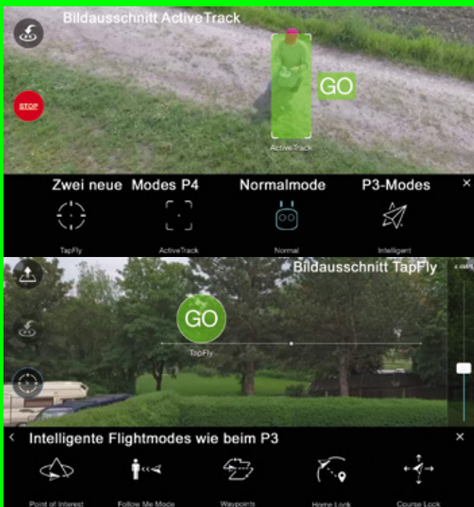
Bildschirm-Ausschnitte: ActiveTrack (oben) mit gelocktem Objekt; Grundmenü für die neuen Flugmodes. TapFly (unten) visiert nach links knapp über den Horizont; Menü der bereits vom Phantom 3 bekannten, intelligenten Flugmodi
