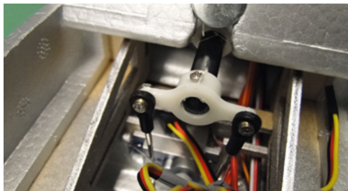
Die Steuerung zum Neigen des Heckrotors erfolgt über ein Servo im Rumpf, die Bewegung wird über ein starkes GFK-Rohr zum Heck übertragen
