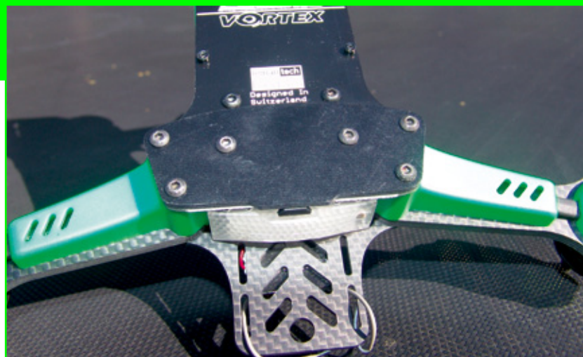
Deutlich zu erkennen sind die CFK-Aufdoppelungen an der Bodenplatte im Bereich der Auslegerarme, was die Konstruktion extrem stabil macht
