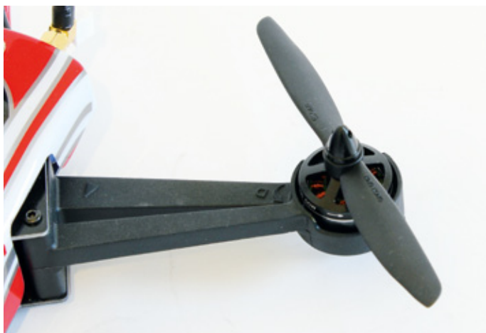
Die Motoren verfügen über eine Drehrichtungsanzeige. Die Zuordnung der Props gelingt daher ganz leicht
