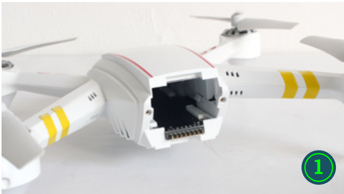
Am Heck des Hornet S befindet sich der große Akkusacht (1). Der Systemakku passt saugend hinein und lässt sich dort arretieren (2)
