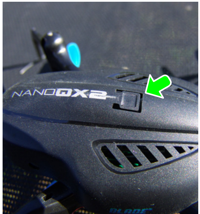
Auf der Oberseite der Kabinenhaube befindet sich der Tastschalter (Pfeil), mit dem die sieben Videokanäle ausgewählt werden können
