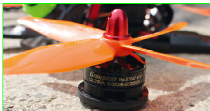
Angetrieben wird dieses Beast Evo X mit Graupner Ultra 2804-2300 KV Motoren und DAL-Vierblatt-Prop 5040
