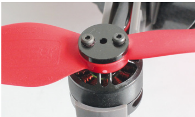
Die Propeller werden durch Schraubverbindungen gesichert
