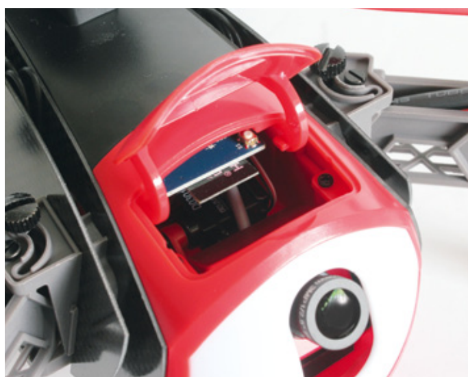
Eine Wartungsöffnung oben auf dem Modell erlaubt den Zugriff auf einen Teil der Elektronik – zum Beispiel die Kamera-Gimbal-Kombination
