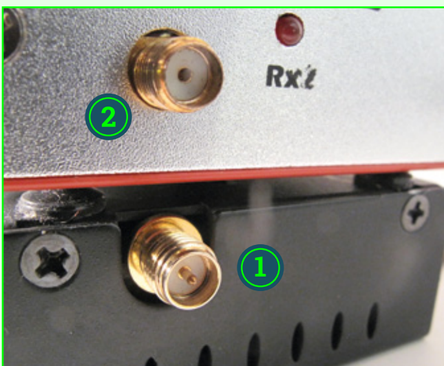
Zwei FPV-Empfänger mit unterschiedlichen SMA-Anschlüssen. 1: Ein alter 2,4 GHz Rx, (male), 2: ein 5,8 GHz IRC, der mehr weiblich geworden ist (female). 3: SMA (SubMiniature Version A) heißen diese Verbindungen und nur male und female passen zu entsprechenden Gegenstücken (2)
