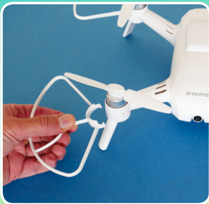
Leicht de/montierbare Schutzbügel helfen Anfängern und bei den ersten Starts
