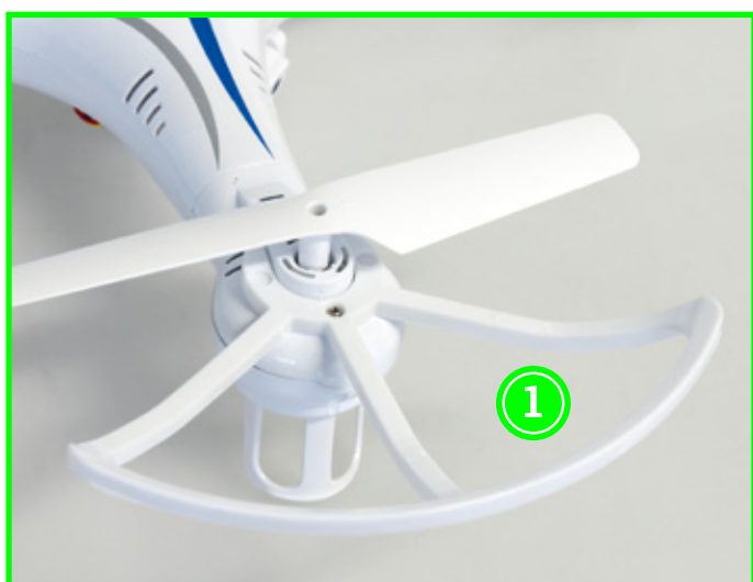
Die Propeller sind bereits auf den Motorwellen platziert. Geschützt werden sie von einem Prop-Guard (1). Bei den Aggregaten handelt es sich um Bürstenmotoren inklusive Getriebe (2)
