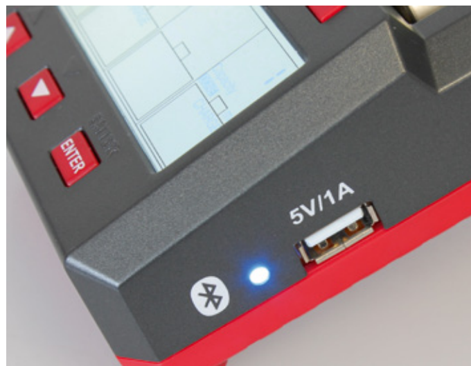
Über die Bluetooth-Schnittstelle bindet sich der X4 Advanced mit einem Smartphone. Praktisch ist der USB-Port
