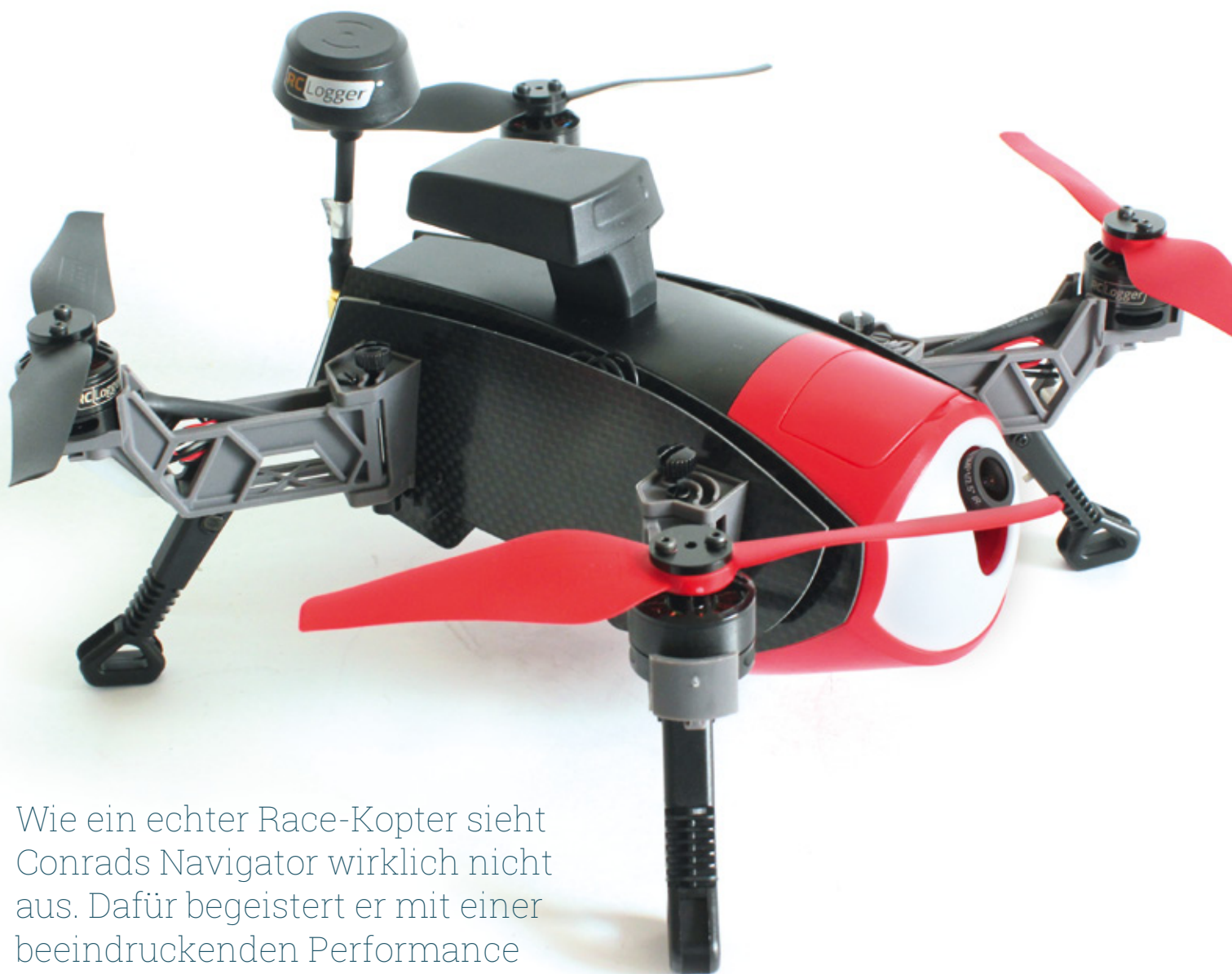
Ausleger und Landegestell sind klappbar ausgeführt. Auf diese Weise lässt sich der Kopter kompakt zusammenfalten
