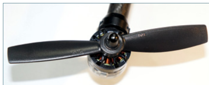
Die DAL Bullnose-Props machen ordentlich Druck und sorgen für ein fast wettbewerbsstaugliches Setup
