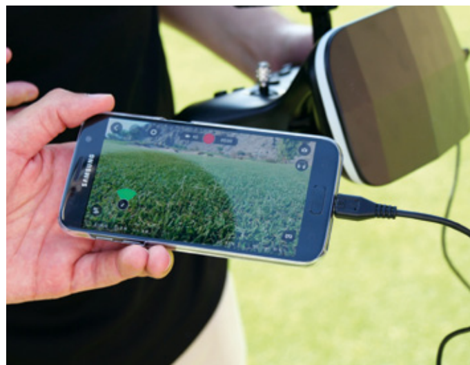
Das Smartphone wird mittels USB-Kabel an den Skycontroller gekoppelt. Es ist nicht mehr notwendig, eine Funkverbindung herzustellen
