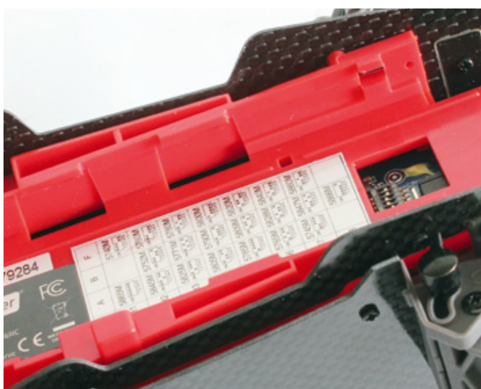
Die Auswahl der 5,8-Gigahertz-FPV-Kanäle zur Übertragung wird am Sendemodul getroffen – erreichbar über den Akkuschacht
