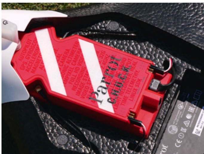
C.H.U.C.K. heißt das Autopilot-System, in dem alle elektronischen Bauteile der Disco integriert sind
