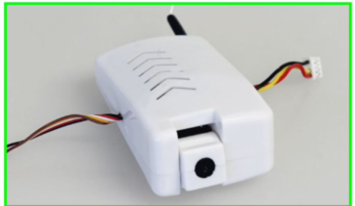
Das Objektiv der Kamera lässt sich über den Sender neigen. Ein praktisches Feature
