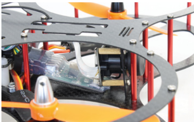
Die Kamera ist – klassentypisch leicht geneigt in der Front des Kopters platziert. Der FPV-Sender samt Pilzantenne sitzt am Heck des Modells
