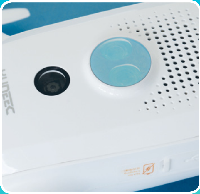
Boden-Sensoren ermöglichen das Fliegen und damit Selfies in geschlossenen Räumen
