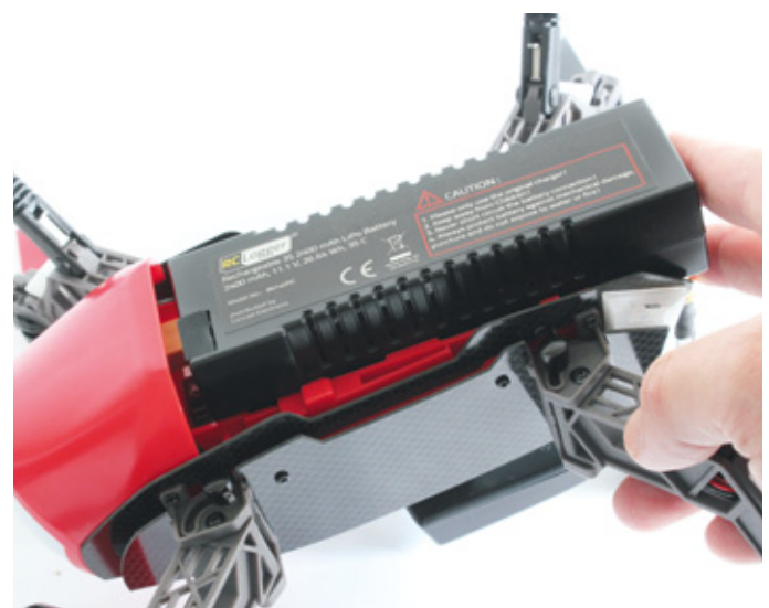
Der Akku verfügt über einen integrierten XT60-Anschluss. Arretiert man ihn, wird der Kontakt hergestellt
