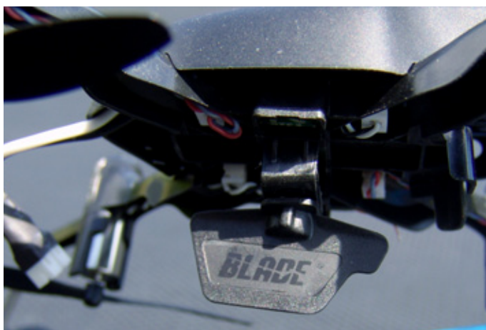
Eine mittig unter dem Kopter angeordnete Finne sorgt für die Einhaltung des Bodenabstands und damit Propschutz beim Landen
