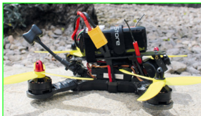
Das Beast Evo ist ein 200er-Kopter, der mit dem exakt gleichen Setup wie das Evo X ausgestattet ist. Die beiden Kopter liegen flugfertig knapp unter der magischen 500-Gramm-Grenze und sind so extrem schnell und agil
