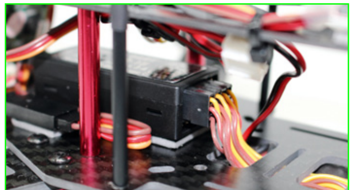
Alle Kabel sind sauber verlegt und angeschlossen. Im doppelten Boden sind die Controller nebst Kabel untergebracht
