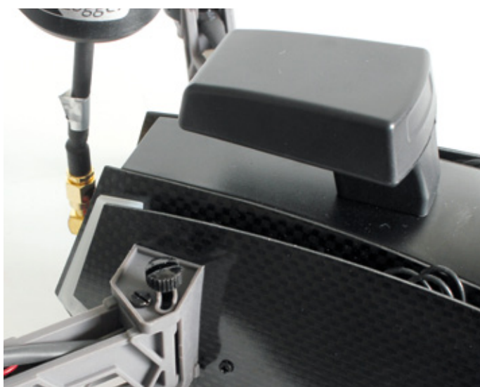
Sind die Ausleger komplett ausgeklappt, werden sie mit einer Schraube so gesichert, dass sie sich nicht mehr bewegen können. Gut zu sehen: das GPS-Modul auf dem Kopter
