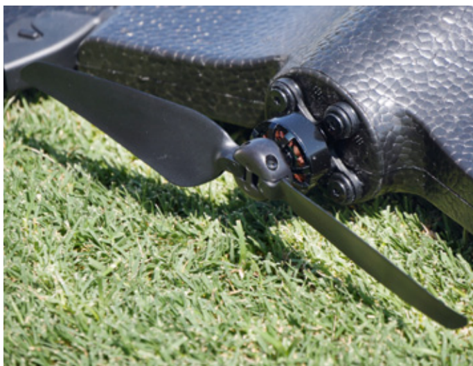
Ein Brushlessmotor mit Klappflugschraube sorgt für Vortrieb. Die maximale Geschwindigkeit liegt bei 80 Kilometer in der Stunde
