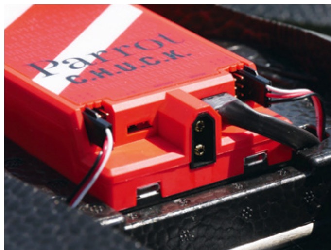
C.H.U.C.K. heißt das Autopilot-System, in dem alle elektronischen Bauteile der Disco integriert sind
