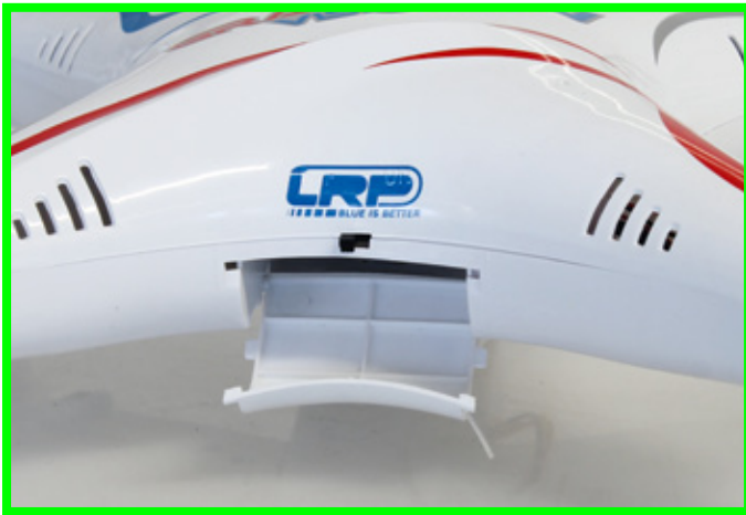
Der Akku wird in den entsprechenden Schacht am Heck eingeschoben. Darüber ist der Ein-aus-Schalter platziert
