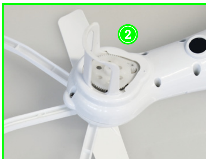
Die Propeller sind bereits auf den Motorwellen platziert. Geschützt werden sie von einem Prop-Guard (1). Bei den Aggregaten handelt es sich um Bürstenmotoren inklusive Getriebe (2)
