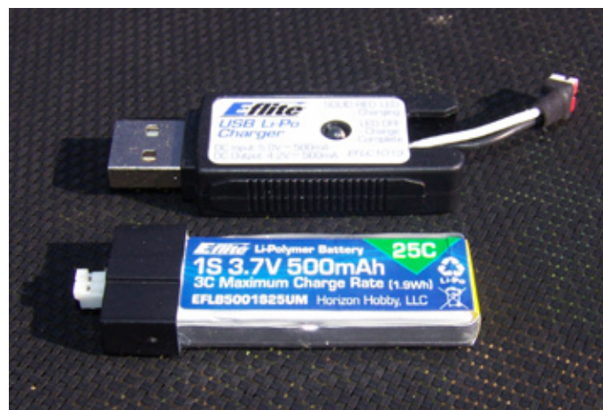
Zur Stromversorgung dient ein 1s-LiPo, geladen wird über USB mittels des Chargers
