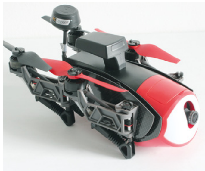
Ausleger und Landegestell sind klappbar ausgeführt. Auf diese Weise lässt sich der Kopter kompakt zusammenfalten
