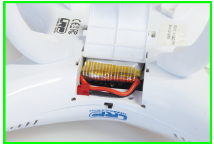
Der beiliegende 1s-LiPo passt perfekt in seine Halterung hinein. Eingesteckt wird er im vorderen Schachtbereich
