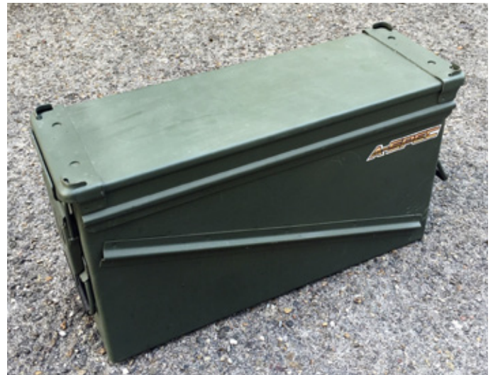
Unter dem Sticker befindet sich eine Druckausgleichsbohrung in der Munitionskiste, in der die LiPos transportiert werden
