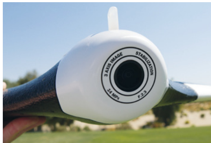
Die Kamera in der Rumpfnase der Disco kennt man von der Bebop Drone 2. Sie verfügt über 14 Megapixel und nimmt in Full-HD auf
