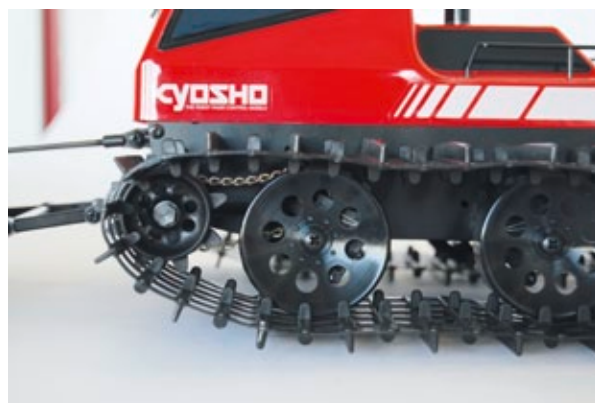
Blick aufs Leitrad. Ist der Schwerpunkt vom Blizzard SR richtig gewählt, kann die Raupe mit ihrer Kunststoffkette auch durch ungemütlichere Landschaften fahren
