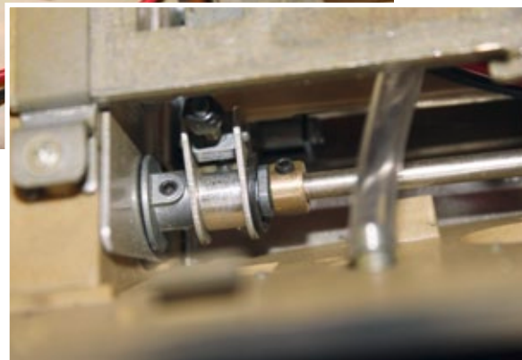
Der linke Kettenspanner – die Justierung wird mittels Stellschraube vom Unterboden bewerkstelligt
