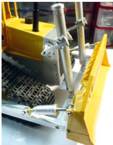
Die Zylinderattrappe besteht aus Alu-Rundmaterial, die entsprechenden Halterungen wurden bei Stahl Modellbau erworben
