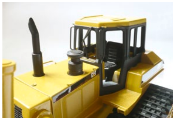
Ebenfalls aus Alu-Rundmaterial: Der Luftfilter und der Auspuff der D8R ähnlichen Raupe
