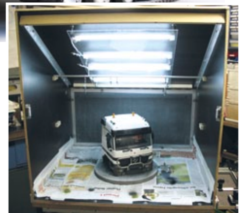
Für alle Sparten des Modellbaus interessant: Eine Airbrush-Absaugung im Eigenbau
