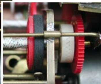
Das weiße Zahnrad greift in das doppelte Zahnrad der Greiferseilwinde und wird für die Freifallfunktion nach links ausgerückt
