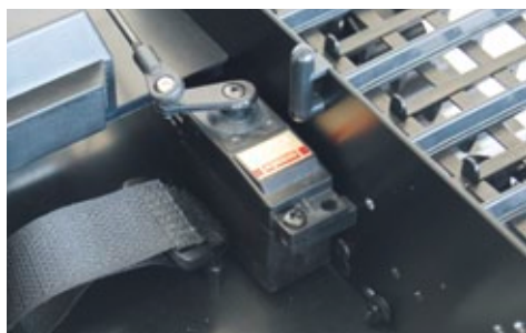
Ein leistungsstarkes KS-101BK-Servo sorgt für das Heben und Senken der Schneeschaufel
