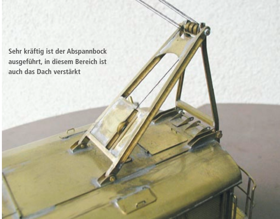
Der Ausleger ist satte 690 mm lang und besteht aus vier Segmenten. Die Abstände der einzelnen Querstreben wurden mit einem quadratischen Pertinaxplatte ausgemessen
