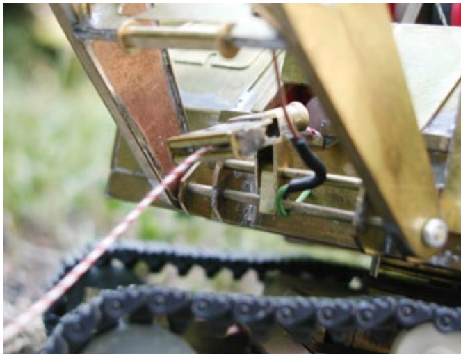
Detailansicht des Fairlead, auch bei Ablenkung des Zugseils wird es sicher zur Winde geführt
