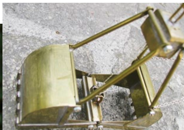
Details am Zweiseilgreifer. Die Greiferschalen wurden aus 0,5 mm dicken Messingblech hergestellt
