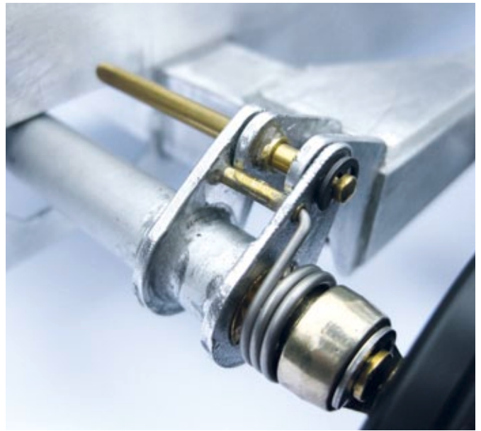
Beide Spannräder sind an der Spannachse befestigt, die für die nötige Kettenspannung sorgt
