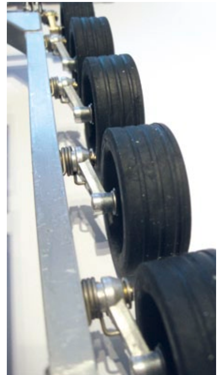
Durch die gefederten Laufrollen behält das Modell auch bei unebenen Pisten sein gutes Fahrverhalten
