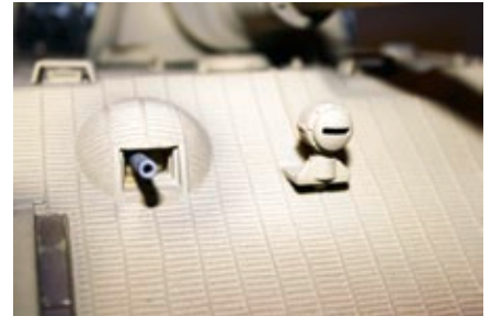
Besonderes Detail: Die Panzer der Wehrmacht wurden zum Schutz vor Haftminen mit einem antimagnetischen Zimmerit bestrichen. Die vorbildähnliche Darstellung ist Torro gelungen
