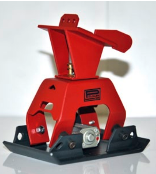
Ein drehbarer Anbauverdichter. Als Vorbild diente ein Modell von der Firma Amman
