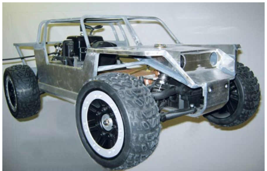
Vom Carbon Fighter bleibt am Ende nicht viel übrig: fast alle tragenden Teile, vor allem die Bodenplatte, wurden durch Aluminium oder Stahl ersetzt. Gut zu erkennen ist auch schon die Linienführung des XR311
