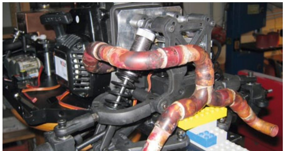
Die aus Kupferfittings hartgelötete Auspuffverlängerung wird nach dem Erkalten noch angepasst und gerichtet
