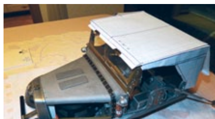
Maß nehmen: Ein provisorisches Verdeck für das Fahrerhaus wurde mit Millimeterpapier gefaltet, davon ließen sich dann die Maße abnehmen
