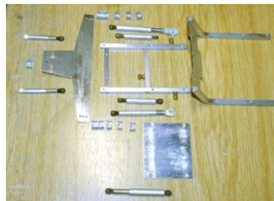
Die Einzelteile der Anlenkung des Frontschildes bereit zum Lackieren
