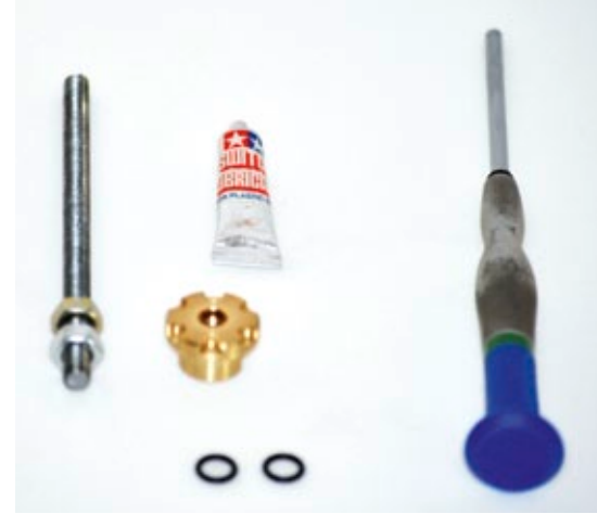
Mit Switch Lubricant von Tamiya wurden die O-Ringe vor der Montage im Zylinder eingefettet
