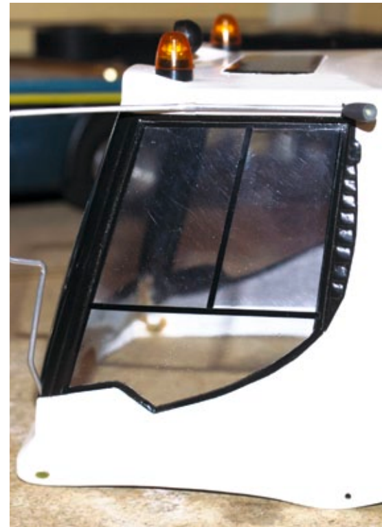
Nach dem Entfernen des Klebebands zeigt sich das Fahrerhaus im zukünftigen Kleid. Sauberes Abkleben zahlt sich durch ein nahezu perfektes Ergebnis aus
