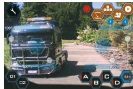
Livebild von der Kamera. Die beiden Joysticks mit den Trimmhebeln befinden sich mittig. Oben rechts finden sich Startknopf und Kameraschalter. Unten links befinden sich die zwei Manöverschalter. Rechts unten kann man die Betriebsspannung ablesen
