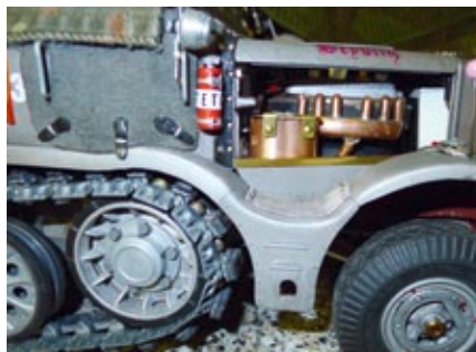
Das Trittbrett am Kotflügel wurde vorbildgetreuer mit einem Gitter gestaltet. Auch lässt sich der Motorraum jetzt seitlich öffnen und ein Motordummy ist zu sehen
