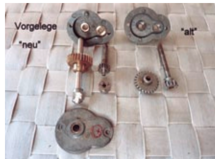
Vergleich: Vorgelege neu (links) und alt. Es kamen drei Kugellager sowie gelaserte Zahnräder mit einem Modul von 0,7 Millimeter zum Einsatz
