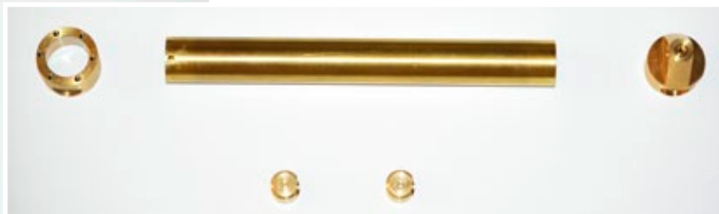
Die zu verlötenden Einzelteile des Zylinderrohrs aus Messing
