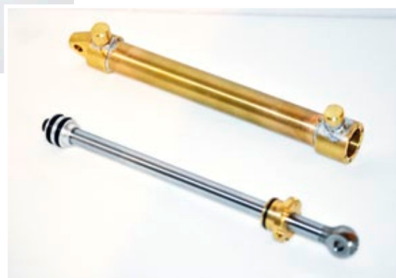
Kolben und fertig verlötetes Zylinderrohr. Letzteres ist allerdings noch nicht verschliffen
