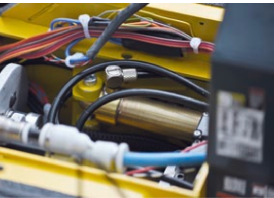
Der Zylinder eingebaut in Fumotecs Bell B50D. Hier übernimmt er die Lenkfunktion
