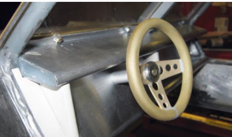
Das Lenkrad aus gebogenem Messingrohr wird von einer angepassten Innensechskant-Zentralschraube gehalten
