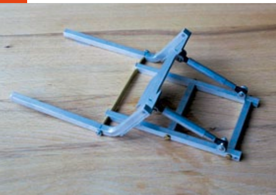
Die Anlenkung für das Räumschild im Rohbau. Noch ist viel zu tun, aber der Anfang ist gemacht
