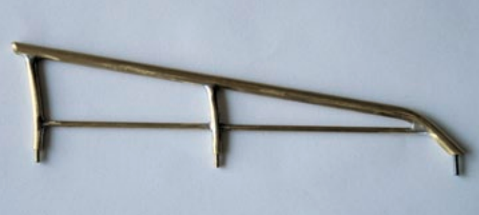
Der Rohbau der Reling. An den ersten beiden Streben sieht man die aufgeschnittenen Gewinde, an der letzten die eingedrehte Gewindestange
