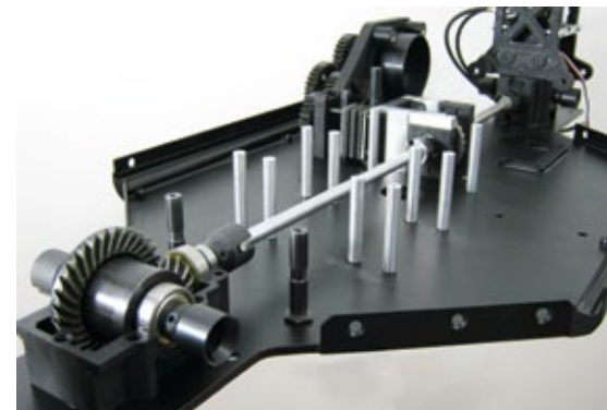
Basis des Fahrzeugs ist eine Bodenplatte aus 5-Millimeter-Aluminiumblech, hier zusammen mit dem fertigen Antriebsstrang. Die paarweise angeordneten Stifte sind die Halter für die Lenkservos
