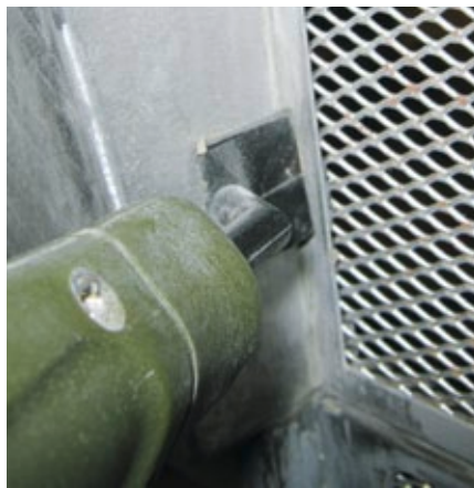
Das richtige Werkzeug: Mit dem Schleifpen erzeugt man auch in den Ecken ein brauchbares Finish
