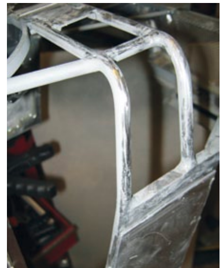
Der grundierte Rohbaurahmen wurde an den Klebestellen wieder blank geschliffen und Schritt für Schritt mit 0,8-Millimeter-Aluminiumblech beplankt
