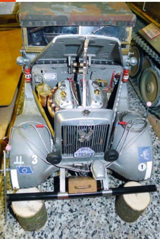
Blick in den Motor. Auch zu sehen: Die neu installierte Stoßstange
