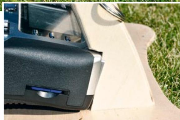
Die Trägerteile mit der Aufnahme des Senderbodens
