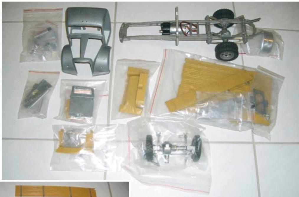
Die Vorderachse und der Rahmen mit Hinterachse und Motor-Getriebe-Einheit sind bereits vormontiert
