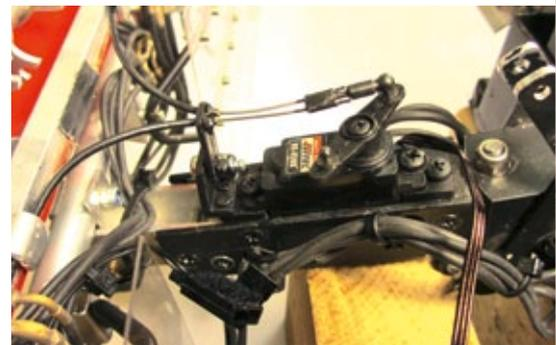
Montage von Servo und Bowdenzug für die Seiten-Finisher im Hubarm
