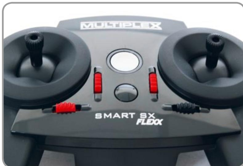
Im Zentrum sitzen neben der zentralen, mit einem Leuchtring eingefassten Powertaste noch die sogenannte Multifunktionstaste, drei rote Tastenwippen zum Steuern von Sonderfunktionen (ein Dreistufen- und zwei Zweistufen-Schalter) sowie eine schwarze Tastenwippe zur Trimmung der Lenkung
