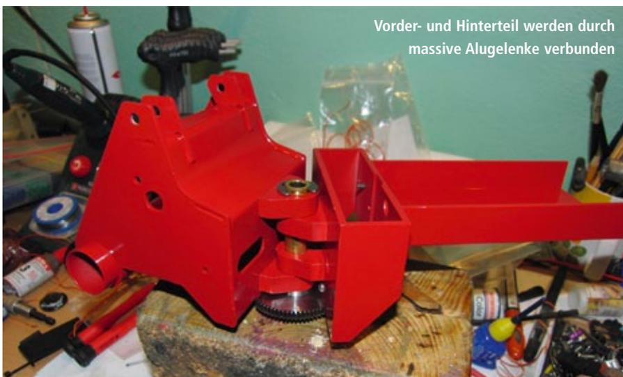
Vorder- und Hinterteil werden durch massive Alugelenke verbunden
