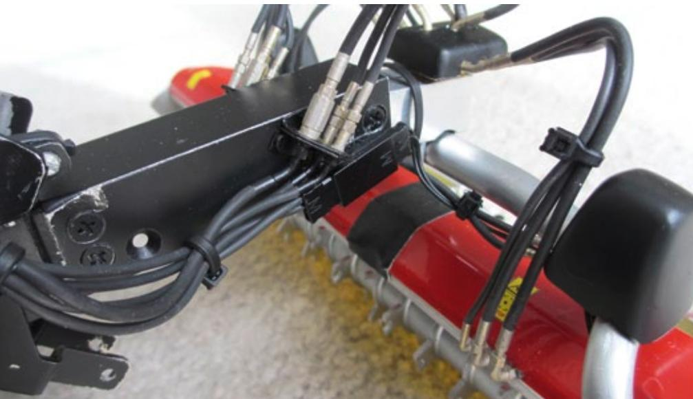
Trennstelle der Hydraulikanschlüsse für die Demontage
