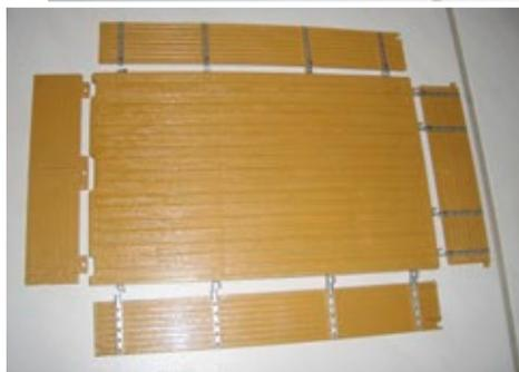
Die Ladefläche und die Bordwände sind aus Kunststoff in Holzoptik und die Scharniere und Bordwände aus dünnem Alu-Blech
