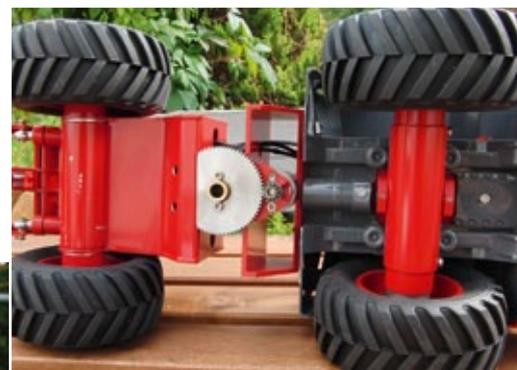
Ansicht von unten: Gut zu erkennen ist hier der Ausschnitt aus dem Kotflügelteil, um die Pendelachse zu befestigen
