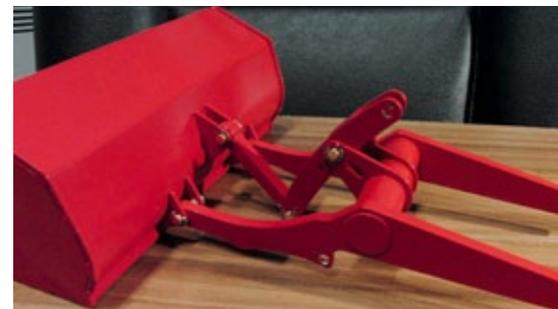
Das komplettierte Hubgerüst ist fertig zum Anbau
