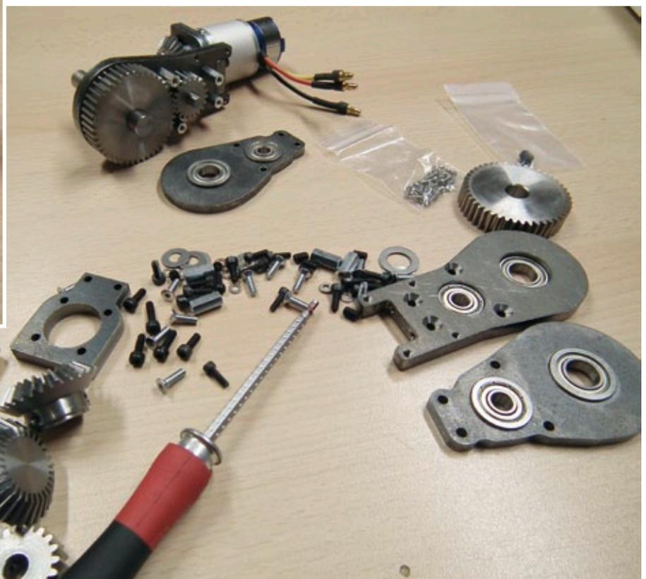
Aus vielen Einzelteilen bestehen die beiden Antriebseinheiten für die Ketten
