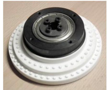
Drehkranz montiert und die Verkleidung probehalber aufgesteckt
