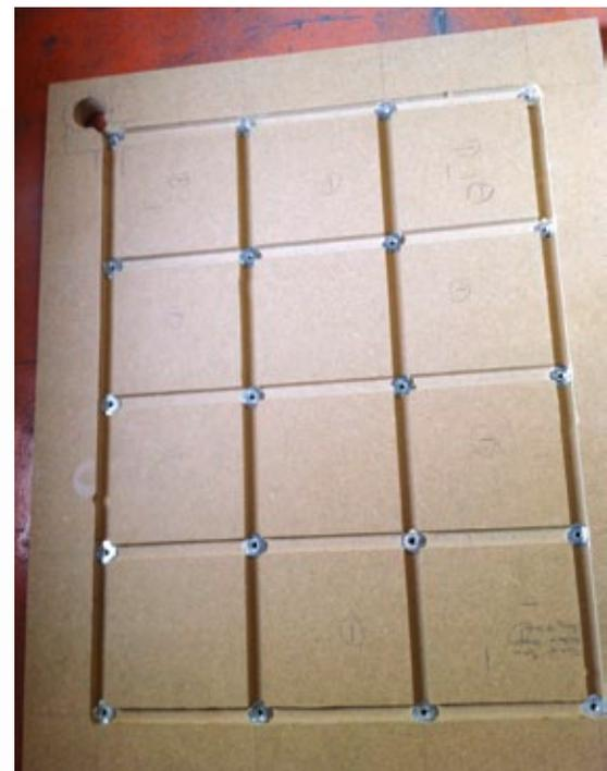
Die Vakuumplatte von unten. Der Unterdruck wird durch einen einfachen Staubsauger erzeugt
