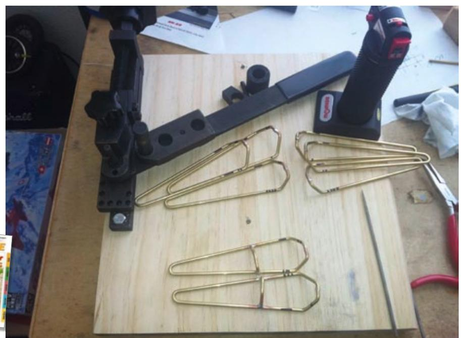
Mit dem Biegegerät lassen sich die Halterungen präzise herstellen
