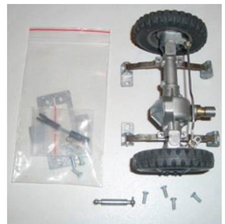
Die Vorderachse mit den Kleinteilen für die Montage am Rahmen und der Befestigungsrahmen für das Lenkservo
