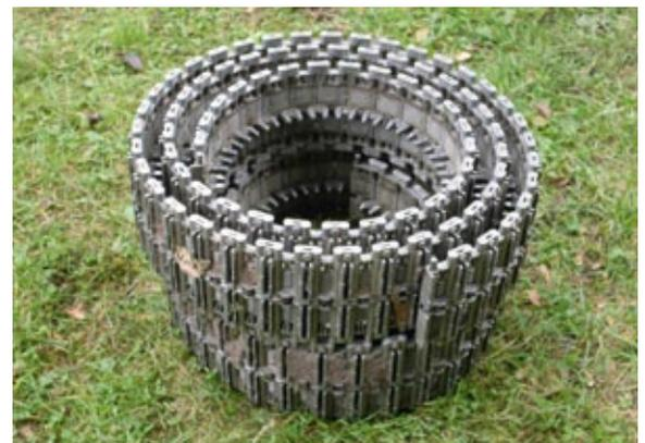
Die Kettenglieder aus legiertem Stahl sind in einem speziellen Winkel montiert, damit das Prinzip der „lebenden Kette“ vorbildgetreu nachempfunden werden konnte
