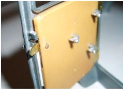
Der Riegel verschwindet beim Drehen nach unten hinter der Türverkleidung. Dazu habe ich an der Kante der Innenverkleidung eine Aussparung angebracht
