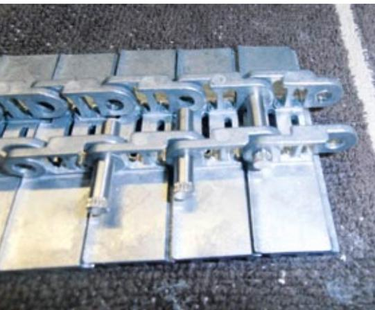
Zuerst werden die Bolzen in die Ketten eingeschoben und später eingeschlagen
