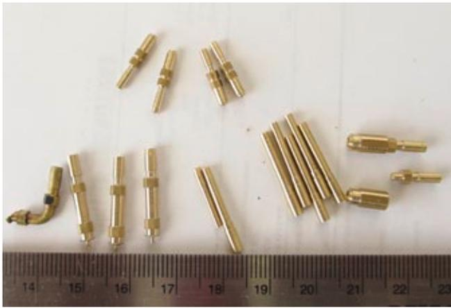
Um die kleinen Messingteile ohne Bruchgefahr biegen zu können, erhitzt man sie am besten mit einem kleinen Gas-Lötbrenner
