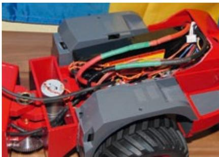
Im hinteren Teil der Maschine ist genügend Platz, um die Elektronik und den Akku unterzubringen
