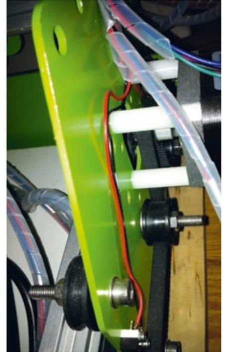
Der Zahnriemen wird über Umlenkrollen geführt
