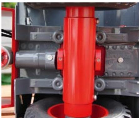
Die montierte Pendelachse. Das Kunststoffunterteil wurde mit zwei Schrauben am Chassis befestigt. Bohren muss man selbst
