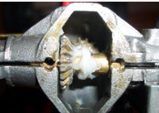
Die Winkelgetriebe der angetriebenen Vorder- und Hinterachse sind aus Messing und gut gefettet
