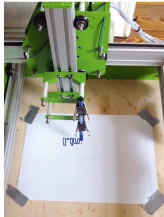
Sicherheitshalber wird eine „Fräsung“ testweise mit einem Stift durchgeführt
