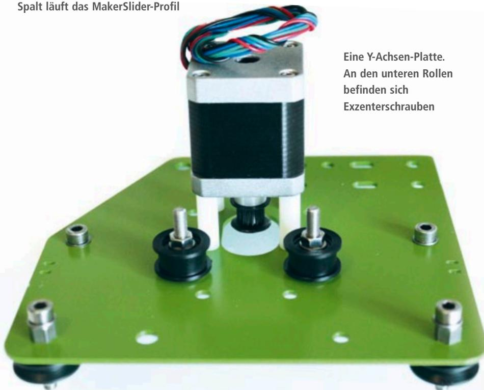
Eine Y-Achsen-Platte. An den unteren Rollen befinden sich Exzenter-schrauben
