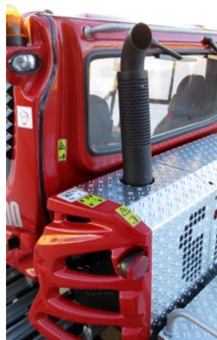
Auspuff aus 3D-Sinterdruck
