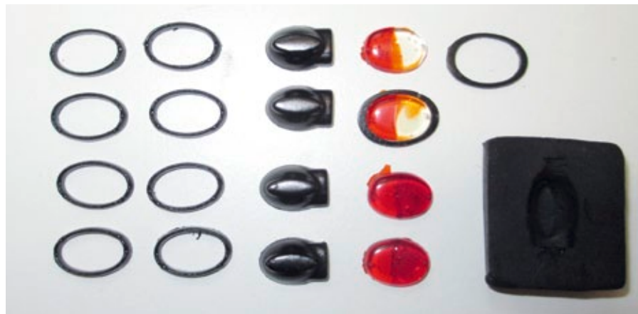
Fassungen für die Dachscheinwerfer, Gehäuse und Gläser für die Kombileuchten
