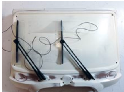
Vormontage der Scheibenwischer und Anbringen der Wischerblatttheilung
