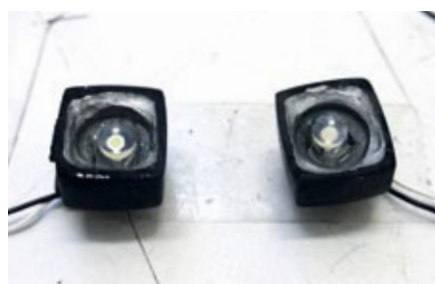
Gehäuse mit abgeflachter LED für die Seitenstrahler
