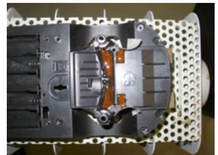
Die Bodenplatte wurde im Bereich der Vorderachse mit Pattex Stabilit verstärkt
