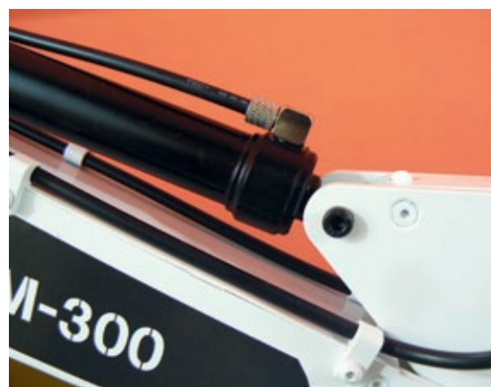
Am ganzen Bagger sind nur Inbus-Schrauben verwendet worden. Auf die sonst typischen Kreuzschrauben hat man der Optik halber verzichtet
