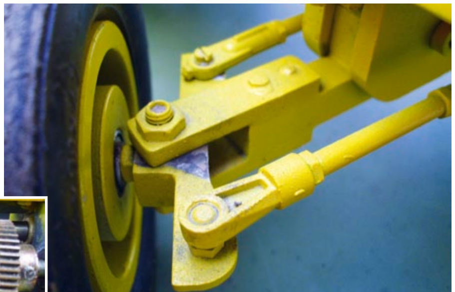
Mit Madenschrauben kann man die Lenkachse nachstellen
