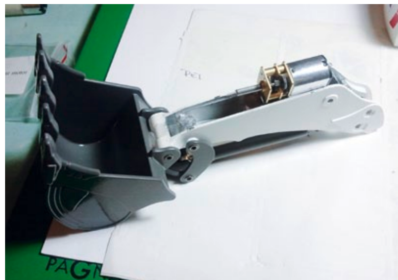
Der Getriebemotor wurde für den Stielarm angepasst
