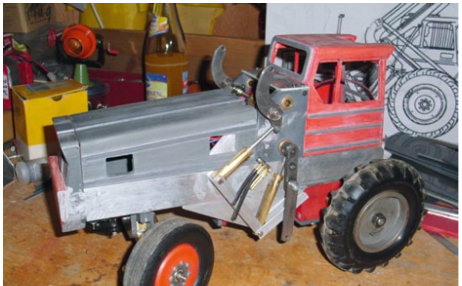
Die Karosserie steht. Ein Gegengewicht versteckt sich an der Motorhaube
