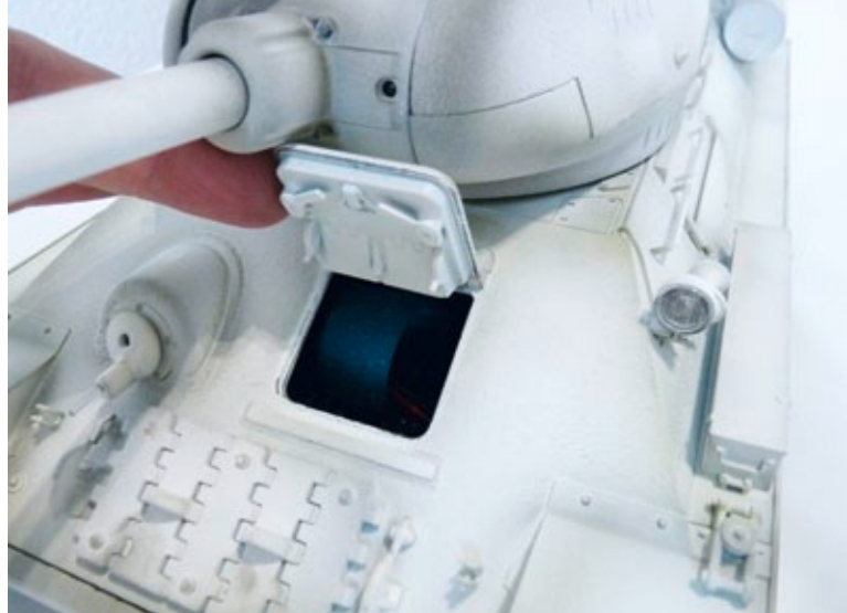
In der Lampe wurde die LED für die Bereitschaftsanzeige (Modell an) integriert. Ein weiteres sehr realistisches Detail ist die per Hand zu öffnende Fahrerluke mit nachgebildeter Innenseite
