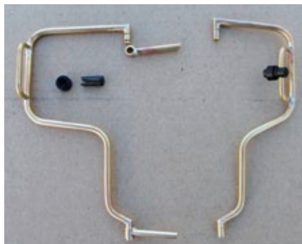
Fertig verlötete Spiegelhalterungen mit Befestigungsteilen
