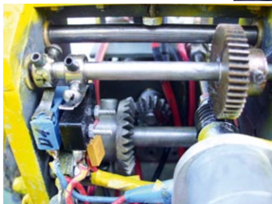
Zu sehen ist die Hub- und Kippmechanik mit Endschaltern
