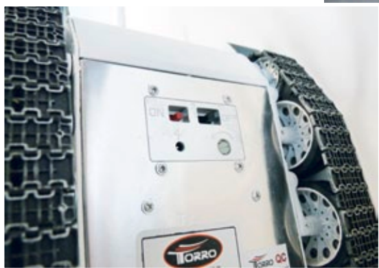
Ladebuchse, Rauchgeneratorschalter (rot) sowie Hauptschalter und Lautstärkereger finden sich an der Unterseite des T34/85. Daher sind Wasserdurchfahrten zu vermeiden
