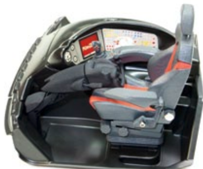
Nach und nach kommen Zubehörteile zur Komplettierung hinzu: hier zum Beispiel die Lenksäule und die Sitze
