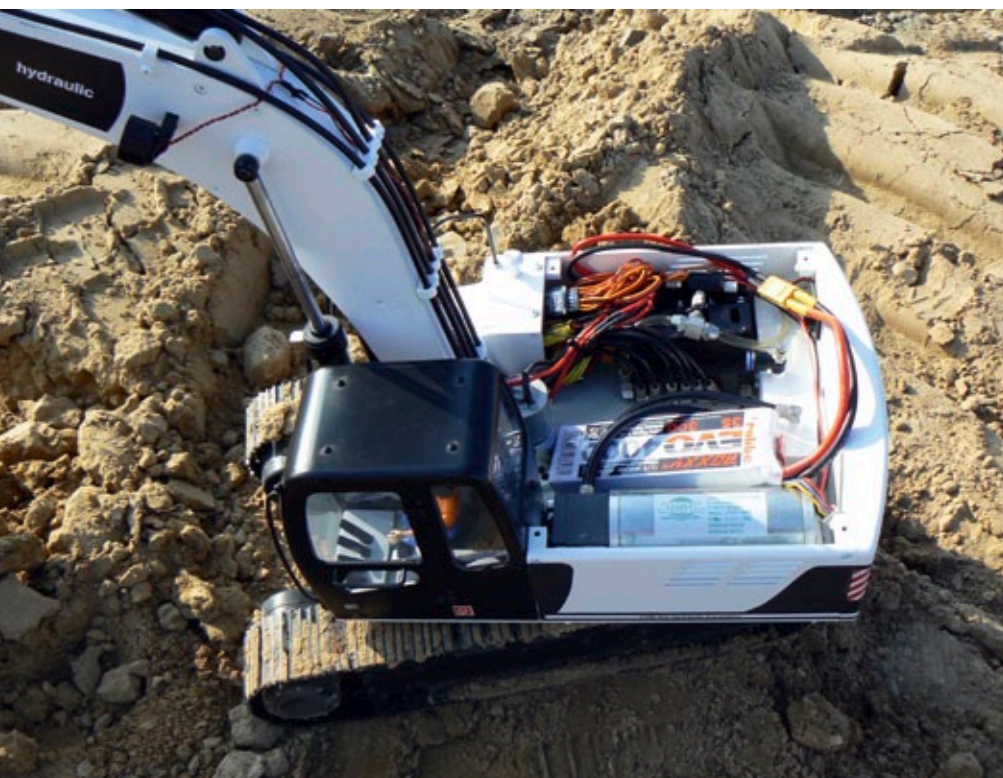
Ein Blick ins Innere des Baggers: Neben Akkufach und Motor findet sich auch der Hydraulikzylinder, der den Baggerstiel bewegt
