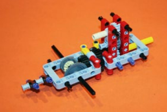
Gut zu erkennen ist die Aufhängung des Hinterwagens mit Differenzial
