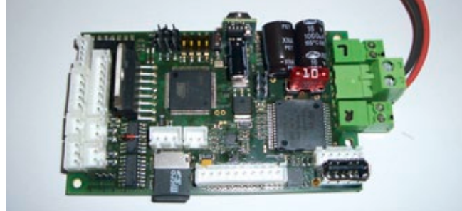
Das FO-Modul ist rund 107 x 55 x 25 Millimeter (mm) groß und damit gut in einem Modell positionierbar
