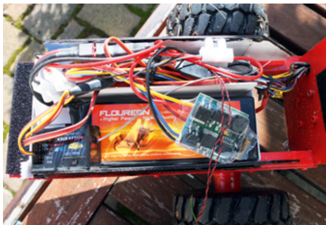
Zwei Fächer trennen Regler und Fahrakku vom Vorderwagen
