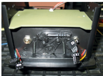
Der Heckmotor nimmt den Ein-aus-Schalter und die Ladebuchse auf. Somit ist später alles durch die Motorklappe erreichbar
