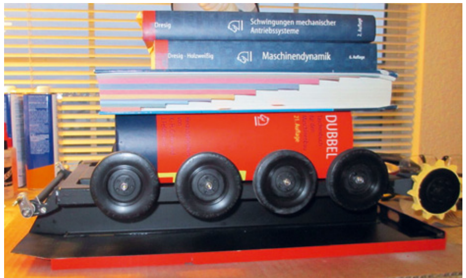
Das Fahrgestell muss mit der Plattform verklebt werden. Für den nötigen Druck sorgt geballtes Wissen
