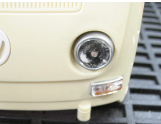
Die Frontscheinwerfer werden mit passenden Leuchtdioden zum Strahlen gebracht
