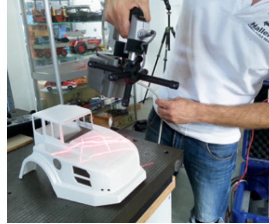
Das Fahrerhaus wird per Laser vermessen, damit weitere Teile passgenau angefertigt werden können
