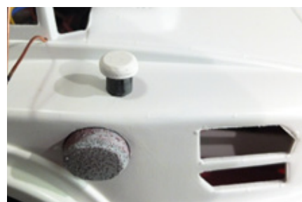
An der Beifahrerseite werden die selbstgebauten Luftfilterteile eingepasst
