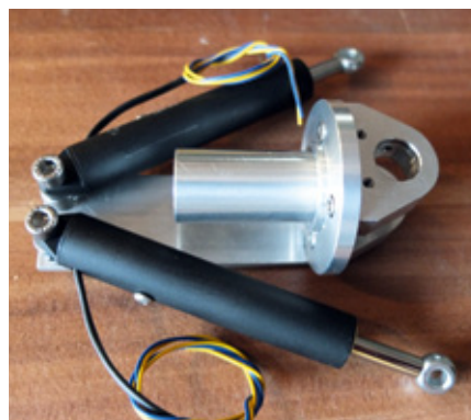
Die Lenkzylinder finden auf einer dicken Halteplatte Platz
