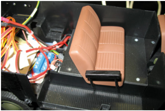
Unter der hinteren Sitzbank findet die Elektronik Platz. Dafür wurde diese etwas erhöht. Für die Optik gab es für die vordere Bank einen neuen Anstrich und eine Armlehne
