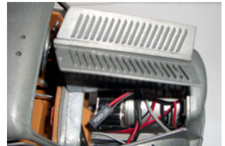
Die beiden Motorklappen lassen sich vollständig öffnen, sodass der Motor leicht zugänglich wird
