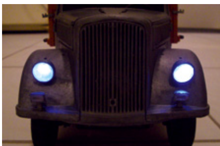
Das ist nicht vorbildgetreu: Die Hauptscheinwerfer sind mit kaltweißen LED bestückt, welche an moderne Xenon-Lampen erinnern
