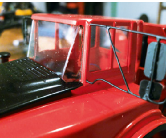
Die Scheiben des Führerhauses konnten dank des digitalen Vermessens fast unbearbeitet eingepasst werden
