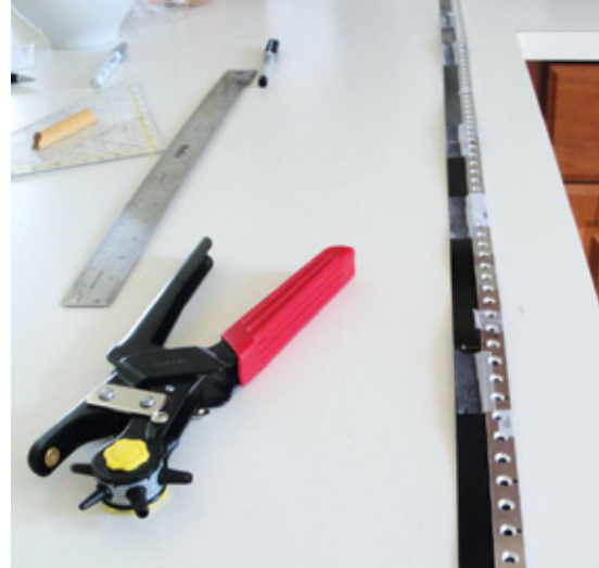
Fleißarbeit: Mittels einer CNC-gefertigten Schablone werden unzählige Löcher in die Kettenbänder gedrückt
