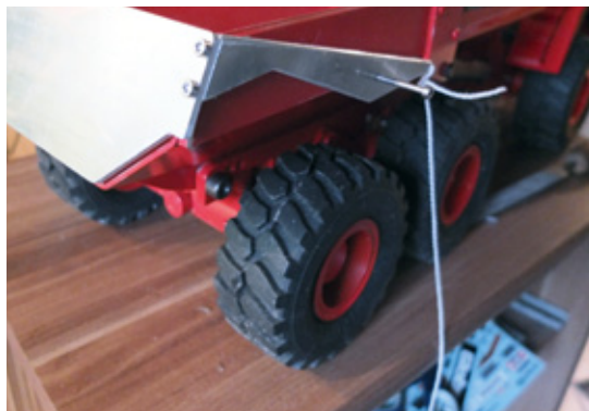
Die Zwangsöffnung wurde mit Nylonflechtschnur und Flachkabelschuhen realisiert
