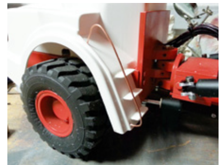
Die Tritte und das passende Geländer zur Kabine wurden aus PS-Plättchen und Kupferdraht gefertigt
