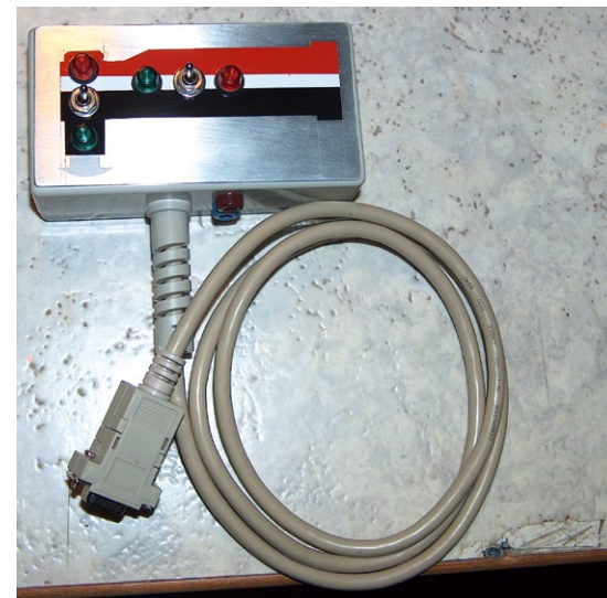
Der Steuerkasten zum Einstellen der Endschalter für die Stützen lässt sich via Kabel mit dem Modell verbinden
