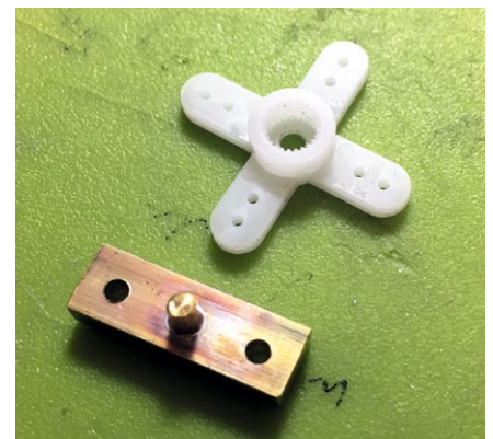
Für die Servoarme wurde eigens eine Bohrlehre angefertigt
