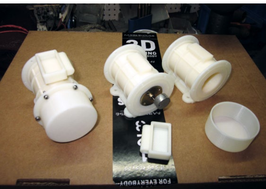
Ein Elektromotor im Inneren des 3D-gedruckten Rüttlers treibt die Unwucht im Lüfter an
