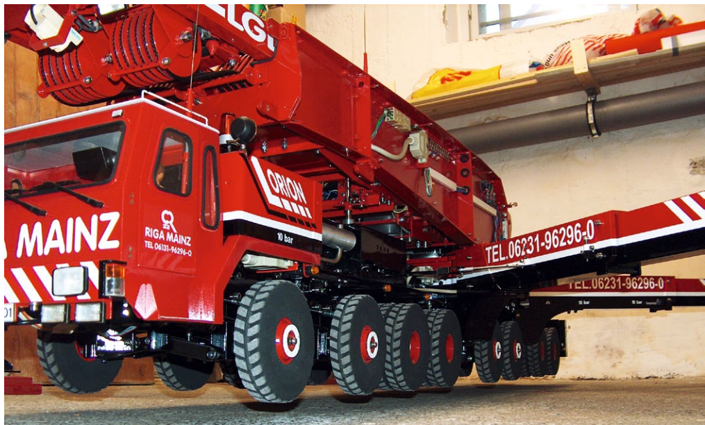
Bei ausgefahrenen Stützen wird das gesamte Modell einige Zentimeter nach oben gehoben
