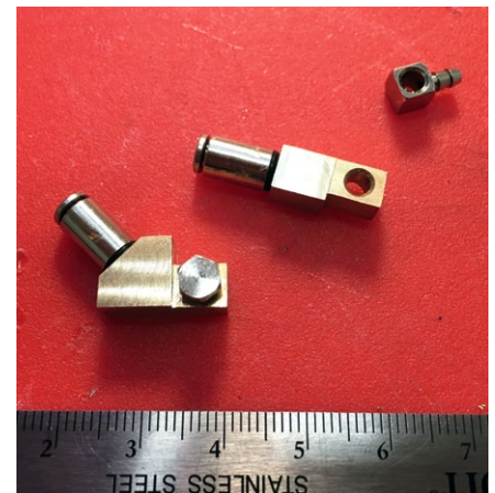
Für den Hochdruckschlauch wurden spezielle Anschlüsse hergestellt
