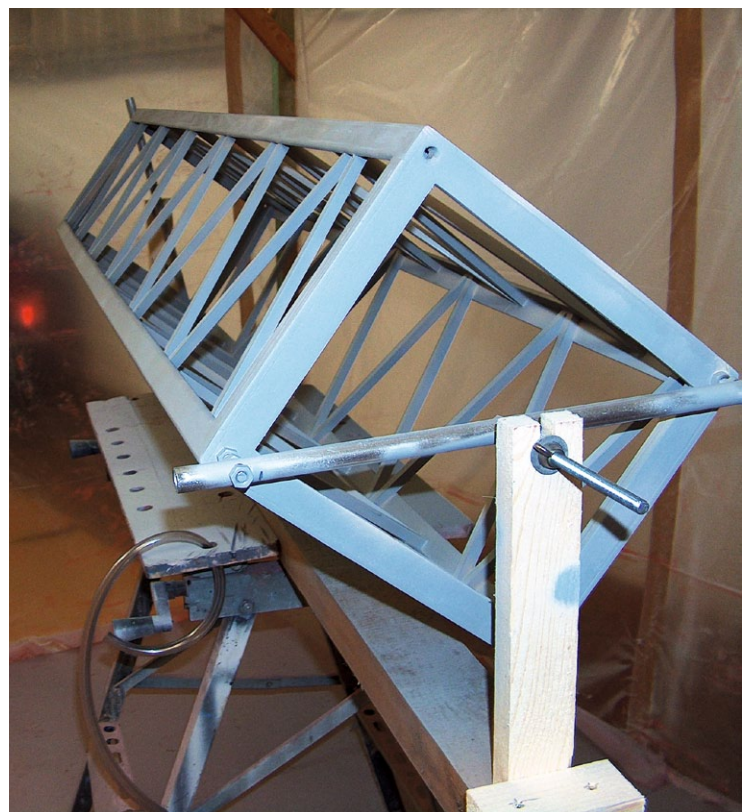
Die Lackierung erfolgte in einer eigens aufgebauten Spritzkabine
