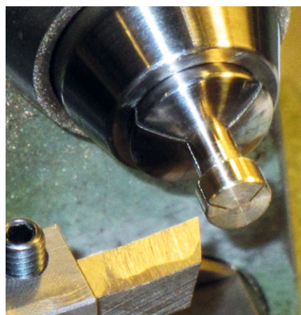
Abbildung 15: Drehen von Messing-Teilen: immer Spanwinkel 0 Grad, also eine waagerechte Oberseite des Drehstahls
