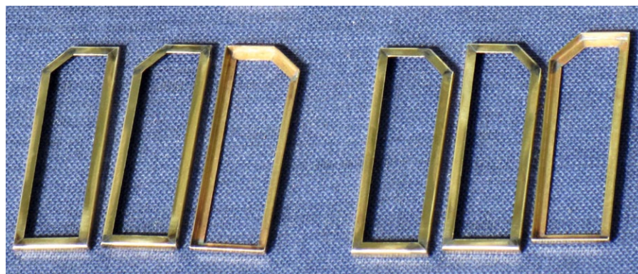
Abbildung 18: Sauber verputzte Rahmen, kein Stück überschüssiges Lötzinn
