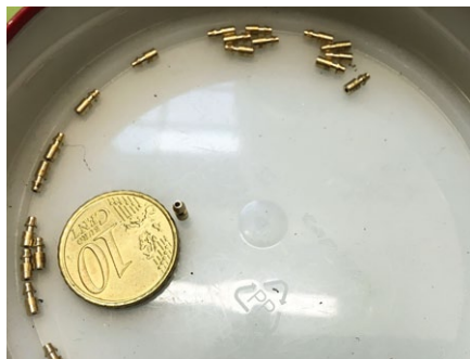
Die Anschlussnippel sind aus Messingdraht mit 2 Millimeter Durchmesser gefertigt
