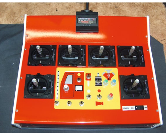
Der Sender FM 6014 wurde für die Bedienung des Kranoberwagens gewählt. Für den Unterwagen gibt es einen weiteren Sender
