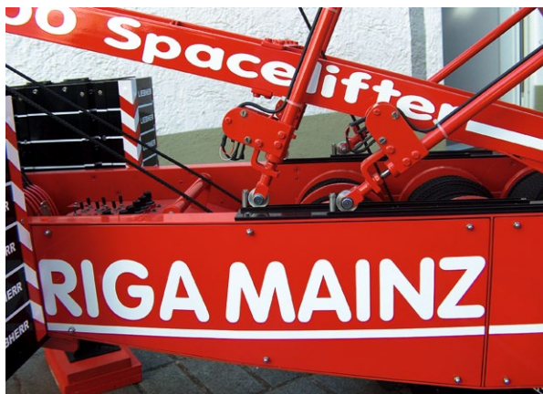
Die Rückhaltesicherungen am Derrick und Hauptmast. Die Endschalter werden mechanisch betätigt
