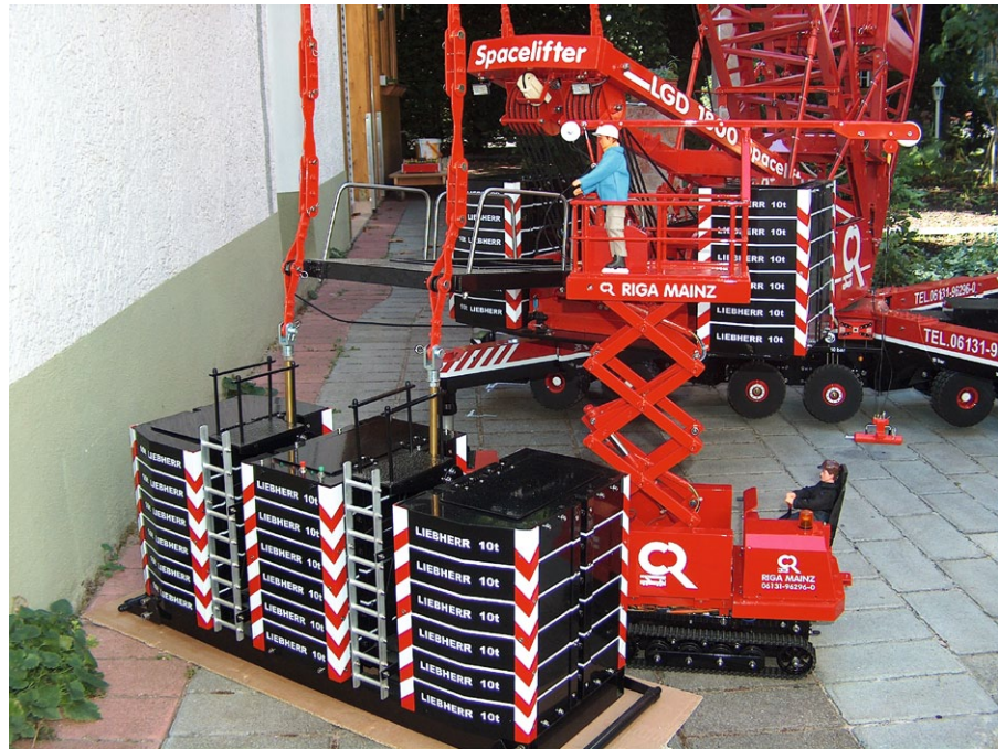
Der Schwebbeballast wird über einen Getriebemotor angehoben
