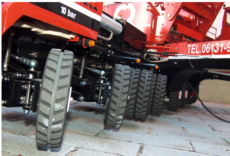
Sechs der insgesamt acht Achsen des Modells sind gelenkt
