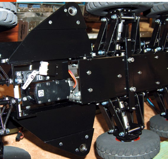
Das Lenkservo ist vorne zu sehen, daneben die Halterungsbleche für die Stützen
