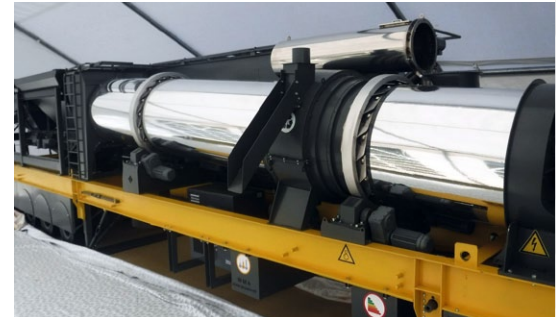
Die Mischtrommel ist nun chromglänzend, ebenso der (abgeklappte) Schornstein
