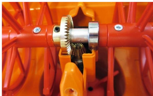
Version 1 mit Kegelradgetriebe
