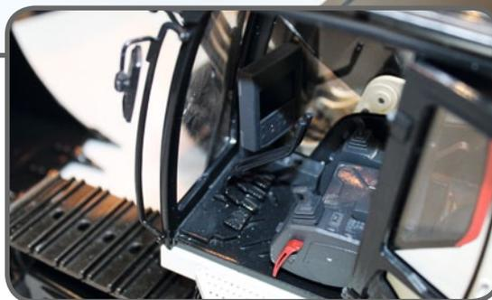
Selbst die Fahrerkabine ist aus Alu gefräst und gedreht, die Tür kann geöffnet werden. Das Display kann je nach Wunsch an- und ausgeschaltet werden
