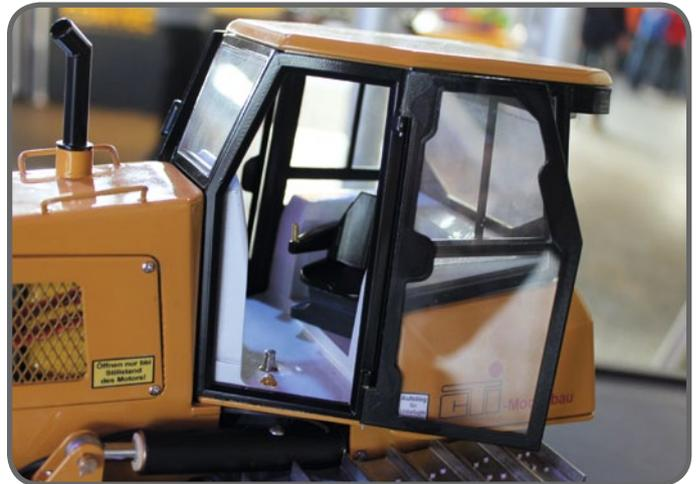
Die Kabine entsteht per 3D-Druck und wird als Bausatz zum Zusammenkleben ausgeliefert
