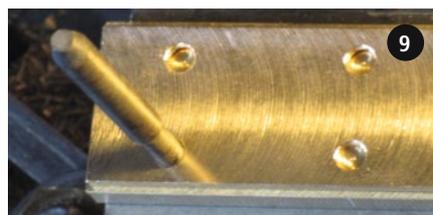
Selbst gedrehte und gehärtete Zentrierkörner aus Silberstahl in 0,1-mm-Durchmesser-Stufungen sollte jeder ambitionierte Eigenbauer haben
