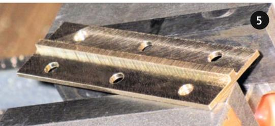
Die gesamte obere Seite muss in einer Einspannung fertiggefräst werden. Dabei auch die sechs Löcher per Koordinaten-Bohren einbringen
