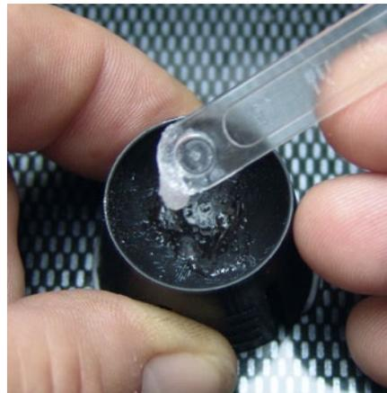
Aus Sekundenkleber und CA-Booster entsteht eine klebrige Masse, die sich zum Modellieren und Fillern hervorragend eignet
