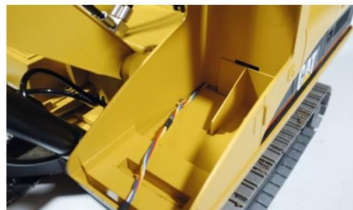
Die Kabelführung in den Maschinenraum. Hierzu muss kein Material entfernt werden
