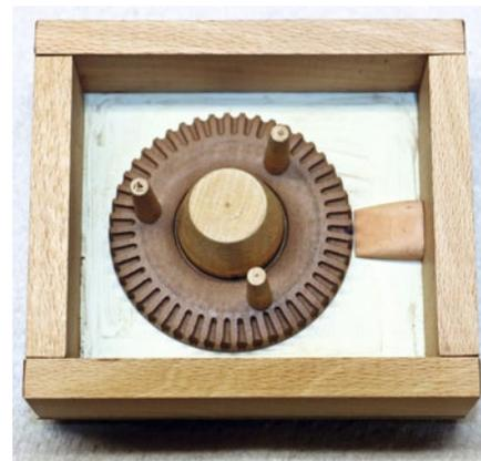
Formkasten für den Negativabguss aus Gips für eine Reifenhälfte
