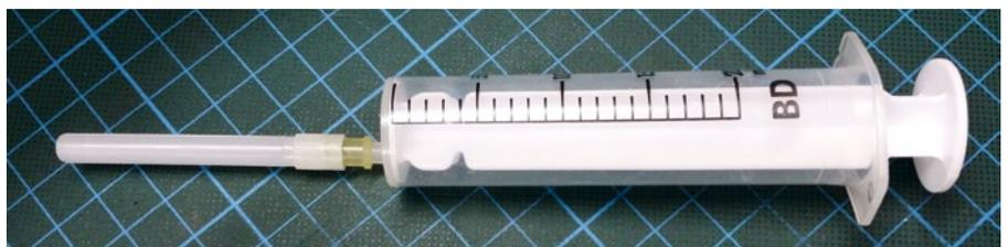
Eine handelsübliche Kolbenspritze und Kanüle (gelb) aus der Apotheke reichen für die Befüllung des Druckteils mit Harz aus
