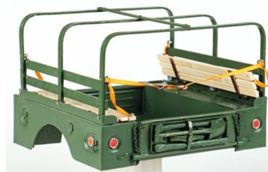
Aufbau mit Bänken und Dachspriegeln. Gut zu sehen auch der Werkzeughalter für Axt, Pickel und Schaufel in der Heckklappe
