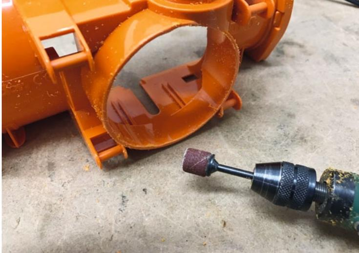
Aushöhlen der Bruder-Schleuder mit Säge- und Schleifwerkzeugen
