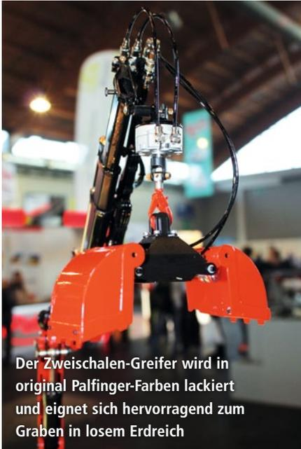
Der Zweischalen-Greifer wird in original Palfinger-Farben lackiert und eignet sich hervorragend zum Graben in losem Erdrich
