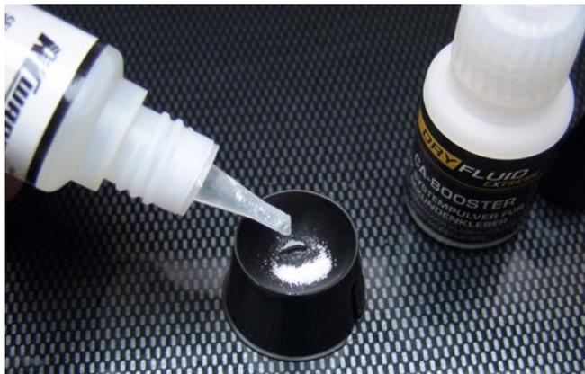
Sekundenkleber wird zu etwa gleichen Anteilen mit CA-Booster gemischt. Nach wenigen Minuten setzt ein Gelierprozess ein und der Powerklebstoff kann vergleichbar mit Fünf-Minuten-Epoxi verarbeitet werden
