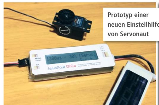
Prototyp einer neuen Einstellhilfe von Servonaut
