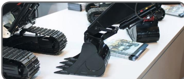
Ein Schnellwechselsystem sowie der Stahllöffel mit gegossenen Zähnen sind im Lieferumfang enthalten
