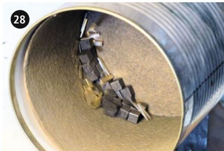
Schon jahrelang im Gebrauch: meine Entgratungs-Trommel. Die Büchse hängt mit dem Boden an einem kleinen Getriebemotor
