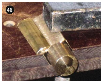
Das Prisma mit der Rundung wird zum Löten mit einer Reißnadel festgehalten
