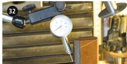
Zu jeder Fräsmaschine gehört ein Feinmesstaster
