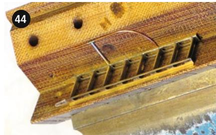
Ein Lötprisma aus Pertinax (verträgt gut die Löt-Temperaturen) fräst man mit einem 45 Grad schräggestellten Walzenstirnfräser
