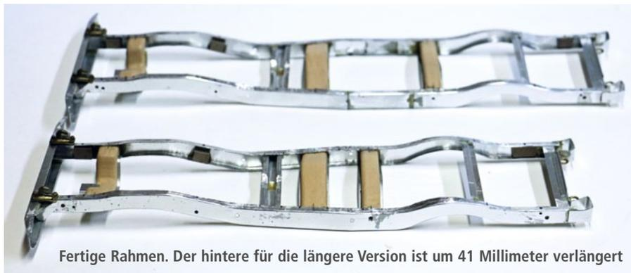
Fertige Rahmen. Der hintere für die längere Version ist um 41 Millimeter verlängert
