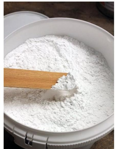
Der pulverförmige Wollastonit-Füller sollte trocken gelagert werden
