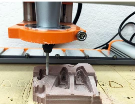
Fräsen der Tiefziehform auf der Stepcraft-Maschine
