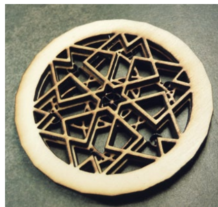
Abbildung 12: Filigranste Strukturen lassen sich mit Hilfe eines Lasers produzieren – mit einer CNC-Fräse wäre das nicht machbar
