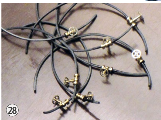
28 Die Gummifäden haben 0,45 Millimeter Durchmesser. Da kann man sich vorstellen, wie winzig diese Ventile sind
