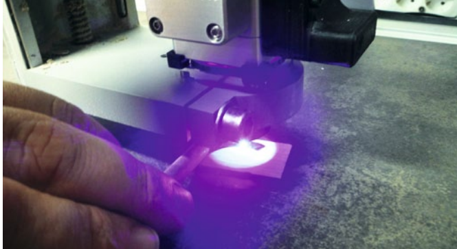
Abbildung 9: Bildeindruck ohne Schutzeinrichtung; die Kamera ist durch die hohe Lichtintensität übersteuert – dem Auge ginge es ähnlich, nur würde es im Gegensatz zur Kamera Schaden nehmen
