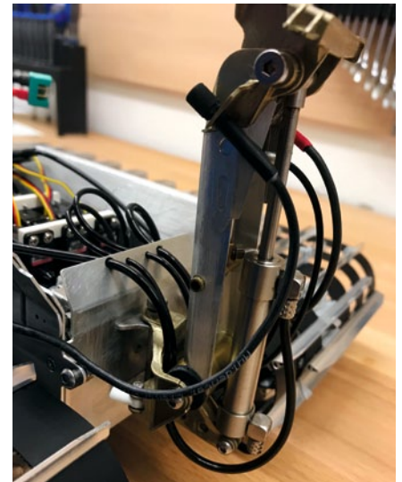
Der robbe-Zylinder hebt die Fräse mit Leichtigkeit an
