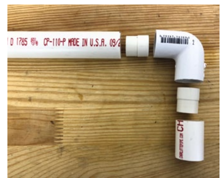
Verbinden von Rohrstücken
