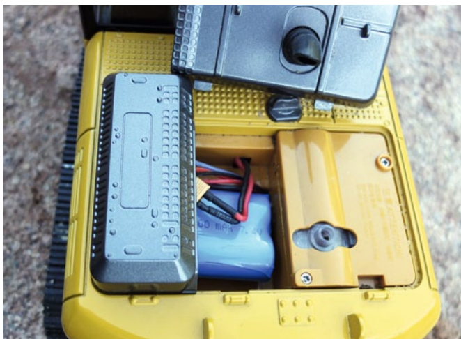
Der Akkuschacht und der Behälter für das Rauchöl sind gut zugänglich
