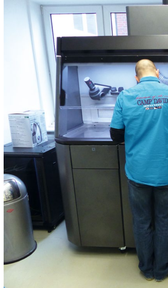
Neben dem Drucker selbst gibt es optional auch die Basisstation, an der die Teile nicht nur schnell und sauber vom überschüssigen Pulver getrennt werden, sondern auch ein Vermischen mit neuem Pulver eingestellt werden kann. Die eckigen Kanister unten rechts enthalten eben dieses neue Pulver
