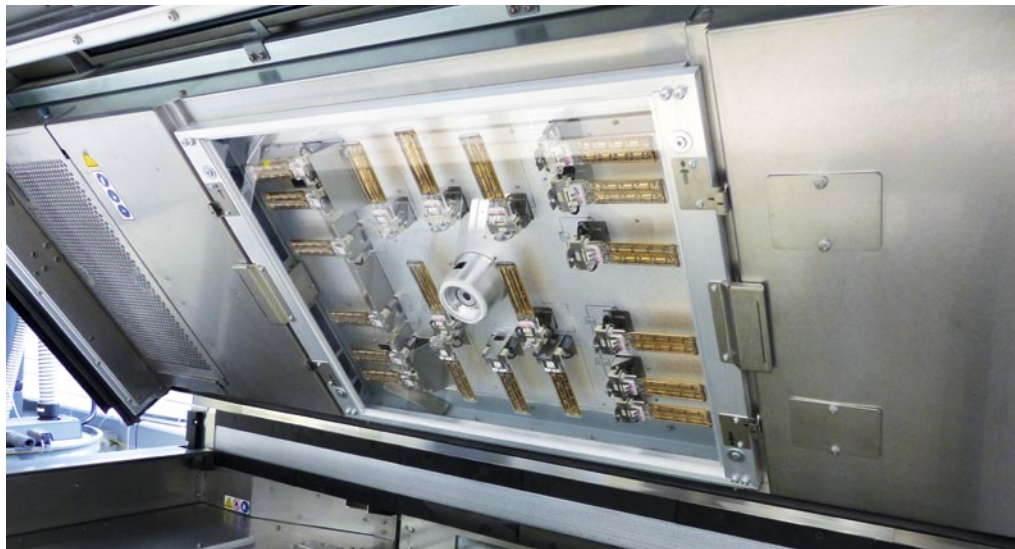
Im Deckel des Geräts befindet sich die Lichtenanlage zur gleichmäßigen Erwärmung der gesamten Oberfläche. Der (gerade leere) Bereich darunter beherbergt normalerweise die Box, in der die Schichten verschmolzen werden
