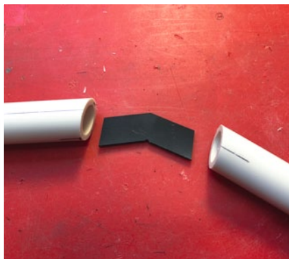
Winkelstück zur Verstärkung der Verklebung
