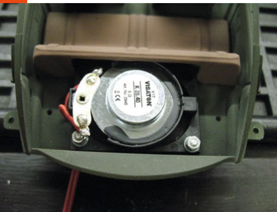
Ein passender Lautsprecher für das Soundmodul wurde im Innenraum montiert
