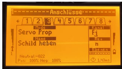
Menüpunkt für die Ventilfunktion „Heben“ bei der verwendeten ScaleART-Fernsteuerung Commander SA-1000
