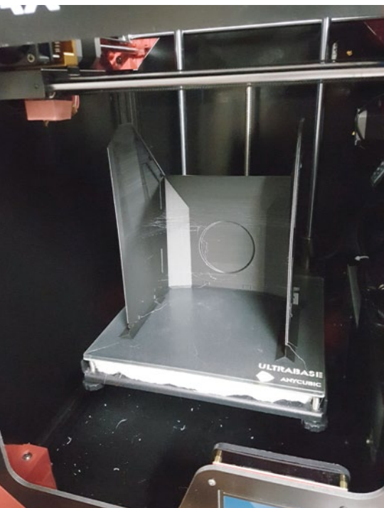
Das Kabinen-Teil ist frisch gedruckt. Es ist kaum noch Platz im Druckraum
