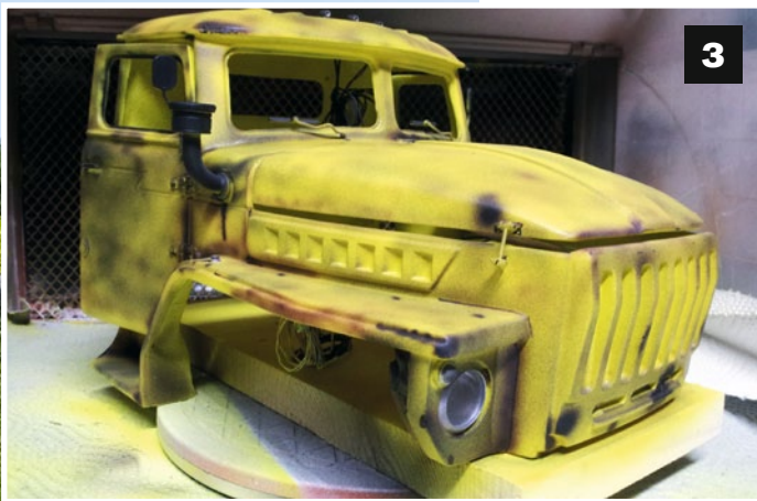
1) Die Basis des Modells ist der bekannte Beast-Bausatz von RC4WD. 2) Die Grundlage der späteren Farbgestaltung ist ein kräftiges Gelb-Ton, der sorgsam aufgetragen wurde. 3) Per Airbrush wurden Gebrauchsspuren hinzugefügt, um den gewünschten Used Look zu erhalten. 4) Auch wenn man es auf den ersten Blick nicht sieht, im Inneren von Aufbau und Bauwagen wurden jede Menge tolle Details realisiert
