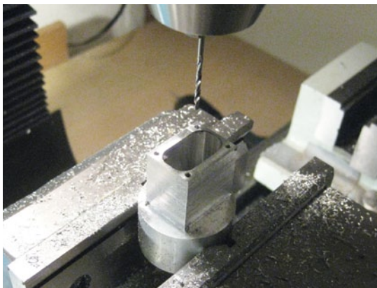
Gehäusefräsen für die Schnecken-Zahnrad-Kombination
