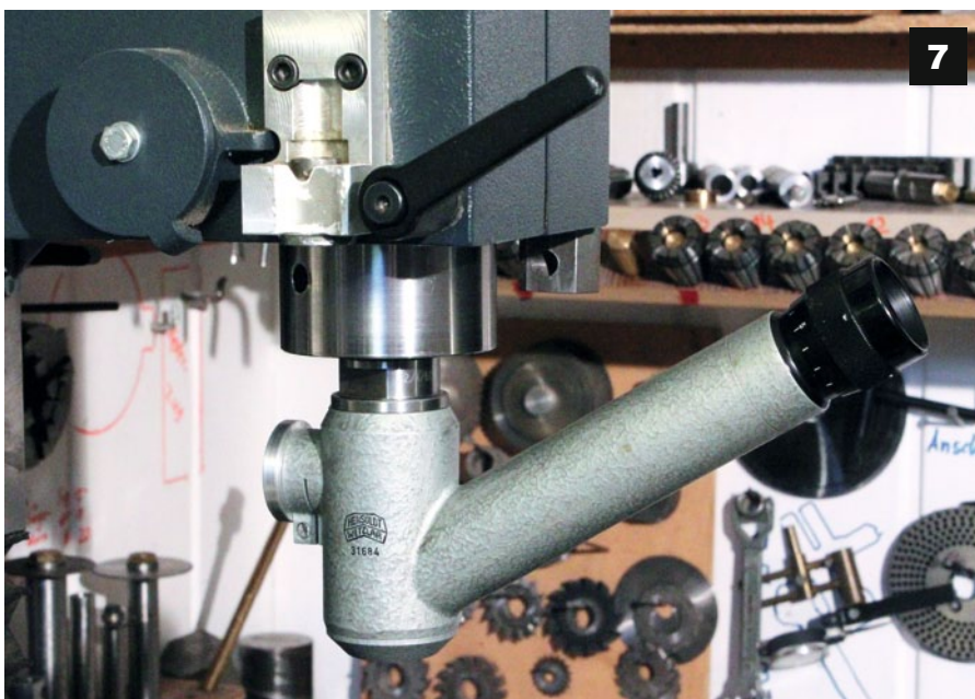
Abb. 5) a = Nullstrich, b = Nullpunkt-Träger. Ich habe viele Jahre mit der Maschine gut gearbeitet. Abb. 6) Mein großes Lob Herr Weers. Abb. 7) Meine Wabeco hat selbstverständlich die bessere Steilkegel-Aufnahme in der Frässpindel. Abb. 8) Das Anfahr-Modul ist auf die Kante einer Beilage gesetzt. Die Anlageflächen sollten exakt senk- und waagrecht sein
