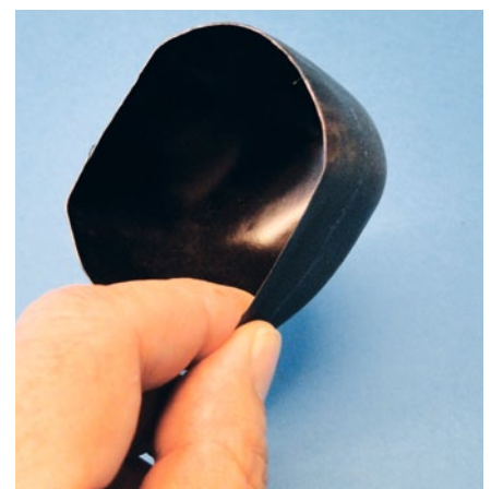
Mit dem Tiefzieh-Verfahren lassen sich dünnwandige, leichte Teile fertigen
