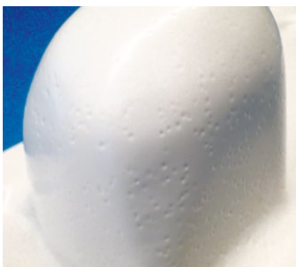
Auch das kam vor: Ein Teil aus Polystyrol-Folie hatte nach dem Tiefziehen diese Pockennarben. Ob die Folie verunreinigt war?
