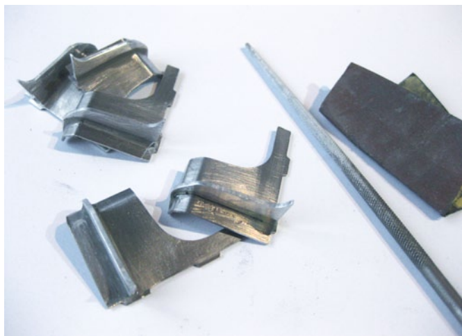
Ein Schleuderrad besteht aus fünf Schaufeln. Vor dem Verkleben auf die Trägerscheiben wurden die Teile verputzt
