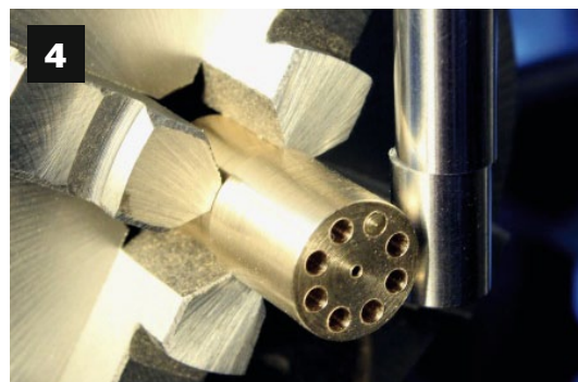
Abb. 1) In einer rechteckigen Platte sollen Bohrungen angebracht werden. Abb. 2) Strichabstände bei Wabeco 0,05 Millimeter. Die Striche sind schon zu breit und der Durchmesser vom Skalenring könnte viel größer sein. Abb. 3) Der Start wird mit „0“ an einem „Anfahrpfeil“ in eine Handskizze eingetragen. Abb. 4) Die Kante eines runden Teils wird im Teilkopf angefahren
