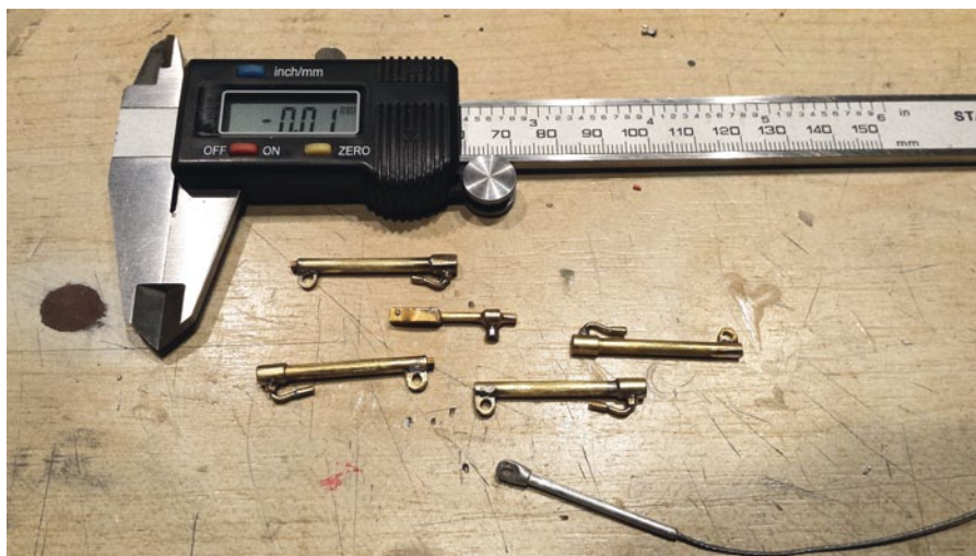
Filigrane Zylinder aus Messing für die beiden Kamine
