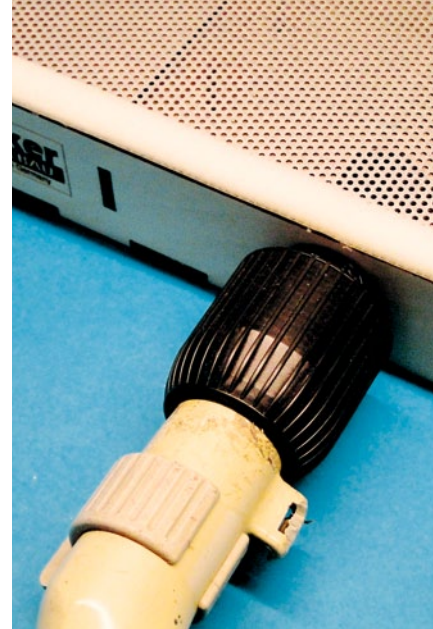
Über den Adapter wird der Staubsauger mit der Box verbunden
