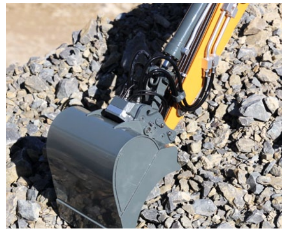
Die Hydraulikanlage arbeitet mit einem Betriebsdruck von zirka 22 bar
