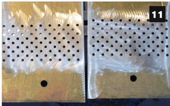
Abb. 11) Beide 0,15-Millimeter-Bleche wurden „im Paket“ mit Pertinax-Auf- und Sperrholz-Unterlage gebohrt. Abb. 12) Das Streichholz macht deutlich, wie klein man dieses wichtige Arbeitsverfahren „veranstalten“ kann
