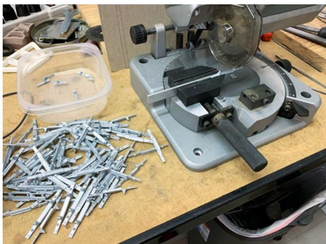
Beim Kettenbau wurden die Spurstege mit der Kappsäge getrennt
