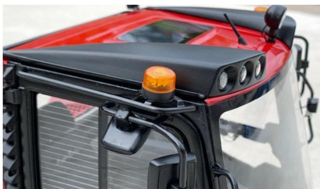
Um auch in Sachen Beleuchtung möglichst nah ans Original zu kommen, baute und kürzte der Autor die Rundumkennleuchten von Pistenking auf die flache Version Comet S um
