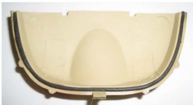
Damit kein Wasser in den Heckraum eindringen kann, ist die Heckklappe mit einer Dichtung ausgestattet
