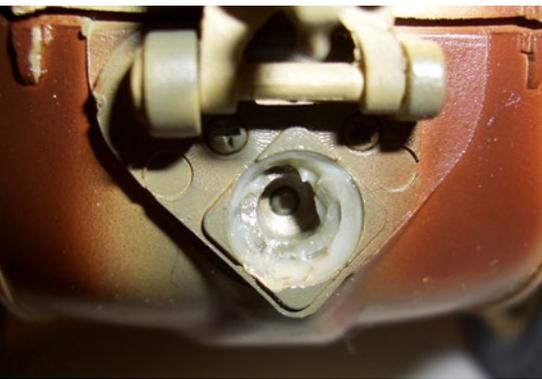
In diese gut gefettete Wellenbuchse rastet der Schraubenantrieb nach dem Absenken ein
