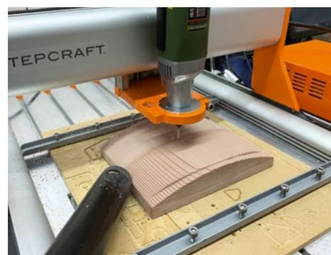
Für die Frontscheibe entstand eine Form auf der Stepcraft CNC-Fräse, die verschliffen, lackiert und poliert werden musste
