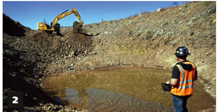
1) Hersteller wie Caterpillar treiben autonome Baumaschinen voran, um den Bergbau sicherer zu machen sowie eine effiziente Produktionsleistung zu gewährleisten. 2) Die Cat Command-Konsole ermöglicht ein Steuern aller Maschinenfunktionen abseits der Maschine, nur in Sichtkontakt
