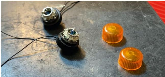
Die Basis für den Umbau stellt eine Pistenking-Rundumkennleuchte dar. Die orangene Kappe ist an diesem Teil nur aufgesteckt und kann abgezogen werden
