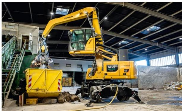
Für den Materialumschlag im Halleneinsatz wurde der elektrisch betriebene Umschlagbagger MH22 entwickelt
