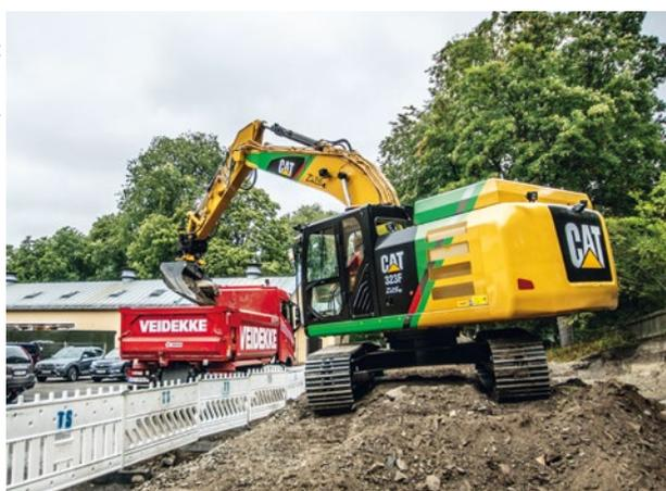
Statt Dieselmotor und Tank sind beim Kettenbagger 323F ZLine Elektromotor, Batteriemodul mit 296 kWh, ein integriertes Ladegerät und verschiedene Steuergeräte verbaut
