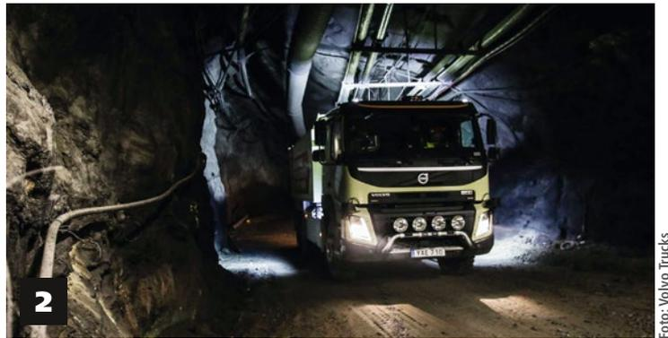
1) Seit 2017 sind in einem norwegischen Bergwerk sechs autonome Volvo FH im Einsatz und transportieren Kalkstein über eine fünf Kilometer lange Strecke. 2) Bereits seit 2016 ist in Schweden ein autonomer Minen-Lkw in einer Erzmine im Einsatz – 1,3 Kilometer unter der Erde
