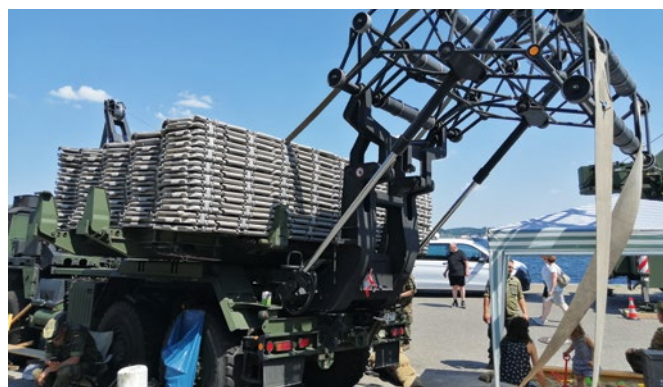
Über die beiden noch lose herabhängenden Überfahrgurte werden die einzelnen Elemente von der Ladefläche gezogen
