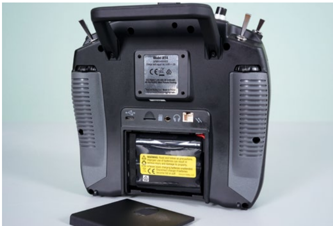
Ein 1s-Li-ion-Akku mit 10.500 mAh Kapazität gestattet viele Stunden Betriebsbereitschaft
