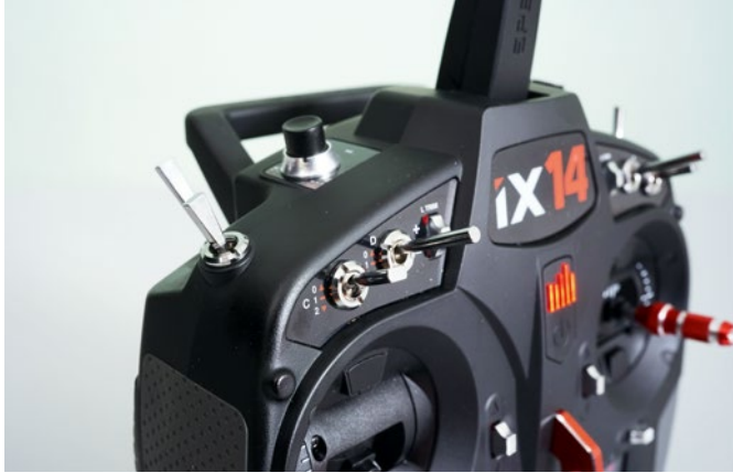
Die Schalter sind frei konfigurierbar und berührungsempfindlich für eine Sprachausgabefunktion
