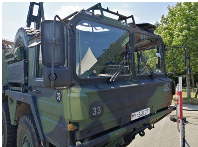
Von der Fahrerkabine des MULTI wird auch das Verlegen gesteuert
