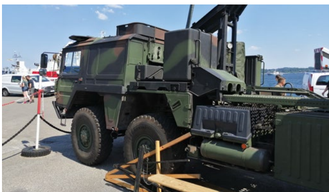
Die beiden vorderen Achsen des MAN MULTI sind beide lenkbar
