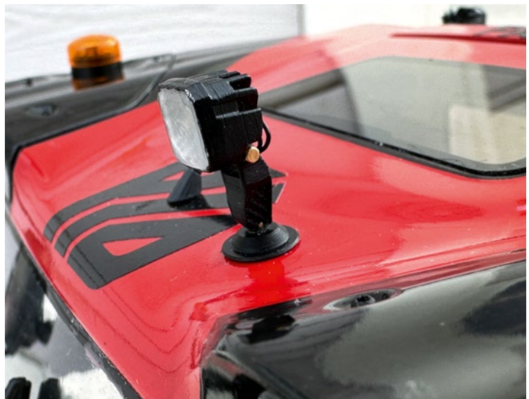
Ein winziges Linear-Servo dreht den Suchscheinwerfer auf dem Dach
