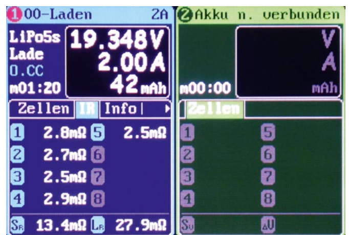
Auf Anforderung werden die Innenwiderstände der Zellen wiedergegeben
