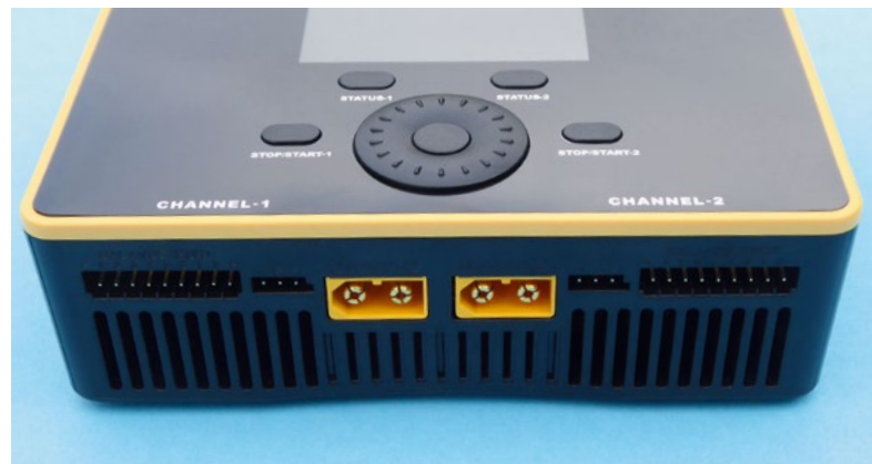
Sämtliche Akkuanschlüsse erfolgen auf der Frontseite. Leider sind die XT60-Anschlüsse sehr schwergängig, sodass man mit Ladekabeln arbeiten sollte
