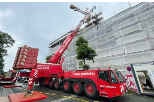
Das Stern-Abstützsystem des Terex Demag AC500-2 verfügt über vier Punkte, die Auslegerbalken lassen sich in den Rahmen voll ein- und ausfahren
