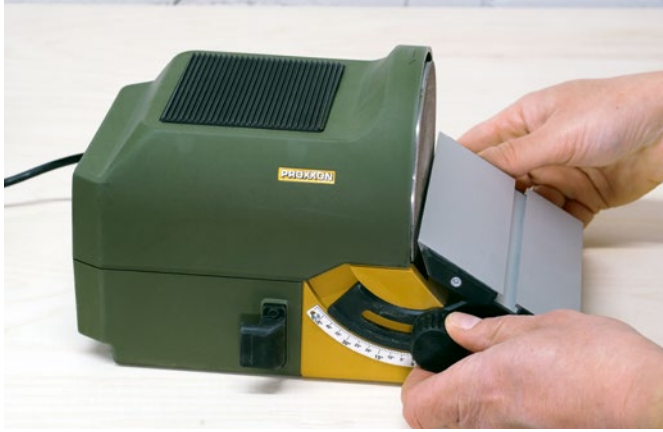
Im Winkel von -10° bis 50° lässt sich der 98 x 140 mm große Alu-Arbeitstisch verstellen – eine Skala zeigt das exakt an
