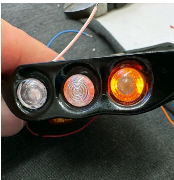
Der Ringeffekt des Blinkers wird mit zwei seitlichen orangenen LEDs erzeugt
