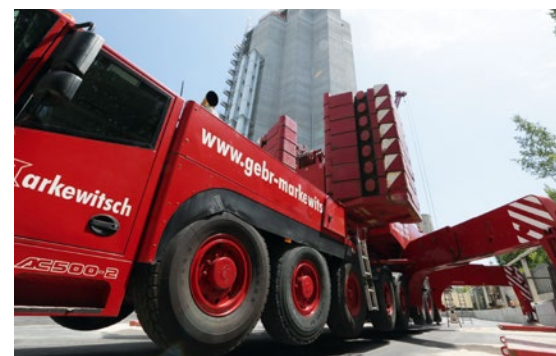
Der Tragrahmen des Terex Demag AC500-2 ist ein von Demag gefertigter Spezial-Hauptrahmen aus hochfestem Feinkornbaustahl
