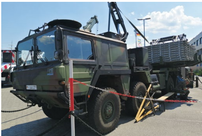
Der MAN selbst wiegt 19,5 t. Hinzu kommen rund 10 t zusätzlich für die faltstraße
