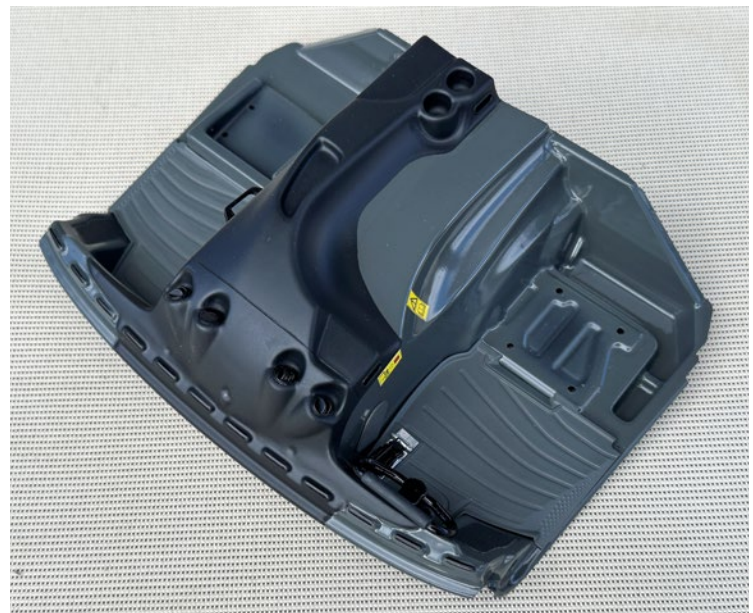
Die Bodengruppe wurde originalgetreu lackiert und mit Lüfterdüsen und Griffen verfeinert
