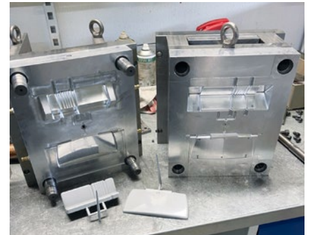
Komplett neue Spritzgussformen waren nach so langer Zeit zwingend erforderlich
