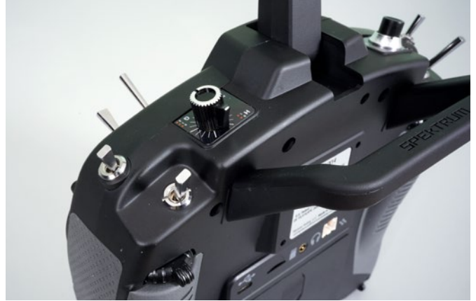
Über drei Drehgeber lassen sich proportionale Funktionen steuern
