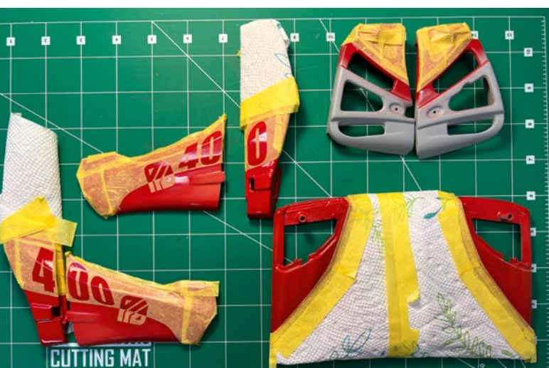
Mit einem Schneideplotter wurden Masken für die aufwändige Lackierung erstellt
