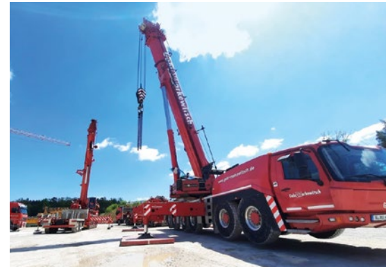
Beim GMK6400 von Manitowoc handelt es sich um einen Mobilkran mit einer Tragfähigkeit von bis zu 400 t, sein Hauptausleger ist 60 m lang
