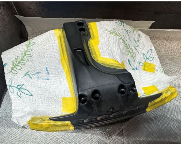
Lackieren der Mitteltunnelabdeckung
