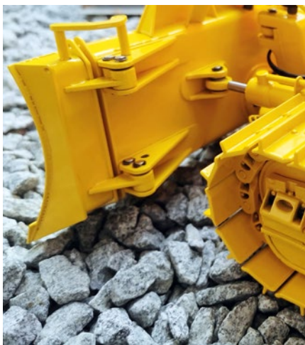
Wie beim Original lässt sich die seitliche Verbreiterung des Schilds für den Transport auf einem Tieflader einklappen
