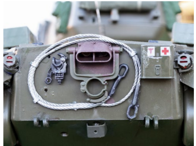
Der Erste-Hilfe-Kasten wurde installiert, um Soldaten, die hinter dem Kettenfahrzeug Schutz suchten, versorgen zu können
