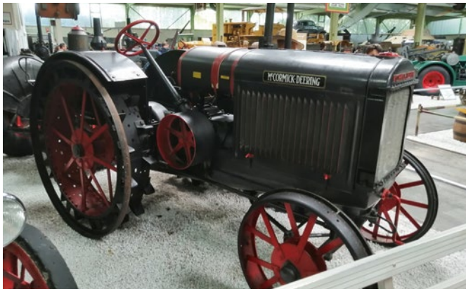
32 PS starker McCormick-Deering, ein Vierzylinder mit 6.100 cm 3 Hubraum
