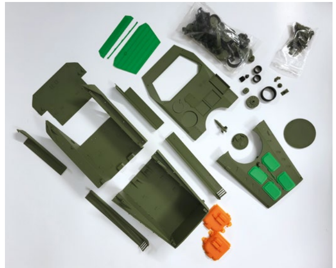
Mit dem P1S gedruckte Teile für den BMP-1 im Maßstab 1:16. Dank der Druckqualität sind wenig Spachtel- und Schleifarbeit nötig
