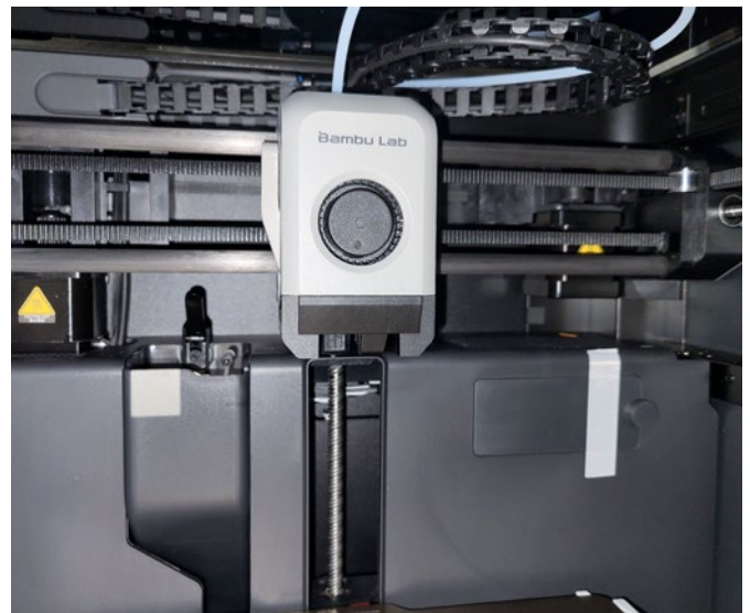
Kompakter Druckkopf: Das leicht wechselbare Hotend ist im Druckkopf formschön verpackt
