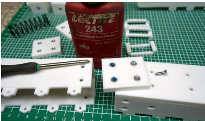
Bei der Montage des Baggers wird hauptsächlich geschraubt, nicht geklebt
