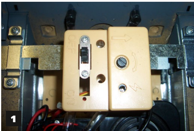
1) Über der Entriegelung der Oberwanne sitzt dieser kleine beige Kasten mit dem Hauptschalter (links), dem Lautstärkereglern (rechts) und einer Ladebuchse (rechts) für das Aufladen des Akkus – ohne diesen auszubauen. 2) Mit diesen Haken rastet die Oberwanne in die Verriegelung in der Unterwanne ein
