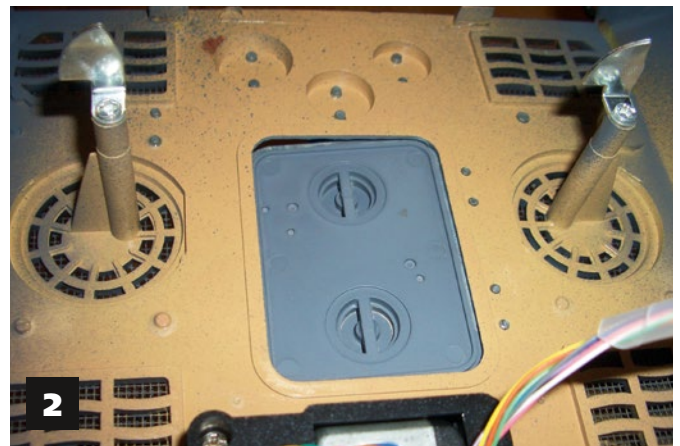
1) Über der Entriegelung der Oberwanne sitzt dieser kleine beige Kasten mit dem Hauptschalter (links), dem Lautstärkereglern (rechts) und einer Ladebuchse (rechts) für das Aufladen des Akkus – ohne diesen auszubauen. 2) Mit diesen Haken rastet die Oberwanne in die Verriegelung in der Unterwanne ein
