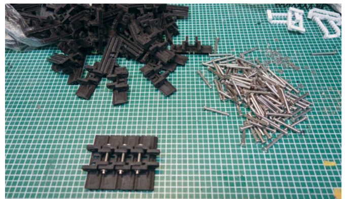
Auch die Kette entstammt dem 3D-Drucker. Hier kann es später am ehesten zu Verschleiß kommen
