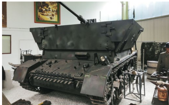
Der „Möbelwagen“ genannte Flakpanzer IV mit einer 3,7-cm-Kanone
