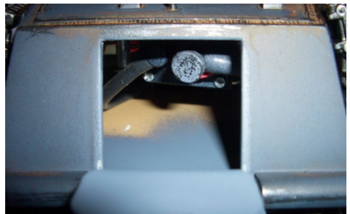
Die Luke am Heck des Turms lässt sich öffnen und gibt den Zugang zum Befüllen des Raucherzeugers für den Kanonenrauch frei
