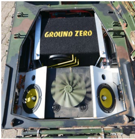
Wie beim Original sorgt ein Motorlüfter für die nötige Umluft im ausladenden Heck
