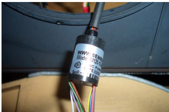
Die Schleifringbuchse verhindert bei der Drehung des Turms um 360° Schäden wie ein Abdrehen an der Turmverkabelung
