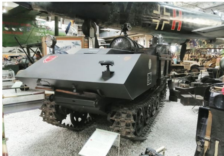
Der Raupenschlepper Ost kam als Zugmittel und Waffenträger der deutschen Infanterie zum Einsatz
