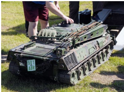
380 kg bringt der Bergepanzer auf die Waage und bewegt bis zu 80 kg Geröll
