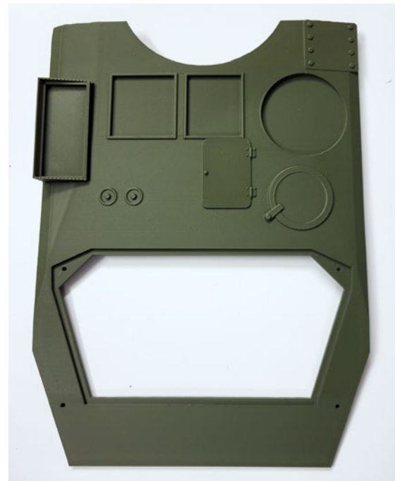
Glatte Oberfläche: Am BMP-1-Wannenoberteil, dass aus eSUN PLA+ gedruckt ist, sind kaum Rillen zu erkennen
