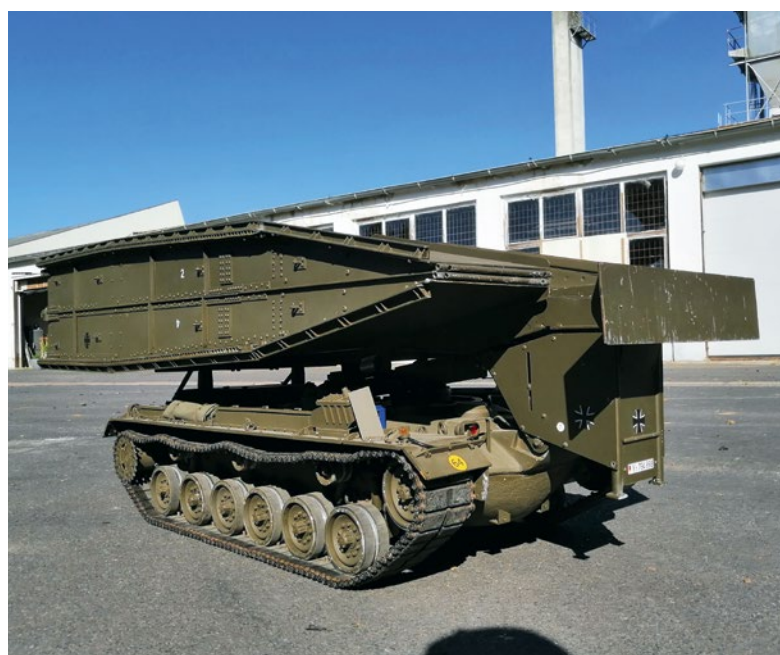
Volker Nagels Modell einer M48 Brücke. Im Museum selbst steht eine T55 Brücke
