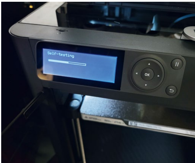
Im Rahmen der Inbetriebnahme führt der Drucker einen Selbsttest durch, der etwa fünf Minuten dauert
