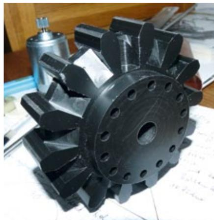
Das fertige Sternrad mit erkennbarer Abfräsung, damit der Schnee sich zwischen den Zähnen nicht aufbauen kann
