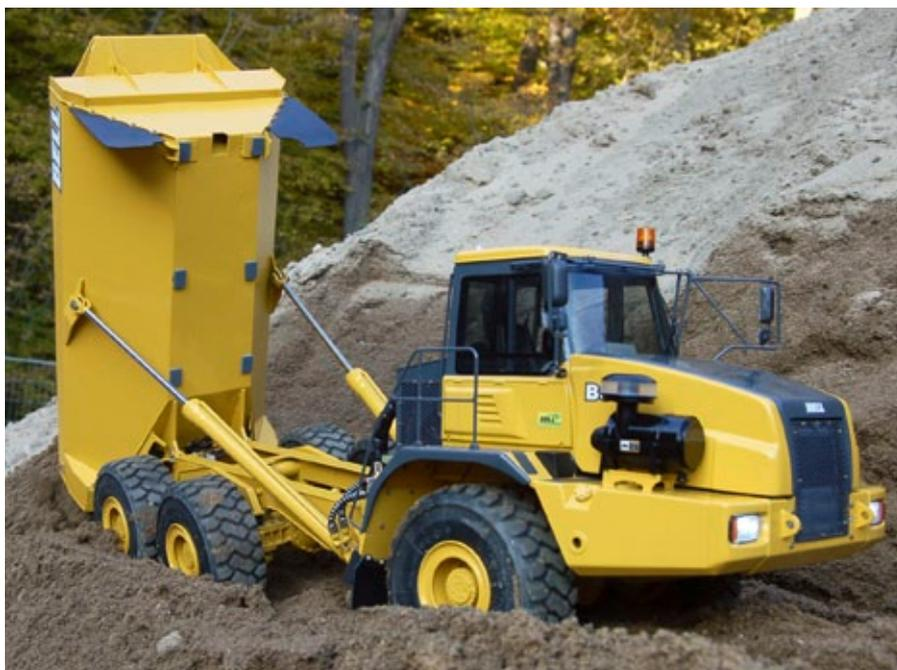
Über 70 Grad kann die Mulde vom Fahrzeug abgewinkelt werden
