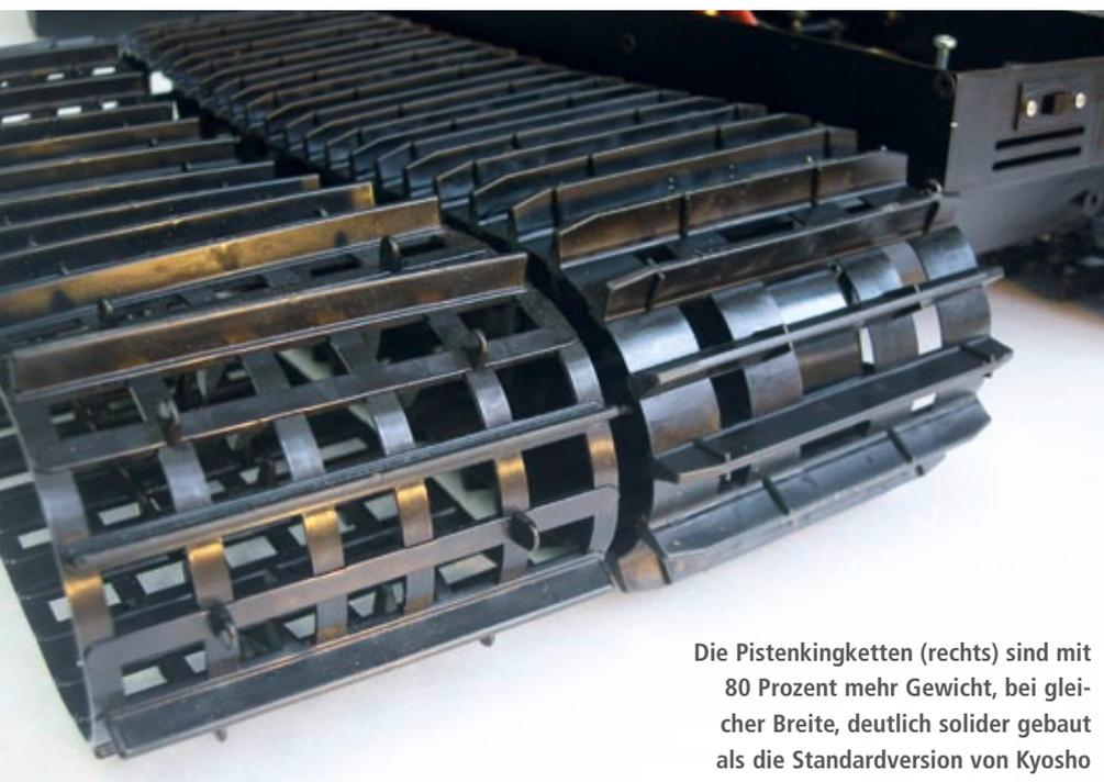
Die Pistenkingketten (rechts) sind mit 80 Prozent mehr Gewicht, bei gleicher Breite, deutlich solider gebaut als die Standardversion von Kyosho
