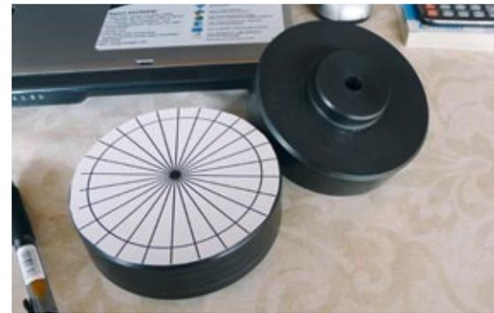
Die Antriebsräder im Rohzustand mit aufgeklebtem CAD-Segment zum Fräsen nach Augenmaß
