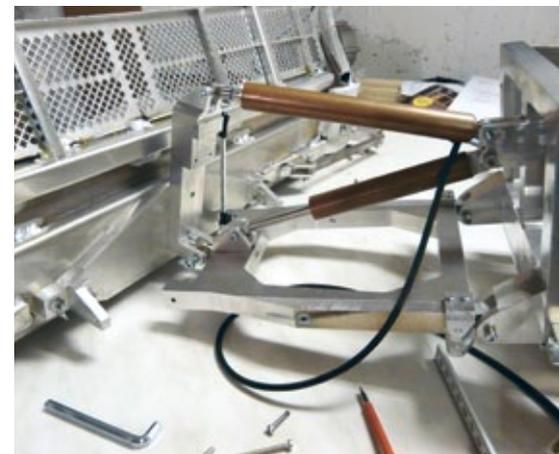
Anpassung des Räumschilds an den Geräteträger mit den imitierten Zylindern
