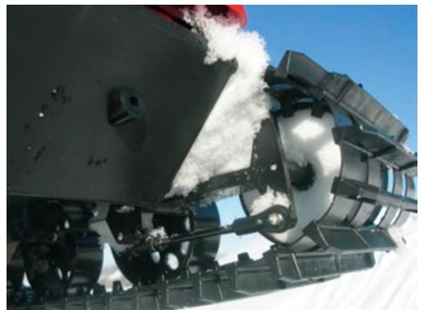
Auf der ungewöhnlich konstruierten Spannradaufhängung lagert sich gerne der Schnee ab und behindert einen optimalen Schneebfluss auf der Ketteninnenseite
