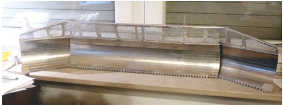
Räumschild in der Frontansicht: das Schneegitter ist handgefeilt und auf dem fertig geschweißten Schild befestigt
