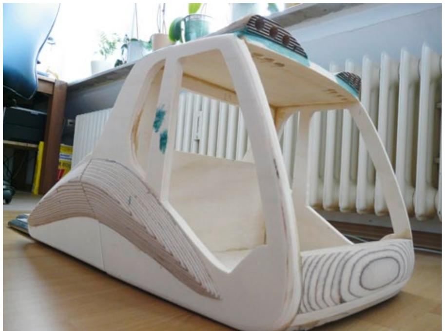
Das Fahrerhaus im Rohzustand. Als Material dient Pappelsperholz, das mit einer Stichsäge entsprechend zugeschnitten und anschließend verklebt wurde
