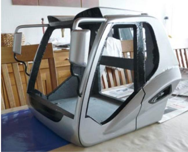
Das fertig lackierte Fahrerhaus, der Einbau der Beleuchtung kann nun beginnen
