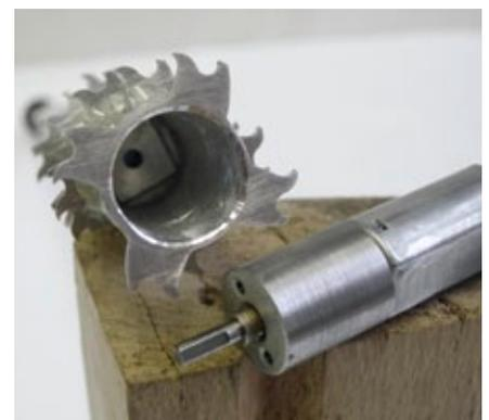
Blick ins Welleninnere, wo eine zentrische Bohrung die Motorwelle aufnimmt
