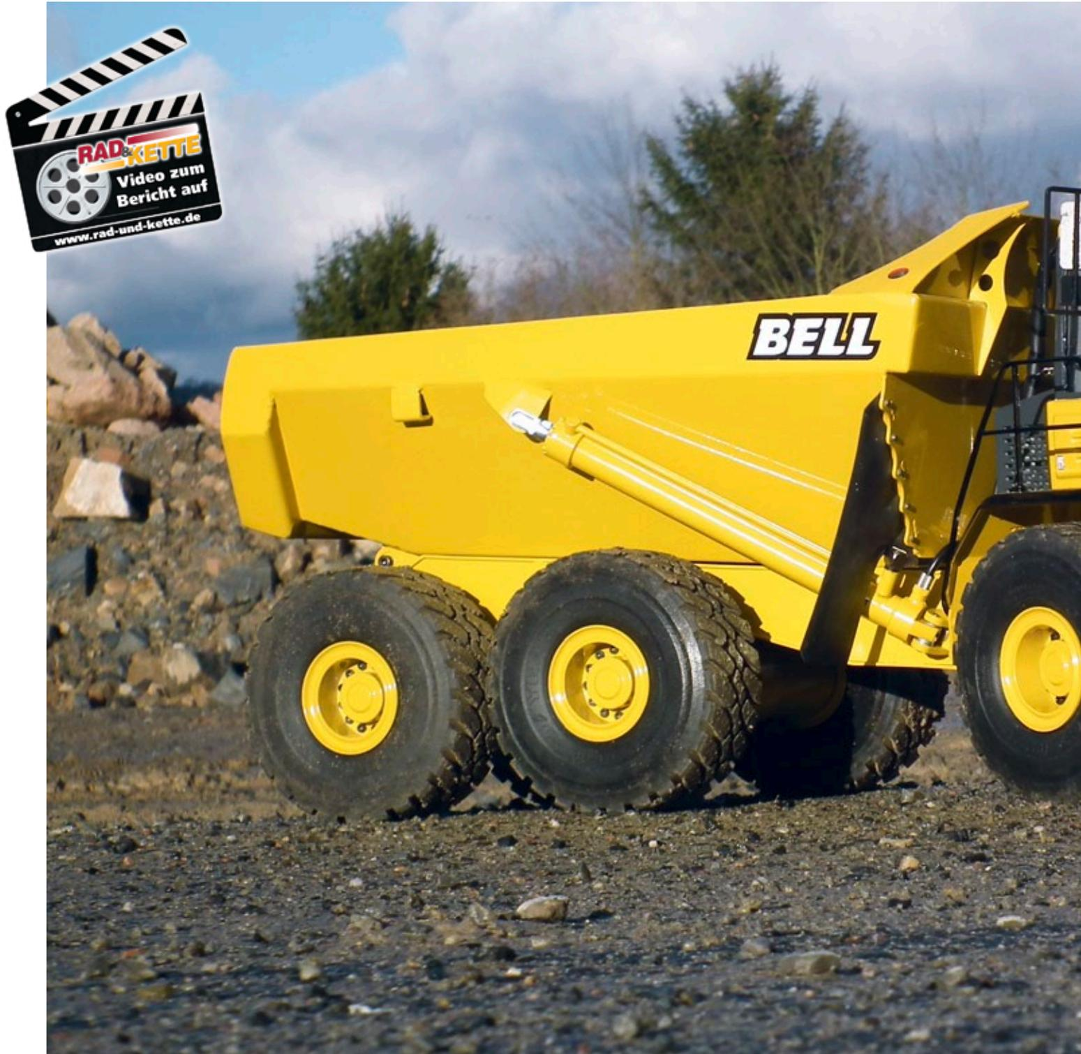
Der Baukasten kommt wie gewohnt daher. Die Stahlteile sind fertig gekantet und geschweißt, es ist nur noch ein wenig Nacharbeit vor dem Lackieren notwendig. Die Aluminium-Komponenten sind alle CNC-gefertigt und passen somit perfekt, die GFK-Teile sind bereits vorgeformt und müssen nur noch ausgeschnitten werden. Die Reifen stammen aus dem Hause AFV, sind von hervorragender Qualität und wurden eigens für den Dumper entwickelt. Die Hydraulik besteht aus einer 4002er-
