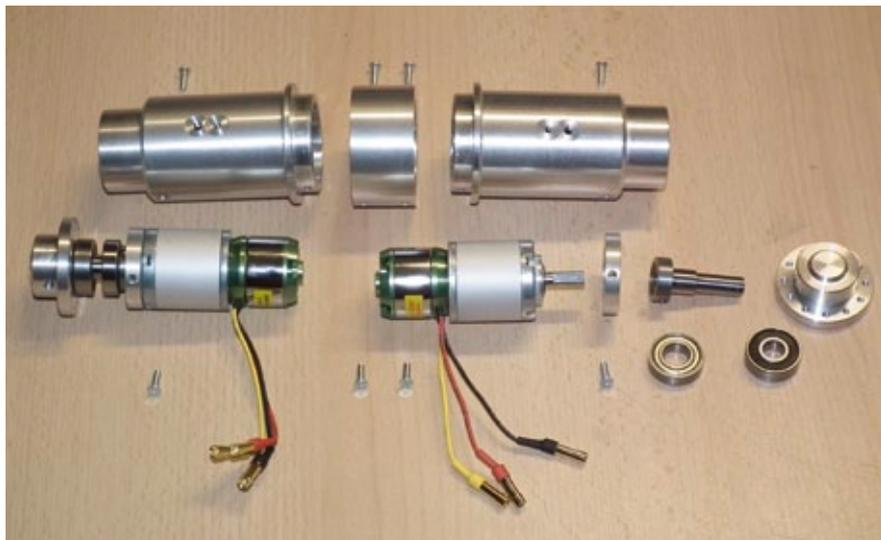
Die Einzelteile einer Achse samt der Lager und Motoren
