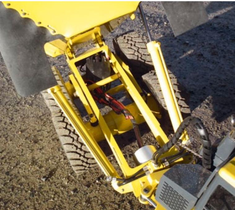
Detailansicht eines Kippvorgangs. Die Hydraulik besteht unter anderem aus einer 4002er-Jungpumpe und einem Meinhardt-Doppelventil
