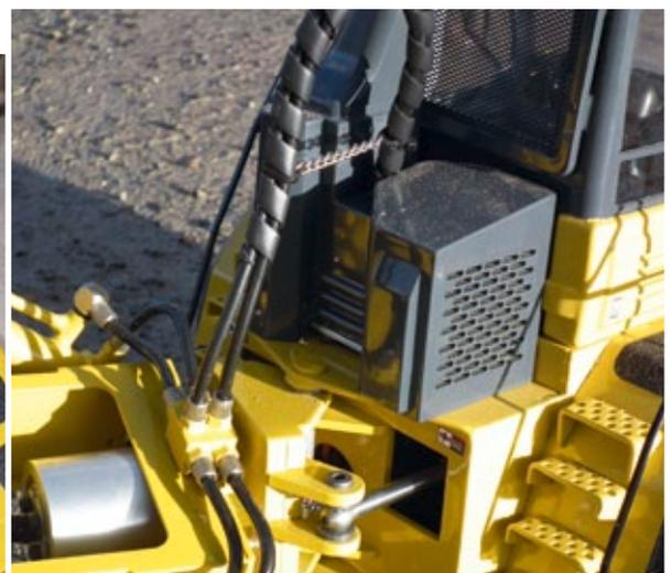
Der optionale Ölverteiler ermöglicht ein originales Verlegen der Hydraulikschläuche
