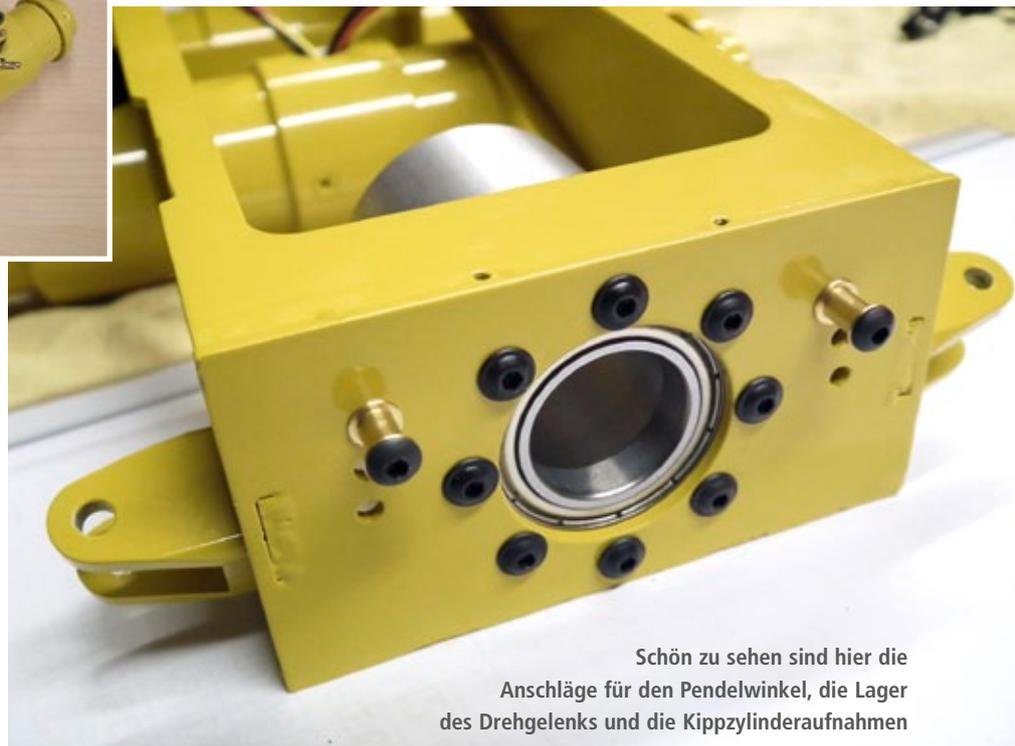
Schön zu sehen sind hier die Anschläge für den Pendelwinkel, die Lager des Drehgelenks und die Kippzylinderaufnahmen
