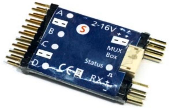
Der Schaltbaustein Switch 4 von Weatronic verfügt über vier Ausgänge, die jeweils mit bis zu 10 Ampere belastbar sind. Das Modul kann an jeden beliebigen Servoausgang angeschlossen werden, ist programmierbar und updatefähig sowie mit 14 Blink- und Schaltprogrammen ausgestattet
