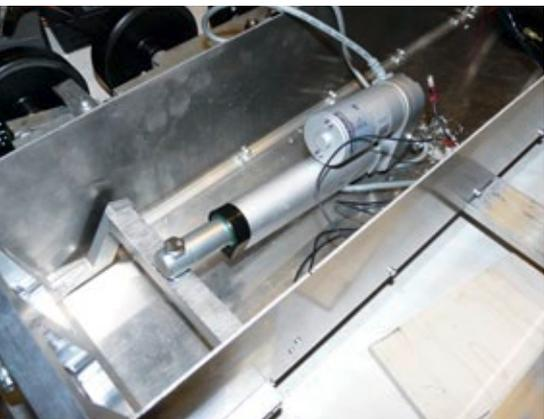
Die Hebelkulisse des Geräteträgers mit dem Linearmotor
