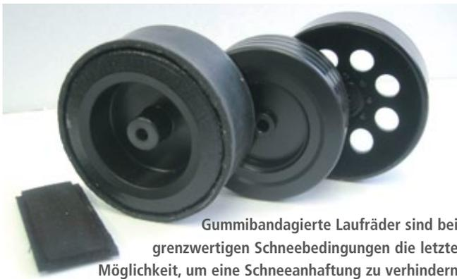
Gummibandagierte Laufräder sind bei grenzwertigen Schneebedingungen die letzte Möglichkeit, um eine Schneeanhaftung zu verhindern
