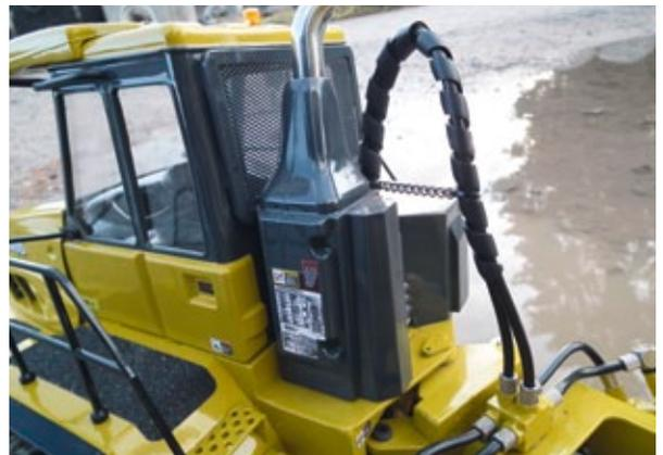
Detailansicht des Heckbereichs und der Hydraulikschläuche
