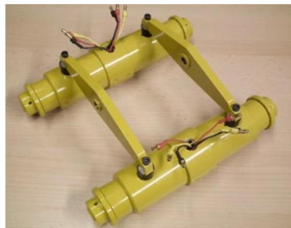
Das fertige Hinterachsaggregat mit der Pendelaufhängung
