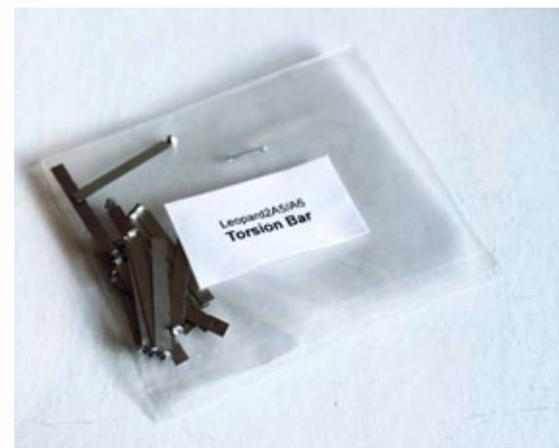
Die aus Federstahlblech hergestellten Drehstäbe noch in der Verpackung
