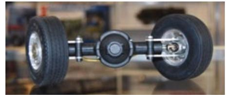
Neu ist ein Umrüst-Kit für die weit verbreiteten Panther-Achsen von robbe, die in vielen Fahrzeugen im Maßstab 1:14,5 zum Einsatz kommen. Nach dem erfolgreichen Umbau wird der Lenkeinschlag auf maximal 44 Grad erweitert. Der Drehpunkt der Lenkgeometrie liegt näher am Rad, was zu einem deutlich kleineren Lenkrollradius beiträgt.
