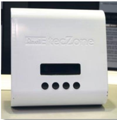
Das Computerladegerät Power stammt aus der neuen tecZone-Produktlinie von Revell. Der Lader im modernen Design ist in zwei Versionen erhältlich: S6/80 für das Laden von sechs LiPo- beziehungsweise 15 NiCd/NiMH-Zellen mit 0,1 bis 6 Ampere (80 Watt) und S3/45 für das Laden von drei LiPo- oder 10 NiCd/NiMH-Zellen mit 0,1 bis 4 Ampere (45 Watt). Beide Lader verfügen über einen 12-Volt-Anschluss und ein eingebautes Netzteil
