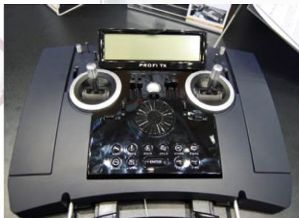
Eine neue 2,4-Gigahertz-Fernsteuerung gibt es bei Multiplex. Die Profi TX M-Link gibt es in Versionen mit 9, 12 oder 16 Kanälen. Besonders fällt das große, kippbare Display auf, die Menüstruktur ist klar und übersichtlich. Der LiFePO4-Senderakku mit Akkumanagement hat eine Laufzeit von zirka 25 Stunden. Ein optionales Senderpult ist ebenfalls erhältlich.
