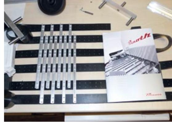
Die Kettenstege im Rohzustand, bereits fertig gebohrt, darunter die Gewebebänder. Fast 2.000 Schrauben kamen zum Einsatz
