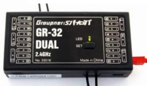
Der beiliegende GR-32-Empfänger bietet bis zu 16 Kanäle und Anschlüsse für bis zu vier Sensoren
