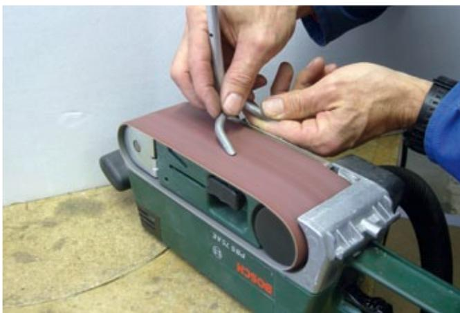
Mit Sorgfalt werden die Tragrohre an den Fräsenkasten angepasst
