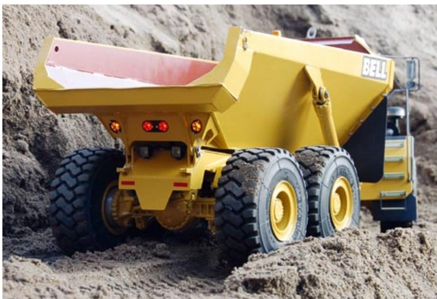
Die Mulde ist aus gelasertem Stahlblech gefertigt und mit einem speziellen Strukturlack bestrichen
