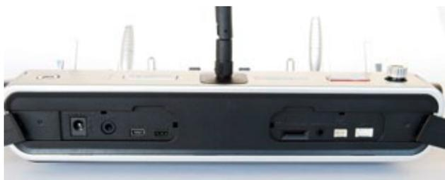
Unter zwei Klappen an der Stirnseite lassen sich folgendes von links nach rechts einstecken: Ladekabel, Lehrer-Schüler-Kabel, Mini-USB-Buchse, Smart-Box, micro-SD-Karte, Kopfhörer, ein externes HF-Modul und optionales für zukünftige Anwendungen
