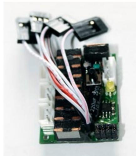
MTC – die Elektronik für die Motorsteuerung
