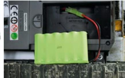
Der Fahrakku mit 800 Milliamperestunden Kapazität ist samt Ladegerät bereits enthalten und wird in einer Kammer am Fahrzeugboden angeschlossen
