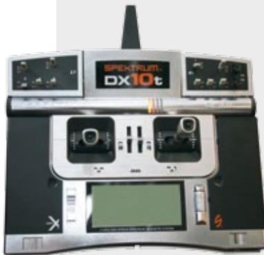
Die Spektrum DX10t ist eine 2,4-Gigahertz-Fernsteueranlage, die höchsten Ansprüchen genügt. Design und Konzept stammen aus Deutschland und sind auf die Bedürfnisse von Modellbauern optimiert. Das Gehäuse überzeugt durch seine Leichtigkeit und durch geringe Abmessungen. Alle Schalter können frei programmiert, die zehn vollproportionalen Kanäle können auf bis zu 18 erweitert werden. Der Sender verfügt über austauschbare Funktionsmodule.
