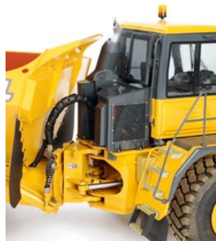
Besonderer Hingucker: das Knickgelenk am Fahrerhaus, das den Bewegungsradius des Modells deutlich erhöht
