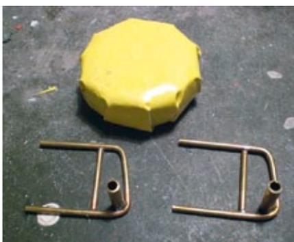
Aus Messingrohren wurde der Ersatzradträger gebogen, hier findet das Ersatzrad mit der Schutzplane seinen Platz
