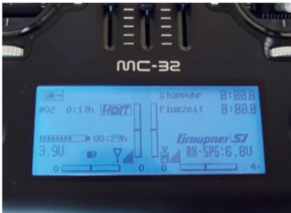
Auf dem unteren Display werden alle üblichen Daten wie Trimmstellungen, verschiedene Uhren und die Versorgungsspannung des Empfängers dargestellt
