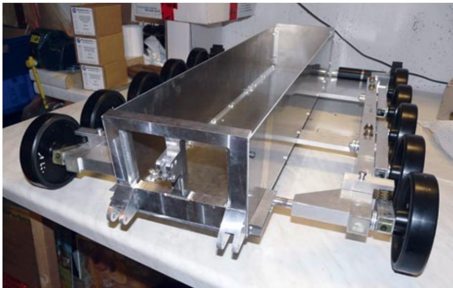
Das Chassis ist vorbereitet für den ersten Fahrtst. Gut zu erkennen ist hier der massive Alufräsrahmen für den Geräteträger
