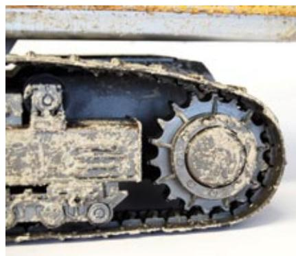
Die Kette besteht aus einem robusten Gummi, das Fahrwerk ist in Metall ausgeführt. Hier macht der Crawler Crane einen hochwertigen Eindruck
