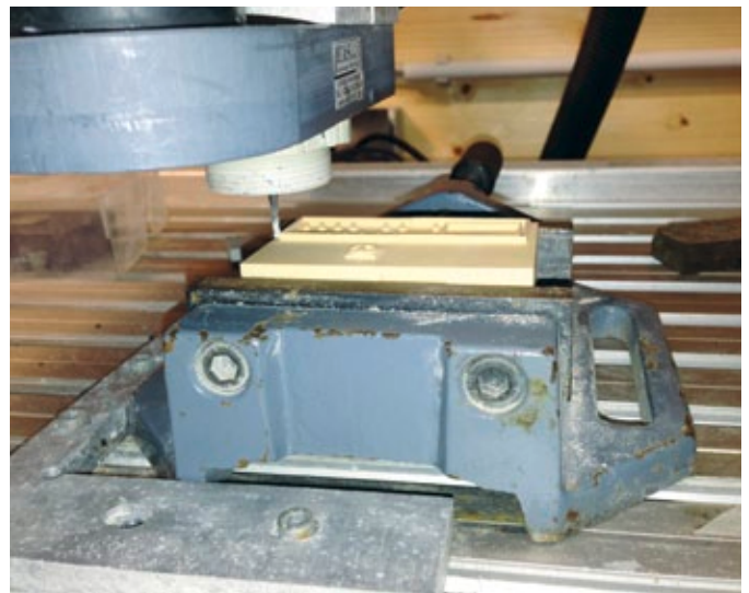
Seitlich am Kanonenrohr ist ein Schaltkasten angebracht, auch hierfür wurde zuerst ein Urmodell aus Ureol-Blöcken gefräst
