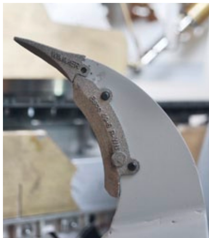
Die gesinterte Schneide von dem Reißzahn mit originaler Beschriftung
