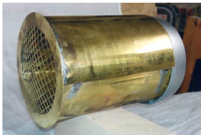
Mit einem Gas-Sauerstoffbrenner wurden die gewalzten Teile zusammengelötet und das hintere Schutzgitter an der Kanone befestigt
