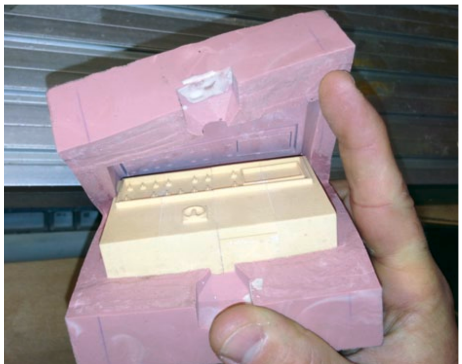
Die Gussform aus Silikon für den Schaltkasten
