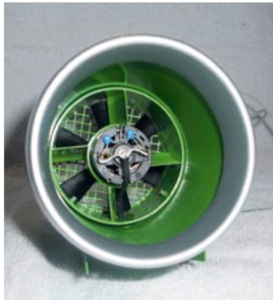
Ein Impeller aus dem Flugmodellbau sorgt dafür, dass die Kanone auch tatsächlich Schnee aufwirbeln kann
