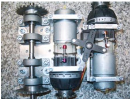
Basis des Antriebs sind zwei Industrie-Akkuschrauber von Bosch. Das Servo schaltet in den zweiten Gang
