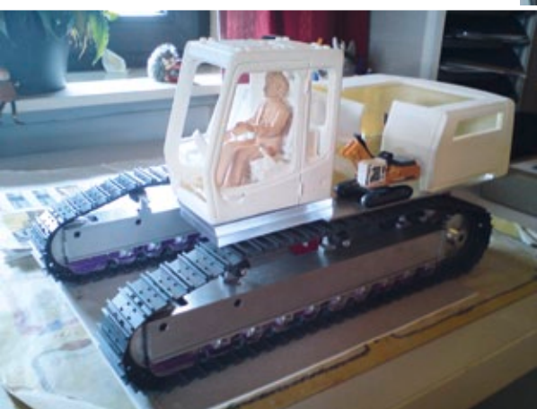
Blick auf den Unterwagen mit den ersten Teilen vom Aufbau
