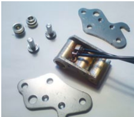
Der Schnellwechsler entsteht. Von den Einzelteilen bis zur fertigen Verriegelungsmechanik und dem ersten Test mit dem Reißzahn
