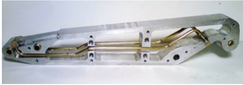
Die Verrohrung für den Schnellwechsler im Löffelstiel
