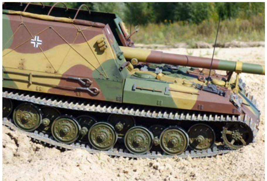
Die Panzerketten stammten ursprünglich von Tamiya, wurden während der Bauphase aber noch einmal durch hochwertige Metallketten von Asiatam ausgetauscht. Nicht ganz günstig, aber der Optik und dem Fahrverhalten absolut zuträglich
