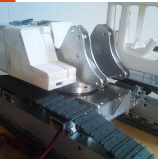
Der Bagger wächst und die beiden Auslegerböcke sind bereits montiert
