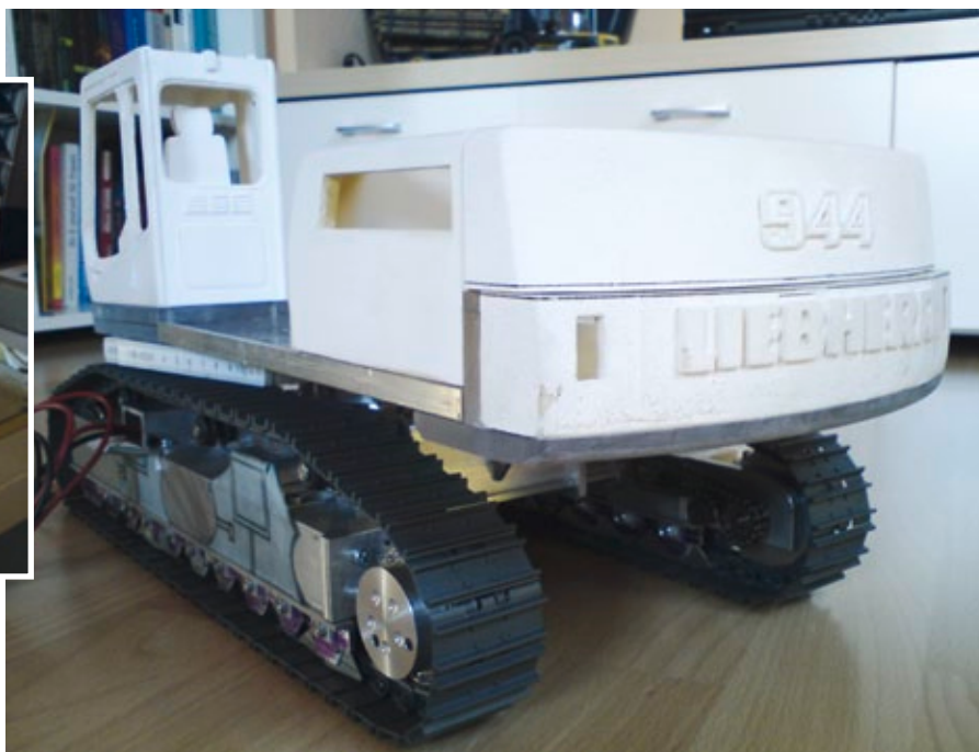
Gewichtig: Der bereits umgebaute Heckballast
