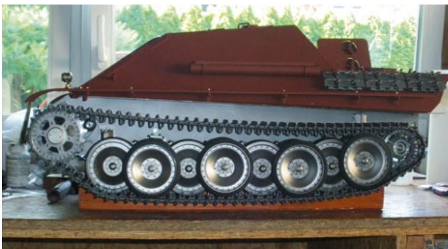
Für die originalgetreue Farbgebung war eine Vorbehandlung des Rohbaus nötig. Zuerst wurde das Modell sangestrahlt und anschließend mit einem rotbraunen Rostschutz grundiert
