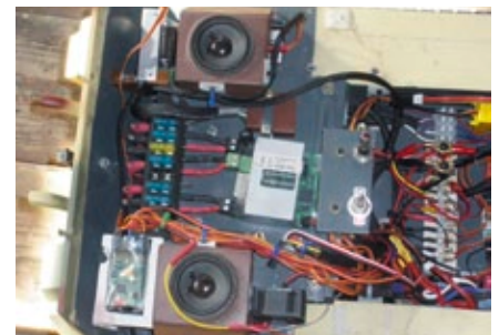
Die Zweiwege-Lautsprecherboxen wurden den baulichen Gegebenheiten des Modells angepasst und im Heckbereich verbaut
