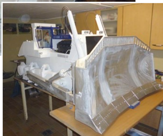
An der Vorderseite des Komatsu D475a ist das Schild. Es wurde aus Aluminiumblechen geschweißt und geschliffen
