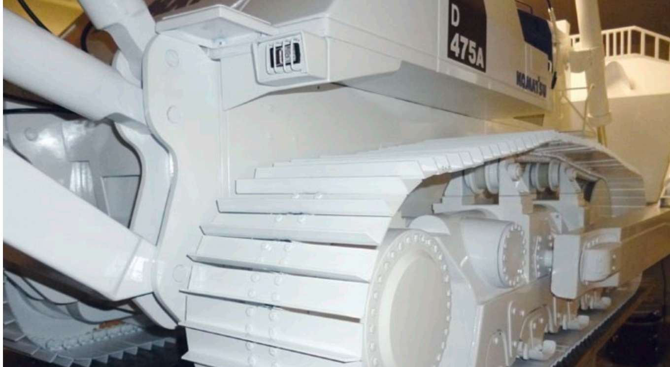
Einfach, aber effektiv: Mittig verschraubte Aluminium-Winkel dienen als Kettenelemente
