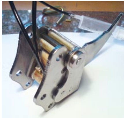
Der Schnellwechsler entsteht. Von den Einzelteilen bis zur fertigen Verriegelungsmechanik und dem ersten Test mit dem Reißzahn
