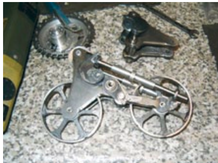
Das fertige Carden-Loyd-Fahrwerk besteht aus 42 Einzelteilen
