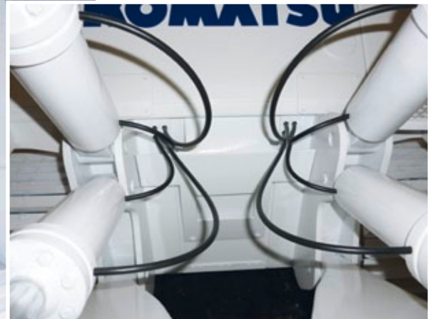
Die Hydraulikattrappen wurden überwiegend aus Aluminium gefertigt
