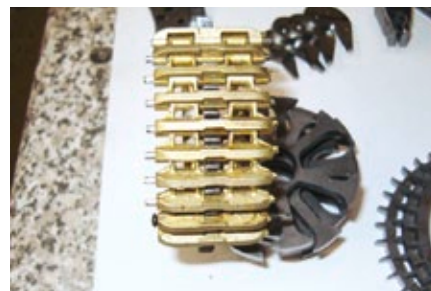
Die Kette besteht aus Messing und wurde von „Das Gießwerk“ nach den CAD-Plänen der Modell-Erbauer angefertigt
