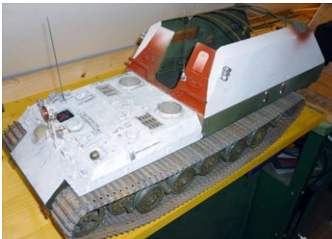
Der Rohbau mit der teilweise weißen Grundierung, bestehend aus einer Mischung aus Feinspachtelmasse mit Nitro-Verdünnung
