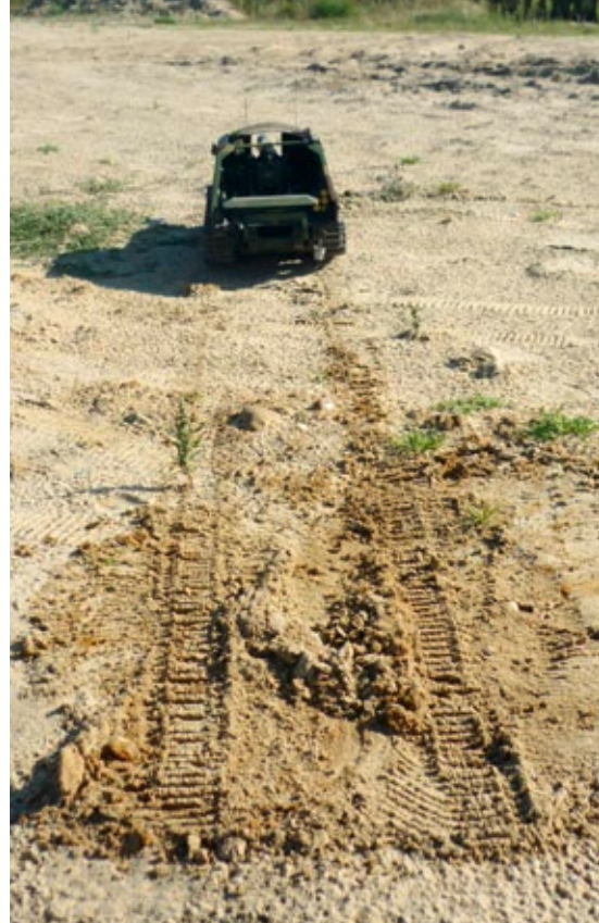
Die Spuren im Sand: Das fertige Modell überzeugt durch ein realistisches Fahrverhalten. Sogar ein Drehen auf der Stelle ist möglich, wie man hier am aufgewühlten Sand erkennt
