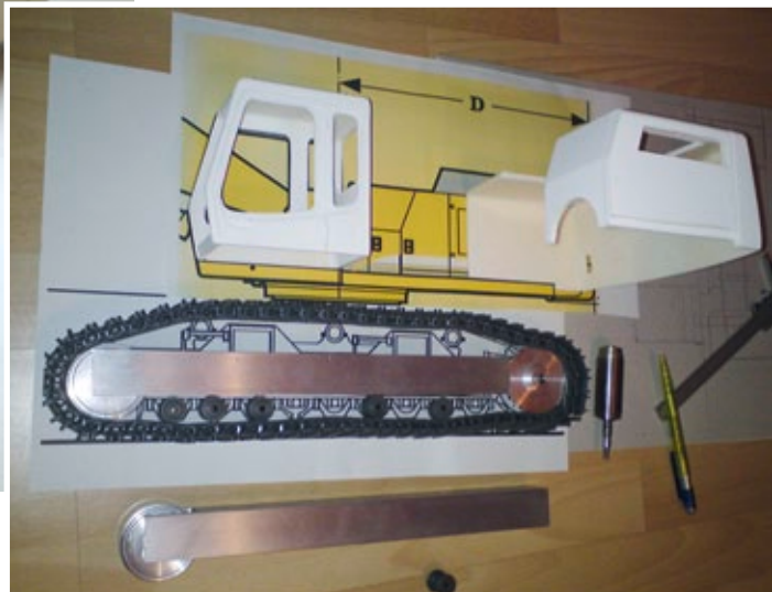
Der Rohbau der Fahrwerksschiffe mit den PDF-Ausdrucken
