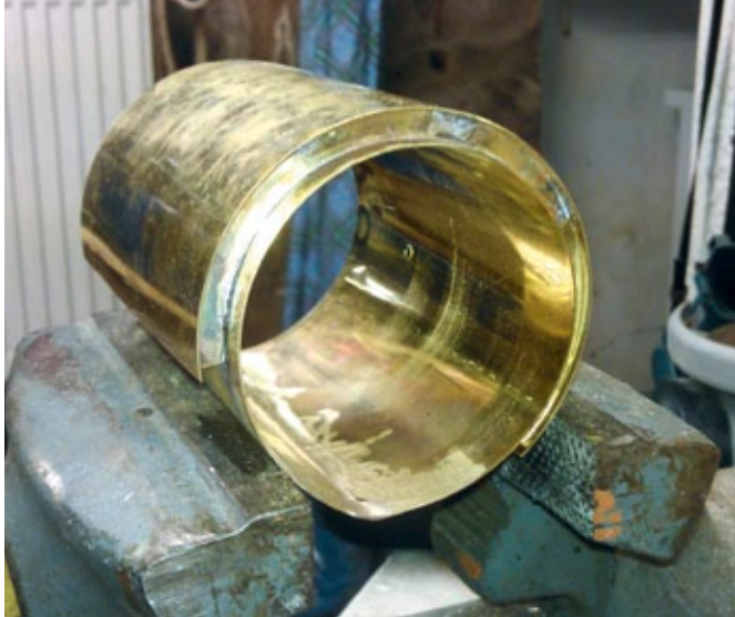
Das Rohr der Schneekanone besteht aus 0,7 Millimeter dickem Messingblech, dass auf einen Innendurchmesser von 69 Millimeter gewalzt wurde
