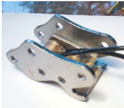
Der Schnellwechsler entsteht. Von den Einzelteilen bis zur fertigen Verriegelungsmechanik und dem ersten Test mit dem Reißzahn
