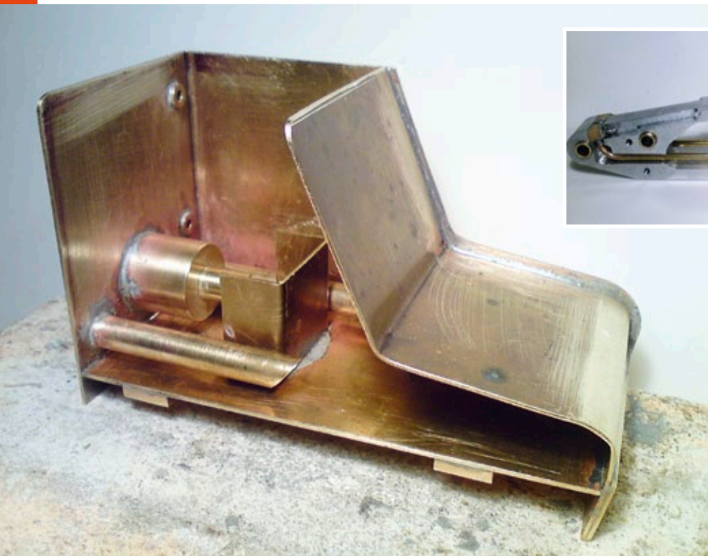
Das Innenleben des Tanks aus Messingblech
