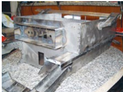
Der Rohbau entsteht. Die einzelnen Bleche sind 1 bis 4 Millimeter dick
