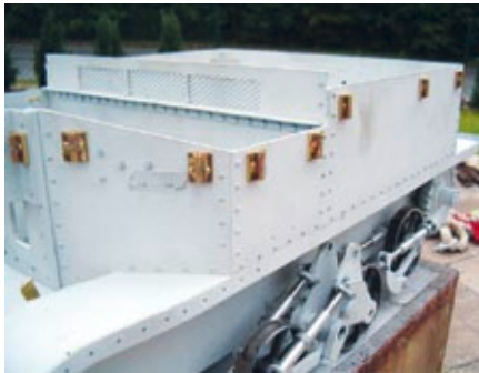
Die Spiegelhalterungen sind aus Messing
