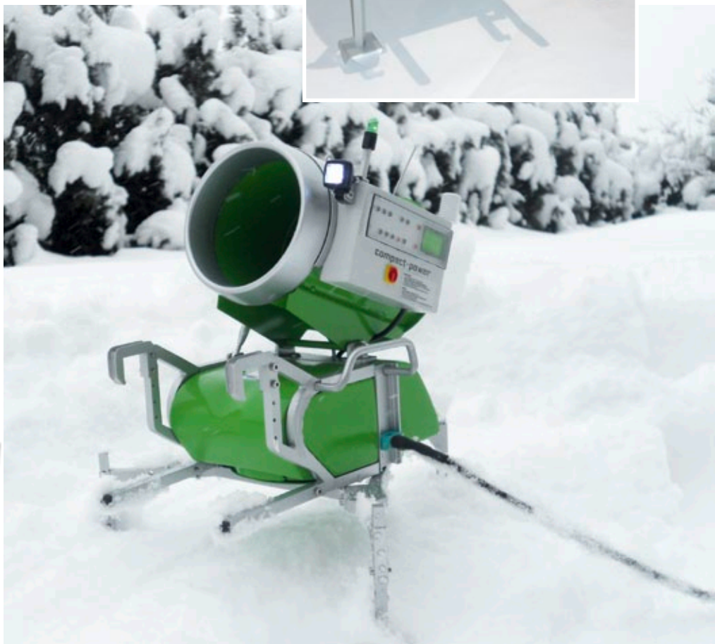
Die fast fertige Schneekanone mit Signalleuchten und einer Wittersonden-Attrappe
