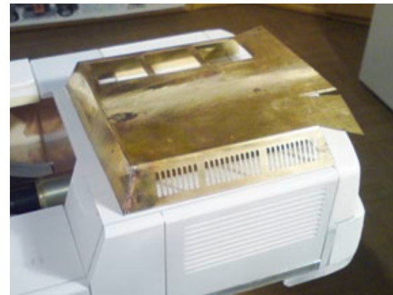
Die Motorhaube besteht aus gerade einmal 0,3 Millimeter starkem Messingblech
