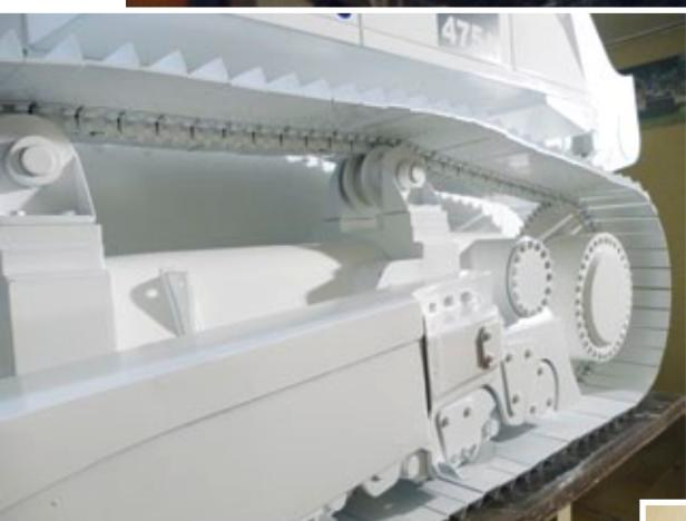
Das Antriebsrad besteht aus Stahl, die anderen Räder wurden aus Hart-PVC gedreht
