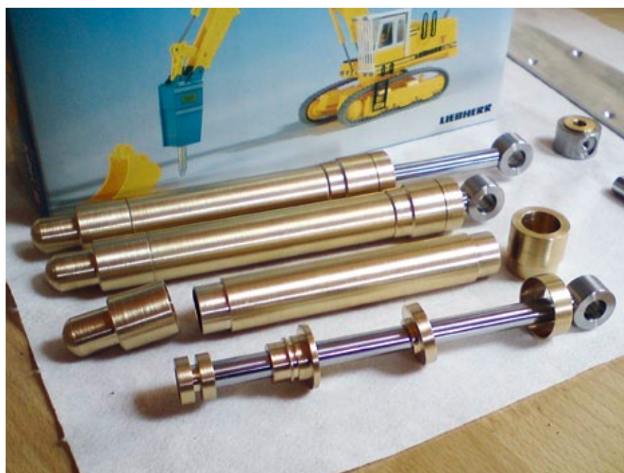
Die Einzelteile der Zylinder, hier kann man gut den Aufbau erkennen
