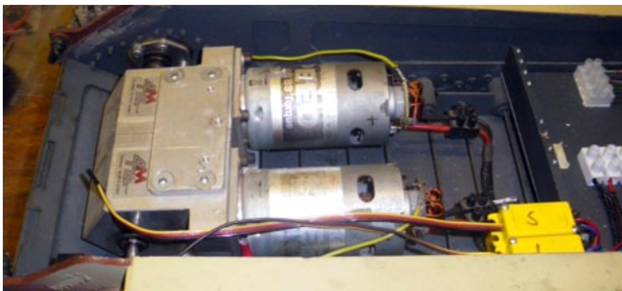
Zwei Graupner-Motoren mit der Bezeichnung BB 900 sorgen im Modell für den nötigen Antrieb. Jeder hat eine Leistung von etwa 100 Watt
