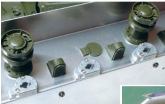
Die Wanne nimmt Gestalt an. Die Anschläge für die Schwingarme sind fest mit der Wannenseitenwand verschraubt
