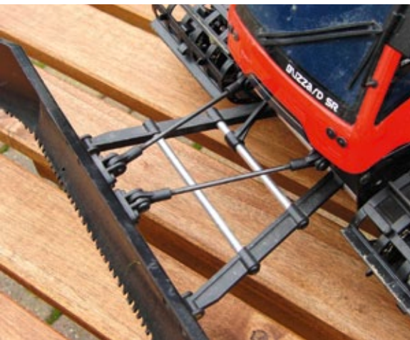
Die vordere Querlenkerkonstruktion vor dem Umbau – alles etwas wackelig
