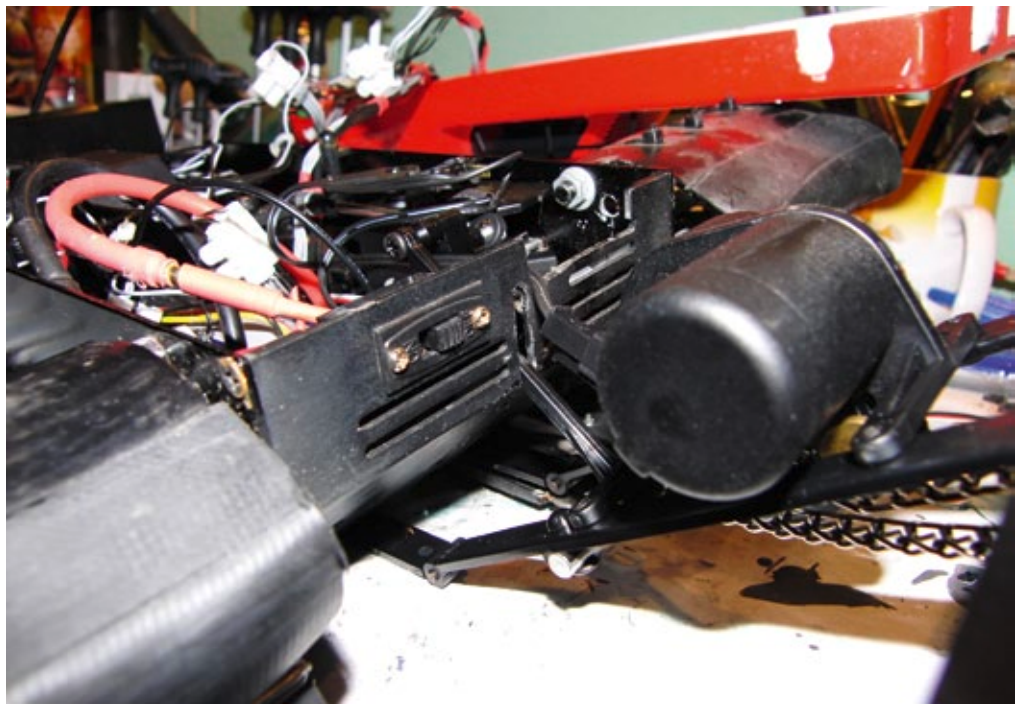
Der Antriebsmotor sitzt gut gekapselt auf dem Heckausleger
