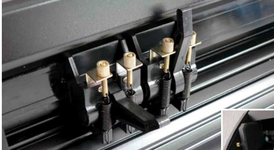
Die Einstellung der Folienandruckfedern sollte zunächst auf gleiches Niveau gebracht und justiert werden
