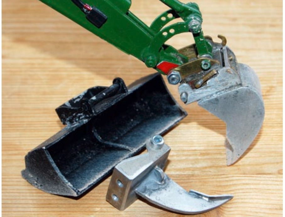
Minibagger mit Schnellwechselsystem und aus Aluminium zusammengelöteten Anbaugeräten
