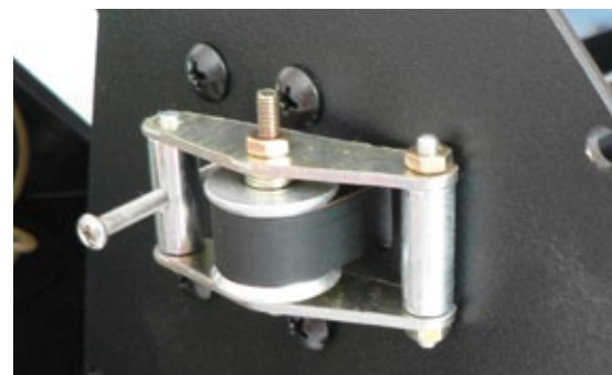
Die Riemenspannung des Messerschlittens sollte von Zeit zu Zeit kontrolliert werden, um ein Überspringen des sich langsam längenden Riemens zu verhindern.
