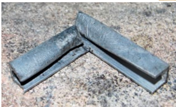
Zu heiß: Bei diesem Versuch schrumpelte das Aluminium auf einer Seite
