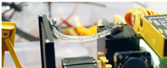
Schön sieht man beim Entlüften der Hydraulikanlage, wie die Luftblasen aus dem System zum Tank zurückgedrückt werden
