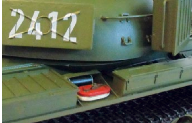
Rot-Weiße Schwimmer für die Unterwasserfahrt
