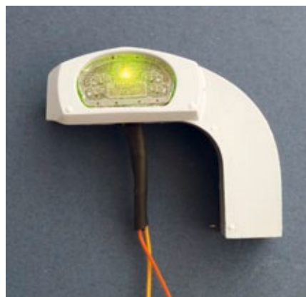
Die grüne Funktions-LED ist in der Instrumentenkonsole untergebracht und signalisiert den betriebsbereiten Zustand der Raupe
