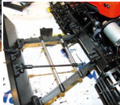
Nur vier Schrauben öffnen und schon lassen sich die Anlenkstangen gegen den massiven Alulenkler austauschen
