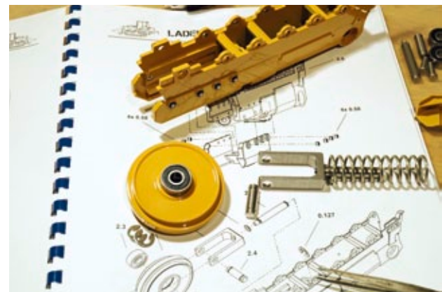
Laufwerk mit Leitrad und Spanner zur Montage bereit
