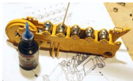
Speziell an den bewegten Teilen müssen alle Verschraubungen mit Loctite Schraubensicherung mittelfest verklebt werden, um ein Lösen im Betrieb zu unterbinden
