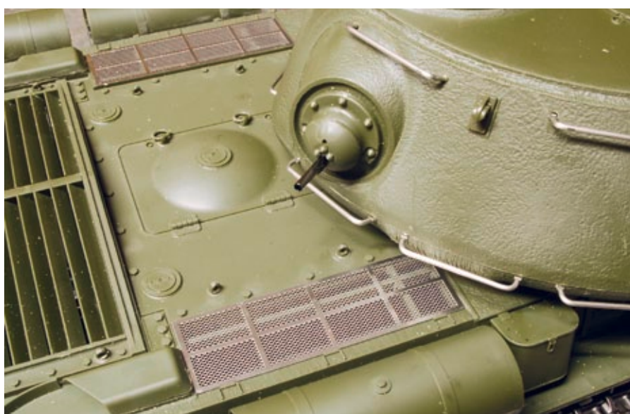
Details im Blick: Abluftgitter als Fotoätzteile, Haltestangen und MG-Rohr aus Metall
