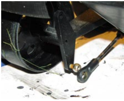
Durch das Entfernen der Kugelpfanne vom Kugelkopf lässt sich die Kette zum Wechsels einfach einspannen
