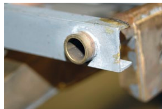
Auch das ist möglich: Aluminium und Messing zusammen verlötet
