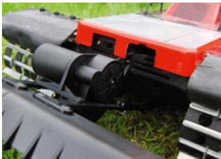
Antriebsmotor und Getriebe sitzen außen auf dem Heckausleger
