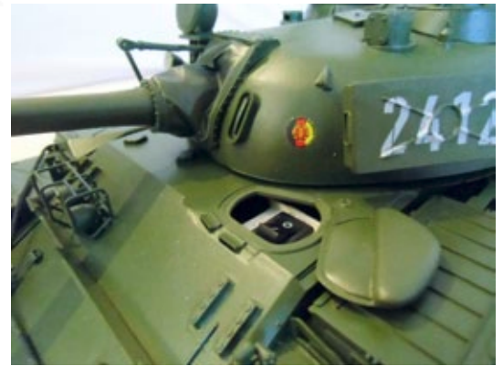
Unter der Fahrerluke befindet sich der Hauptschalter
