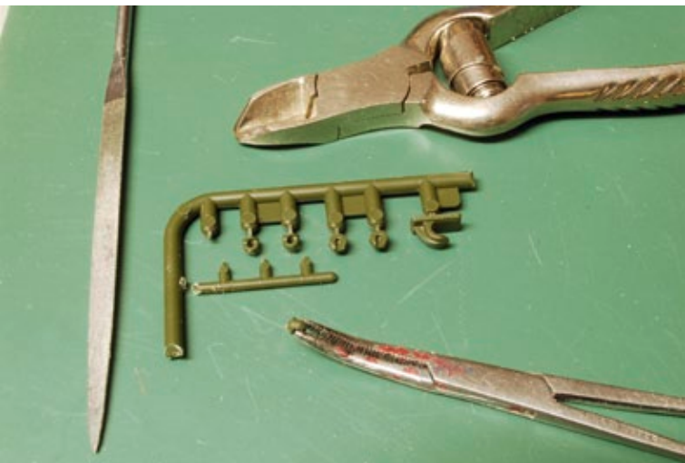
Hilfreiche Werkzeuge bei der Montage. In der Klemmschere wartet eine Einsetzöse auf das Entgraten ihrer kegelförmigen Basis
