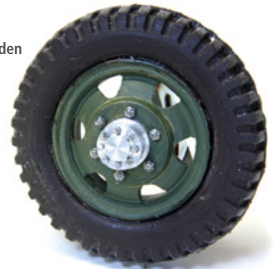
Eine Gießform dient zur Fertigung der Felgen
