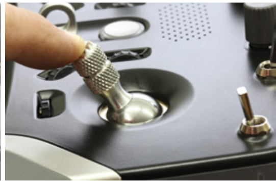
... und nach hinten ist der Knüppel mit einer Federrückstellung versehen
