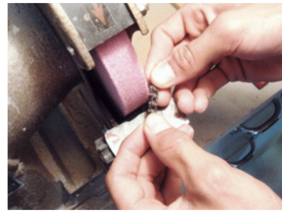
Die Kettenglieder habe ich von der Rollenkette abgetrennt und die Vernietungen abgeschliffen
