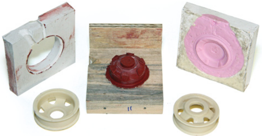
Eine Gießform dient zur Fertigung der Felgen
