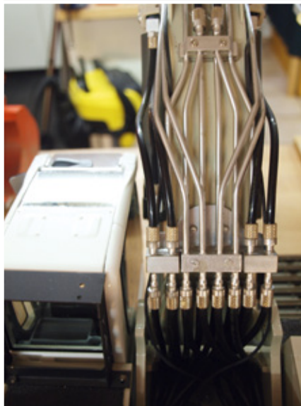
Sämtliche Schläuche von den Ventilen sind verschraubt
