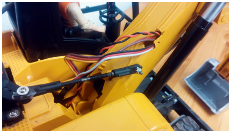
Die Anlenkung des Hauptarms wurde auf gleicher Höhe wie das Servohorn montiert
