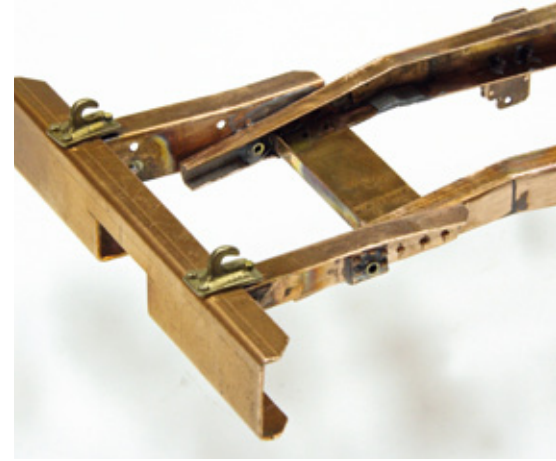
Für den Rahmen wurde 0,8 mm dickes Kupferblech genutzt
