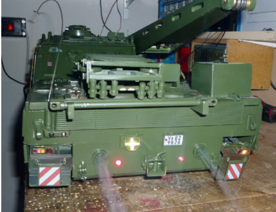
Die Lichteinheit und der Dampferzeuger sind in Aktion. Schön zu erkennen sind die Auspuffgitter
