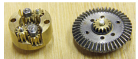
Das Tellerrad und der Differentialkorb entstanden an der heimischen Drehbank
