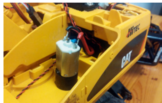
Der Getriebemotor passt sauber unter das Fahrerhaus
