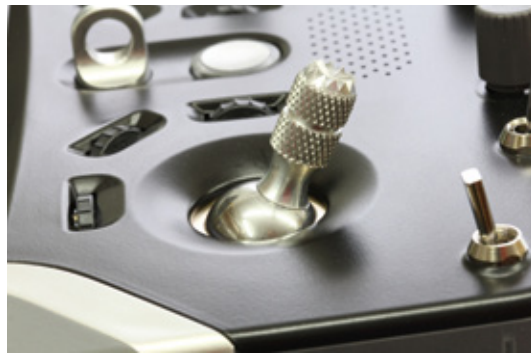
... nach vorne besitzt der Knüppel eine Rastung, um zum Beispiel den Motor zu steuern ...
