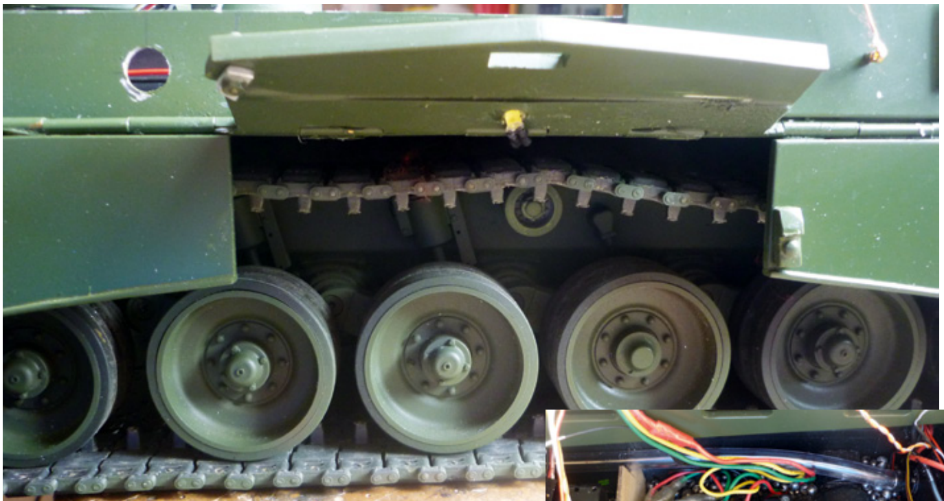
Der Kettenschutz kann zu Reparaturzwecken geöffnet werden
