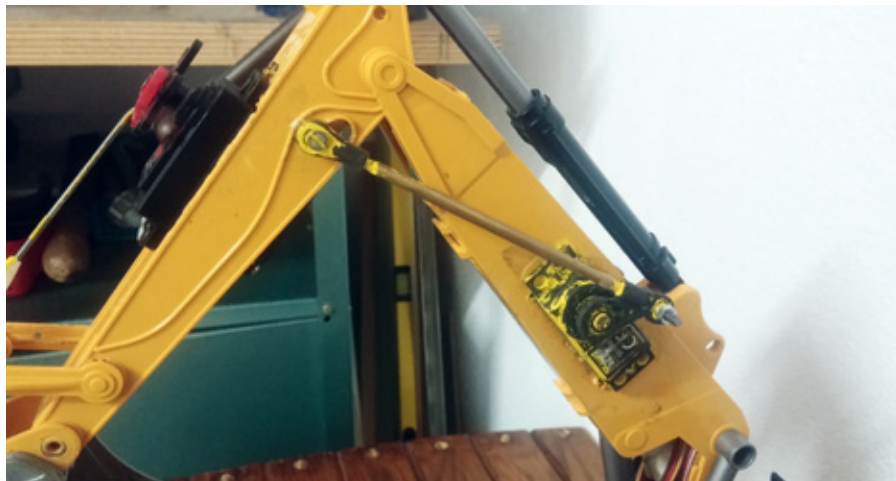
Die Anlenkung für den Schaufelarm wurde seitlich montiert und ist sehr stabil
