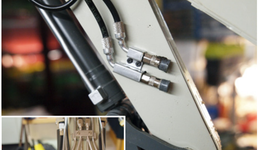
Die Schnellkupplung hat zwei Zusatz-Anschlüsse
