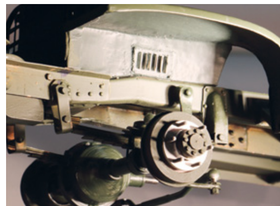
Eingebaute Vorderachse mit Lenkgestänge: Die Umlenkung befindet sich im Rahmen, dort wo im Vorbild das Lenkgetriebe ist
