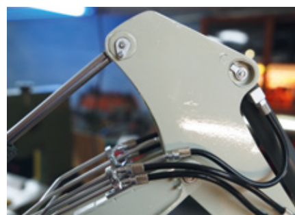
Die Leitungen wurden sauber am Ausleger und am Stiel des R960 SME entlanggeführt
