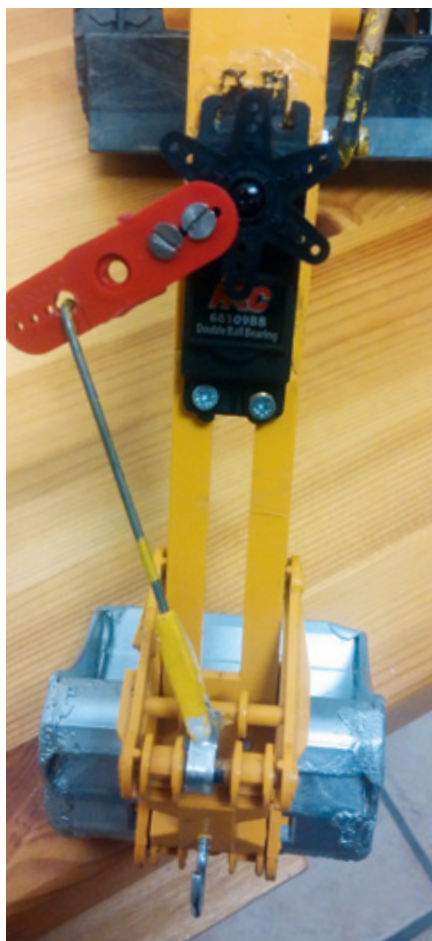
Das Servohorn wurde verlängert, um den größtmöglichen Lenkausschlag zu erhalten
