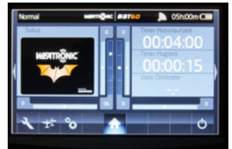
Im Hauptbildschirm werden der Modellname, die Trimmstellungen und in unserem Fall die Timer angezeigt. Welche Werte dort zu sehen sind, ist frei programmierbar. So lässt sich auch ein Bild vom Modell hinzufügen und auch die Menüleiste erweitern
