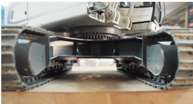
Der Deckel am Unterwagen verschließt die Öffnung. Der Zylinder wird am A-Block aufgenommen
