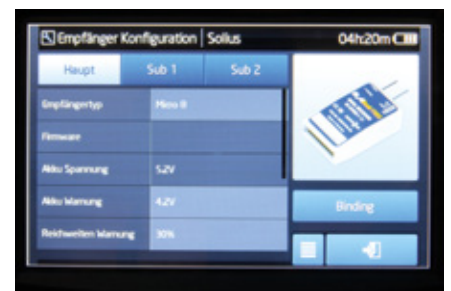
Während der Empfängerkonfiguration kann das Binding erfolgen. Auch der Schwellenwert für die Empfänger-Akkuwarnung lässt sich anpassen
