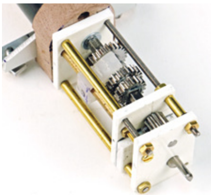
Das Dreigang-Schaltgetriebe: Gut zu erkennen ist die Schaltgabel
