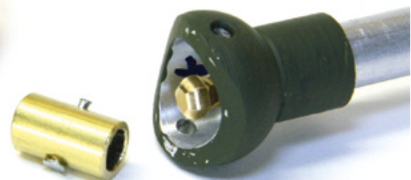
Die Vorderachsende mit Aufnahme für das Schwenklager und die Verbindungsmuffe des Antriebs mit Innensechskant geben dem Modell Beweglichkeit
