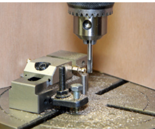
Der Antriebssechskant entsteht auf der Fräsmaschine
