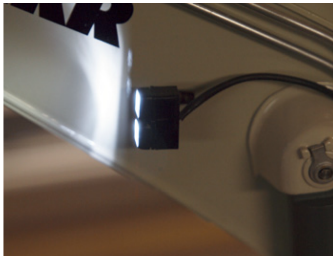
Pro Seite sind zwei LED am Ausleger erhältlich. Gut ausgeleuchtet kann im Arbeitsbereich nichts übersehen werden
