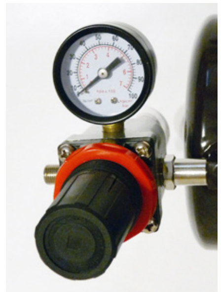
Das Manometer erlaubt die schnelle Kontrolle des Drucks, durch Herausziehen des oberen Rings ermöglicht der schwarze Regler eine Einstellung des Luftdrucks
