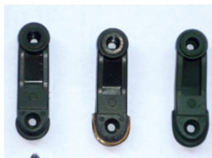
Da die Original-Schwinghebel (links) an der unteren Seite nach einiger Zeit aufplatzen, habe ich sie verstärkt (mitte). Rechts ist die fertig-lackierte Komponente zu sehen
