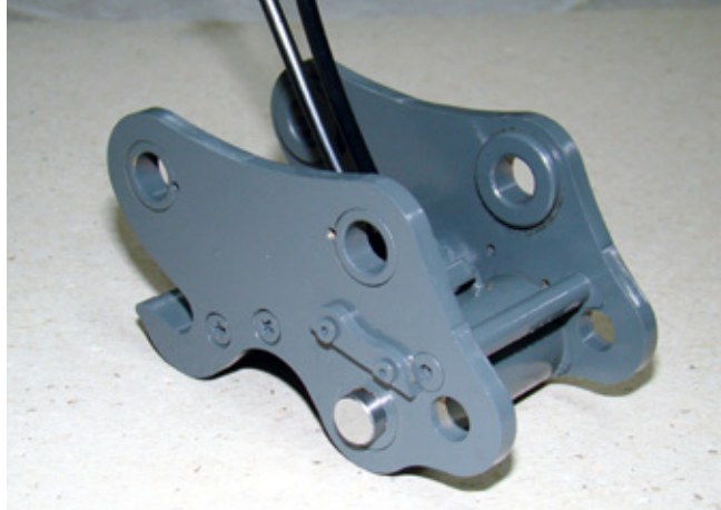
Der fertig lackierte Schnellwechsler: Die Verriegelungsbolzen sind hier ausgefahren
