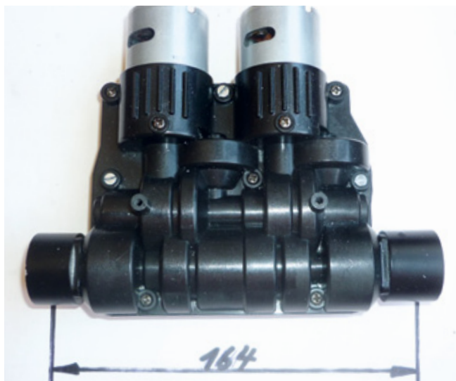
Die Antriebseinheit wurde um 40 mm verlängert
