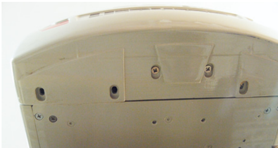
Die Kehrseite des Oberwagens – Von hier aus werden verschiedene Einbauten verschraubt
