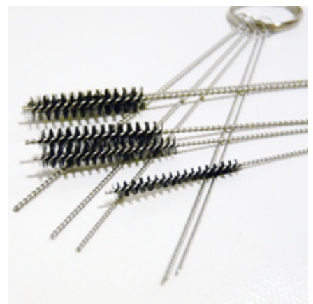
Lösungsmittelhaltige Farben erfordern eine Säuberung mit speziellen Reinigern. Dies ist aufwändiger und erfordert solche Putzhilfen
