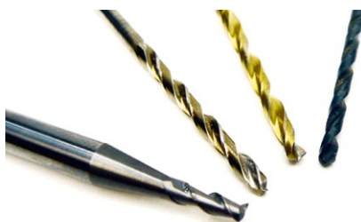
Bohrer dürfen natürlich nicht fehlen, wieder passend zum Einsatzbereich mit unterschiedlichen Beschichtungen und Winkeln der Spiralen zur optimierten Spanabfuhr
