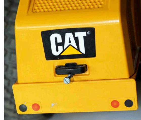
Eine kleine M2,5-Schraube dient als Sicherungssplint, damit die Motorhaube geschlossen bleibt
