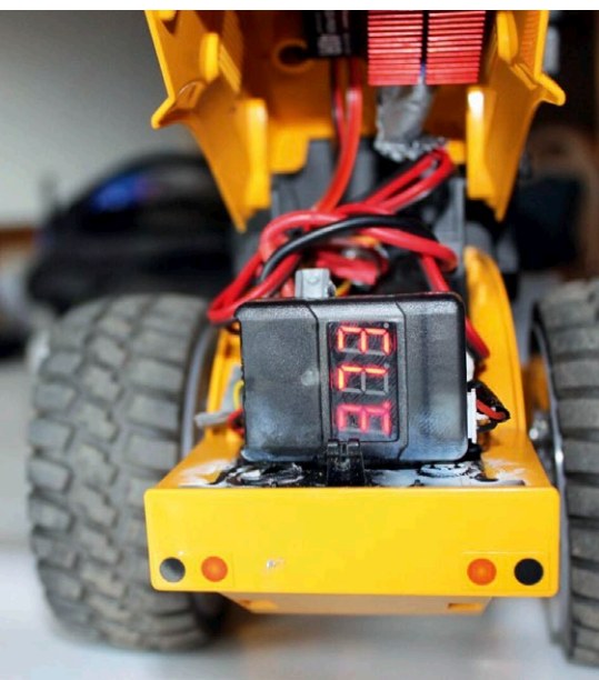
Der LiPo-Wächter schlägt bei leerem Akku Alarm und gibt Auskunft über den Akkustand
