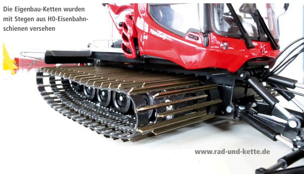
Bis der fein detaillierte, vordere Geräteträger überall freigängig ist, verlangt es ein vorsichtiges Nacharbeiten der Lagerbolzen und Kolbenstangen
