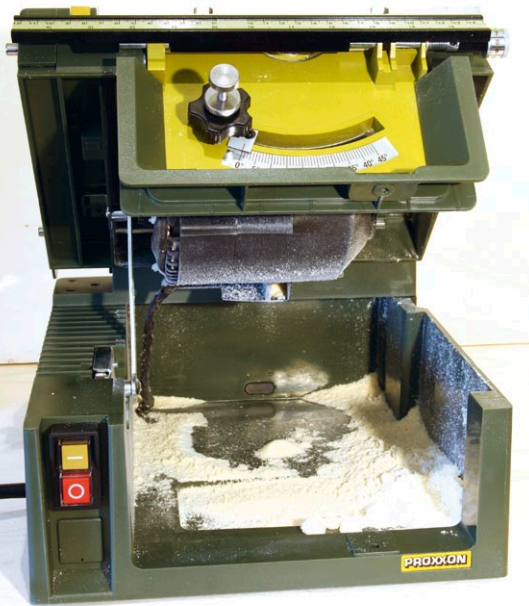
Trotz angeschlossenem Staubsauger cw-Matic bleibt viel Sägespäne im Gehäuseinneren zurück. Feiner Staub wird hingegen zuverlässig abgesaugt
