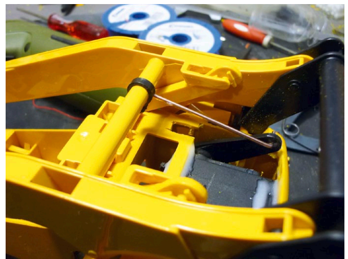
Das Gestänge zum Heben des Arms besteht aus Federstahlsraht der Stärke 2 Millimeter
