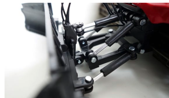
Bis der fein detaillierte, vordere Geräteträger überall freigängig ist, verlangt es ein vorsichtiges Nacharbeiten der Lagerbolzen und Kolbenstangen
