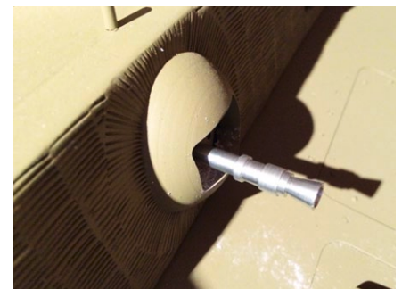
Das selbst gedrehte Bord-MG ist eines der vielen kleinen Details des Panzers IV
