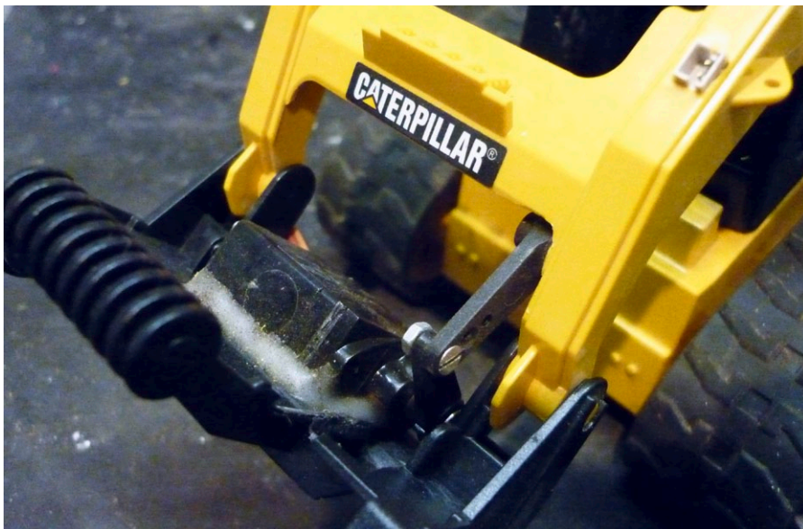
Über eine Umlenkung wird der Servoarm mit der Schaufel verbunden
