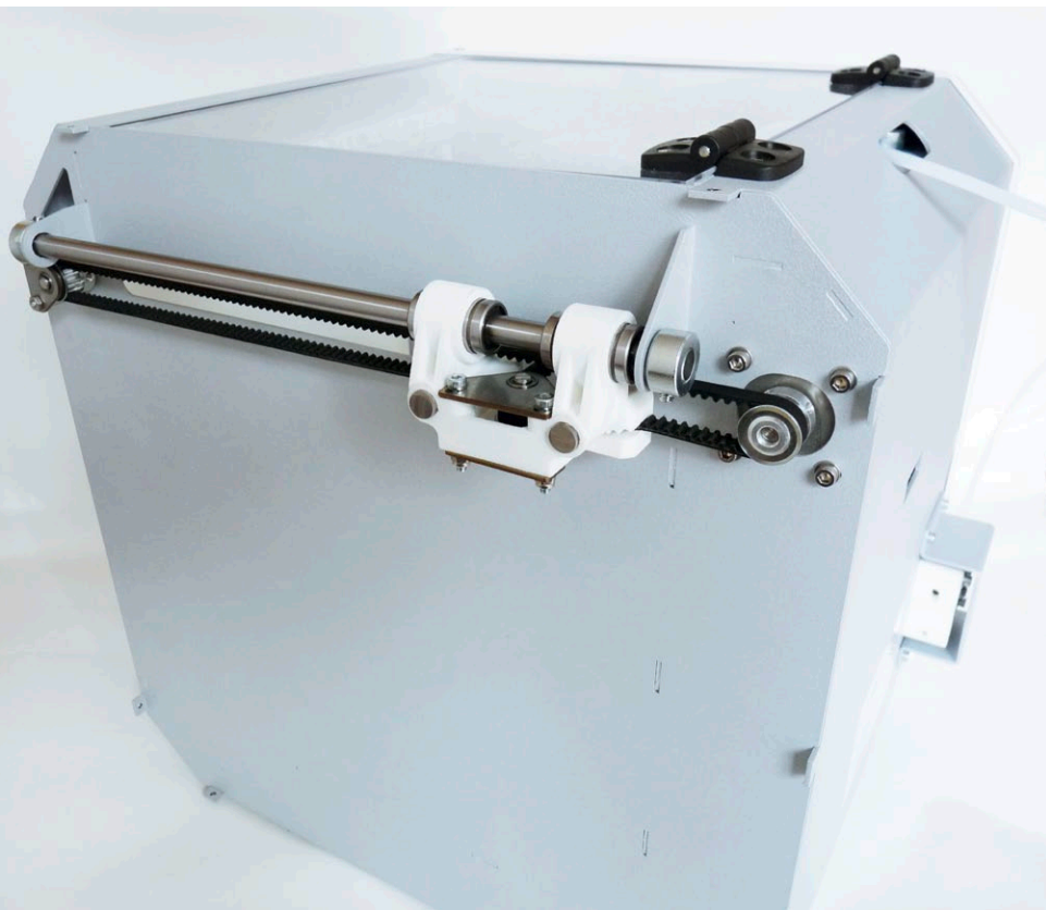
Einfachere CNC-Maschinen nutzen eine simplere Linearführung. Diese sind meistens zwar nicht für hohe Belastungen ausgelegt, dafür aber sehr auf Geschwindigkeit optimiert
