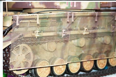
Die Thoma-Schürzen im Detail: Sie bestehen aus engmaschigen Drahtgittern
