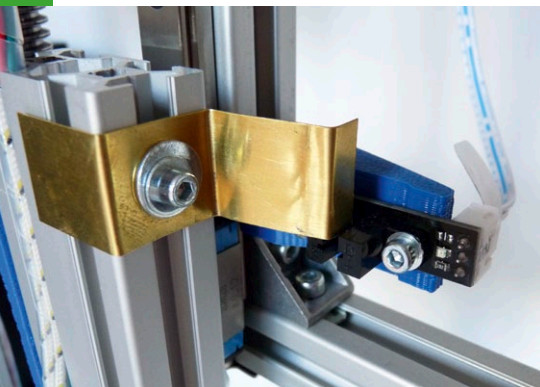
Das vorgebogene Messingblech musste an der Z-Achse etwas angepasst werden, damit die Lichtschranke sauber ausgelöst wird
