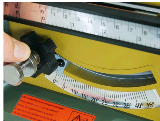
Für Gehrungsschnitte lässt sich das Sägeblatt stufenlos bis 45 Grad neigen
