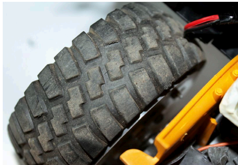
Die Reifen wurden mit zwei Schrauben auf der Rohrmuffe befestigt. Sie wurden so weit festgezogen, bis sie ein hartes Profil bekamen
