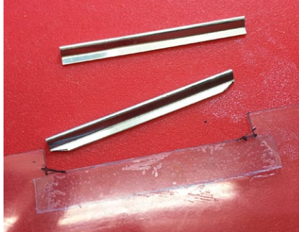
Wenn 240 Mal der gleiche Schnitt verlangt wird, bedient man sich am besten einer einfachen Schablone
