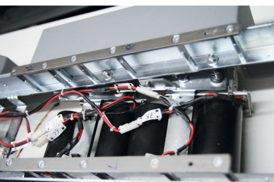
Hier sind die vier Fahrmotoren zu sehen, die an den Getrieben angeflanscht sind – jeweils zwei pro Achse
