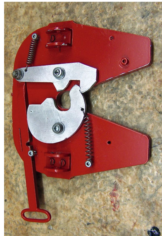
Die Sattelplatte ist ein Highlight der Schwerlast-Zugmaschine. Sie lässt sich per Fernsteuerung öffnen
