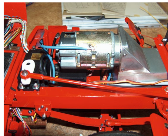
Der große Bühlermotor mit Getriebe: links das Lenkservo, unten das Schaltservo
