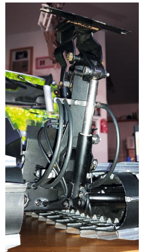
Die Schläuche werden nun auch an der Wanne angebracht
