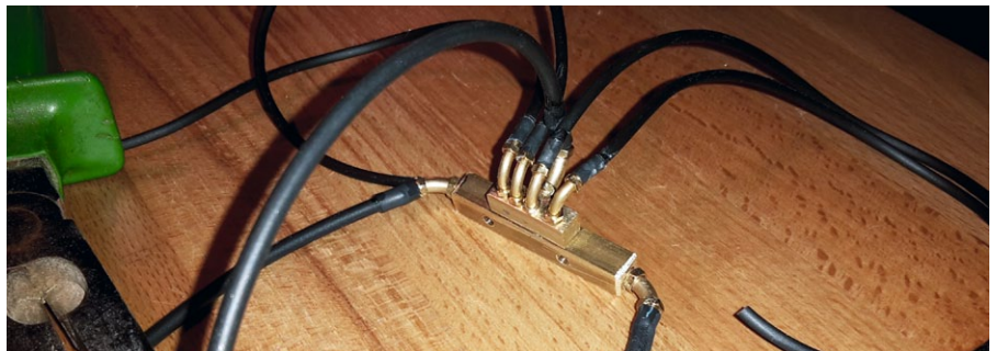
Der Hydraulikverteiler mit den einzelnen Schläuchen ist eines der Projekte, die den Umbau ausmachen
