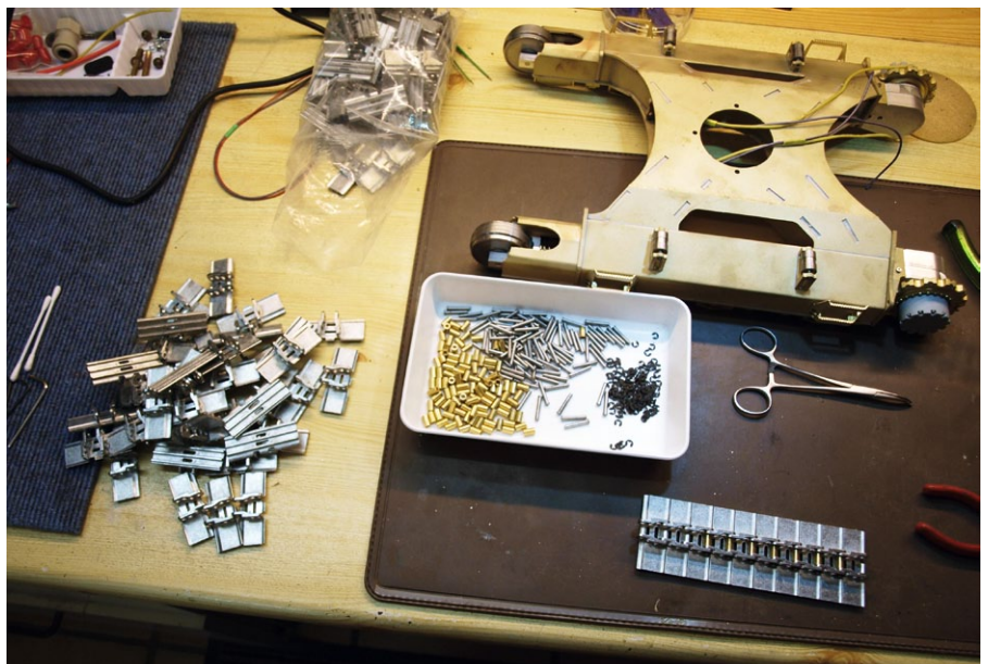
Die einzelnen Kettenglieder mit den Kettenbolzen, den Messingbuchsen und den Sicherungsringen
