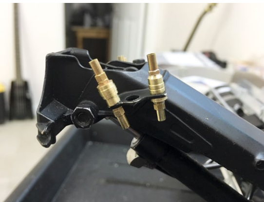
Die Hydraulikanschlüsse am Hubarm sind Drehteile
