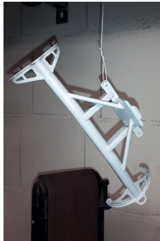
Der Fräsenräger wurde grundiert, bevor er eine neue Lackierung bekam
