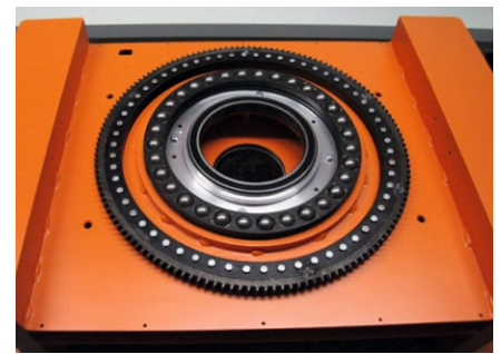
Dies ist die Lagerung für den Oberwagen. Im Unterwagen sieht man ein Axiallager und ein Rillenkugellager, darunter sind noch mal je ein Axial- und ein Rillenkugellager sowie der Zahnkranz zum Drehen des Oberwagens. Letzterer ist ein Anlasserkranz eines John-Deere-Traktors
