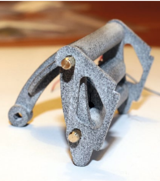
Die Gehäuseteile für den Schnellwechsler entstanden per 3D-Druck
