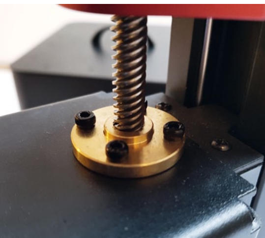
Die Spindel-Mutter der Z-Achse macht einen guten Eindruck
