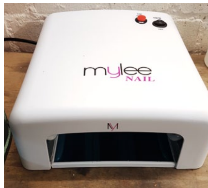
Mit einer kostengünstigen Fingernagel-UV-Lampe können kleinere Druckteile gut durchgehärtet werden
