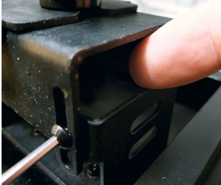
Für das Homing wird die Druckplatte an vier Inbusschrauben festgezogen, wenn die Achse den Nullpunkt angefahren hat
