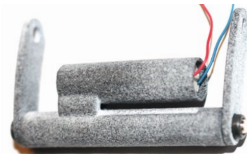
Die Verriegelung der Anbauteile mit dem Schnellwechsler wird über elektrisch betriebene Bolzen realisiert
