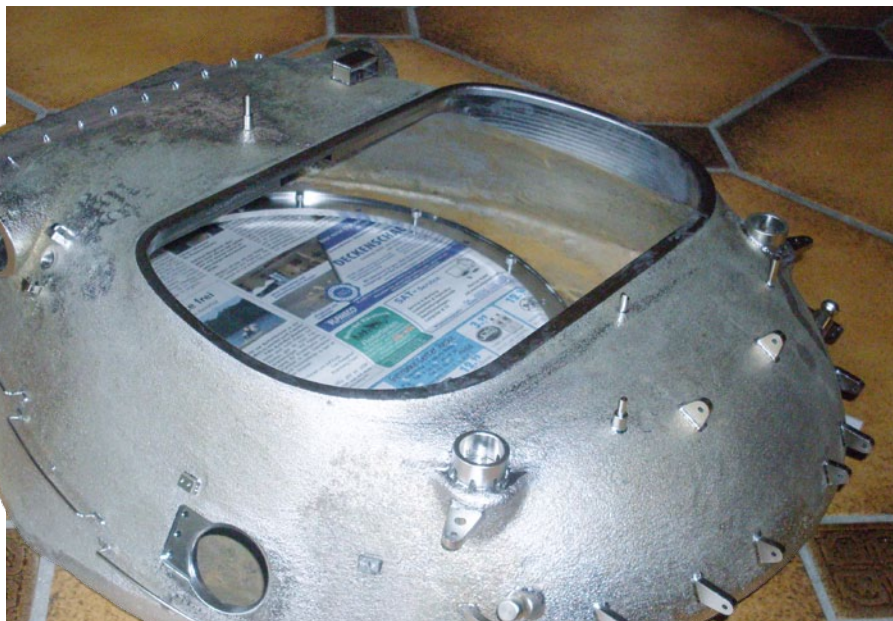
Das Turmgehäuse aus massivem Stahlguss
