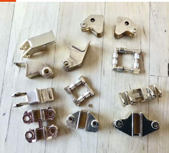
Man kann Kosten sparen, wenn man kleine Teile für das Drucken kombiniert und anschließend trennt
