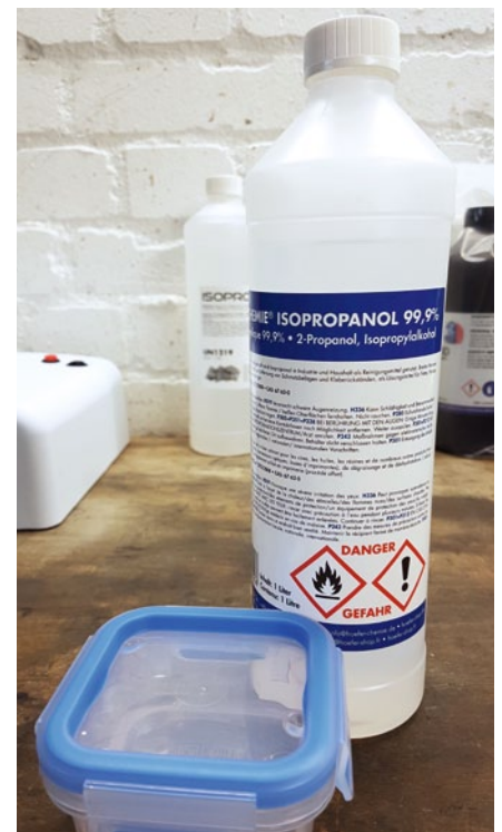
Zum Reinigen von Druckteilen sowie der D7-Harzwanne und Druckplatte wird Isopropanol benötigt
