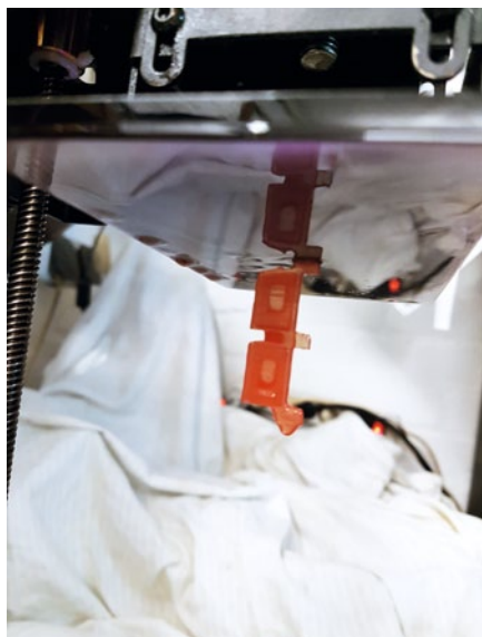
Das Leopard-Kettenglied ist fertig gedruckt. Das Bauteil entsteht kopfüber
