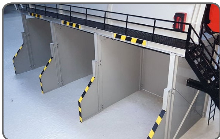
Die drei Kammern, in denen das Erdreich sortiert wird, sind per LED-Stripes beleuchtet
