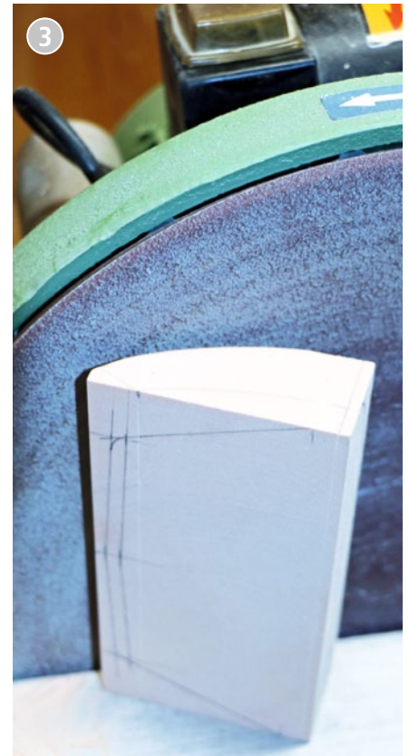
3 Bearbeitung des Teils an der Schleifscheibe
