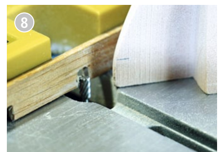
8 Mit der Fräse wird mit einem 3-mm-Stiftfräser noch rundum ein Falz eingearbeitet
