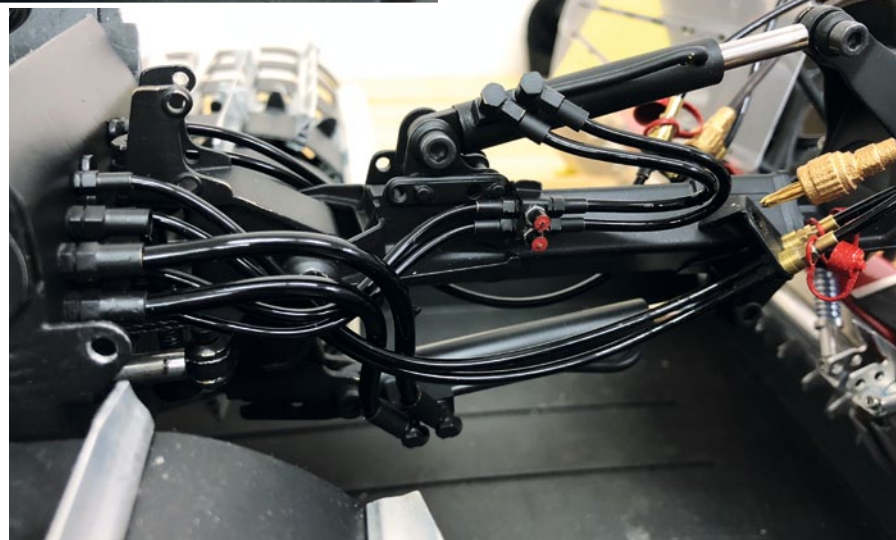
Originalgetreue Schlauchführung und Anschlüsse beim Heckgeräteträger
