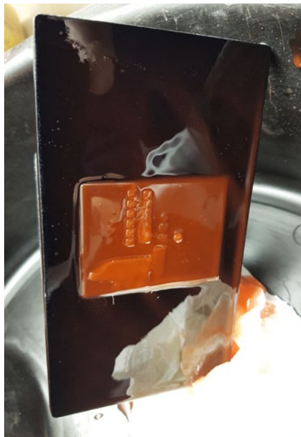
Frisch aus dem Drucker: Das Kalibrierungsteil haftet gut an der Druckplatte
