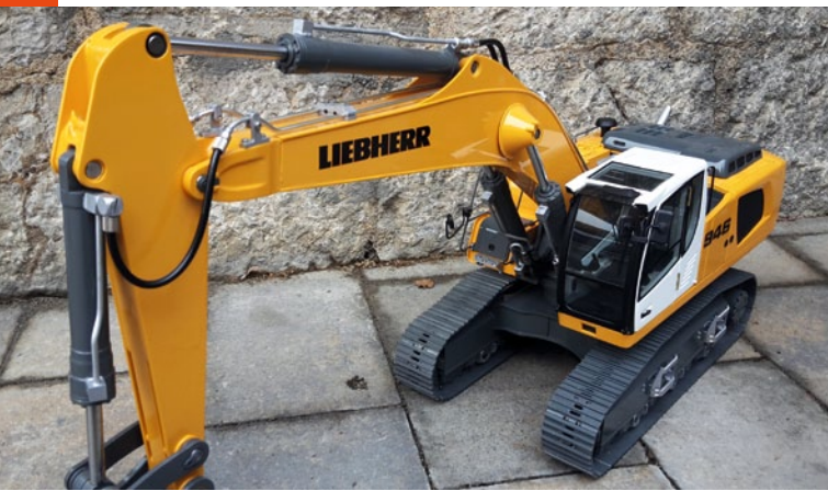
Der Monoblock ist in diesem Fall ohne zusätzlichen Hydraulikleitungen ausgeführt
