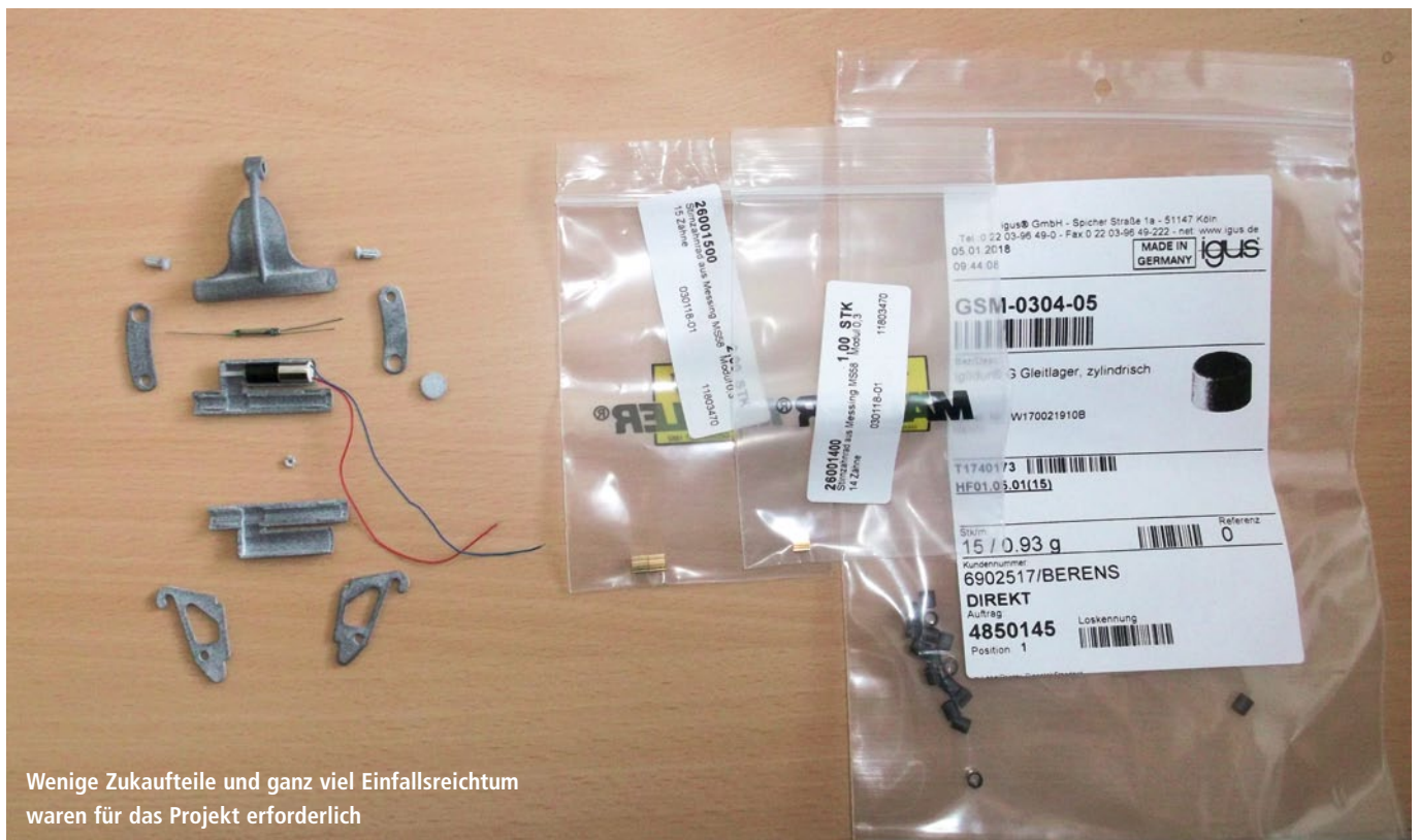
Die Gehäuseteile für den Schnellwechsler entstanden per 3D-Druck
