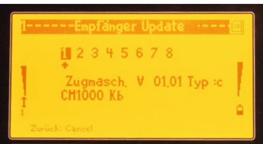
Sollten mehrere Empfänger gekoppelt sein, kann man einen einzelnen auswählen; die aktuell installierte Software wird angezeigt
