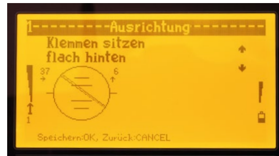
Der verbaute Empfänger muss vom Sender aus justiert werden, damit später die Lagesensoren korrekte Werte anzeigen
