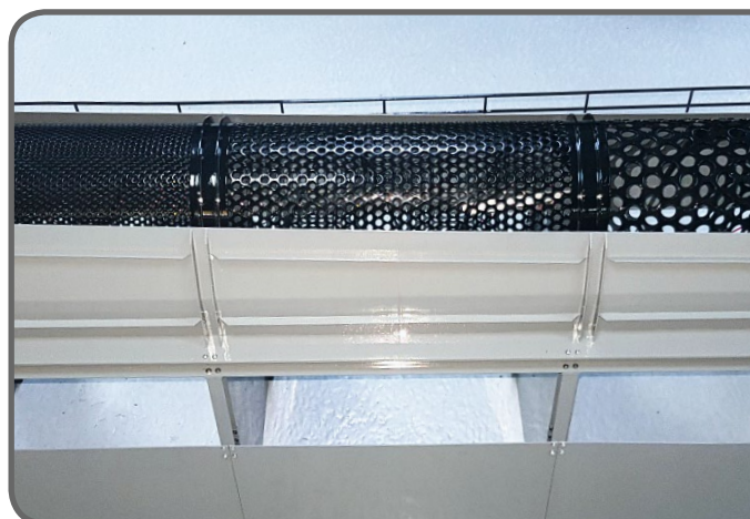
Gut zu erkennen sind die unterschiedlichen Lochgrößen der Trommel
