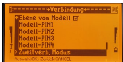
Über die Funktion „Zweitverbindungs Modus“ kann man zwei Modelle gleichzeitig mit dem Commander koppeln und dann blitzschnell zwischen ihnen umschalten
