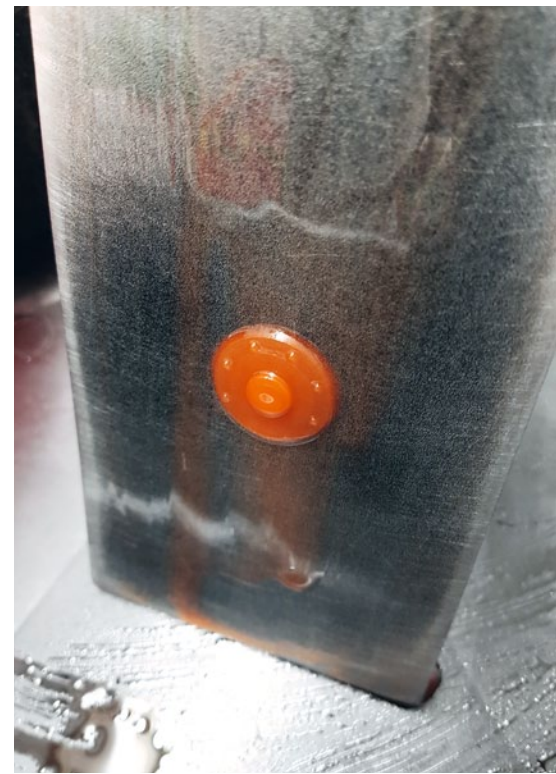
Die LKW-Radkappe ist fertig gedruckt. Sie muss jetzt noch von der Druckplatte gelöst und anschließend mit Isopropanol gereinigt werden
