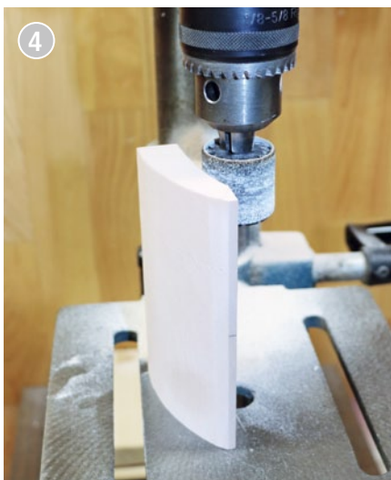
4 Formen der inneren Hohlform mittels Rundscheifer in der Säulenbohrmaschine
