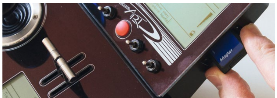
Unter der seitlichen Abdeckung befindet sich der SD-Card-Slot, in den eine handelsübliche Speicherkarte des Typs SD passt. Da die zu übertragenden Dateien nicht besonders groß sind, reicht auch eine abgelegte Micro SD-Karte aus dem alten Handy mit Adapter
