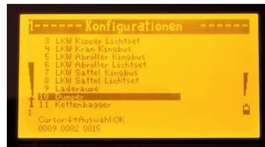
Im Konfigurations-Menü findet sich eine passende Einstellung für Rad- und Kettendumper
