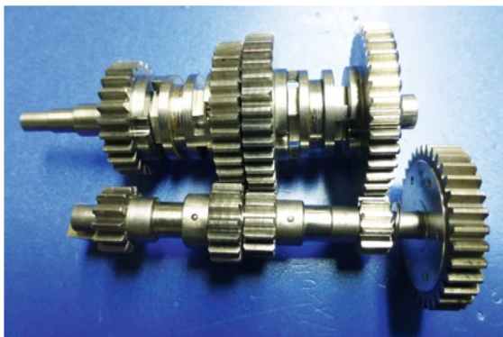
Unten die Vorgelegewelle, darüber die Schaltwelle. Zwischen den Radpaaren befinden sich die Schaltmuffen
