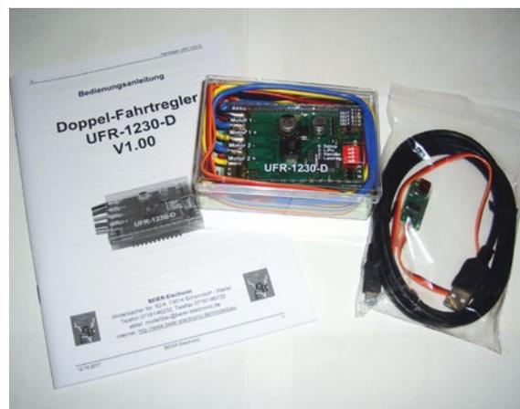
Die Bestellung: Der Doppelfahrregler UFR-1230-D mit Anleitung in Deutsch. Das Datenkabel K-USB-2 wurde zusätzlich bestellt
