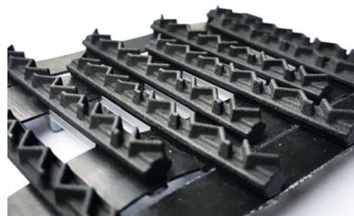
Die X-Track-Kette ist für den untergrundschonenden Geländeeinsatz entwickelt worden
