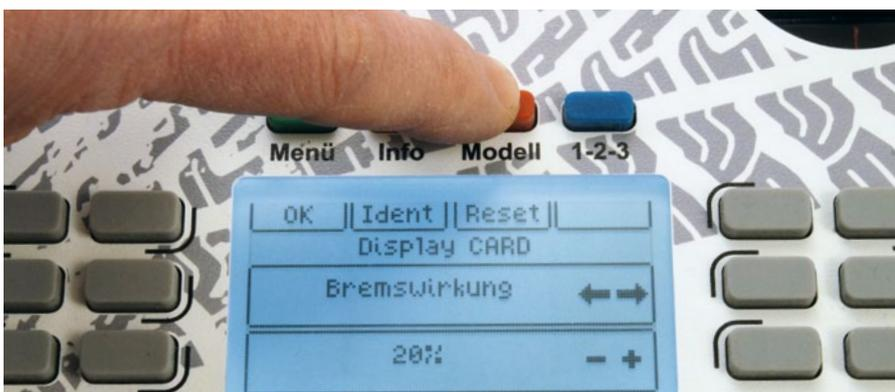
Durch Drücken der roten „Reset“-Taste wird der Wert auf Werkseinstellung zurückgesetzt
