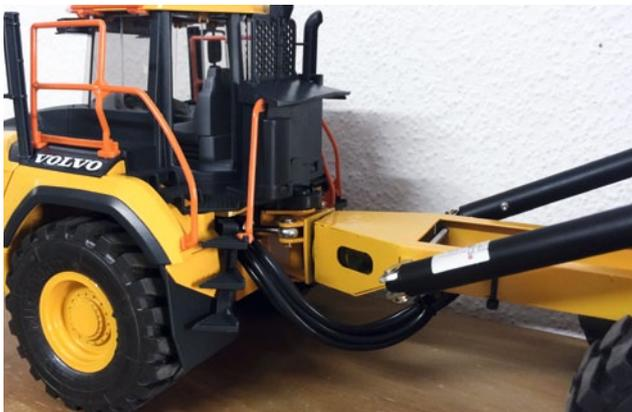
Die Knicklenkung wird durch zwei im Vorderwagen platzierte Titan 30-Zylinder realisiert
