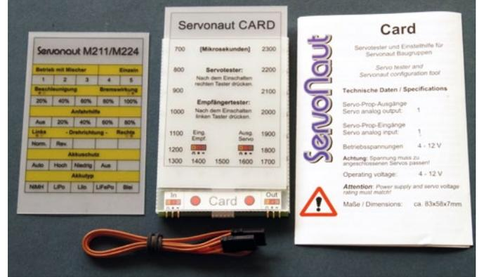
Der Servotester CARD ist als Servo- und Empfängertester sowie als Einstellhilfe für alle kompatiblen Servonaut-Produkte ein überaus praktisches Hilfsmittel
