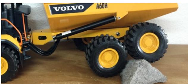
Die Achsen aus Alu weisen eine gute Verschränkungsfähigkeit auf, die Motoren sind in den Achsen integriert
