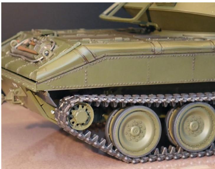
Das Modell verfügt über eine gefederte Aufhängung für jede einzelne Laufrolle
