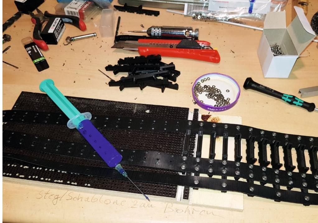
Schraubensicherungslack befindet sich in der Spritze. In jedes Gewindeloch wurden einige Tropfen gefüllt, um ein „Freirappeln“ der Schrauben auf unwegsamem Gelände zu verhindern
