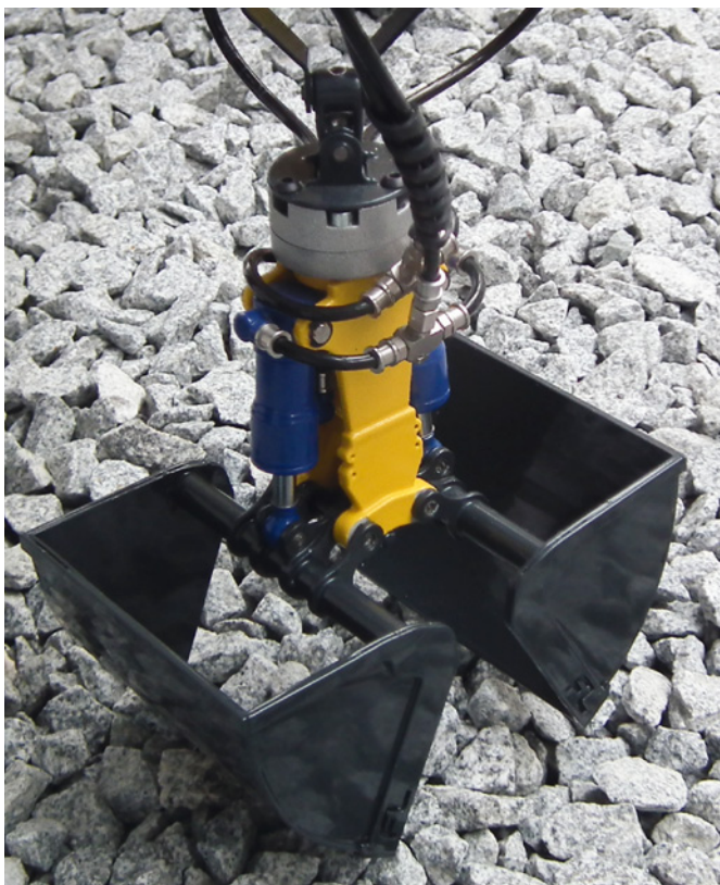
Beim Zweischalengreifer nehmen zwei gegeneinander schiebende Löffel Ladung auf
