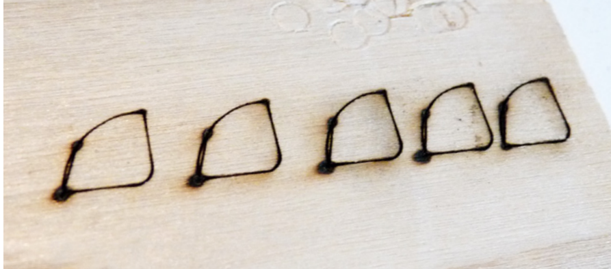
Von links nach rechts: Anzahl der Umläufe zum Durchschneiden der 5-Millimeter-Sperrholzplatte mit zwei-, drei-, fünf-, acht- und zuletzt 24-fach. Selbst beim letzten Versuch blieb noch etwa die Hälfte des Materials stehen. Der Laser ist allerdings auch nicht für derlei Arbeitsschritte ausgelegt
