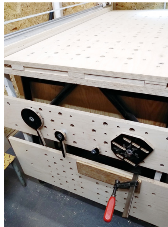
Die Vise gibt es als Bauvorschlag. Mit ihr können stirnseitig auch hohe Werkstücke bearbeitet werden
