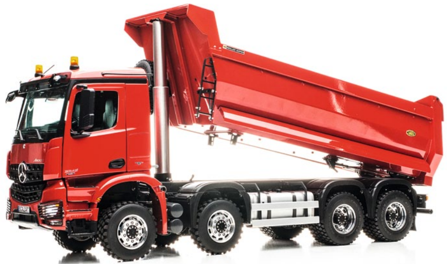
Die Zylinder lassen sich bei allen bestehenden ScaleART-Modellen nachrüsten, lediglich ein zusätzliches Ventil muss dann noch angebaut werden
