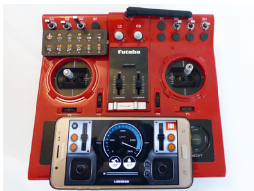
Gleiche Aufteilung bei App-Steuerung und Funktionsmodellbau-Handsender: Kreuzknüppel und Schieberegler sowie ein Zusatzbutton auf der App-Steuerung für die Klappschaufel
