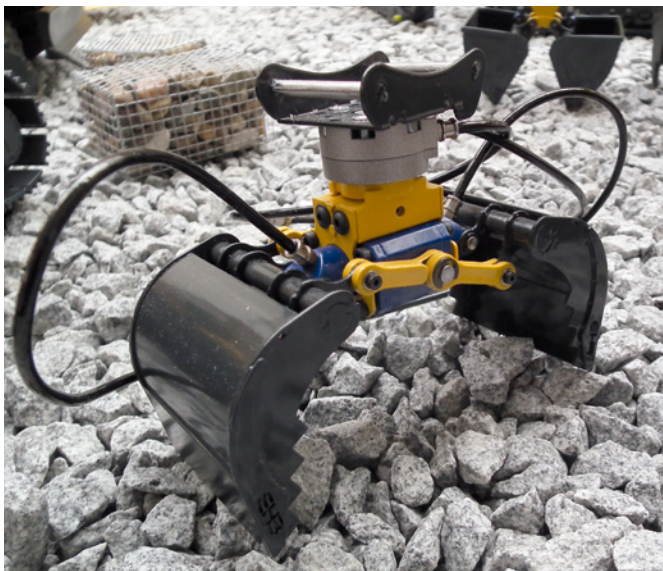
Der Sortiergreifer ist eine Sonderform des Zweischalengreifers
