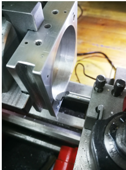
Ausdrehen des Grundkörpers, der die Maße 70 x 70 x 20 Millimeter hat und ebenfalls aus Aluminium besteht
