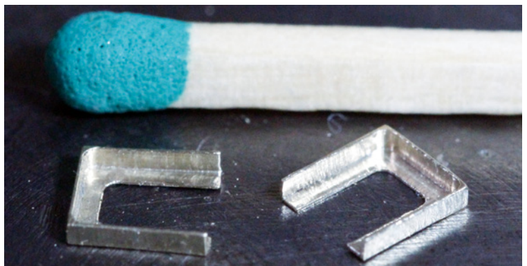
Abb. 18) Vor dem Lackieren rundum sauber entgraten
