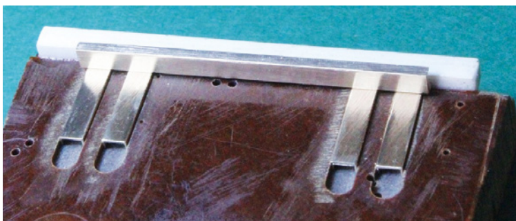
Abb. 22) Die lange U-Schiene wird beim Löten an die weiße PVC-Kante angelegt. Danach wird das Ganze umgekehrt und die zweite U-Schiene angelötet
