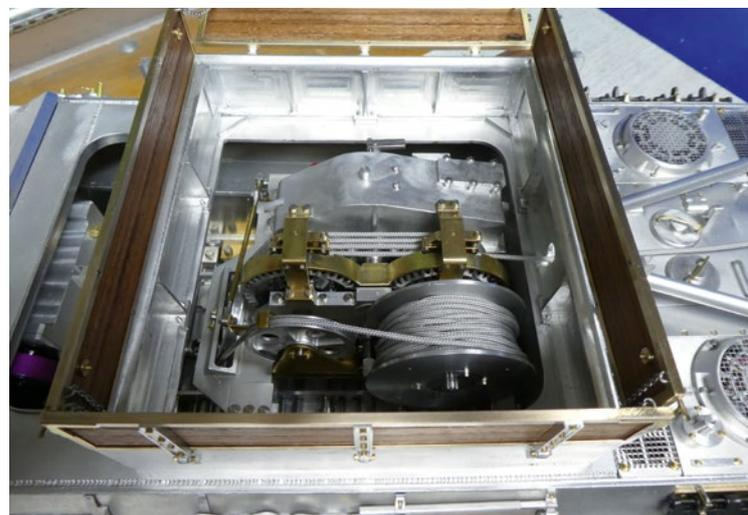
Blick auf die eingebaute Seilwinde
