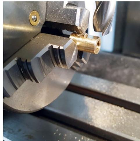
An der Fräse: Anfertigen der Gewindehülsen
