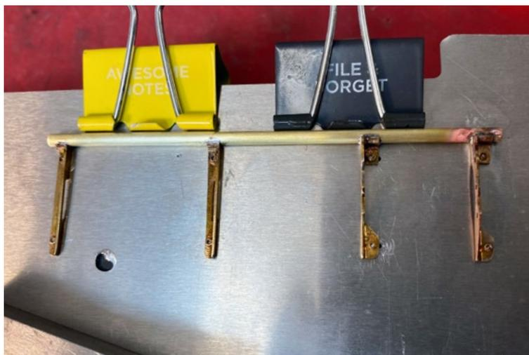
Lötshablone für den Überwurfschutz mit CNC-gebohrten Befestigungslöchern
