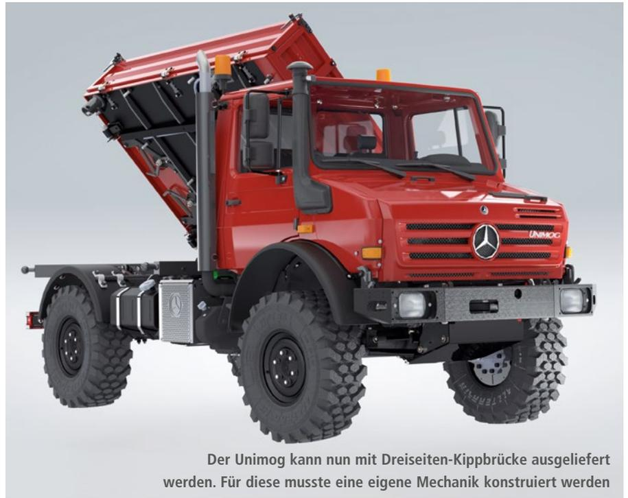
Der Unimog kann nun mit Dreiseiten-Kippbrücke ausgeliefert werden. Für diese musste eine eigene Mechanik konstruiert werden
