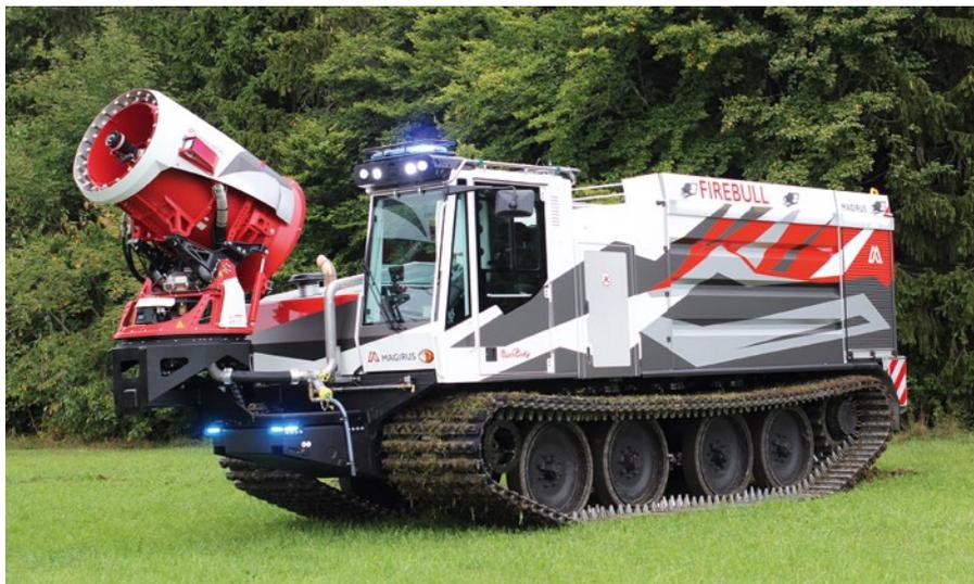
Vorgestellt von Magirus: Der Löschpanzer mit 9.000 l Wasser, 1.000 l Schaummittel und einer AirCore-Turbine, die um 360 Grad dreh- und schwenkbar sowie vollbeweglich einsetzbar ist
