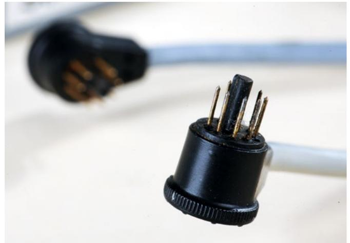
Weitere Herausforderung bei der Auswahl des richtigen Servos: Steckerformen, -belegungen und Drahtfarben sind unter den verschiedenen Herstellern nicht einheitlich
