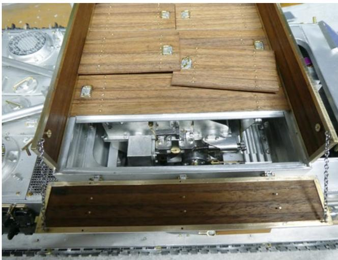
Unter der Windenabdeckung befindet sich die Seilwinde
