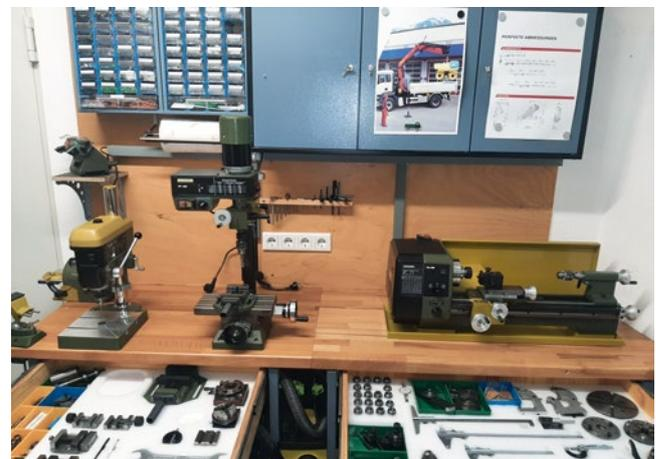
Martin Vogel setzt auf eine gut strukturierte Werkstatt – unterhalb von Drehbank und Fräse hat er die passenden Werkzeuge in passenden Schubfächern organisiert
