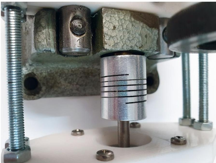
Blick auf die montierte Wellenkupplung. Sie verbindet den Schrittmotor mit der Spindel der jeweiligen Achse
