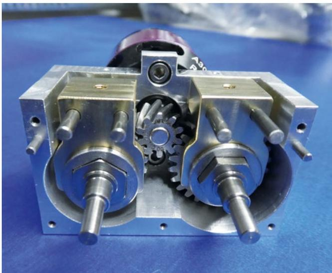
Fertig aufgebautes Schaltgetriebe für Winde und Fahrtrieb ohne Hauptlagerdeckel
