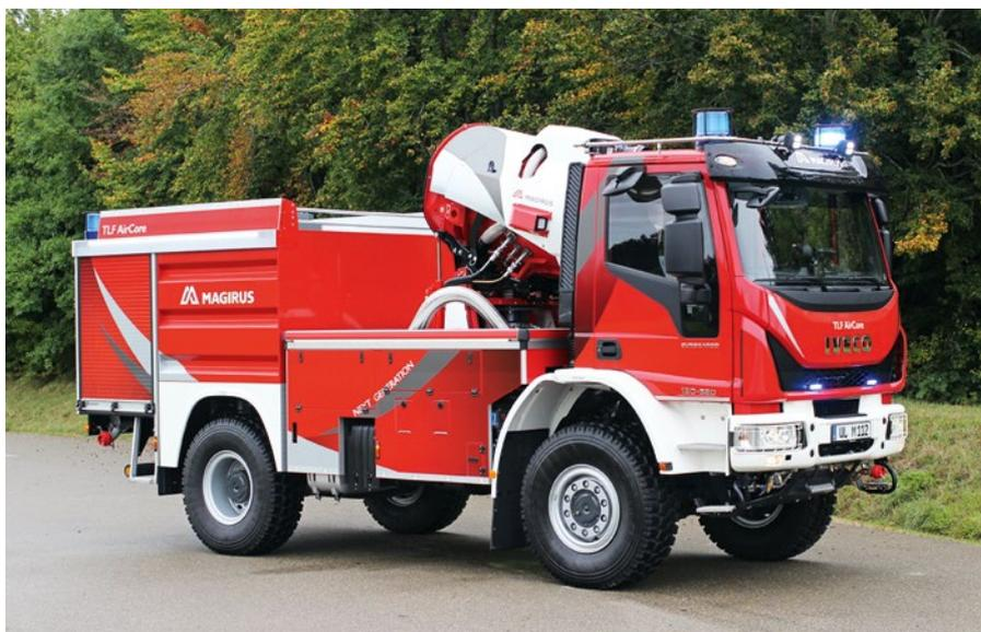
Tanklöschfahrzeug TLF AirCore auf Eurocargo FF 150E32 WS, 4x4 mit Scherenhubbühne und AirCore-Turbine MFT 60-H
