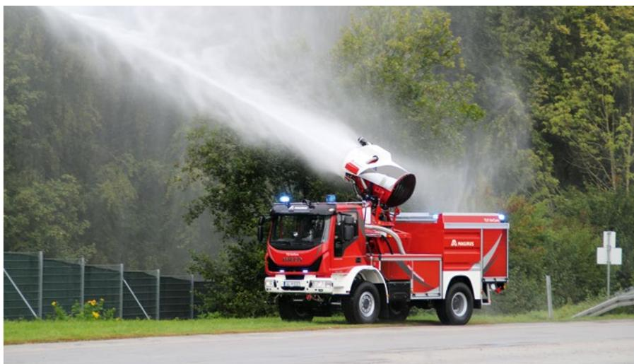
Das TLF AirCore zeigt seine Einsatzfähigkeit. Es hat eine Durchflussleistung bis zu 6.000 l/min
