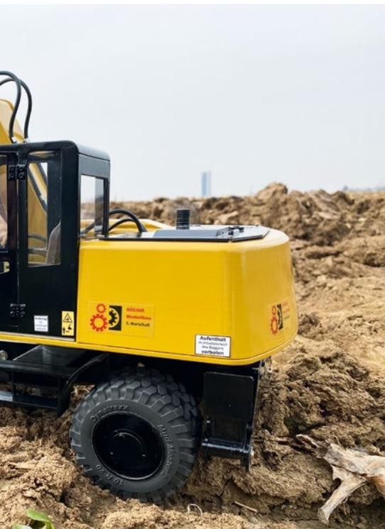
Alle Bauelemente des Baggers sind aus hochwertigen Alu-Fräs- und Drehteilen gefertigt. Die Karosserie ist aus Kunststoff 3D-gedruckt, das Fahrerhaus besteht aus 3D-Druckteilen mit Scheiben aus Plexiglas
