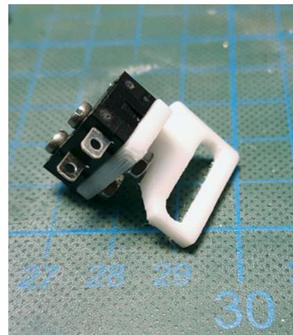
Gedruckte Halterung für Mikroschalter
