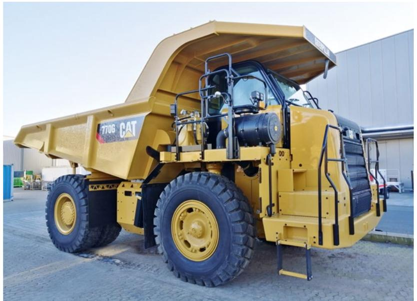
Der Muldenkipper 770G mit einer Nenn-Nutzlastklasse von 38,2 Tonnen
