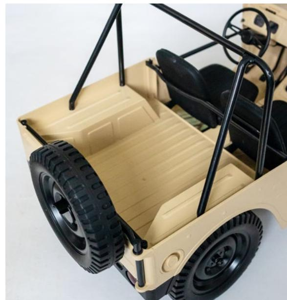
Über Schrauben lassen sich die hinteren Bügel an den Radkästen befestigen
