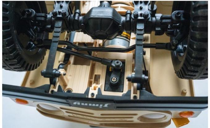
Direkt hinterm Kühlergrill sitzt das kraftvolle Lenkservo. Mechanisch ist der Ausschlagwinkel so begrenzt, das etwa anderthalb Meter Platz für eine 180-Grad-Kurve nötig sind
