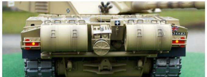
Auffälliges Detail: Die beiden Treibstofffässer. Damit ist der Panzer serienmäßig ausgestattet, um seine Reichweite zu erhöhen
