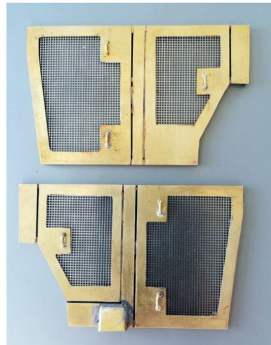
Geätzte Gitter und Messingblech bilden die neuen Seitenwände
