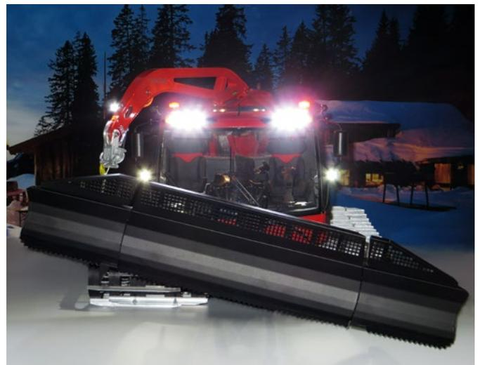
Das Schild verfügt über eine Tiltfunktion, mit der sich das Anbaugerät horizontal und seitlich kippen lässt
