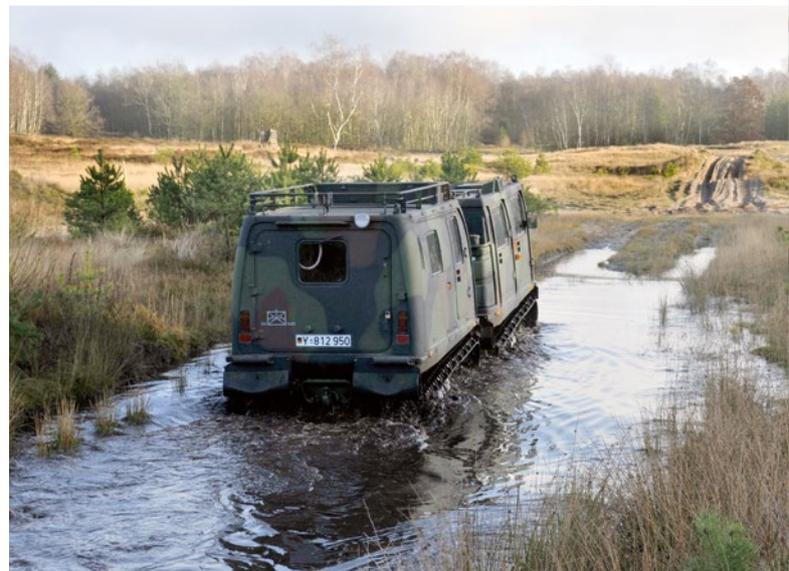
Der Hägglunds kann auch im Wasser fahren. Dort schafft er eine Geschwindigkeit von drei Kilometer pro Stunde. Zu Land wie im Wasser wird das Fahrzeug über seine Laufbänder angetrieben
