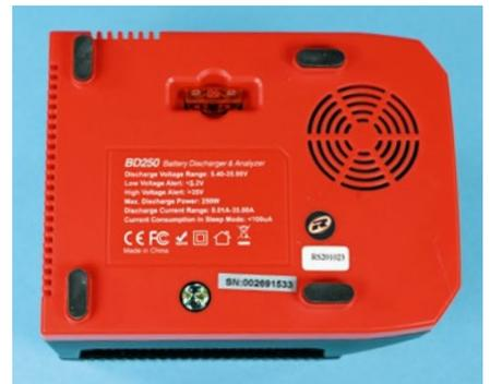
Ein Fach für eine Flachstecksicherung aus dem Kfz-Bereich gibt es auf der Geräte-Unterseite
