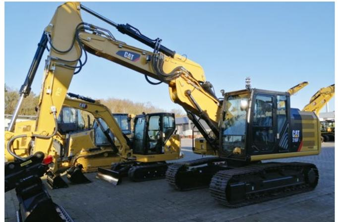
Der kleine Hydraulikbagger 316FL ist mit seinem kompakten Design gut geeignet für Abbrucharbeiten
