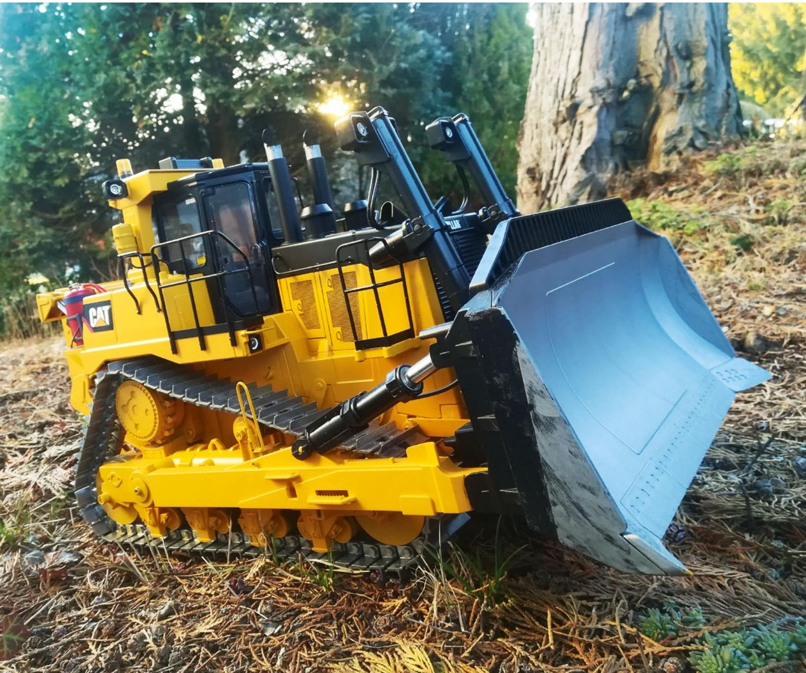
Eine Schubraupe ist ständig in Bewegung, also ist die robuste Ausführung des Fahrtriebs Voraussetzung für einen reibungslosen Betrieb. Ich entschied mich, den Antrieb mit zwei Getriebemotoren in Verbindung mit dem Doppelfahrregler von Servonaut zu realisieren. Die Antriebe für das Schild und den Heckaufreißer plante ich, mit Spindelantrieben im Eigenbau auszuführen. Zusätzliche Detaillierung, Beleuchtung und ein Soundmodul sollten optisch und akustisch für einen vorbildgetreuen Eindruck sorgen.
