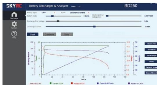
In Verbindung mit einem PC gibt es noch weitere Möglichkeiten, beispielsweise zur Überwachung von Entladevorgängen
