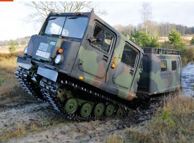
Hängt der Vorderwagen einmal in der Luft, weil der Rampenwinkel zu spitz ist, schiebt der Hinterwagen das Fahrzeug über die Rampe bis der Vorderwagen wieder Grip hat
