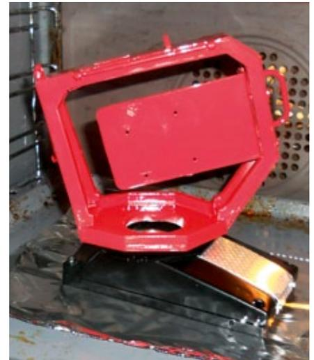
Die einzelnen Teile der Winde wurden im Backofen mit dem Industrielager fest verklebt. An besonders beanspruchten Stellen wird die Konstruktion zusätzlich mit Schrauben gesichert
