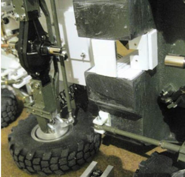
Platz für die Aufnahme der Getriebebox. Um die hohen Drehzahlen des Modell-Elektromotors in eine passende Geschwindigkeit umzusetzen, wird hier ein Felgen-Planetengetriebe mit einer Untersetzung von 5:1 eingebaut
