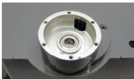
Der Kettenradantrieb ist glücklicherweise kugellagert
