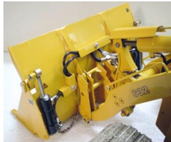
Die Bewegung der Klappe an der 4-in-1-Schaufel erfolgt über zwei Hubzylinder. U-Profile halten die Schlauchführung in geordneten Bahnen
