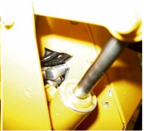
Die Hydraulik wurde beim LR 632 komplett überarbeitet. Aus Platzgründen mussten die Hauptleitungen über Eckverschraubungen im Freien zum Hubzylinder geführt werden
