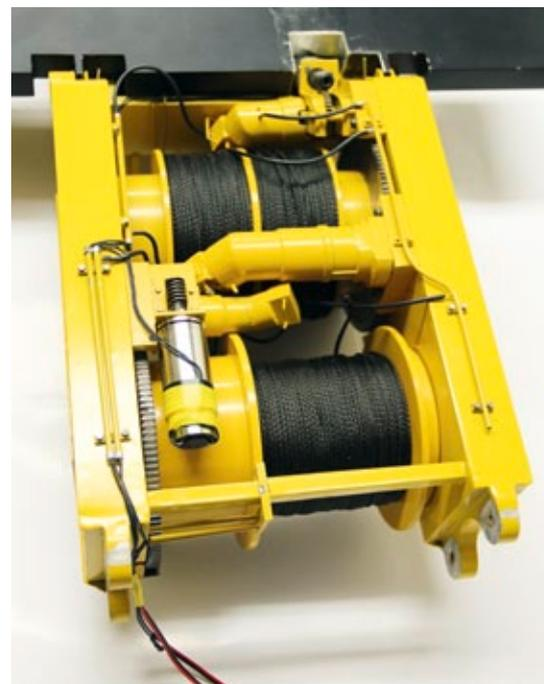
Der geteilte Oberwagen von unten. Die Attrappen der Hydraulikmotoren mit den dazugehörigen Leitungen sind gut sichtbar
