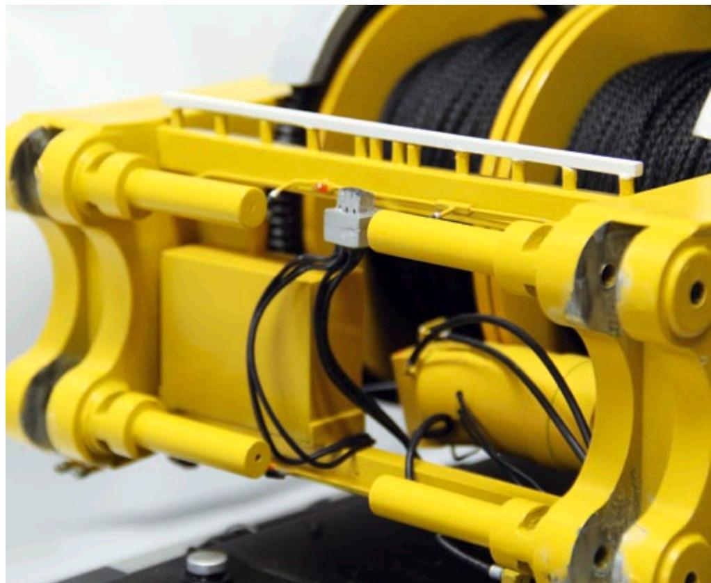
Die Trennstelle am Oberwagen. Da hier höchste Präzision gefragt ist, wurde das Bauteil im CNC-Verfahren hergestellt
