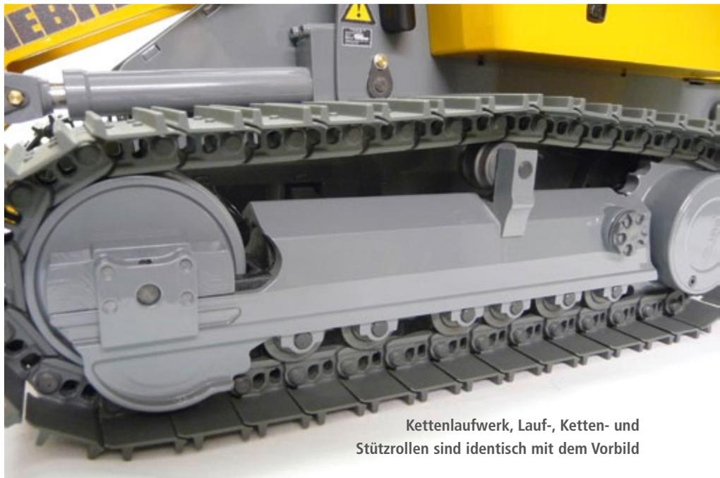
Kettenlaufwerk, Lauf-, Ketten- und Stützrollen sind identisch mit dem Vorbild
