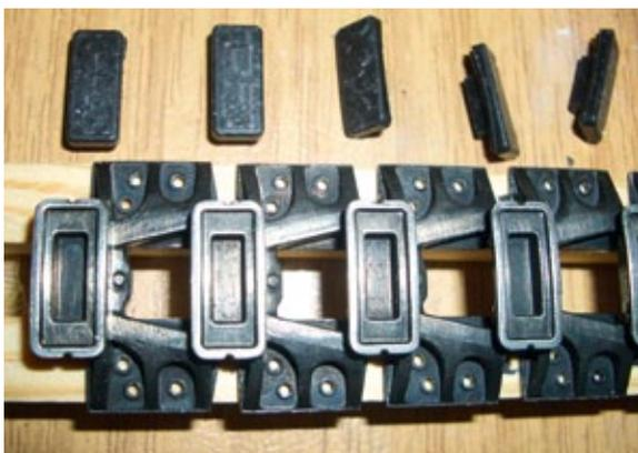
Die Kettenpolster aus Gummimaterial müssen in die Kettenglieder eingeklebt werden. Eine aufwändige Arbeit, bei der Anzahl
