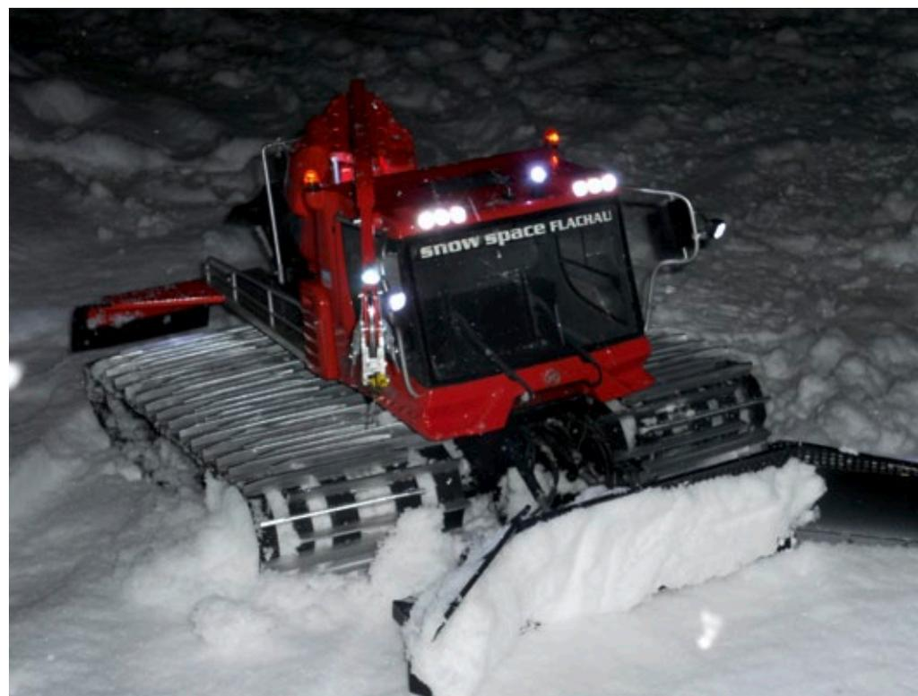
Wie beim Vorbild ist auch beim PistonBully PB 300 polar eine kräftige Beleuchtung Grundvoraussetzung für die Arbeit im weißen Element. Auch am Windenarm wurden entsprechende LED verbaut
