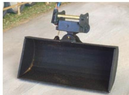
Schwenkbarer Grabraumlöffel mit Knickschutz an den Leitungen. Das Servo für die Neigung des Löffels ist voll integriert. Unten ist der Drehpunkt für die Bewegung und oben ist die Aufnahme für den Schnellwechsler angebracht
