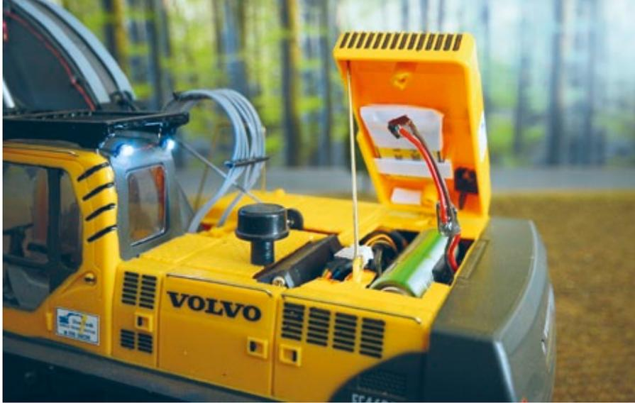
Um den Fahrakku zu schonen, wurde für die Beleuchtung ein zusätzlicher Akku unter der Motorhaube untergebracht
