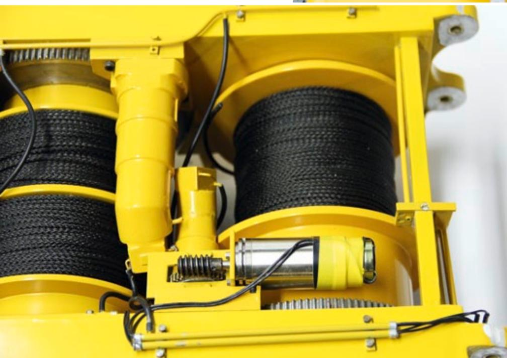
Die beiden Seilwinden für Ausleger- und Maxiliftverstellung. Gut sichtbar ist der Schneckenantrieb von der Verstellwinde des Hauptmastes
