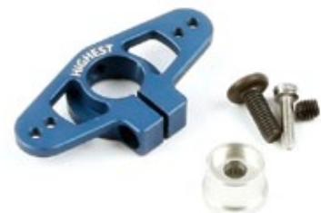
Für die neuen Highest RC-Servos im Vertrieb von Robitronic gibt es nun Servohörner aus Aluminium, die die Möglichkeit bieten, die Anlenkung an jedem beliebigen Punkt zu montieren – man braucht auf die 25-Zahn-Rasterung also keine Rücksicht zu nehmen. Das Horn wird an der gewünschten Position geklemmt und mit einer Wurmsschraube fixiert.
