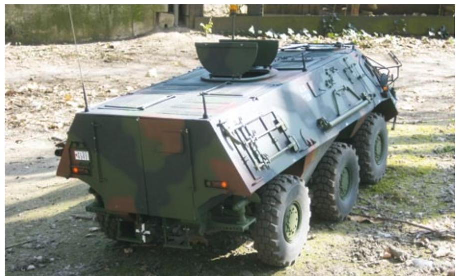
Auch die Rückseite erfolgte vorbildgetreu. Als Material dient beim Modell allerdings kein Metall sondern Polystyrol
