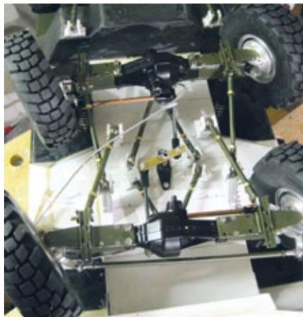
Bei der Detailansicht vom Fahrzeug fällt auf, dass nur die vorderen beiden Achsen – analog zum Vorbild – angelenkt werden
