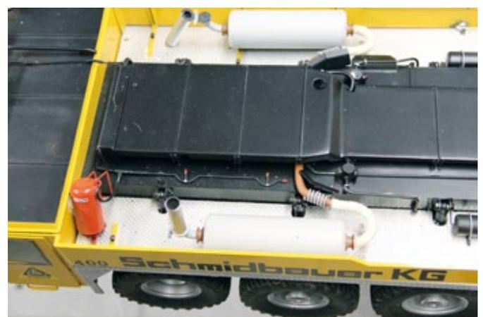
Der Oberwagen – gut sichtbar die Details der Feuerlöschanlage und Schalldämpfer
