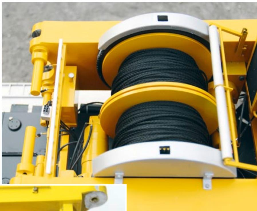
Die Hubwinden mit den Nummern Eins und Zwei im vorderen Teil des Oberwagens, der Antrieb erfolgt durch Stirnrad-Getriebemotoren
