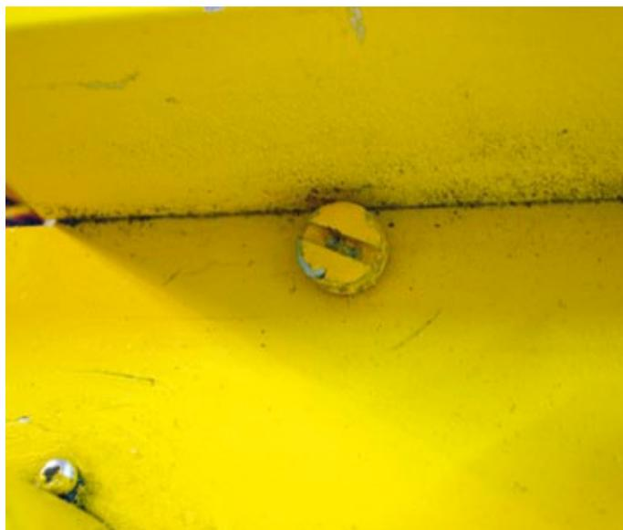
Klein aber fein: Über diese verschließbare Öffnung gelangt man an die Regelschraube fürs Überdruckventil
