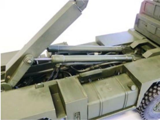
Der Hubzylinder in Aktion. Die Hydraulik des Modells arbeitet mit einem Betriebsdruck von 15 bar
