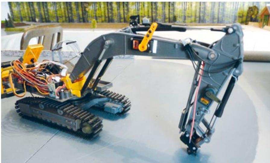
Oben am Ausleger das verlängerte Servohorn und der abgeänderte Stielzylinder. Somit lässt sich der Arm wie beim Original bewegen und für den Transport zusammenlegen
