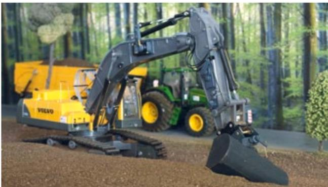
Der schwenkbare Grabräumlöffel im Einsatz
