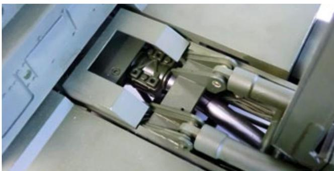
Das Dreigang-Getriebe von ScaleART mit 10-Millimeter-Kardanwellen aus Edelstahl
