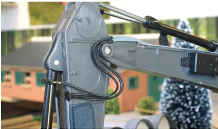
Die Hydraulikleitungen am Übergang von Ausleger zum Stiel wurden so originalgetreu wie möglich aus Computerlitze, Drahtlitze und Schrumpfschlauch nachgebildet
