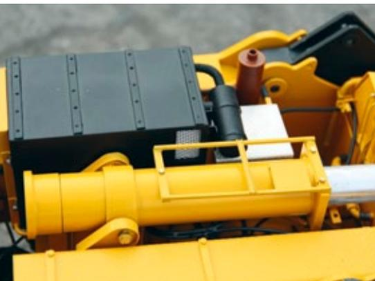
Der Oberwagen mit der Rückfallstütze in Transportstellung
