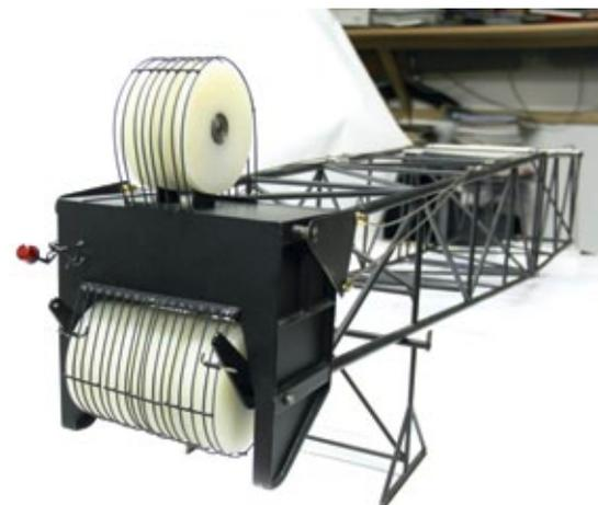
Der Mastkopf mit Seilrollen, Windmesser und dem roten Kollisionslicht an der Seite. Als Seil dient ein 2 mm starkes schwarzes Kunststoffseil, das direkt von einer Seilerei bezogen wurde
