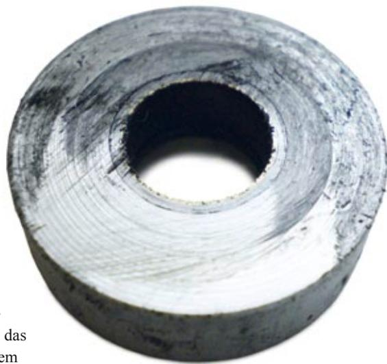
Die alte Laufwerkslagerung war aus Aluminium und schon etwas abgenutzt. Ersetzt wurde sie durch ein Bauteil aus Stahl
