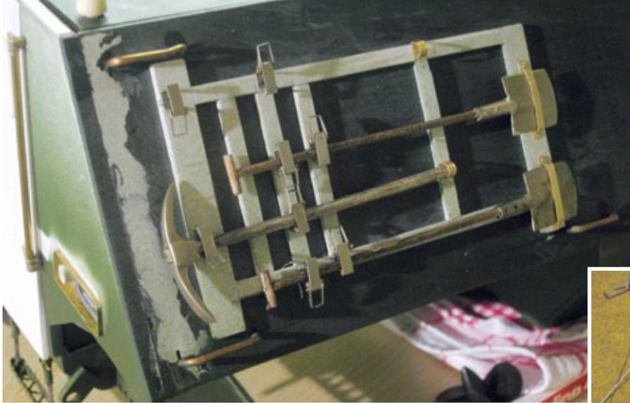
Die Werkzeughalterungen entstanden aus einer Ätzplatine, die Anfertigung dieser Kleinteile ist sehr filigran
