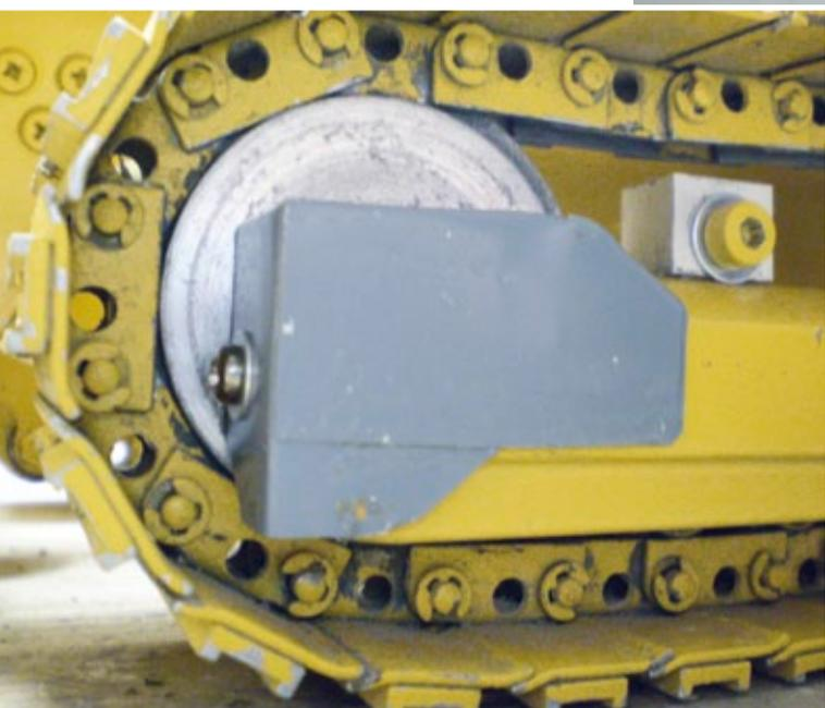
Dieses neu montierte Schutzblech sorgt für deutlich weniger Verschleiß beim Betrieb des Kettenfahrzeugs
