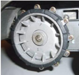
Die Kettenantriebsräder sind mit Gummibandagen bestückt und die Mitnehmerrollen sind beweglich. Natürlich wird hier noch eine Radkappe angebracht, sodass die Befestigungsschraube abgedeckt wird
