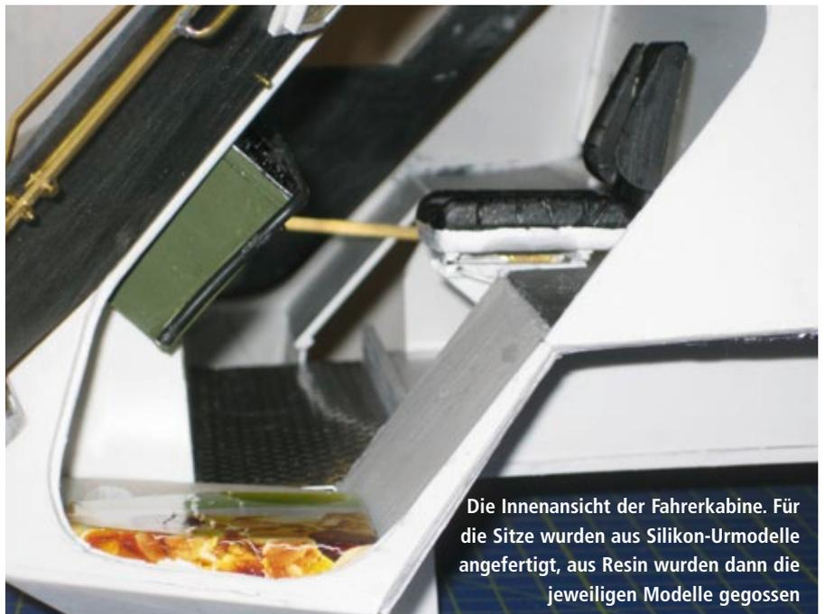
Die Innenansicht der Fahrerkabine. Für die Sitze wurden aus Silikon-Urmodelle angefertigt, aus Resin wurden dann die jeweiligen Modelle gegossen
