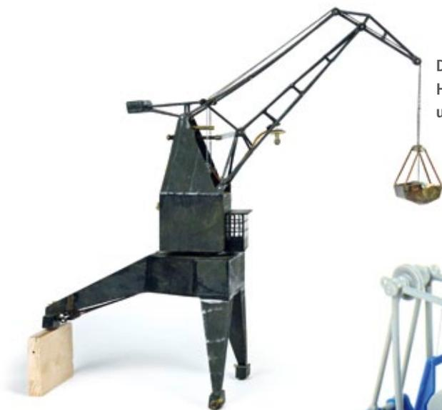
Der Verladekran für die HO-Bahn, ohne Laufschienen und Stromkontaktbahnen
