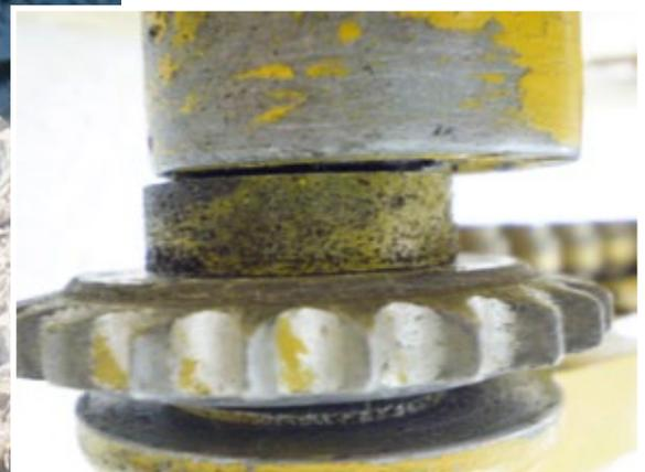
Der neue Turas mit Stützring. Dieser vergrößert die Wellenauffläche und stützt sämtliche einwirkenden Kräfte in Richtung Lager und Maschinengehäuse ab
