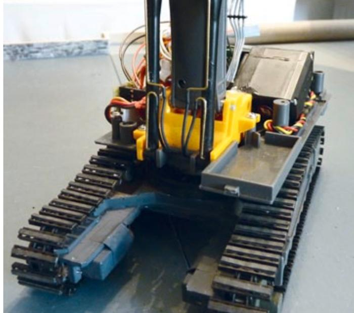
Die modifizierten LEGO-Bodenplatten, auf die dünne Gummistreifen aufgeklebt wurden, sind hier gut sichtbar
