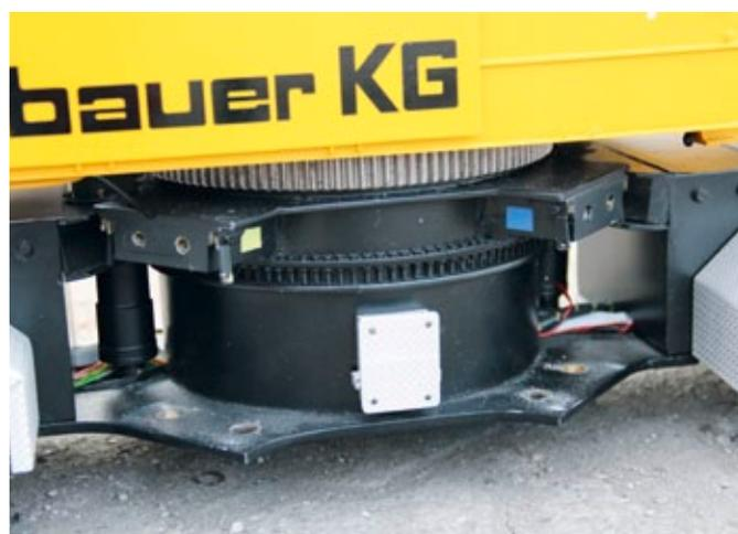
Detailansicht vom Topf, in Fahrstellung mit montierten Kotflügel
