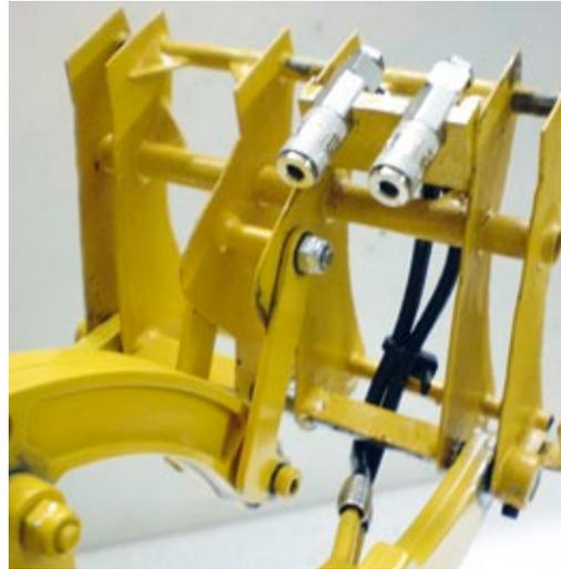
Die Schlauchführung am Wechsellader. Hier ohne entsprechend montiertes Arbeitsgerät
