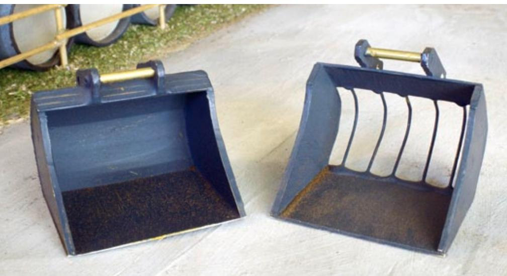
Die eigens aus Polystyrol-Platten gefertigten und sehr robusten Tief- und Sieblöffel
