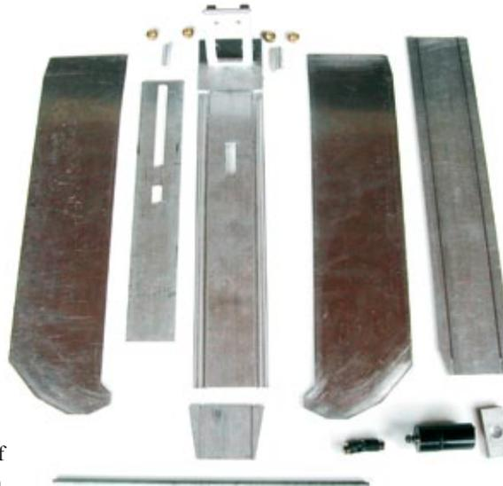
Die große Stütze in ihren Einzelteilen. Die Herstellung der einzelnen Stücke erfolgte per Hand und war entsprechend aufwändig
