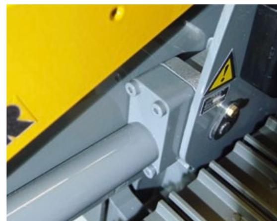
Die Technik der Hubzylinder verschwindet quasi unsichtbar hinter dem Hauptrahmen
