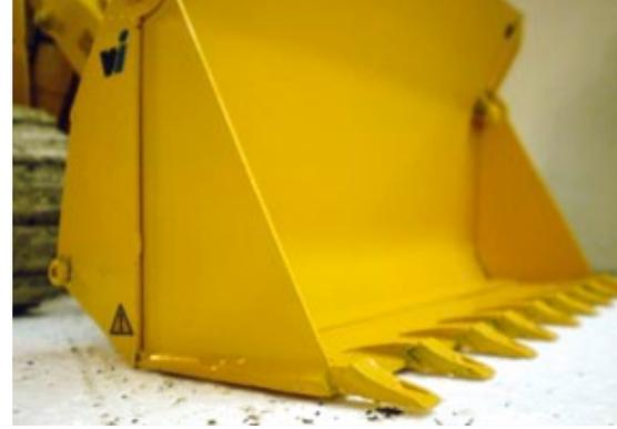
Speziell die Herstellung der 4-in-1-Schaufel war eine knifflige Angelegenheit. Als Grundmaterial dient verzinktes Blech
