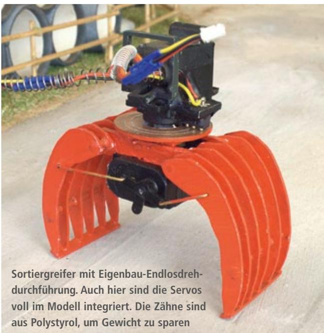
Sortiergreifer mit Eigenbau-Endlosdrehdurchführung. Auch hier sind die Servos voll im Modell integriert. Die Zähne sind aus Polystyrol, um Gewicht zu sparen
