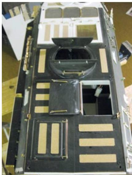
Die Antirutschbeläge auf dem Fahrzeugdach wurden aus Schmirgelpapier hergestellt
