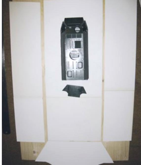
Die einzelnen Segmente der Karosserie wurden mit einem CAD-Programm erstellt und anschließend aus Polystyrol-Platten ausgeschnitten
