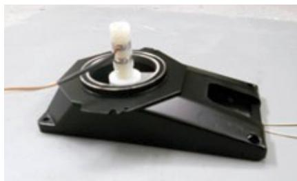
Die im Windenbock montierte Drehdurchführung. Da fertige Lösungen sehr kostspielig sind, entstand die Konstruktion im Eigenbau
