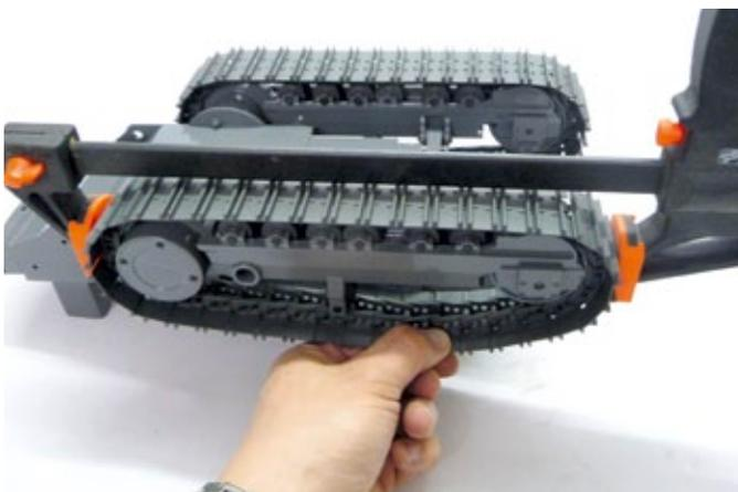
In vorgespanntem Zustand ist die Kette sehr einfach anzubringen und zu schließen
