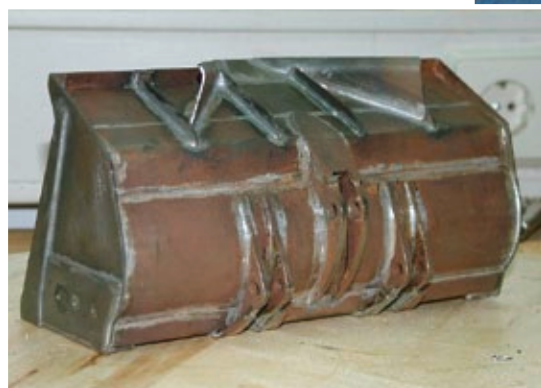
Die fertig verschweißte Schaufel. Für dieses unter Belastung stehende Bauteil kam ausschließlich Stahl zum Einsatz
