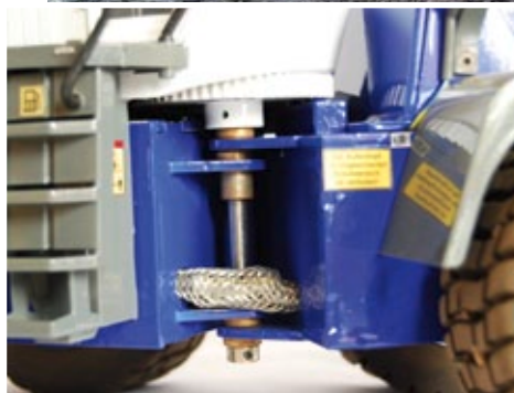
Der Aufbau des Knick-Gelenks. Unterhalb des Kabinenbodens erkennt man das große Zahnrad mit 60 Zähnen und die vierfache Lagerung mit Sinterbuchsen
