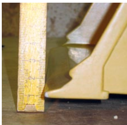
Die WEDICO-Schaufel lässt sich nicht plan auf den Boden absenken, hat dafür aber eine größere Hubhöhe
