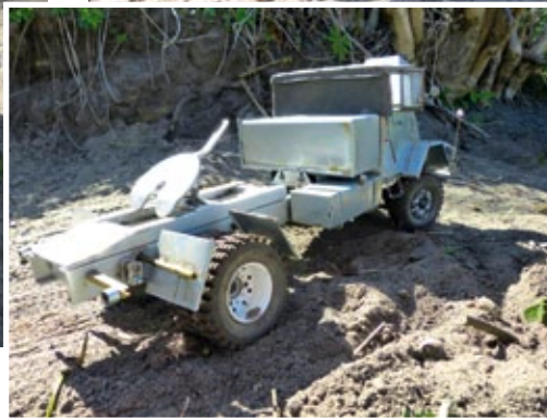
Hinter dem Fahrerhaus ist ein Staukasten angebracht, darunter befindet sich der Akku
