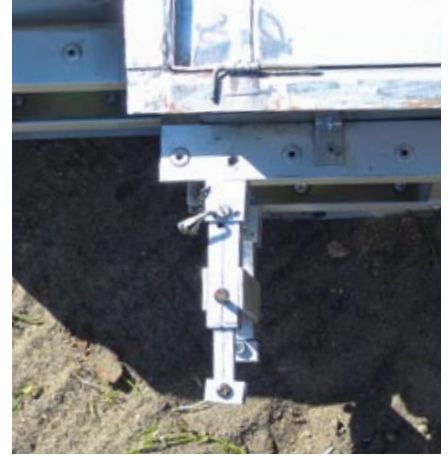
Die Aufliegerstützen wurden aus Alu-Vierkantrrohr konstruiert und sind ausziehbar gestaltet
