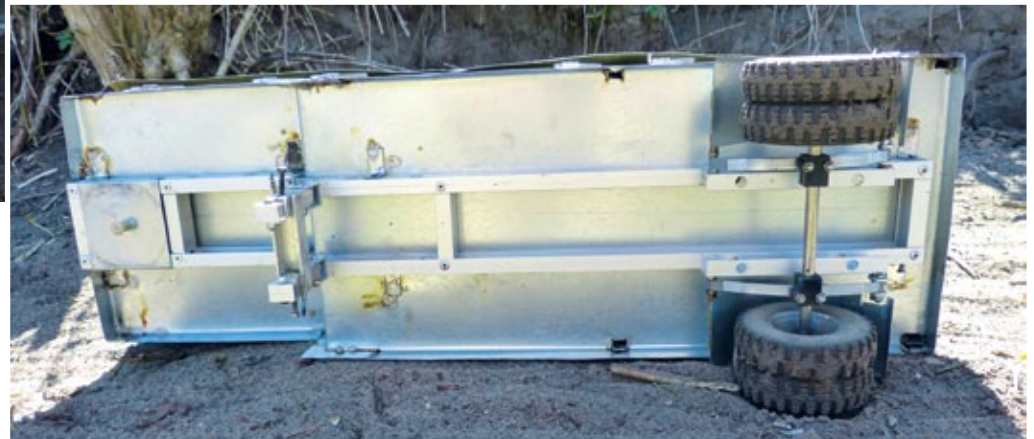
Die Aufliegerstützen wurden aus Alu-Vierkantrrohr konstruiert und sind ausziehbar gestaltet
