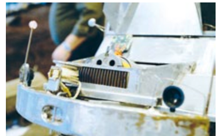
An der vorderen Stoßstange befindet sich eine Seilwinde. Als Antrieb dient hier ein Mikrogetriebemotor mit 6 Volt und 60 Umdrehungen pro Minute
