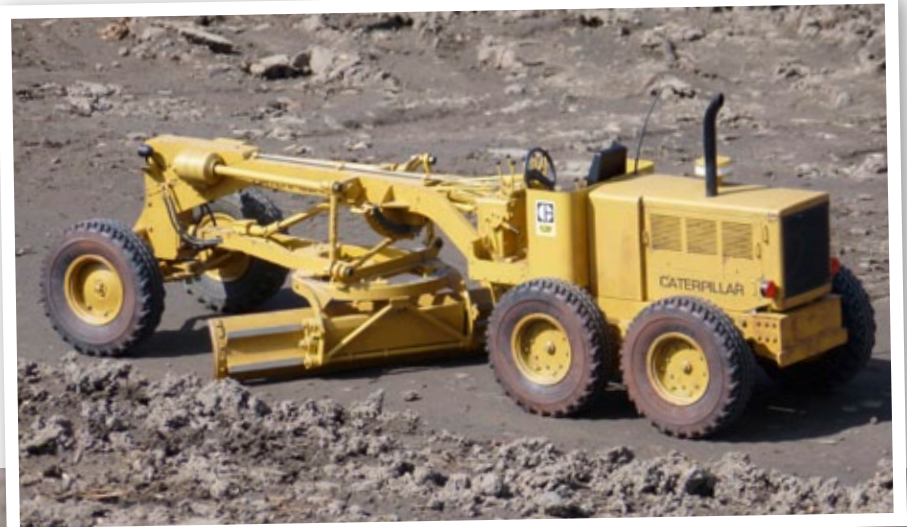
Die Seitenverschiebung der Schar wird über einen kleinen Faulhabermotor realisiert
