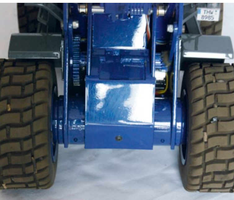
Mit nur einer Schraube wird eine lackierte Abdeckung aus Polystyrol vom Vorderwagen entfernt
