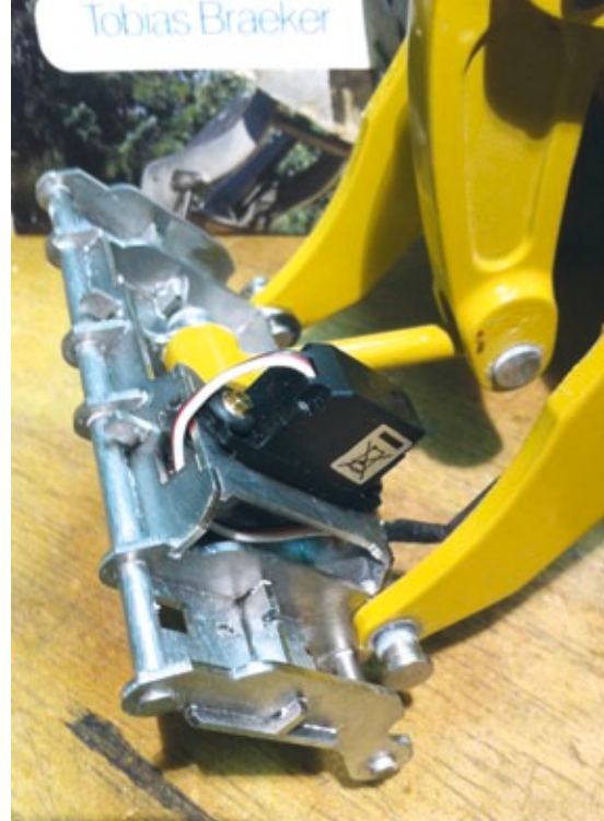
Die Verriegelung des „Braeker Lock“ mittels Mini-Servo
