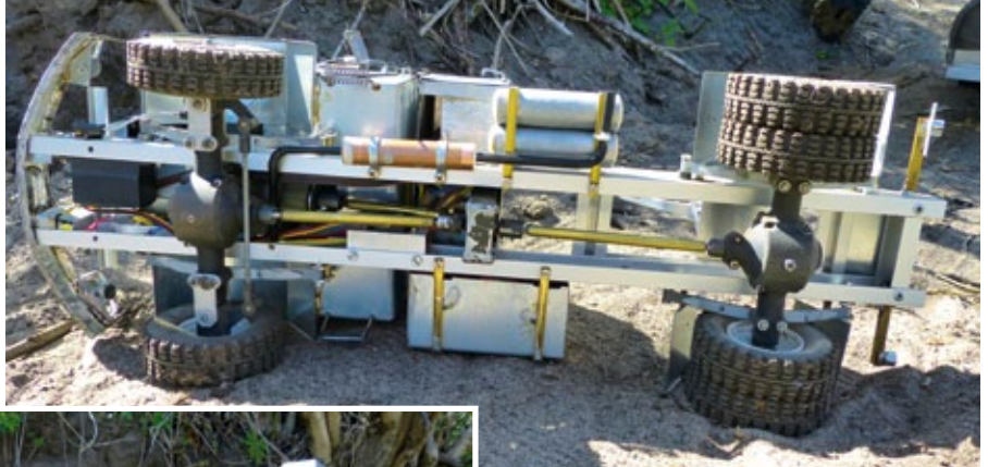
Von unten erkennt man den Alu-Rahmen der Zugmaschine sowie die Verteilung der Antriebsenergie an beide Achsen
