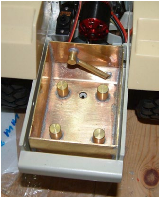
Der Tank sitzt auf vier Gummilagern die von unten verschraubt sind
