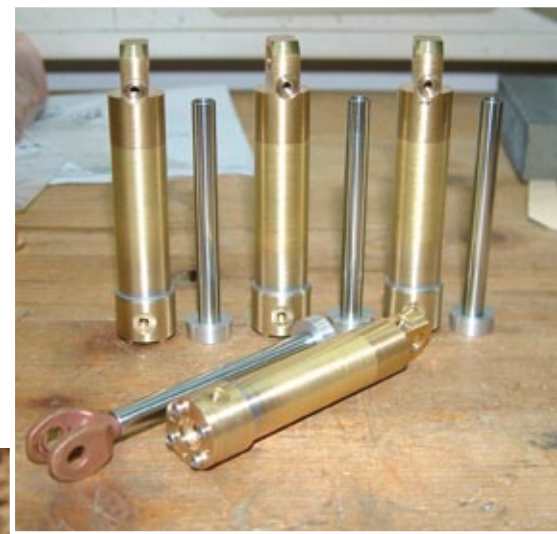
Die vier Hubzylinder für die beiden Radlader-Modelle im Rohbau
