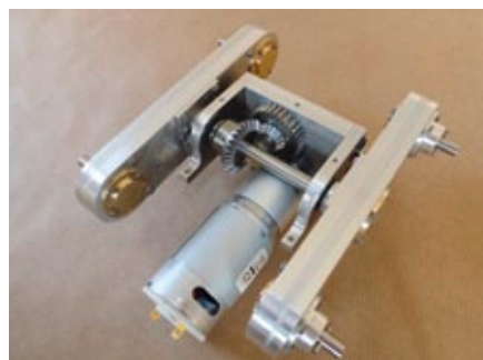
Die Antriebsmechanik, bei der die Drehbewegung direkt über eine Starrachse auf die so genannten Bogie-Achsen übertragen wird
