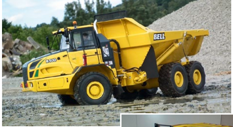
Der Bell B50D vor seinem Umbau. Im Unterschied zum B45D ist der Vorderwagen breiter und hat einen etwas höheren Motorraum
