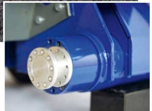
Die gedrehten Naben verschwenden keinen wertvollen Millimeter an Platz. Der Abstand von Nabe zum Gehäuse des RB35 beträgt grade einmal einen halben Millimeter
