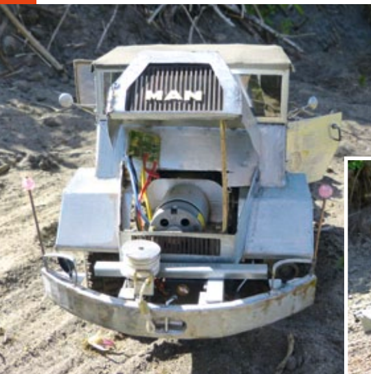
Hier kommt ein modifizierter Akkuschauber-Motor zum Einsatz. Geschwindigkeiten bis 6 Stundenkilometer sind damit möglich
