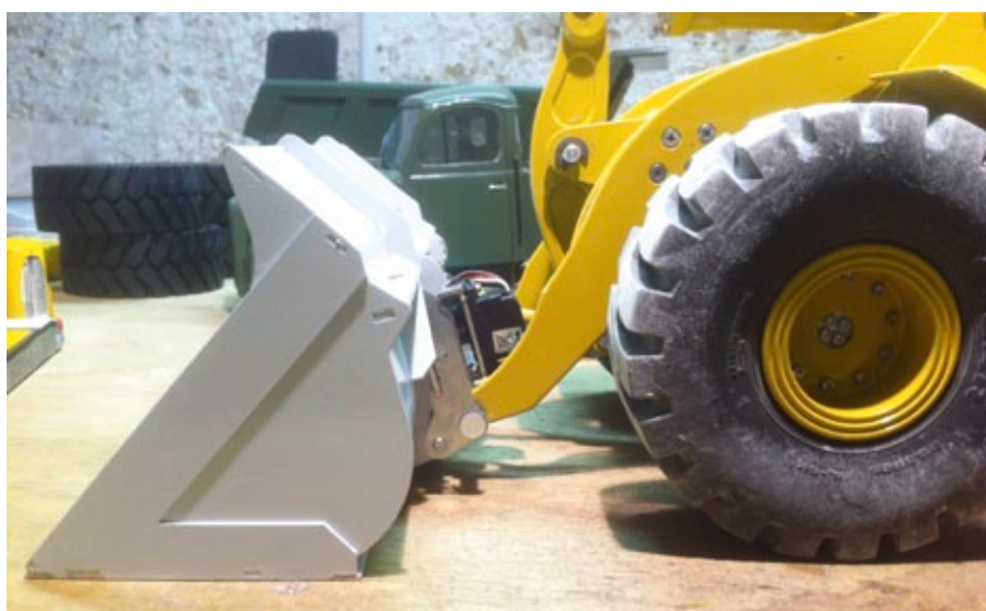
Die Anbaugeräte von Tobias Braecker im Zusammenspiel mit dem Braeker Lock lassen sich plan auflegen
