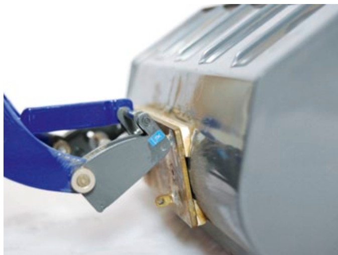
Zum Ankoppeln des Anbaugeräts an den selbst gebauten Schnellwechslers ist lediglich etwas Fingerspitzengefühl nötig
