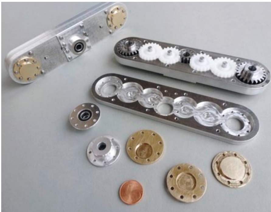
Präzise gefertigt und schon in diesem Zustand einer Augenweide: Das Achsgehäuse, bei dem die Kunststoffzahnäder der Vermeidung von störenden Geräuschen dienen
