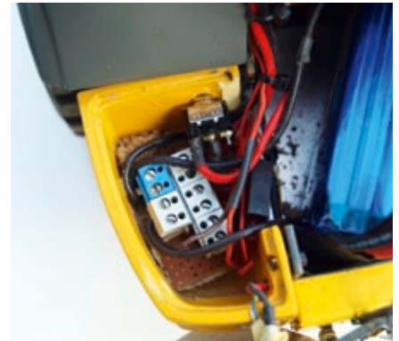
Die Stromverteilung füllt den linken Ballastkasten
