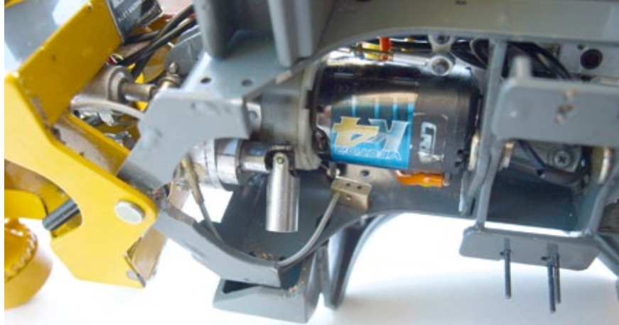
Wiederaufbau nach dem Lackieren der Achsen. Der Bowdenzug für die Vorderachse ist schon eingebaut
