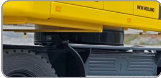
Die elektro-hydraulische Drehdurchführung ermöglicht eine Endlosdrehfunktion des Oberwagens
