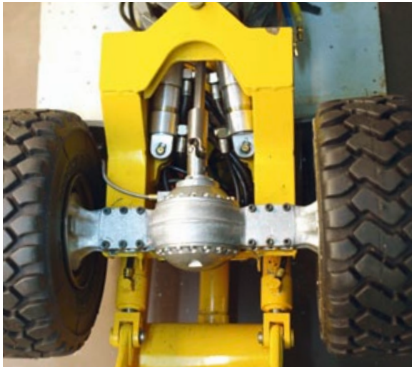
Vorderwagen mit Kardanwelle und den Lenkzylindern. Der Platz für die Kardanwelle reicht gerade aus
