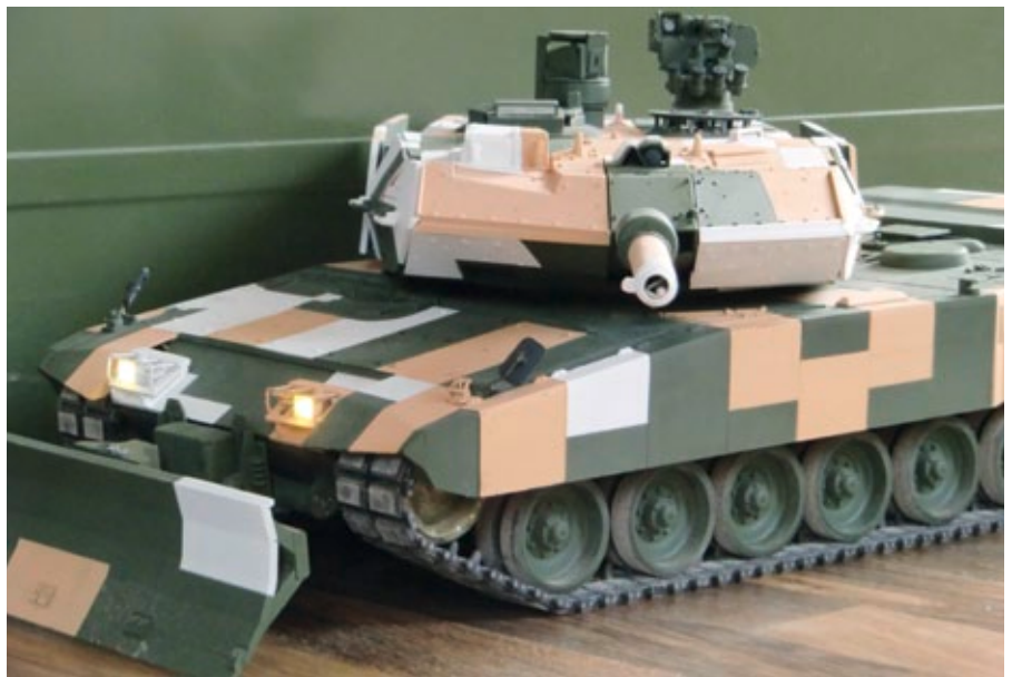
Das Modell Leopard 2 PSO ist ausgestattet mit einer TankControl V3 und nutzt die alternative Steuerung für den nicht verwendeten Anschluss der externen Fahrregler zum horizontalen und vertikalen Schwenken des Räumschilds
