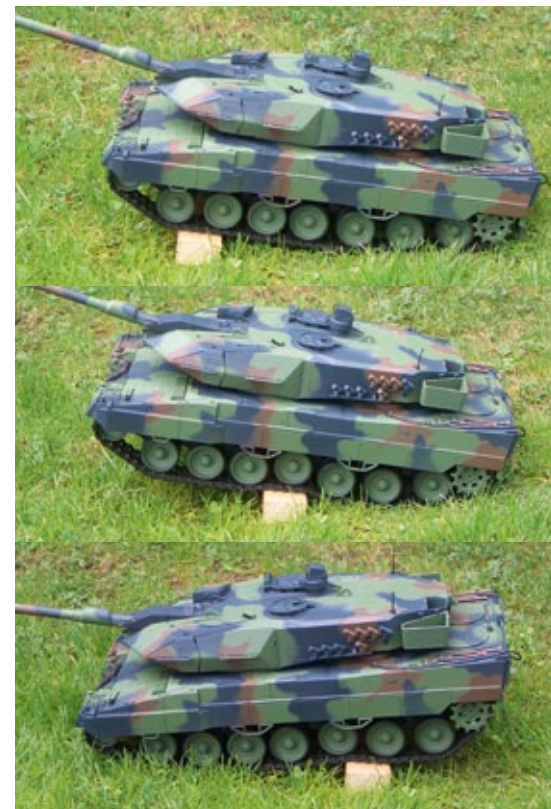
Der Leopard 2A6 fährt mühelos über das Hindernis hinweg, wobei die einzeln gefederten Laufrollen vorbildgetreu einfedern
