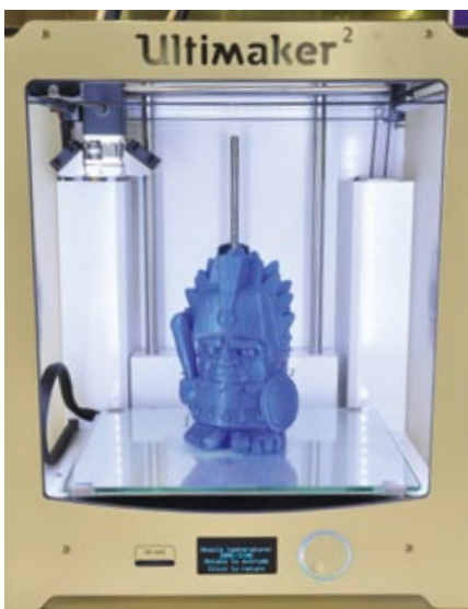
Ultimaker 2 – dieser 3D-Drucker kann zwei unterschiedliche Materialien in einem Produkt verarbeiten
