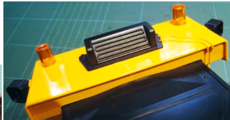
Die Scheinwerfer und Rundumlichter am Überrollbügel sind vollfunktionsfähig
