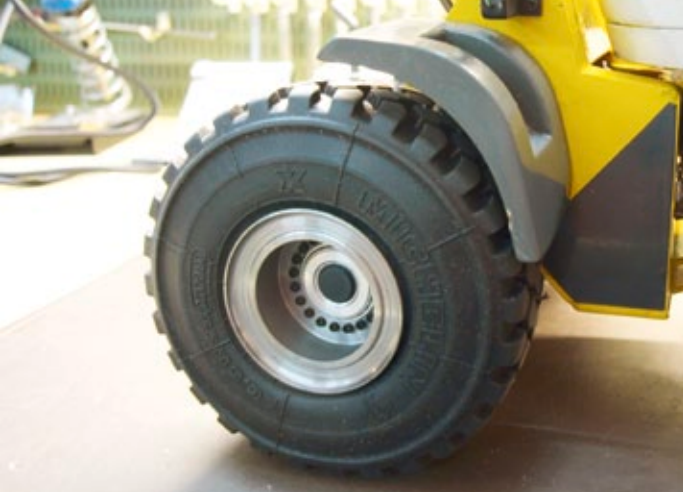
Jedes Rad wird mit 20 M1,6-Schrauben M 1,6 befestigt
