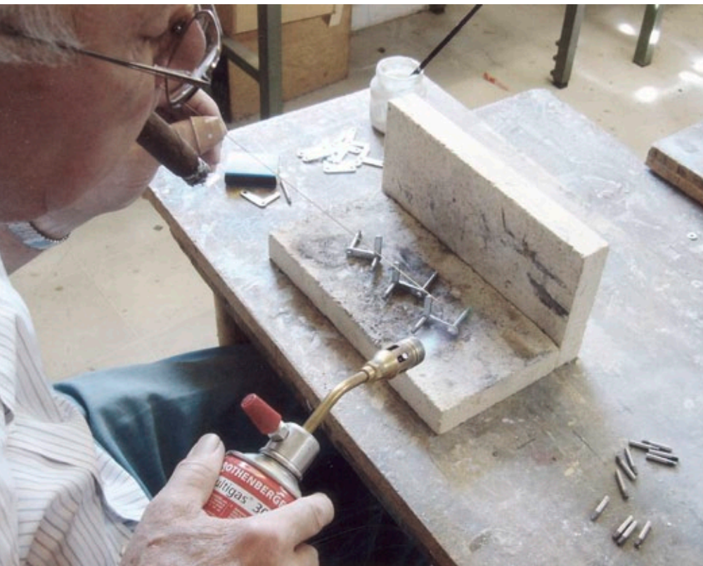
Die Achsschenkel müssen hartgelötet werden
