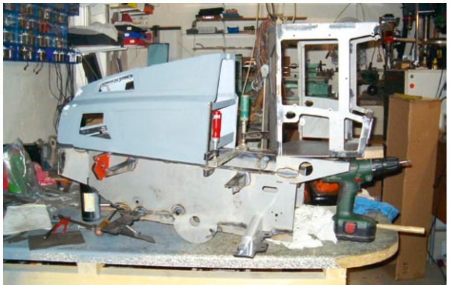
Die Karosserie besteht aus 2,5-mm-Stahlblech
