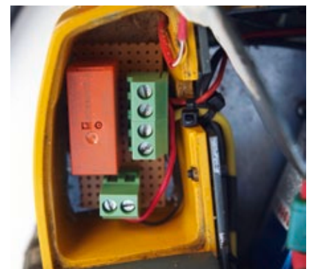
Im rechten Ballastkasten ist das Schaltrelais für die Hydraulikpumpe verstaubt
