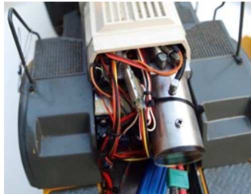
Die Empfängereinheit befindet sich neben der Pumpe. Vorne ist die Empfangsantenne zu sehen
