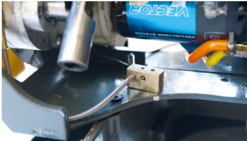
Der Messingblock zur Aufnahme der beiden Bowdenzüge für die Differenzialsperren
