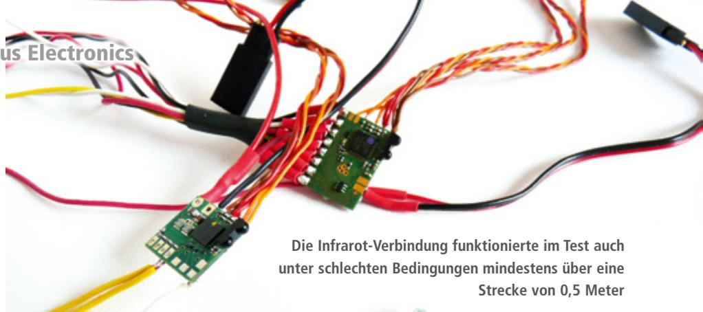
Die Infrarot-Verbindung funktionierte im Test auch unter schlechten Bedingungen mindestens über eine Strecke von 0,5 Meter
