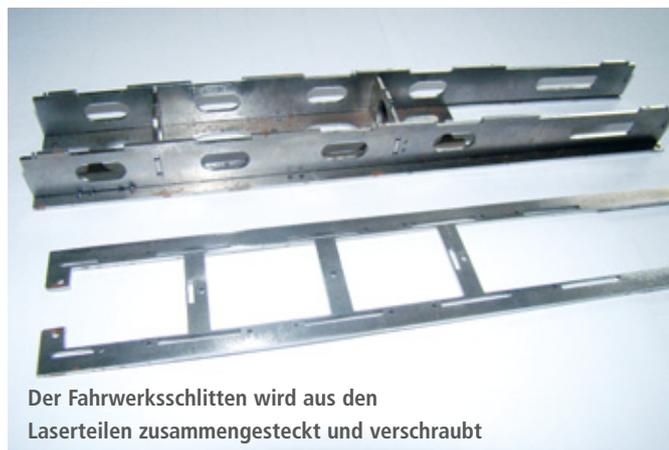
Der Fahrwerksschlitten wird aus den Laserteilen zusammengesteckt und verschraubt
