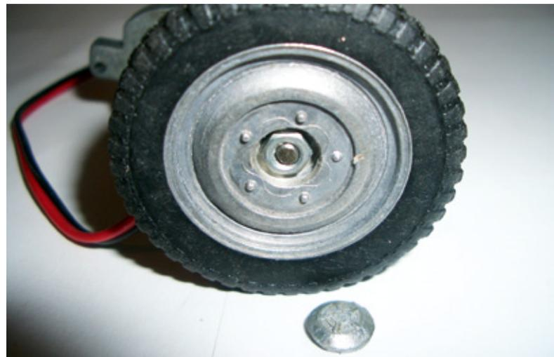
Die Felge mit angeedeuteter Verschraubung und die Radkappe sind gut wiedergegeben. Unter den Nabendeckeln kommen die Befestigungsmuttern der Räder zum Vorschein
