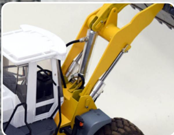
Bei der Hydraulik – Betriebsdruck etwa 12 Bar – werden bewährte Komponenten von Leimbach verwendet
