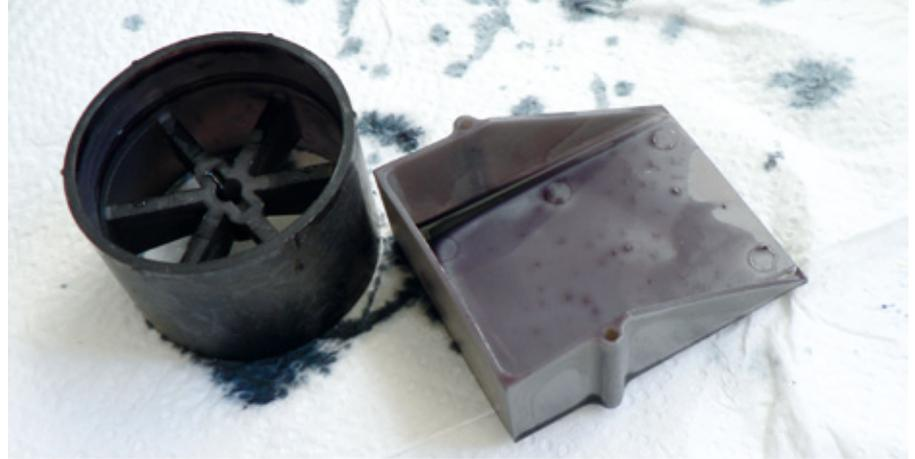
Je mehr Nylonanteil das Bauteil aufweist, desto schneller und gründlicher ist es eingefärbt. Die Felge war nach knapp zwei Stunden fertig und der Akkuhalter benötigte über 12 Stunden
