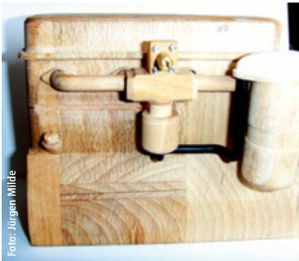
Der fertige Motorblock aus Holz diente als Vorlage zur Erstellung der entsprechenden Gussform
