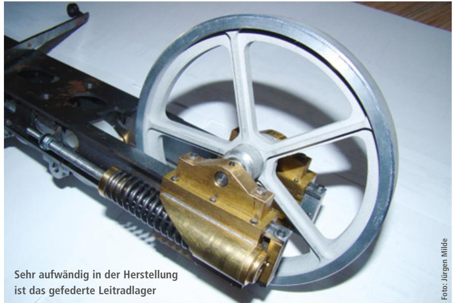
Sehr aufwändig in der Herstellung ist das gefederte Leitradlager
