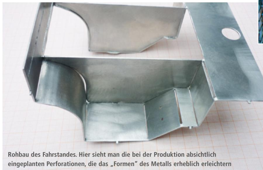
Rohbau des Fahrstandes. Hier sieht man die bei der Produktion absichtlich eingeplanten Perforationen, die das „Formen“ des Metalls erheblich erleichtern
