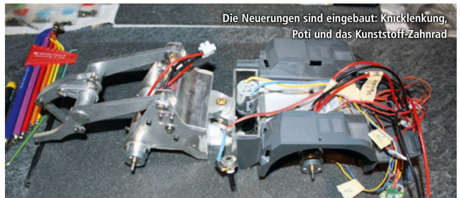
Die Neuerungen sind eingebaut: Knicklenkung, Poti und das Kunststoff-Zahnrad
