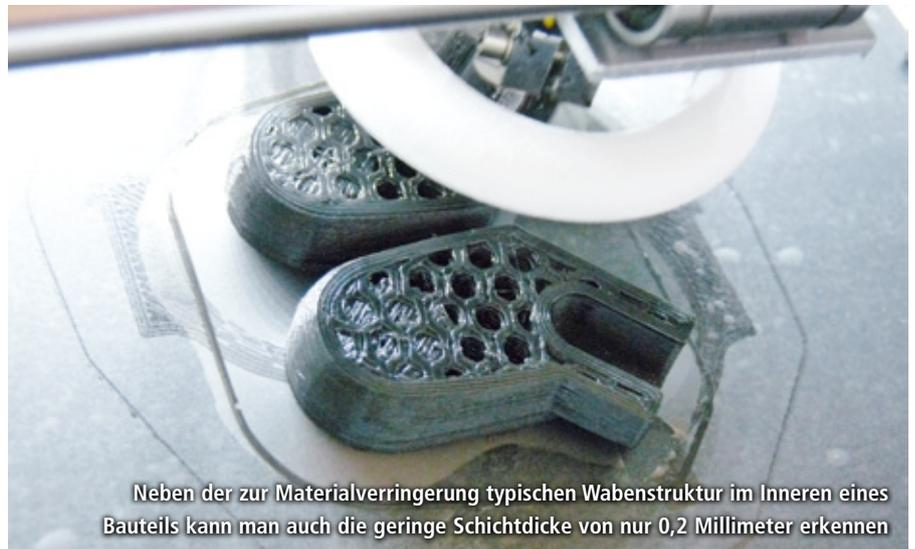
Neben der zur Materialverringerng typischen Wabenstruktur im Inneren eines Bauteils kann man auch die geringe Schichtdicke von nur 0,2 Millimeter erkennen
