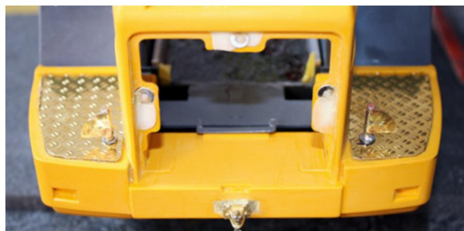
Das Heckteil nimmt das Gegengewicht auf. Die Öffnung ist für das schnelle Wechseln des Akkus gedacht
