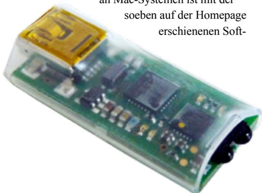
Das mit einem Silab-Chip bestückte IRDA-Modul wird per Micro-USB-Anschluss an einen Windows PC angeschlossen
