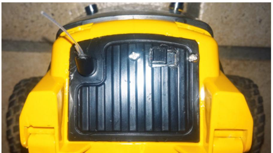
Schalter und Empfängerantenne sitzen fast unsichtbar auf der schwarzen Abdeckung
