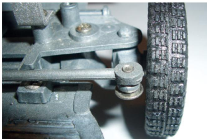
Lenkstange und Anlenkhebel der Vorderräder sind links und rechts mit einer Schraube verbunden. Da diese nur leicht eingedreht ist, könnte sie sich im Fahrbetrieb lösen und verloren gehen – Abhilfe schafft hier Schraubensicherungslack mittelfest
