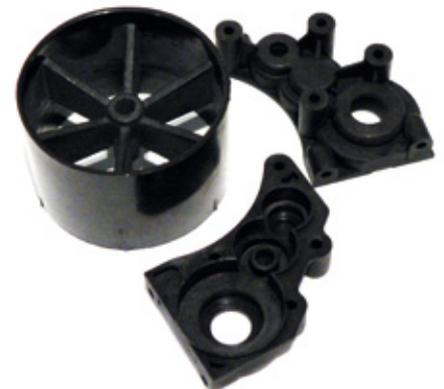
Die vielen Vertiefungen und die komplexere Form der Getriebegehäuse verlangen nach einem erheblich längeren Bad im Färbemittel als die Felge, generell ist aber auch das Färben von deutlich größeren Teilen möglich
