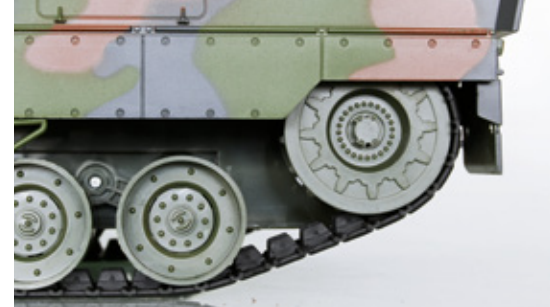
Das Antriebsrad und die Laufräder sind aus Kunststoff gefertigt, die Ketten sind komplett aus Gummi
