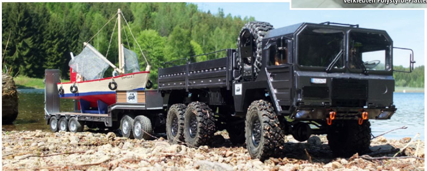
Die Kabine besteht aus verklebten Polystyrol-Platten
