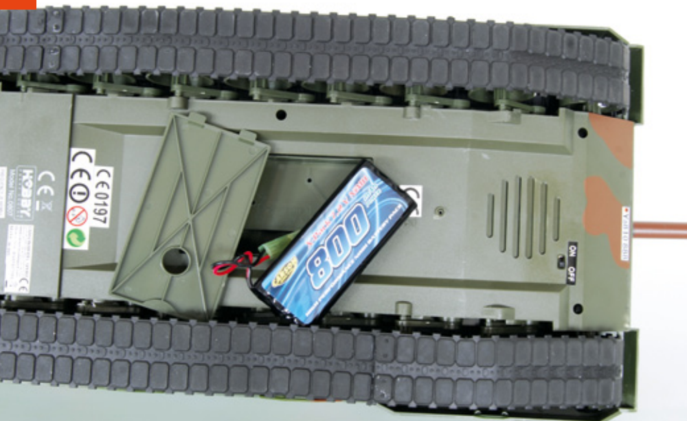
In einer Klappe auf der Unterseite des Panzers wird der NiMH-Akku eingelegt. Das ist aufgrund der geringen Abmessungen dieser Klappe ziemlich fummelig
