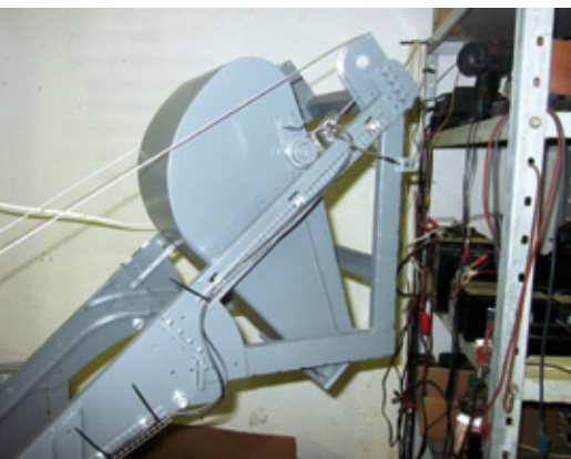
Der Trog fährt im Original mit dem fertigen Asphalt nach oben zur Ausschüttung
