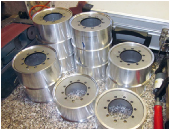
Die Felgen wurden selbst aus Aluminium gedreht
