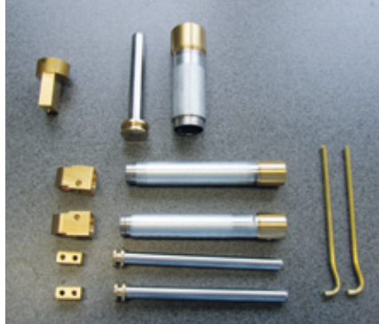
Ein Hydraulikzylinder in seinen Einzelteilen. Hier wird bis auf Dichtungen und Kolbenstange alles selbst hergestellt
