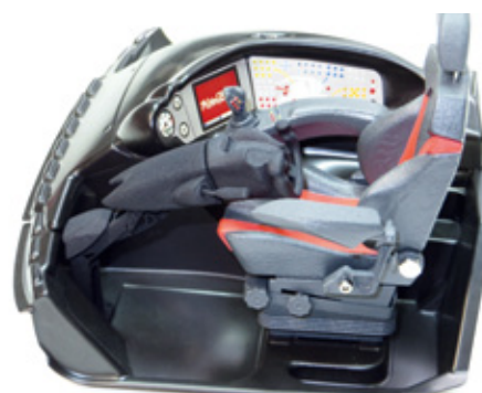
Nach und nach kommen Zubehörteile zur Komplettierung, so wie die Lenksäule und die Sitze des PistenBullys
