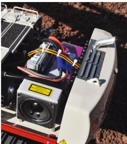
Unter einer Abdeckung verbergen sich Soundmodul und andere Elektronik-Komponenten
