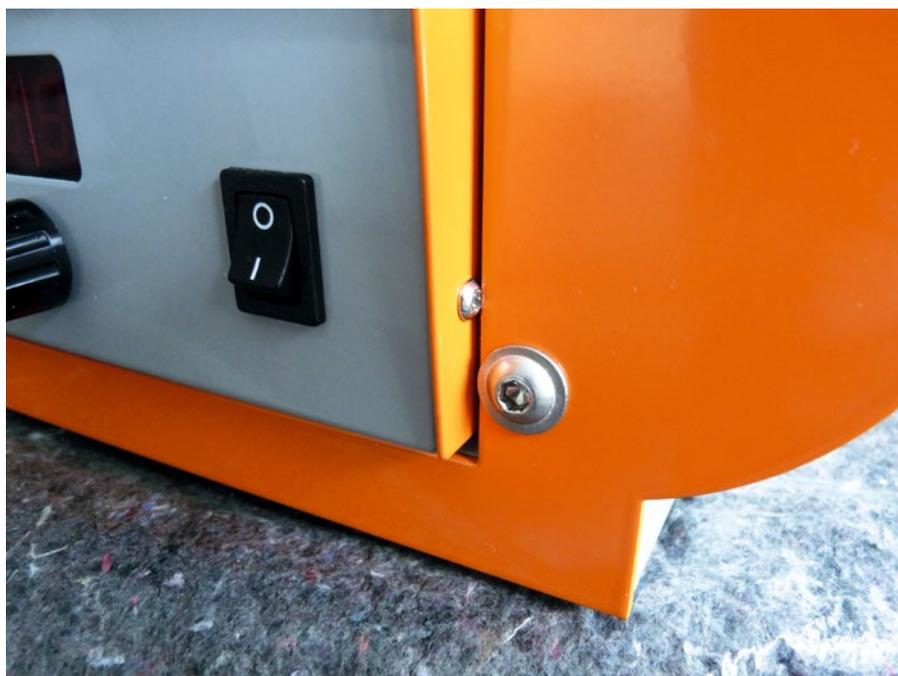
Die von vorne schiebbaren Steuerelemente der diversen Stepcraft-Maschinen geführten Elemente werden mit der seitlichen Gehäuseschraube in der Tiefe begrenzt. Als Alternative können wiederum seitliche Führungsschienen mit Schrauben und Muttern versehen werden, um eine zusätzliche Sicherung in der Tiefe zu haben
