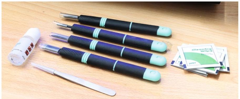
Hilfreiche Utensilien im Lieferumfang des Robox: Das Öl für die Wellenschmierung, eine Pinzette, verschiedene Messer und Reinigungstücher
