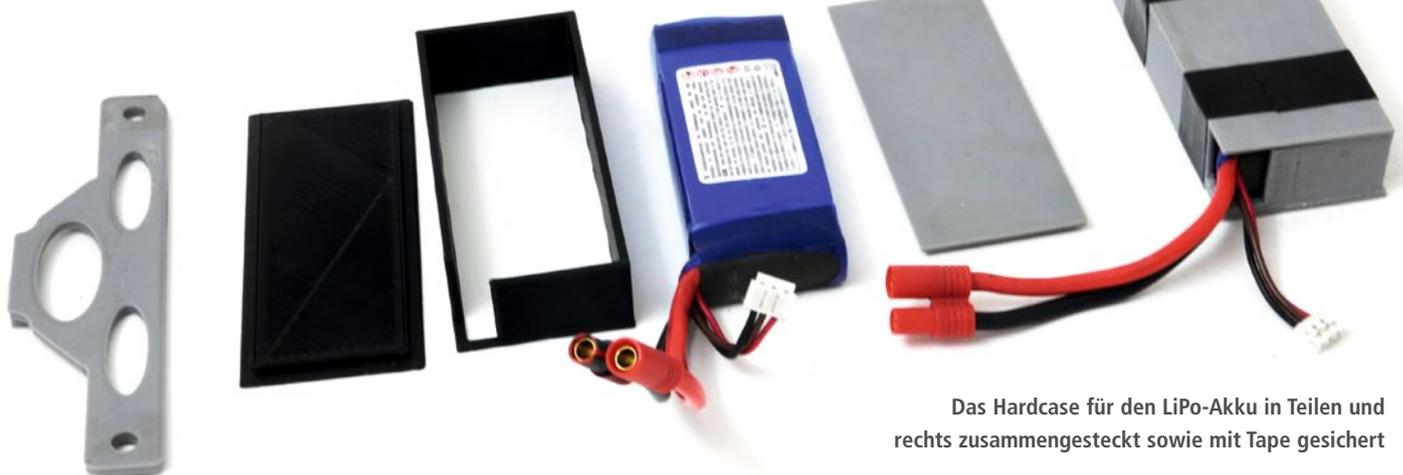
Das Hardcase für den LiPo-Akku in Teilen und rechts zusammengesteckt sowie mit Tape gesichert
