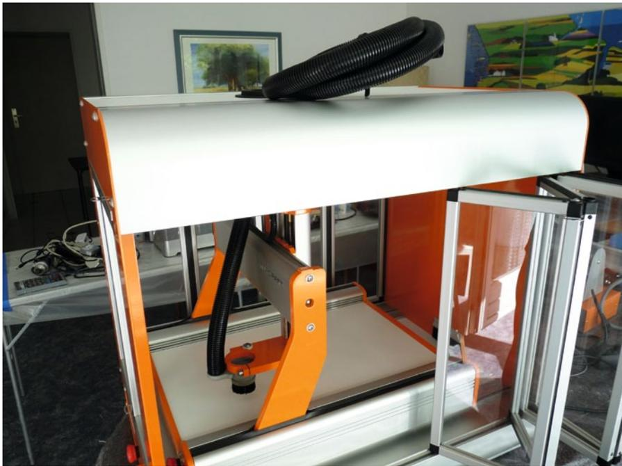
In der Decke befindet sich eine kreisrunde und durch Borsten geschützte Öffnung, durch welche sowohl der Absaugschlauch als auch das eine oder andere Kabel oder Druckluftschläuche nach oben herausgeführt werden können
