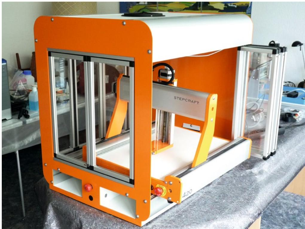
Die Maschine wird von der Seite her eingeschoben und kann mit Schrauben und Muttern in den Führungsschienen auf dem Boden der Umhausung gegen ein Verschieben gesichert werden
