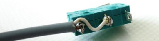
Bevor die Endlagenschalter mit etwas Sekundenkleber endgültig in den Profilen befestigt werden, sollte unbedingt das längere Kabel wie gezeigt gebogen werden, um Kurzschlüsse durch aufgeschuerte oder eingeklemmte Isolierungen zu vermeiden
