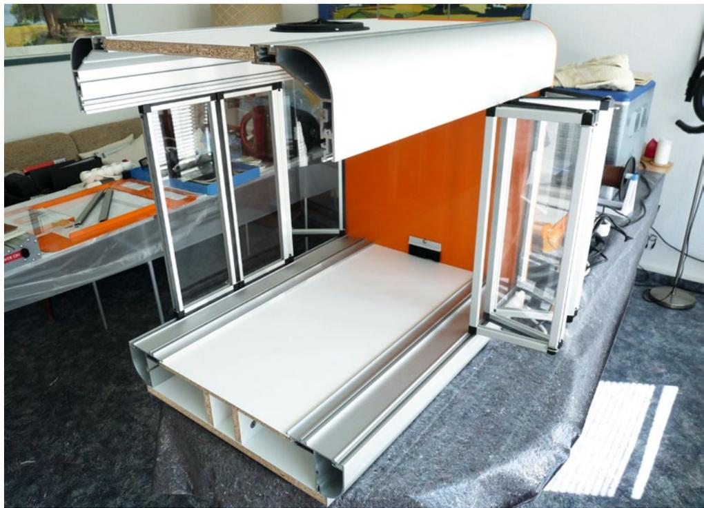
Die Profile haben an vielen Stellen Führungsschienen für die spätere Montage von weiteren Halterungen, Kabelführungen oder anderen Dingen. Zudem kann man hier recht gut die sehr bullige Bauweise erkennen, nicht umsonst wiegt die Umhausung später deutlich mehr als die einzelne Maschine
