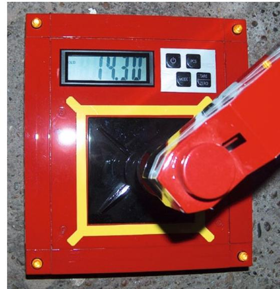
Die Abstützplatten mit Waage wurden aus den Bauteilen von Paketwaagen zusammengefügt
