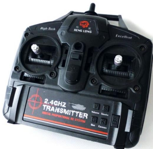
Der mitgelieferte Sender wird im störungsfreien 2,4-Gigahertz-Bereich betrieben und ermöglicht mittels proportionalen Steuerknüppel ein sanftes Rangieren des Modells. Sonderfunktionen wie das Front MG oder die Schussfunktion werden über das Tastenfeld unten rechts gesteuert
