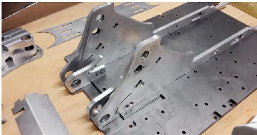
Die Teile des A-Bocks werden auf der Grundplatte angepasst
