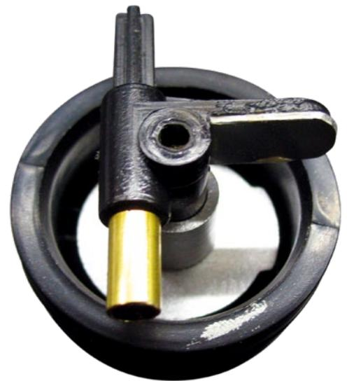
Mit Hilfe des Messingrohrs wird das Spiel in der Lenkung minimiert
