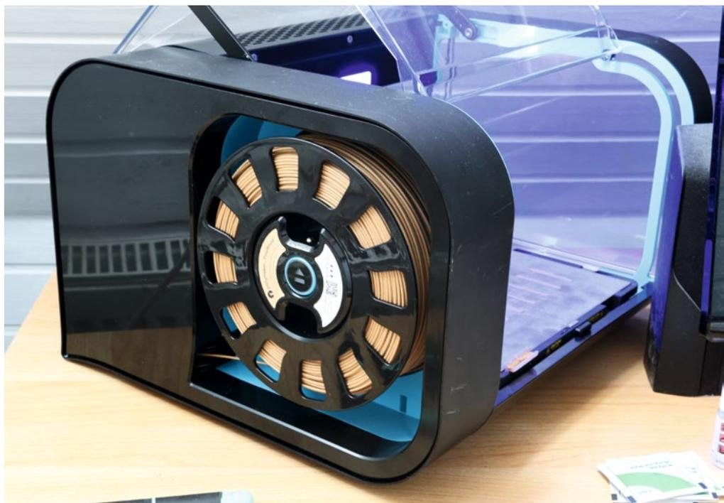
Auf der Seite steckt die spezielle programmierbare Spule. Auch Fremdmaterial kann benutzt werden
