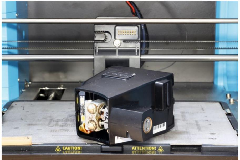
Zur gelegentlichen Reinigung der Düsenausgänge kann der Druckkopf am Cel-Robox sehr leicht entnommen werden
