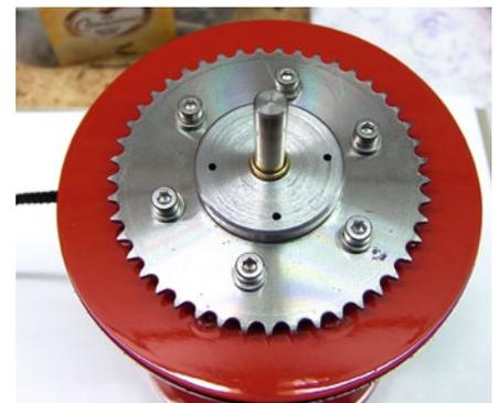
Die Seiltrommel mit dem Kettenrad, das für die passende Übersetzung sorgt
