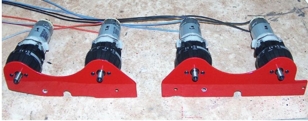
Die vier Windenmotoren stammen aus Akkuschraubern und eignen sich hervorragend für den Modellbau
