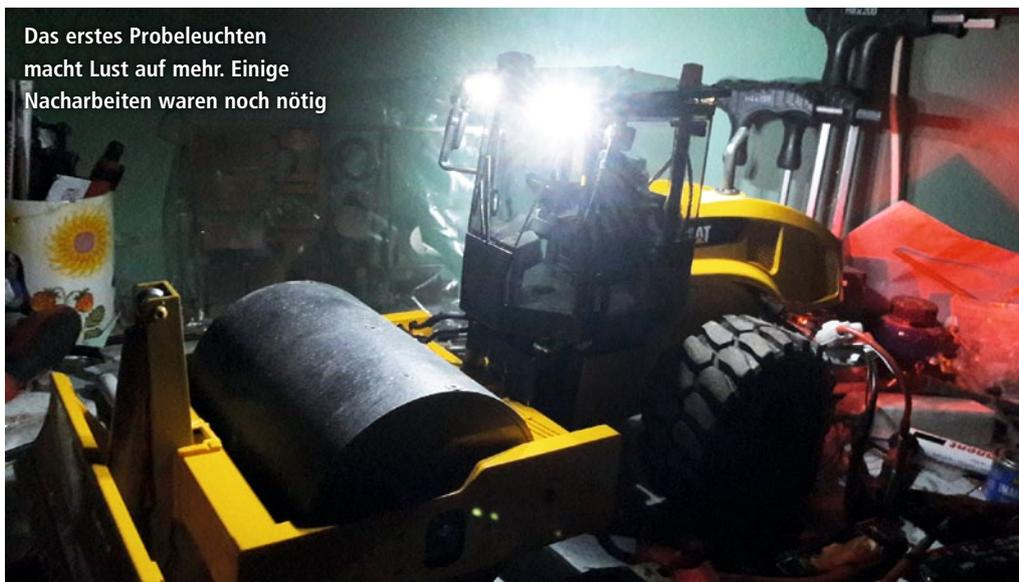
LED, leicht modifiziert, in das orangene Glasteil hineinpasst. Später wird sie noch an eine im Motorraum versteckte Blitzlichtplatte angeschlossen, damit man einen Doppelblitzeffekt erhält.
