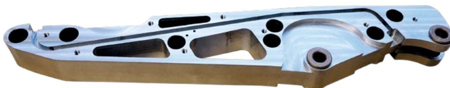
Der Baggerstiel ist aus dem Vollen gefräst und ein sehr beeindruckendes Bauteil
