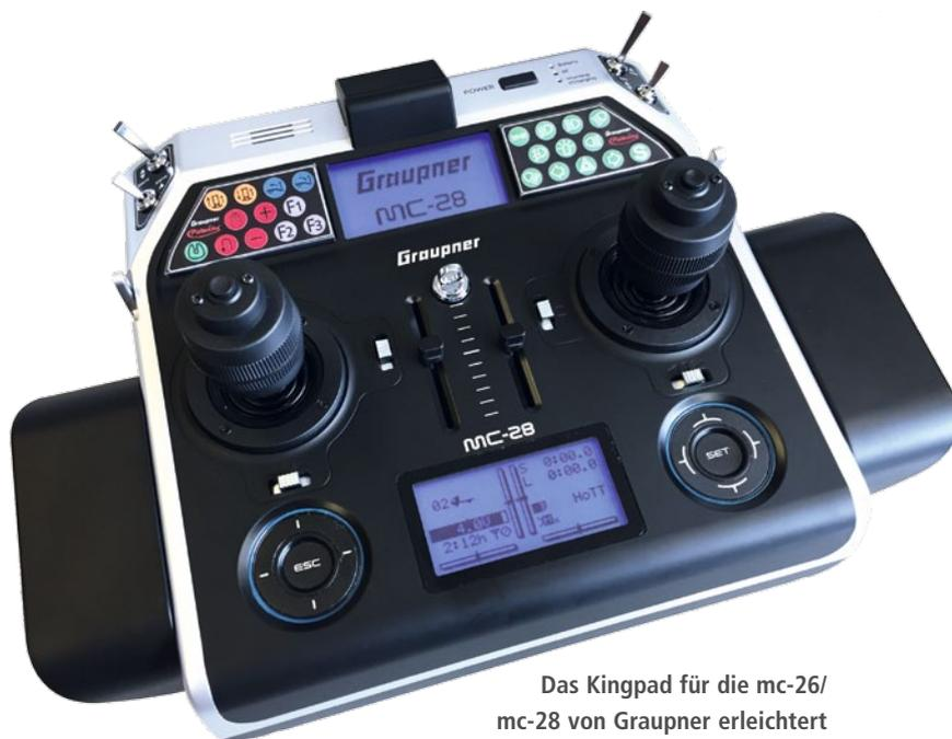
Das Kingpad für die mc-26/ mc-28 von Graupner erleichtert die Bedienung des Modells
