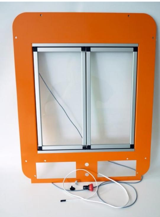
Die fertig vormontierte Frontplatte sollte nicht sofort verbaut werden, denn das doppelseitige Klebeband, welches die oberen und unteren Führungsprofile des vorderen Fensters hält, sollte sich erst richtig fest angezogen haben
