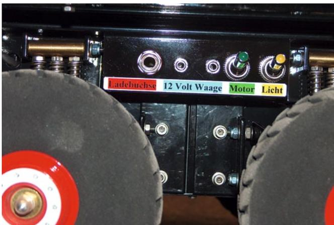
Gut erkennbar: Die Buchsen und Schalter für die Spannungsversorgung
