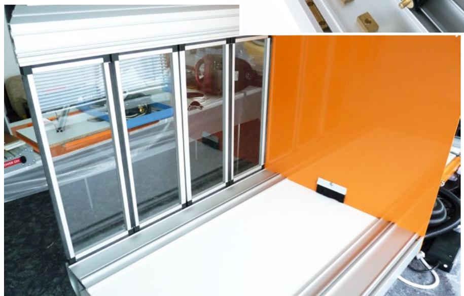
Die Dichtungen müssen nach innen zeigen, um optimal funktionieren zu können. Alle Einzelteile des Klappfensters sind von der Passung her recht eng, daher kommt man um grobes Werkzeug nicht herum – vor allem aber sollte man sich Baufehler verkneifen, da die Teile später nicht mehr ohne Beschädigungen demontierbar sind
