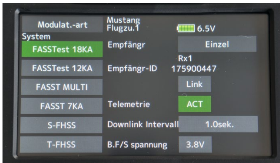
Abhängig von der gewählten Modulationsart – der Empfänger muss dafür geeignet sein – stehen bis zu 18 Kanäle zur Verfügung
