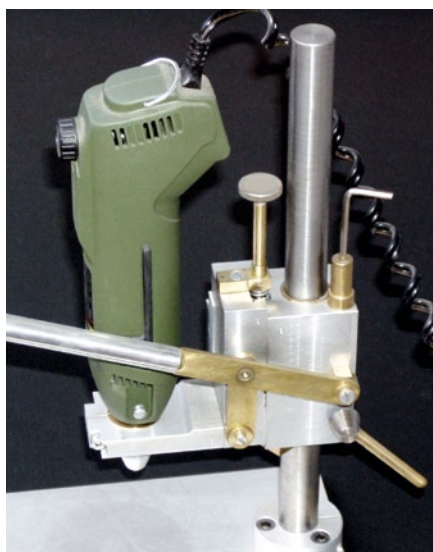
Abbildung 2: Für den Spannhals braucht es eine geschlitzte Klemmbuchse. Die Schwalbenschwanz-Führung muss immer gut gefettet sein
