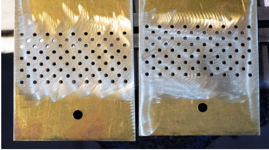
Abbildung 4: Die beiden 0,2-Millimeter-Bleche wurden „im Paket“ gebohrt. Dabei werden oben und unten zwei Pertinax-Platten mit gebohrt
