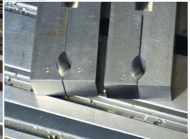
Abbildung 4: Schlagzahlen-Markierungen, Körnerschläge genügen auch
