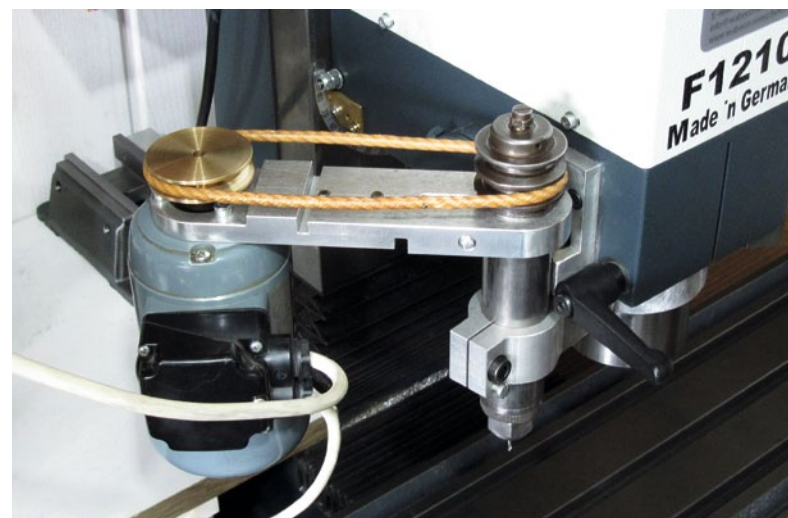
Abbildung 8: Der Motor, und damit auch der Bohrer, dreht nur etwa 1.300 Mal die Minute, viel zu wenig. Demnächst bekommt der Schnell-Fräskopf einen schnelleren Motor
