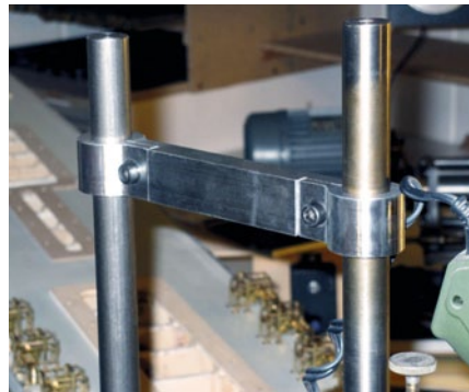
Abbildung 5: Der Auslegerarm sollte nicht zu flach sein
