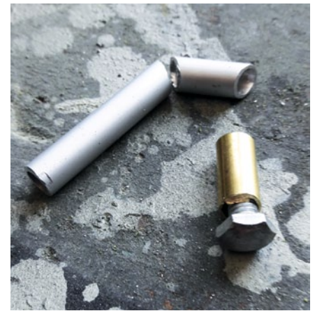
Auspuff und Tankstutzen, hier im Rohbau, sind aus Aluminium, Messing und einer Schraube improvisiert
