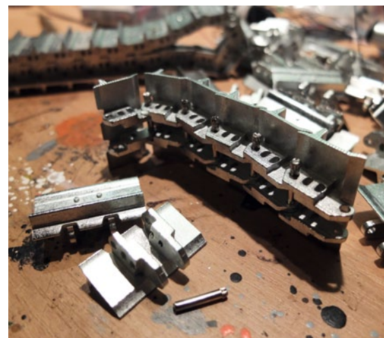
Der Aufbau der Ketten im Detail – Kettenglieder und Verbindungsstifte lassen sich ohne Schwierigkeiten zusammensetzen
