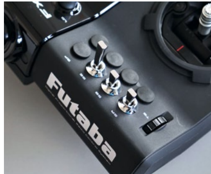
Für zwei weitere Schalter bietet die FX 36 noch einen Ausbauplatz. Entweder in einem der Schalterplätze oder in den Sticks
