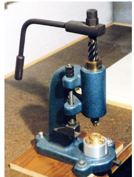
Abbildung 1: Mit dieser Spindelpresse wurden beispielsweise Hunderte von winzigen Nietkopf-Imitaten gestanzt
