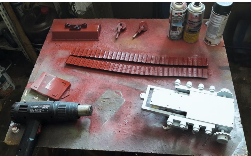
Sämtliche Baugruppen aus Metall wurden extra noch mit Rostschutzfarbe grundiert
