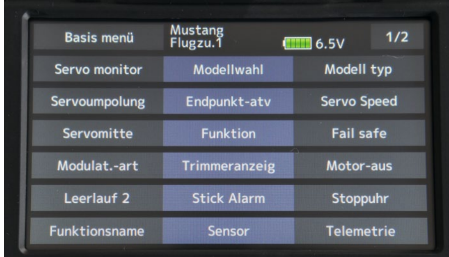
Das Basis-Menü ist eines von drei Hauptmenüs. Hier platziert sind wichtige Untermenüs wie Modellwahl und -typ, Modulationsart, Alarmer, Telemetrie-Einstellungen und mehr
