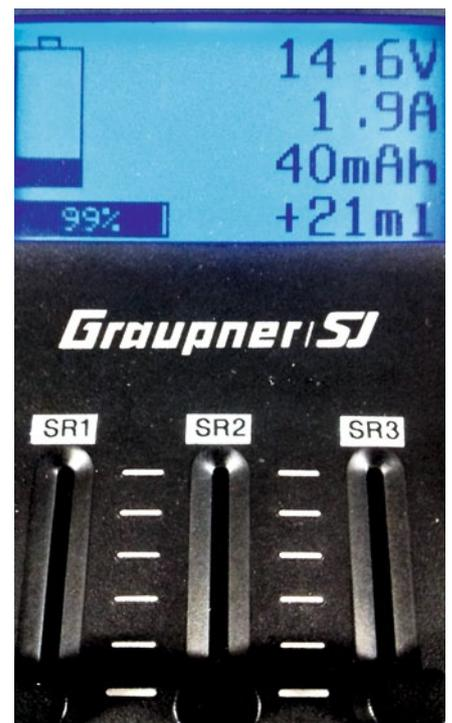
Am Telemetriedisplay wurde der Anzeigemodus gewählt, der Akkuspannung, Motorstrom, verbrauchte Kapazität und prozentuale Restenergie anzeigt
