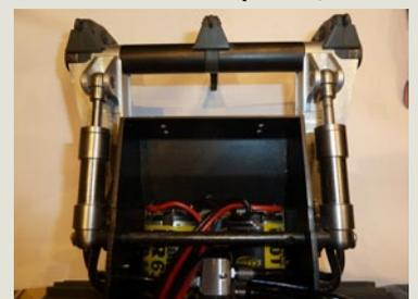
Akkus ist möglich. Für die Steuerungs-/ Soundfunktionen entschied ich mich für das Multifunktionsmodul von SGS-Electronic. Dieses klebte ich mit doppelseitigem Klebeband mittig in der Wanne auf das Akkufach und verdrahtete es zum Teil. Für die weiteren Lichtfunktionen kamen entsprechende Module der Firma CTI zum Einsatz.
