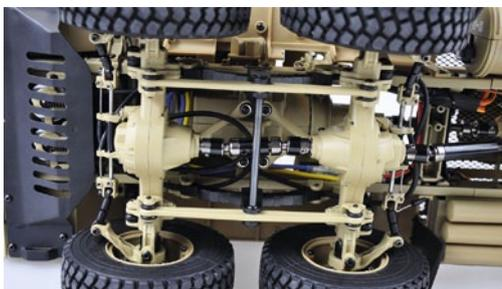
Die Kraftübertragung im Antriebsstrang erfolgt über Kardanwellen, für Vortrieb sorgt der verbaute 550er-Bürstenmotor
