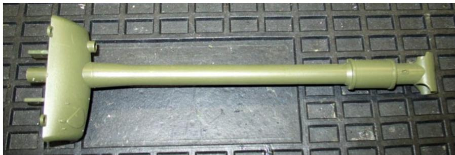
Das ursprüngliche Rohr tauschte ich gegen ein passend gedrehtes Alurohr mit entsprechendem Mündungsaufsatz aus Feinguss
