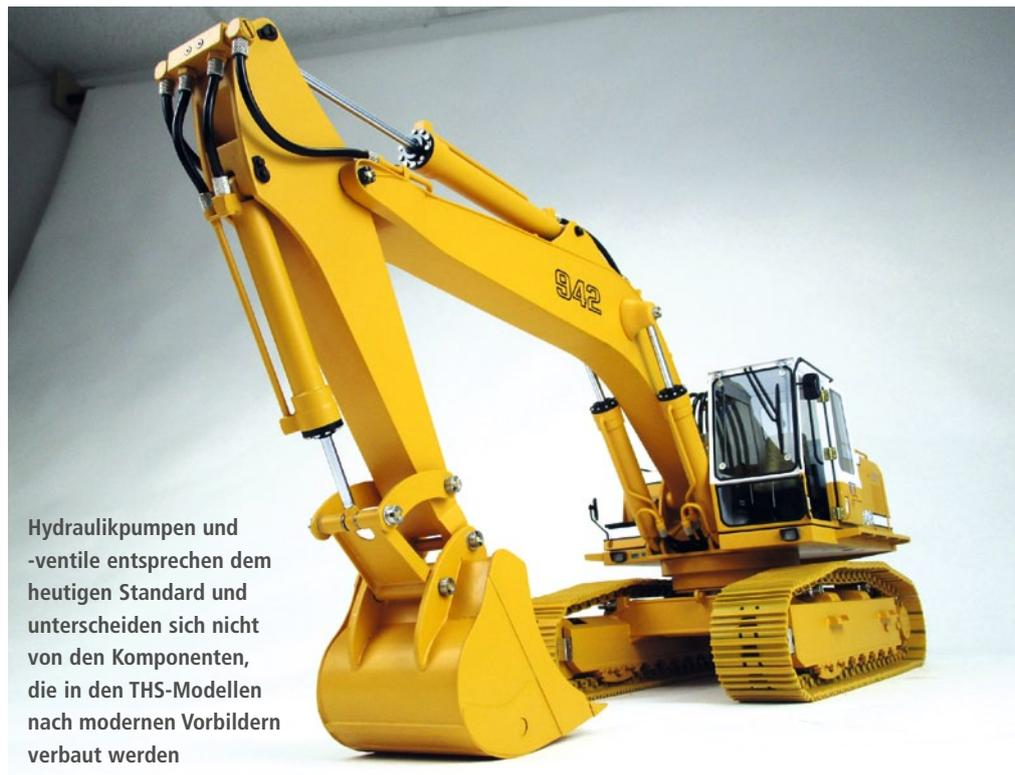
Hydraulikpumpen und -ventile entsprechen dem heutigen Standard und unterscheiden sich nicht von den Komponenten, die in den THS-Modellen nach modernen Vorbildern verbaut werden
