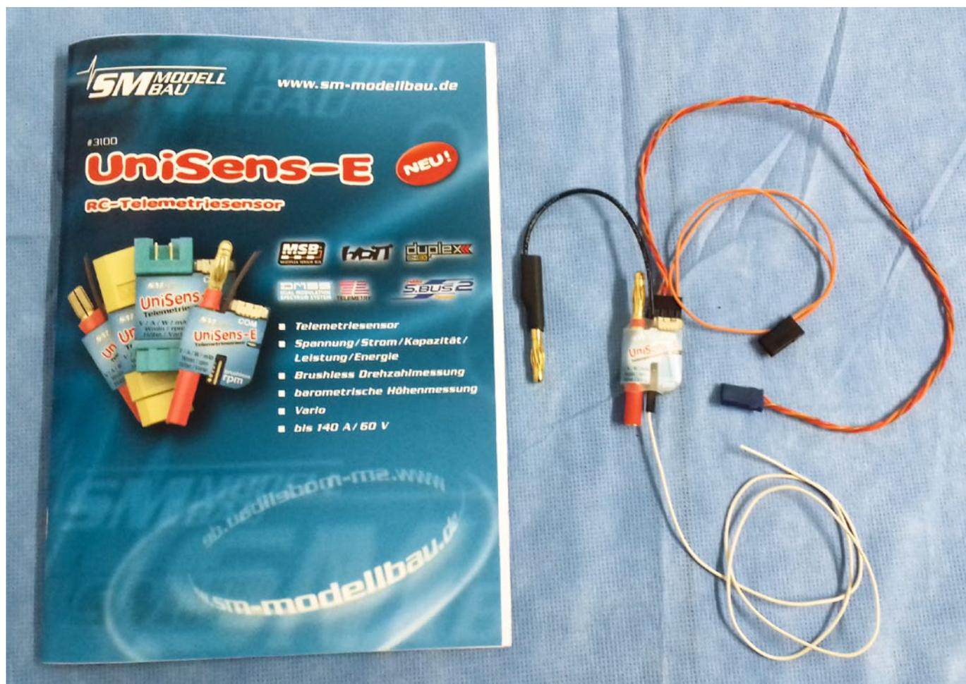
Die Lieferung des UniSens-E erfolgt anschlussfertig, auch sämtliche Anschlusskabel für die Verbindungen zum Empfänger und Motor sind dabei
