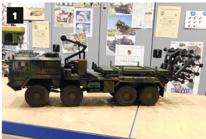
1) Die fertige faltstraße mit dem „Gerippe“ der Abrollereinheit, aber ohne Platten. 2) Die Einheit zum Aufrollen befindet sich hinter dem Fahrerhaus und wickelt den Verlegegurt auf und ab. Beim Verlegen der faltstraße wird der Gurt mit abgespult und liegt unter der faltstraße. In umgekehrter richtung wird diese über den Gurt aufgenommen und zum Trägereisch gezogen
