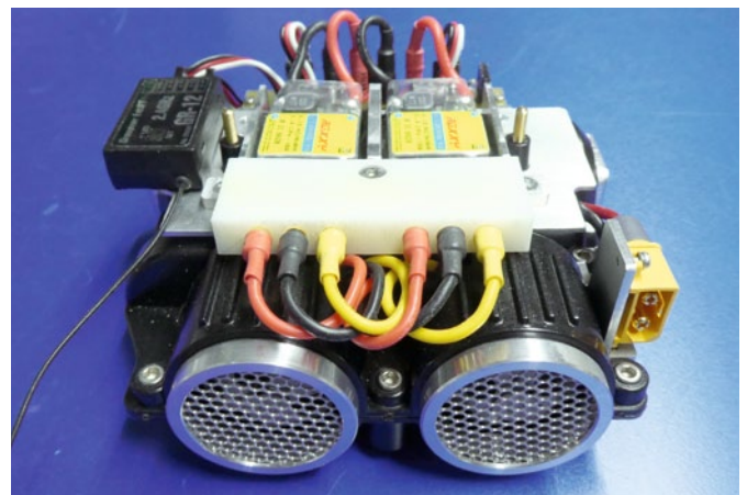
Der einbaufertige Antriebsblock, der zuvor modifiziert wurde. Die Gitter sind als Schutz der Außenläufer-Brushless-Motoren eingesetzt
