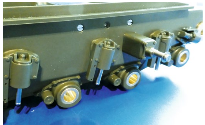
Die Anbauteile mehren sich. Im Vordergrund sieht man die neue Achse zur Aufnahme der ersten Stützrolle
