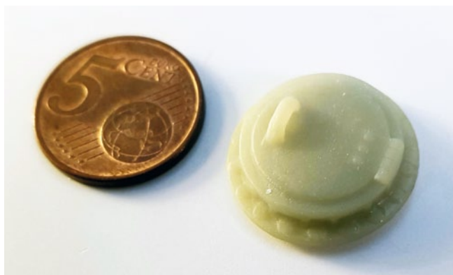
Das gedruckte, gewaschene und gehärtete Bauteil
