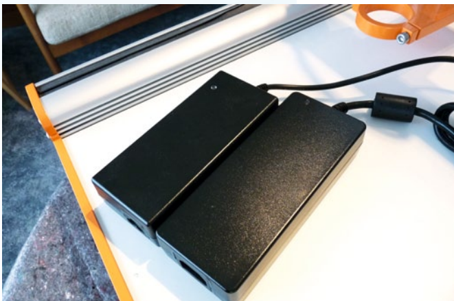
Das neue Netzteil zur Stromversorgung der deutlich leistungsstärkeren Motoren fällt nicht viel größer als das ursprüngliche Netzteil aus – ideal, wenn man beengte Platzverhältnisse um die Maschine herum hat
