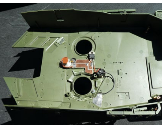
Die Innenseite des Turmdachs. Hier befindet sich auch die Energieversorgung für Rundumlicht und Kommandanten-Periskop
