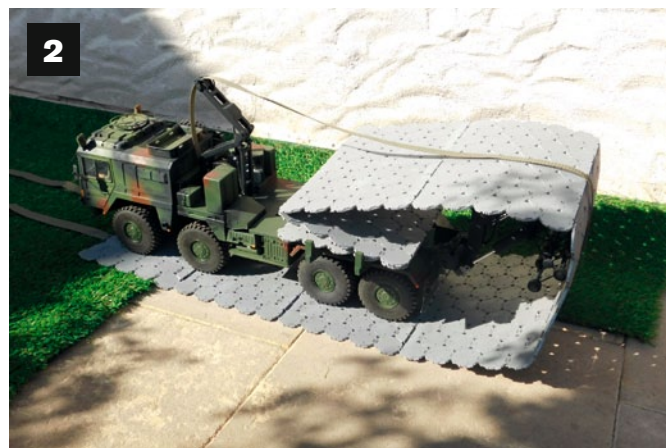
1) Die fertige faltstraße mit dem „Gerippe“ der Abrollereinheit, aber ohne Platten. 2) Die Einheit zum Aufrollen befindet sich hinter dem Fahrerhaus und wickelt den Verlegegurt auf und ab. Beim Verlegen der faltstraße wird der Gurt mit abgespult und liegt unter der faltstraße. In umgekehrter richtung wird diese über den Gurt aufgenommen und zum Trägereisch gezogen
