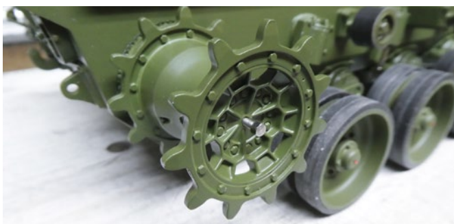
Ein vorderer Zahnkranz in der aufgeschobenen Ansicht. Mit der Zentralschraube wird der Zahnkranz gehalten. Die Mitnahme erfolgt über die Verzahnung
