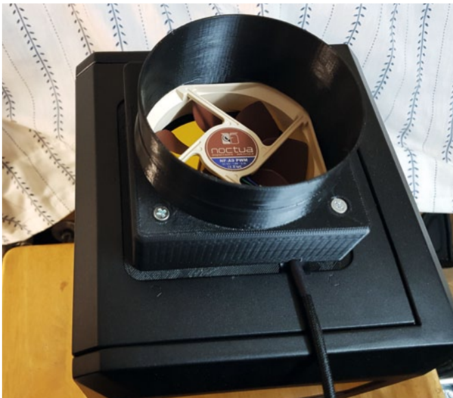
Die Absaugung ist montiert. Der Schlauch ist noch nicht befestigt
