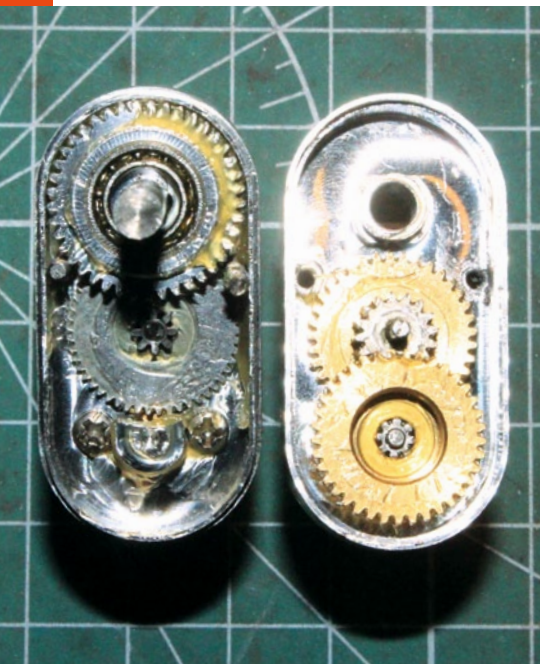
Blick in eins der Antriebsgetriebe
