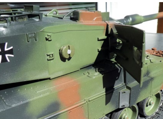
Im Turmverschluss ist ein Magnet eingesetzt, in der klappbaren Turmpanzerung das Stahlblech
