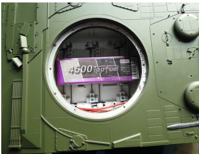
Blick in den Turmschacht. Der Fahrakku ist mittig angeordnet
