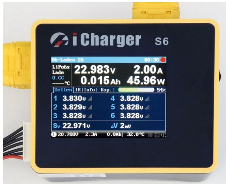
Zahlreiche Parameter, wie die Spannungslagen der einzelnen Zellen, lassen sich während des Ladevorgangs abfragen
