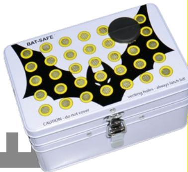
Der Himmlische Höllein hat den Bat-Safe-Mini neu im Programm. Dieser ist so konstruiert, dass Akkus darin geladen und gelagert werden können. Die Ladekabel werden durch eine flammensichere Öffnung nach außen geführt. Durch die oberen Lüftungsbohrungen kann im Falle eines brennenden LiPos der Druck entweichen, gleichzeitig wird der Rauch gefiltert. Das Innere der Box kann bei einem Brand einer Temperatur von bis zu 800°C standhalten. Das Innere des Koffers misst 170 x 100 x 40 Millimeter.
