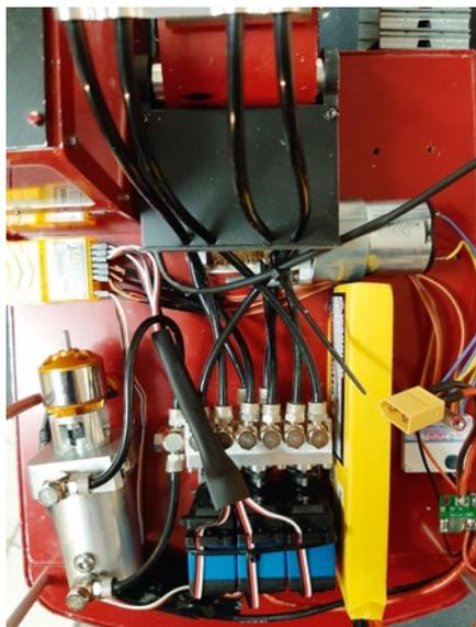
Blick auf die Hydraulikschläuche vom Arm Richtung Oberwagen
