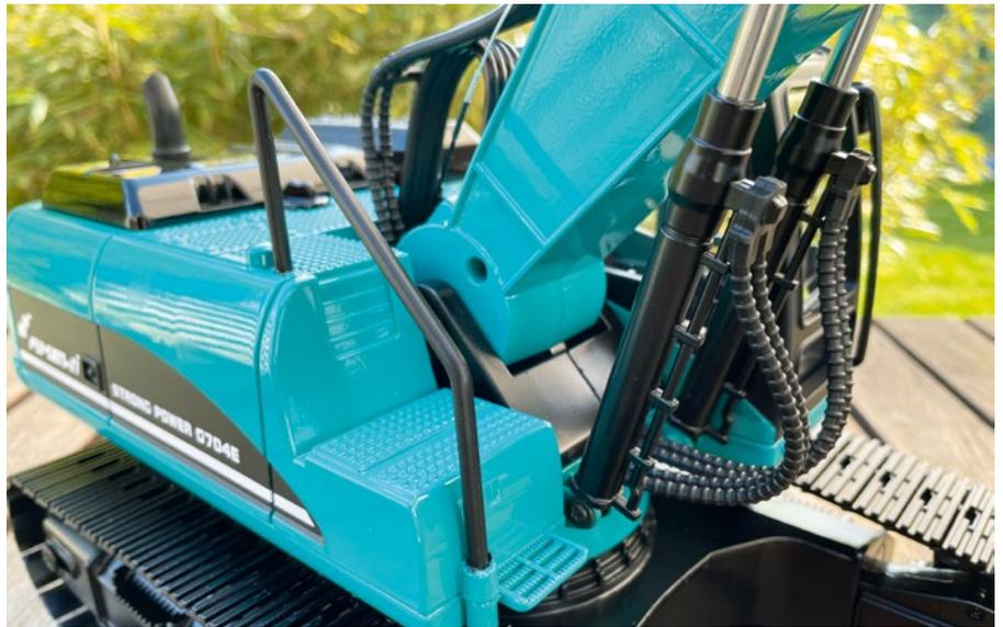
Die beiden Auslegerzylinder sind im Gegensatz zum Stielzylinder und Löffelzylinder nur Attrappen und haben keine Funktion. Daher bestehen sie auch als einziges aus Kunststoff
