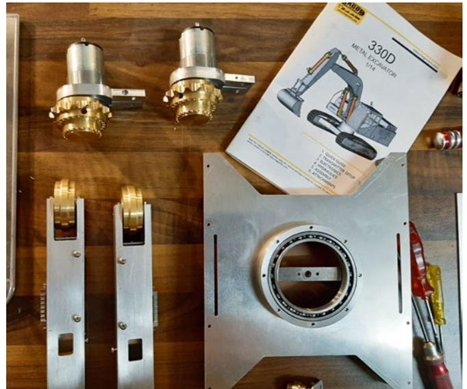
Die Antriebsmotoren und der Unterwagen
