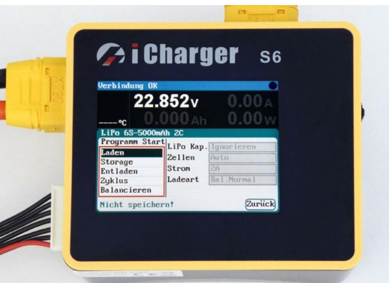
Für Lithium-Zellen stehen alle relevanten Lade- und Entlade-Vorgänge zur Verfügung – die Bedienung ist selbsterklärend
