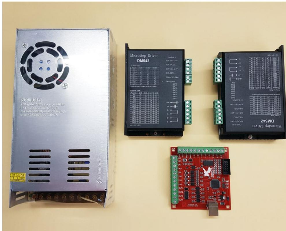
Alle Steuerungskomponenten auf einen Blick: 24-Volt-Netzteil (links), Schrittmortortreiber, Mach3-USB-Interface-Karte (rot)
