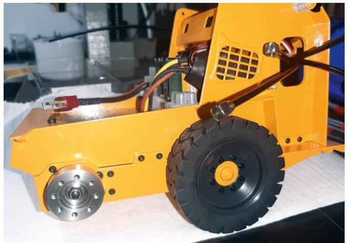
Montage der Räder mit Scale-Schrauben
