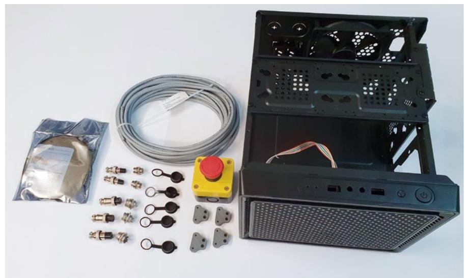
Zur Unterbringung der Steuerung dient ein kleineres PC-Gehäuse (rechts). Die noch anzufertigenden Kabelstränge (graues Kabel) werden mittels Kabelschlauch (links) gebündelt. Die gedruckten Bauteile (grau) dienen der Befestigung der Motortreiber in dem Gehäuse
