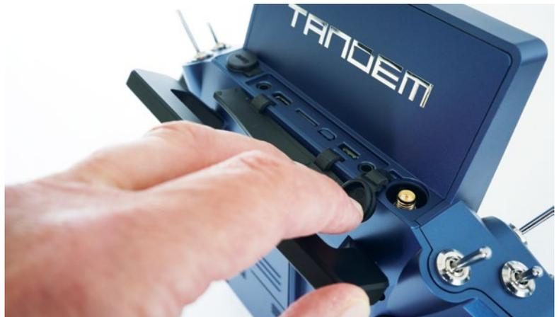
Rückseitig befinden sich ein SD-Mikro-Karten-Slot, ein USB-Anschluss und Anschlüsse für externe Module
