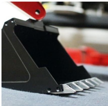
Die Zähne an der Schaufel sind geschraubt und können nach Bedarf entfernt werden
