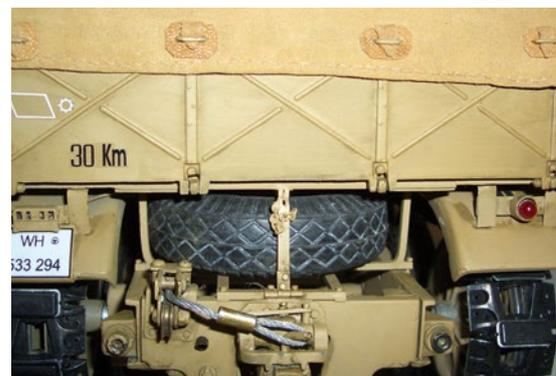
Am Heck wurde der Ersatzreifen verstaut und die Schwerlastanhängerkupplung verbaut
