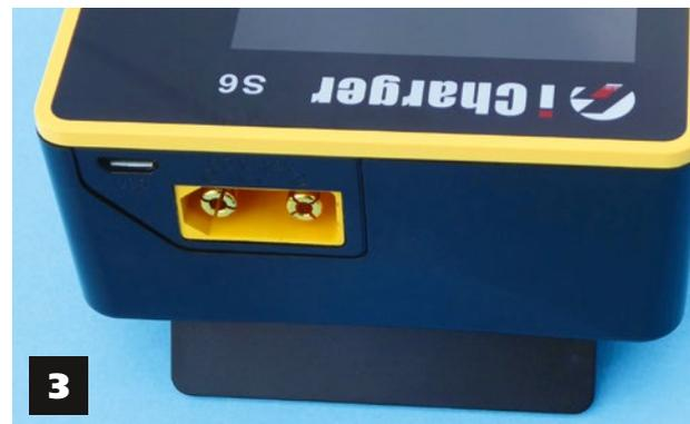
1) Akkuanschlüsse, der Multifunktions-Port sowie der SD-Karten-Slot sind im linken Seitenteil untergebracht. 2) Auf der rechten Seite befindet sich die Wippe zur Bedienung sowie ein kräftiger Lüfter. 3) Die Spannungsquelle wird über einen XT-90 Stecker auf der Rückseite angeschlossen, außerdem befindet sich dort ein Mini-USB-Port
