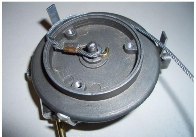
Das Drahtseil konnte eingehängt und nach dem Verschrauben der oberen Hälfte der Spule aufgewickelt werden
