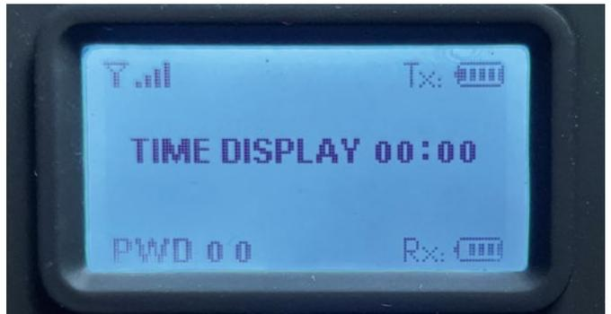
Auf dem kleinen Display der Fernsteuerung sind alle nützlichen Informationen abgebildet. Auch eine Akkuanzeige für Bagger und Fernsteuerung wurde integriert
