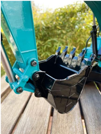
Der montierte Löffel hier ohne den neuen Schnellwechsler
