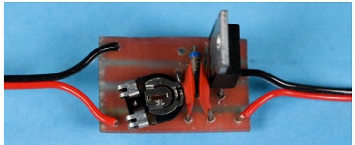
Bild 2: Musteraufbau des Transistorreglers
