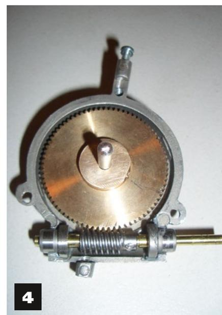
1) Fertige Oberseite der Ladefläche. 2) Dank einer vorher angefertigten Schablone passte die Plane wunderbar auf die Ladefläche. 3) Das Vorderteil des Fahrzeugs mit Details versehen und wieder auf dem Fahrgestell montiert. 4) Die Seiltrommel wurde funktionstüchtig gemacht
