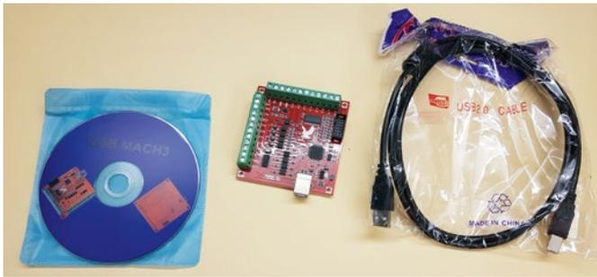
Im Lieferumfang der USB-Interfacekarte: CD-ROM mit Treiber und Mach3-Software, die USB-Karte und ein USB-Kabel
