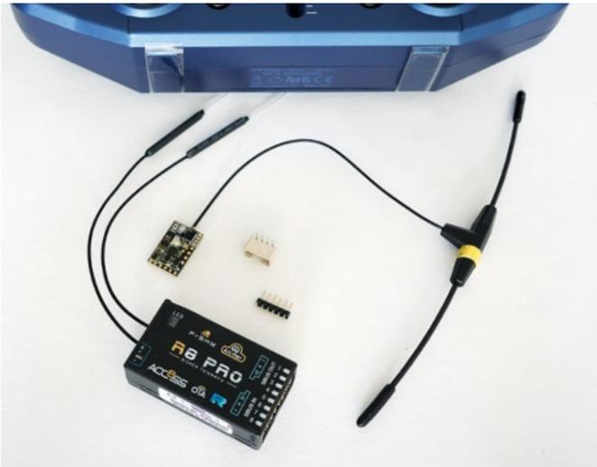
868-MHz- und 2,4-GHz-Empfänger können eingesetzt werden, und zwar einzeln oder parallel
