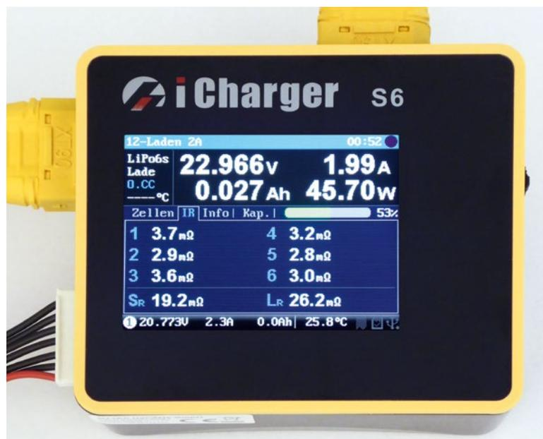
Die Werte der Innenwiderstände der einzelnen Zellen geben Aufschluss über die Leistungsfähigkeit
