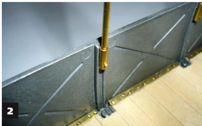
1) Auch die Heckklappe der Ladefläche erhielt neue Verriegelungen. 2) Die Halterungen für die Planenspiegel entstanden aus einem Messingröhrchen. Verschraubt wurden diese bündig mit der Oberkante der Bordwandhalterungen der Bordwand
