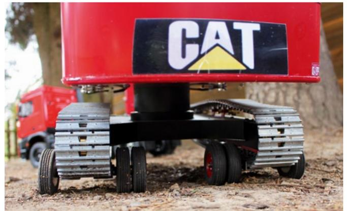
Um dem Bagger die „Rollschuhe“ anzuziehen, werden aus einem L-Profil vier gleich lange Schenkel abgesägt; zwei 5-mm-Rundstäbe auf Länge gebracht, mit einem Gewinde und Reifen versehen
