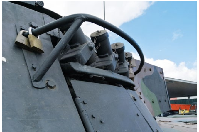
Auf beiden Seiten des Gefechtssturms befinden sich jeweils eine Nebelmittelwurfanlage
