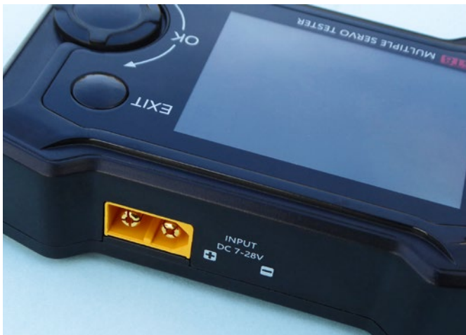
Auf der Rückseite erfolgt die Spannungsversorgung über einen ST-60-Anschluss
