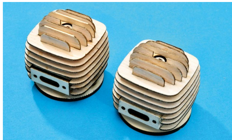
Diese selbstkonstruierte Zweizylinder-Benzinmotoratrappe macht deutlich, welche filigranen Strukturen sich realisieren lassen. Sowohl aus dünnem Sperrholz als auch beispielsweise aus schwarzem Polystyrol
