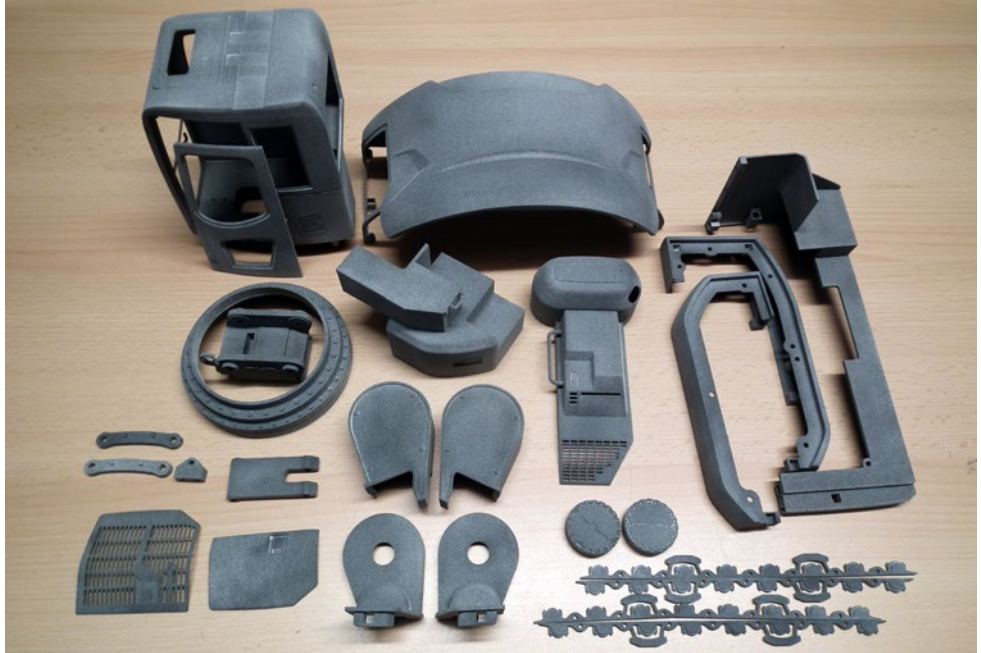
Eine ganze Reihe an optisch prägenden Elementen entstehen im 3D-Druck-Verfahren
