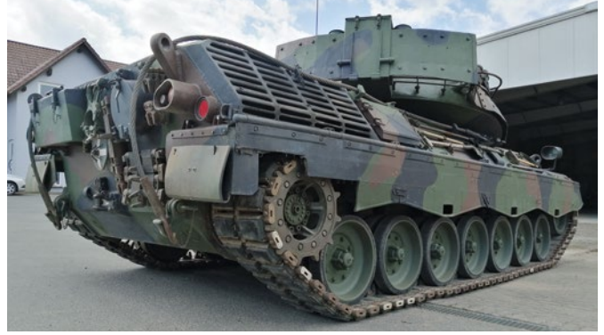
Die Grätings sorgen dafür, dass die Abluft abgekühlt und die Wärmesignatur des Panzer unauffälliger wird
