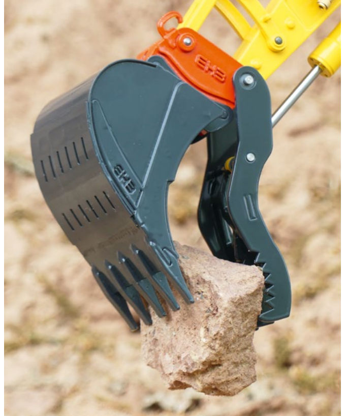
Während der mechanische Schnellwechsler genau wie ein einfacher Löffel zum Lieferumfang gehört, ist der Zweischaalen-Greifer als Zubehör separat zu erwerben
