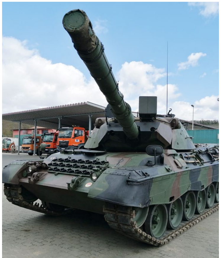
Das Hauptgeschütz lässt bis zu einem Winkel von 20 Grad anstellen
