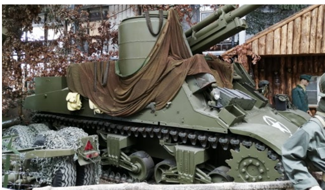
Die Panzerhaubitze M 7 B2 wurde 1941 für die US Army als leichtes, geländegängiges Artillerieunterstützungsfahrzeug entwickelt
