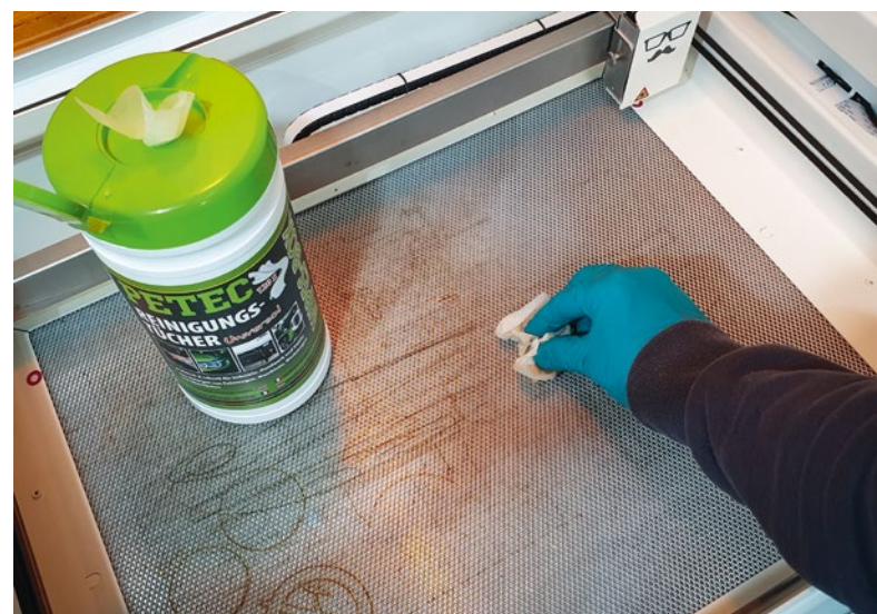
Mit Werkzeug-Reinigungstüchern lassen sich unvermeidliche Abbrand-Reste vom Gitterblech rubbeln
