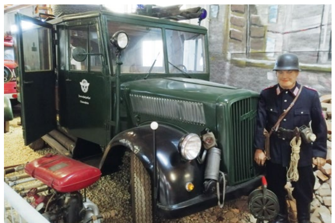
Das leichte Löschgruppenfahrzeug LLG auf Basis eines Opel Blitz-Fahrgestells
