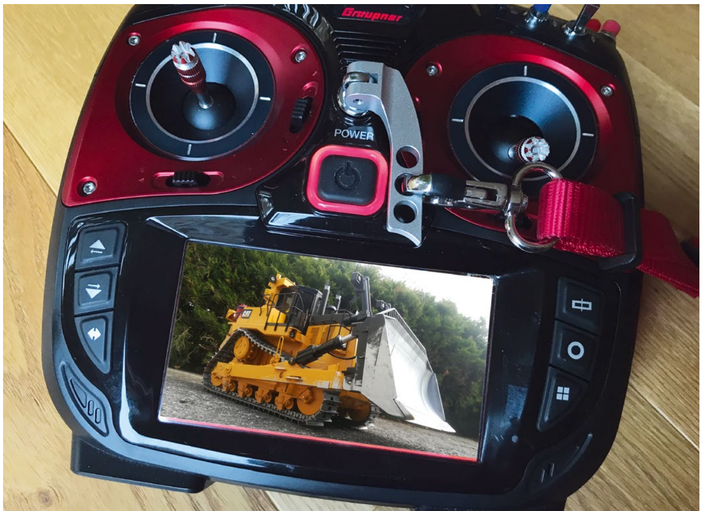
Die Verwendung von eigenen Modellbildern in verschiedenen Formaten im Senderdisplay dank neuer Firmware
