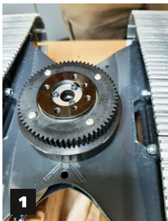
1) Das Modell mit elektrischer und hydraulischer Drehdurchführung eröffnet interessante Optionen, um mit Anbaugeräten den Spielwert zu steigern. 2) Der Sechsfach-Ventilblock kann bei Bedarf modular erweitert werden
