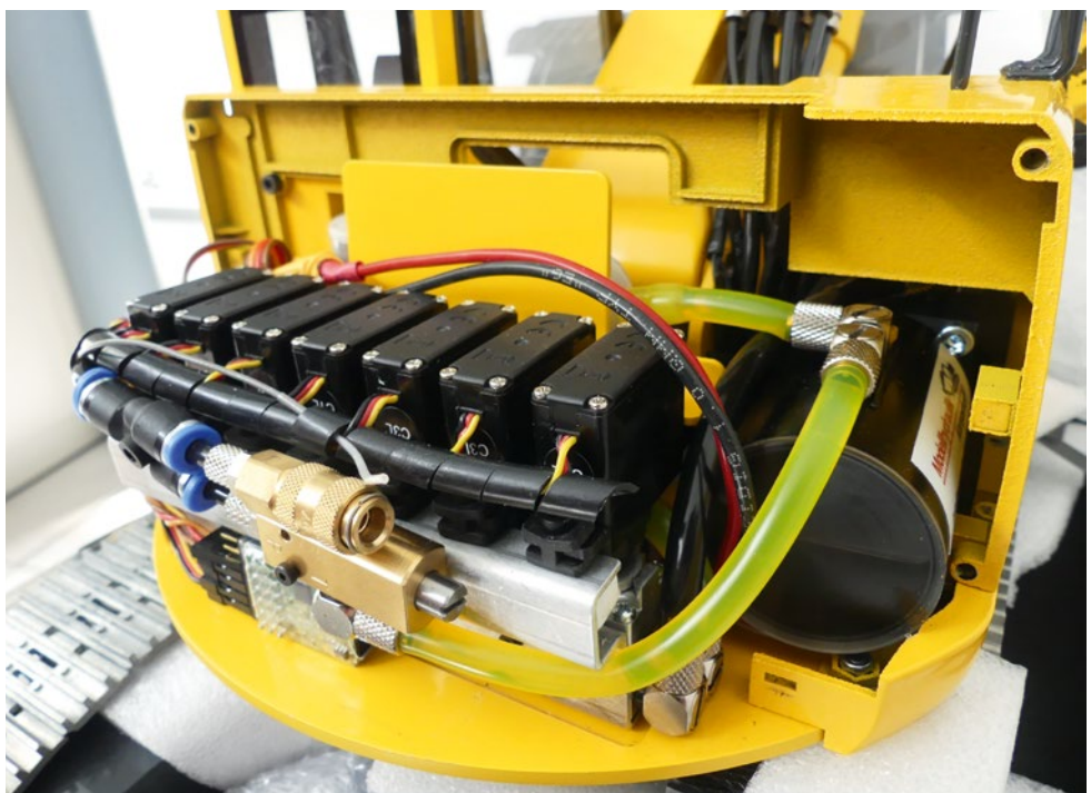
Der Kurzheckbagger bietet zwar ein vergleichsweise geringes Platzangebot, doch die erforderliche Technik kann dennoch untergebracht werden – sogar mit zusätzlichem Ventilblock
