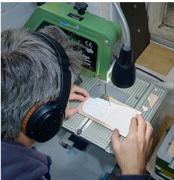
Früher war das so: Bauplan ausdrucken, aufs Holz aufkleben, dann mit der Bandsäge aussägen. Mit Übung und anschließendem Schleifen wurde das schon ordentlich
