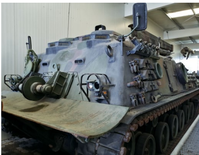
Der Bergepanzer M 88 wurde auf Basis eines M 48-Fahrgestells entwickelt
