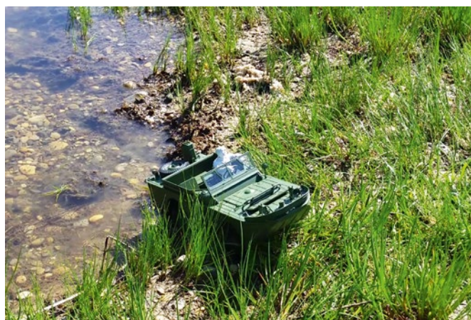
Wenn die Räder wieder Grund unter dem Profil spüren kann der Schraubenantrieb abgeschaltet werden und es geht im „Pkw-Modus“ zurück an Land
