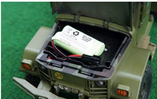
Mit dem 500-Milliamperestunden-Akku sind der Fahrzeit enge Grenzen gesetzt
