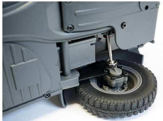
Die Heckfederung kann über ein Servo hochgedrückt werden, um eine gute Bodenfreiheit zu gewährleisten
