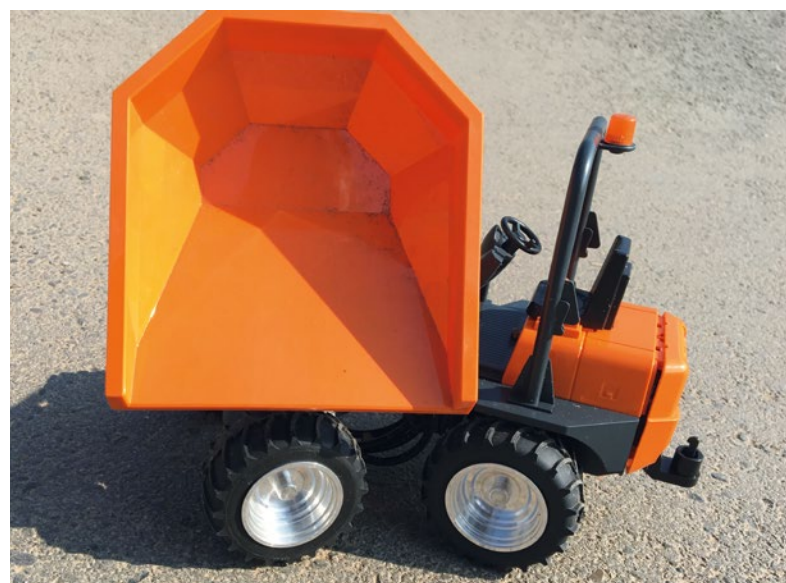
Der verbaute Drehkranz ermöglicht es, die Mulde in drei Richtungen zu kippen
