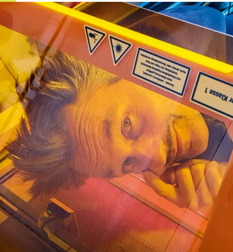
Der transparente Deckel ist nicht ohne Grund orange. Er filtert die schädlichen Laser-Lichtwellen heraus, sodass man dem Gerät bedenkenlos bei der Arbeit zusehen kann
