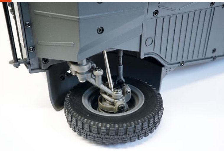
Alle Räder sind einzeln aufgehängt und Torsionsfedern sorgen für ein gutes Fahrverhalten
