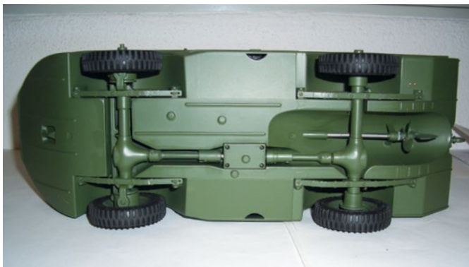
Von unten betrachtet sind Allrad- und der Schraubenantrieb mit Steuerruder zu erkennen
