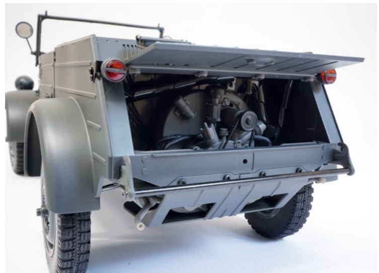
Irre, aber FMS hat den Bürstenmotor über den Riemen mit dem Luftkühlerventilator verbunden, der sich im Betrieb mitdreht
