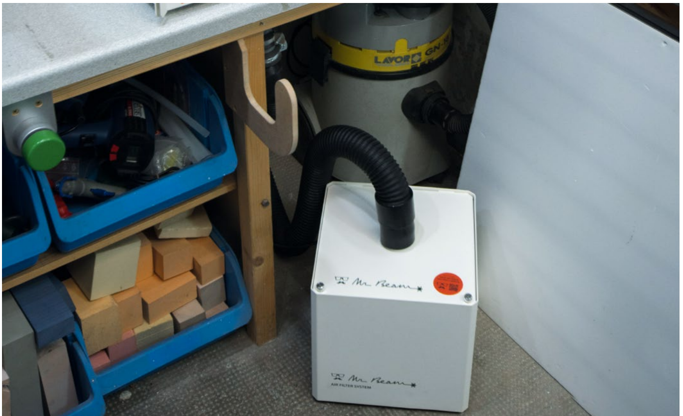
Unter der Werkbank findet neben dem Werkstattsauger die Aktivkohle-Filteranlage ihren Platz. Sie ist sowohl mit einem Abluftschlauch als auch elektrisch mit der Dreamcut S verbunden
