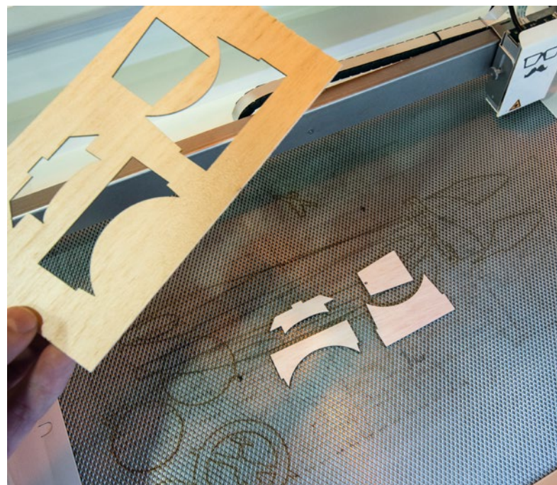
Heute geht das so: Fertige Teile aus dem Laser entnehmen. Auch ein passionierter Handwerker muss sich eingestehen, dass die Teile mit der Bandsäge weniger exakt gelingen
