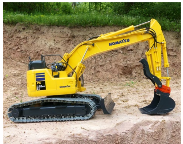
Gut zu erkennen ist die Anpassung des bisherigen PC228-11 mit Verstellausleger (links) an die Version mit Monoblockausleger
