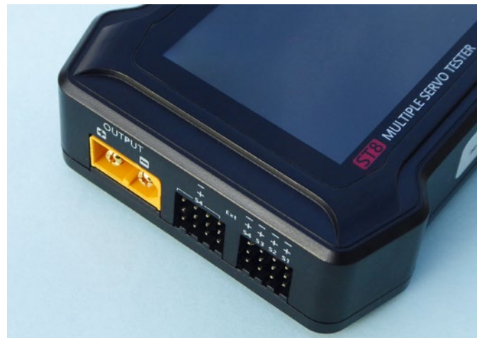
Über die linksseitig angebrachten Ausgänge können bis zu vier Servos einzeln oder kombiniert angesteuert werden
