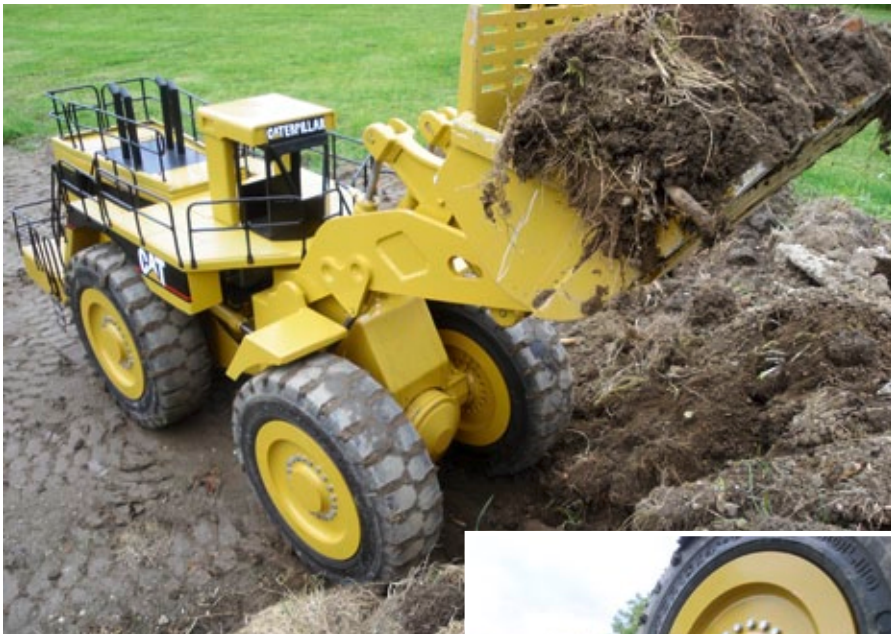
Eine volle Ladung kann schon 25 Kilogramm betragen, bis zu 30 Kilogramm steckt die Schaufel problemlos weg
