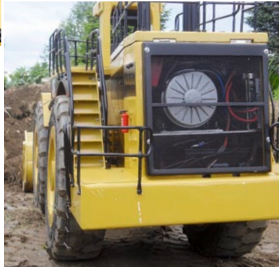
Durch das Kühlergitter ist für ausreichend Lüftung aller Komponenten gesorgt
