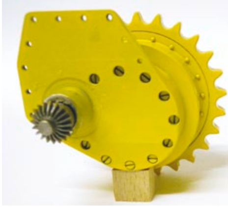
Rück- und Vorderansicht auf eines der beiden Fahrgetriebe. Gut zu sehen sind die Kegelräder zu den Elektromotoren
