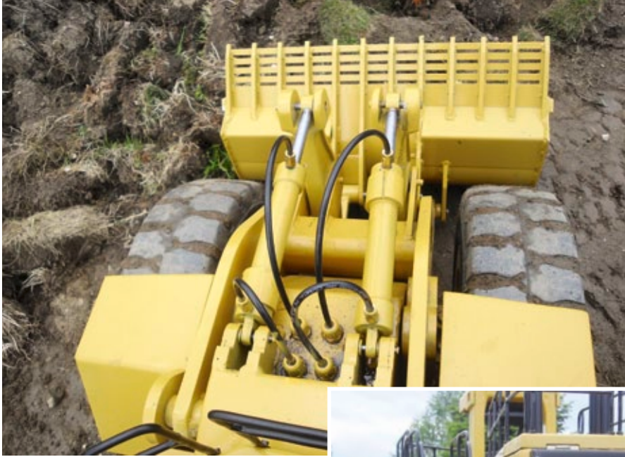
Die Durchführung der Schläuche mit einer PG-Verschraubung
