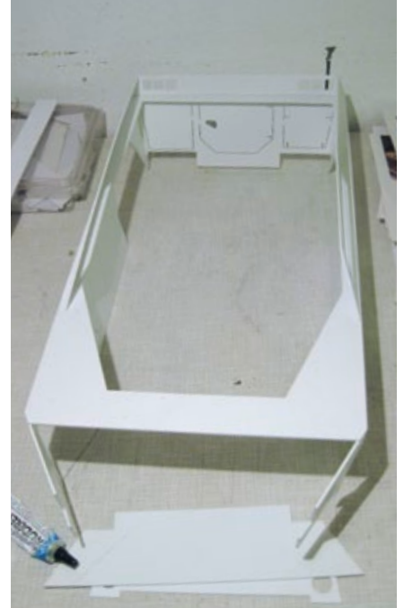
Die Einzelteile der Karosserie wurden aus einer Plastikplatte geschnitten und anschließend miteinander verklebt
