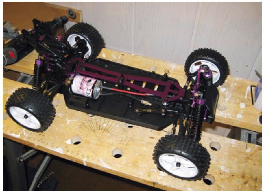
Die Basis für den Fennek bildet das Fahrwerk eines 1:10er-Buggys der Conrad Hausmarke Reely
