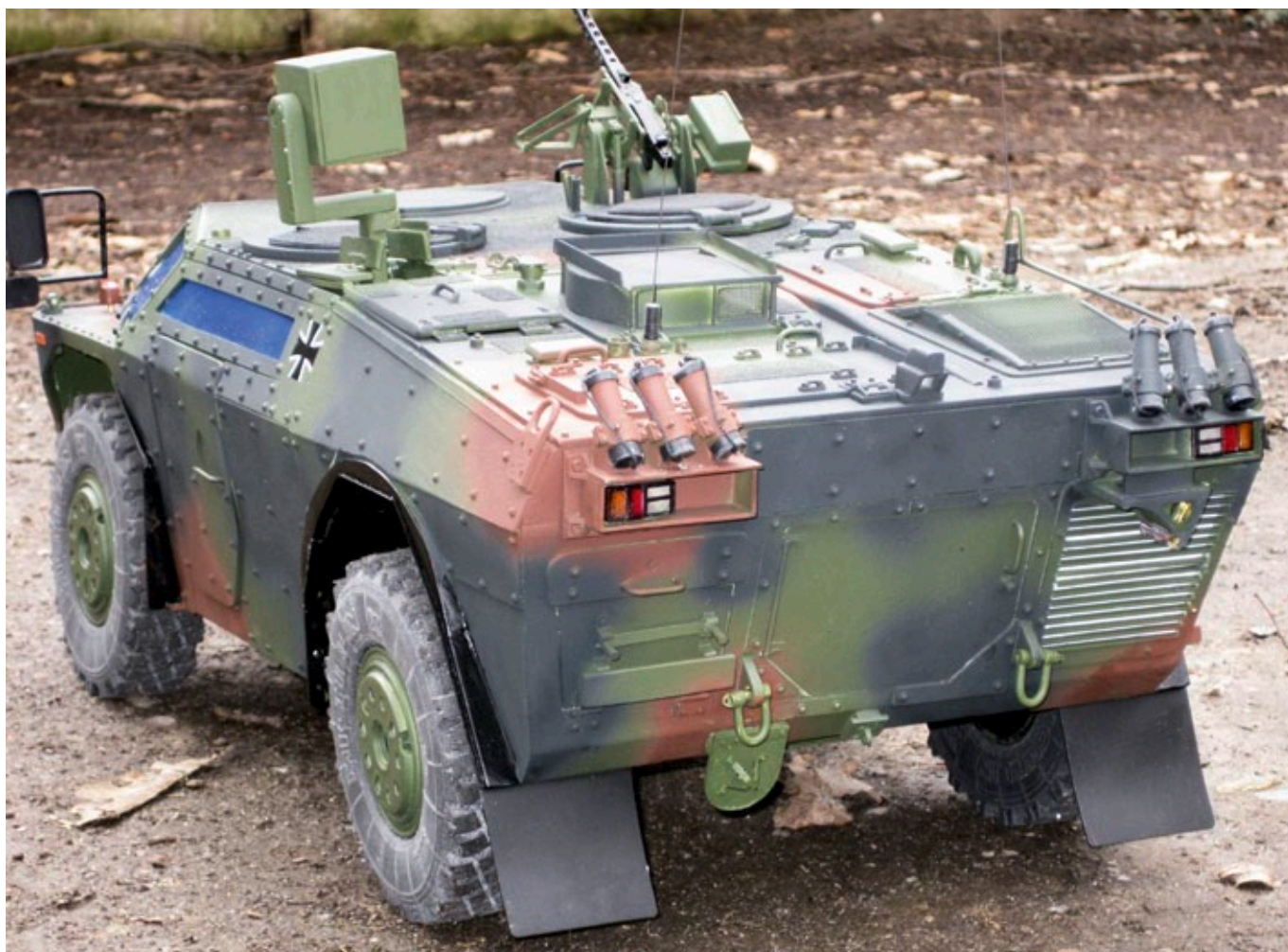
Der Sensorenmast des Fennek in eingefahrenem Zustand. Über ein Seilwindenservo kann dieses Bauteil ausgefahren werden
