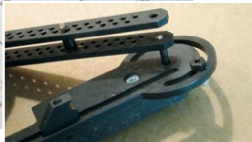
Der Biegeradius kann fein abgestuft eingestellt werden
