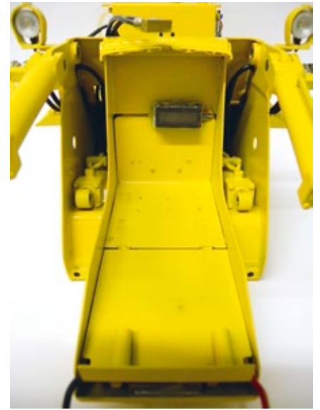
Der Motorraum mit geöffneter Bodenklappe und dem daran befestigten 10-Ampere-Sicherungsautomat. Unten befinden sich die zwei Fahrregler für die beiden Ketten
