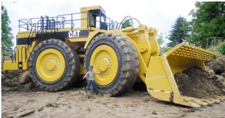
Durch die Knicklenkung ist er trotz der Größe sehr wendig
