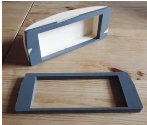
Das Heckgewicht entstand im STL-Druckverfahren. Der ausgefräste Kasten diente uns als Lager für den Akku, der zugleich ein gutes Gegengewicht zum Ausleger bot
