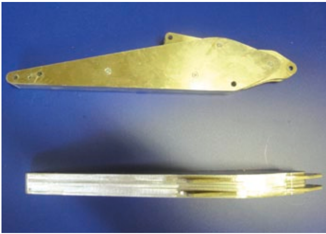
Der Aufbau der Stielkonstruktion erfolgte in Sandwichbauweise. Die nötigen Bauteile wurden in CAD erstellt und mittels Wasserstrahlschneiderverfahren gefertigt
