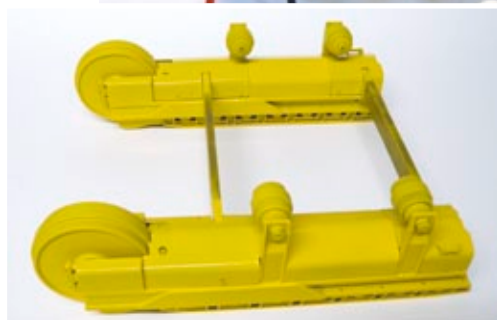
Die Raupenlängsträger wurden aus ausgefrästen Messingprofilen gefertigt. Da das Vorbildmodell über kein Pendelfahrwerk verfügte, konnten starre Quertraversen verbaut werden
