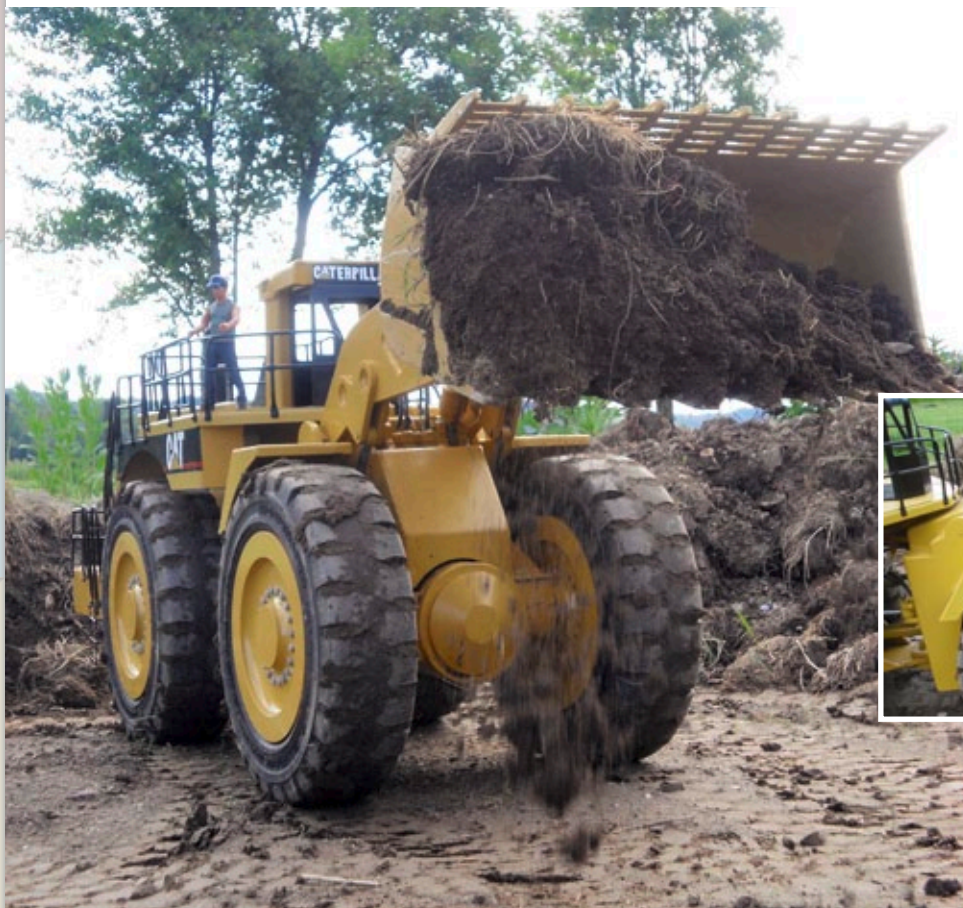
Die Hubhöhe reicht auch für große Muldenkipper
