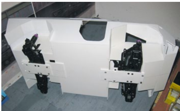
Die Achsen werden in die Radhäuser des Fennek eingepasst, die Dämpfer kommen später fast gerade stehend im Radhaus unter
