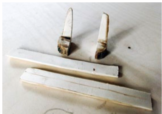
Die Füße für die Holzbänke können mit einer Stichsäge problemlos zurechtgeschnitten werden
