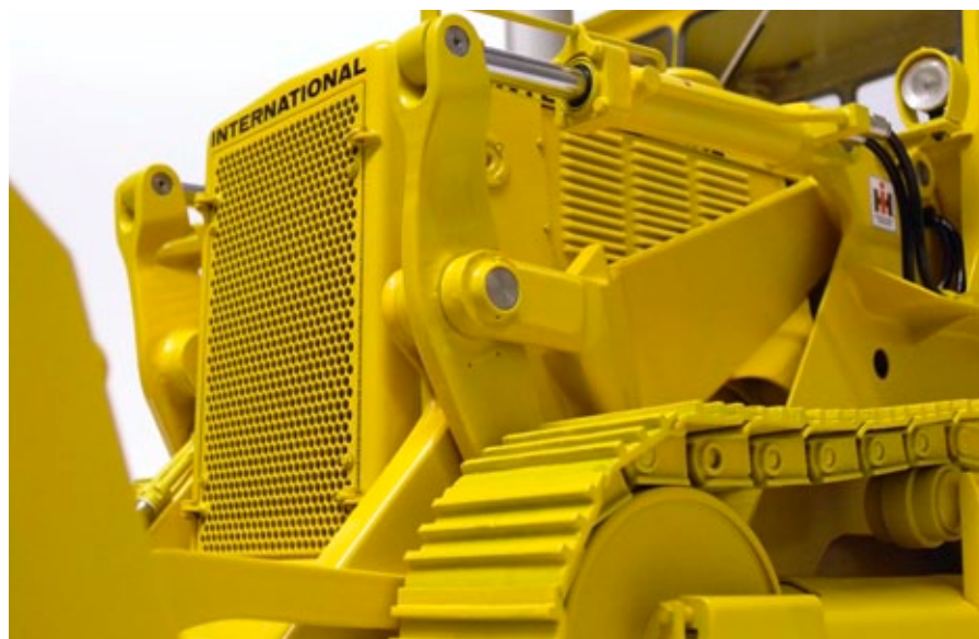
Das Kühlerschutzgitter war Fleißarbeit. Die Löcher wurden alle per Hand gebohrt
