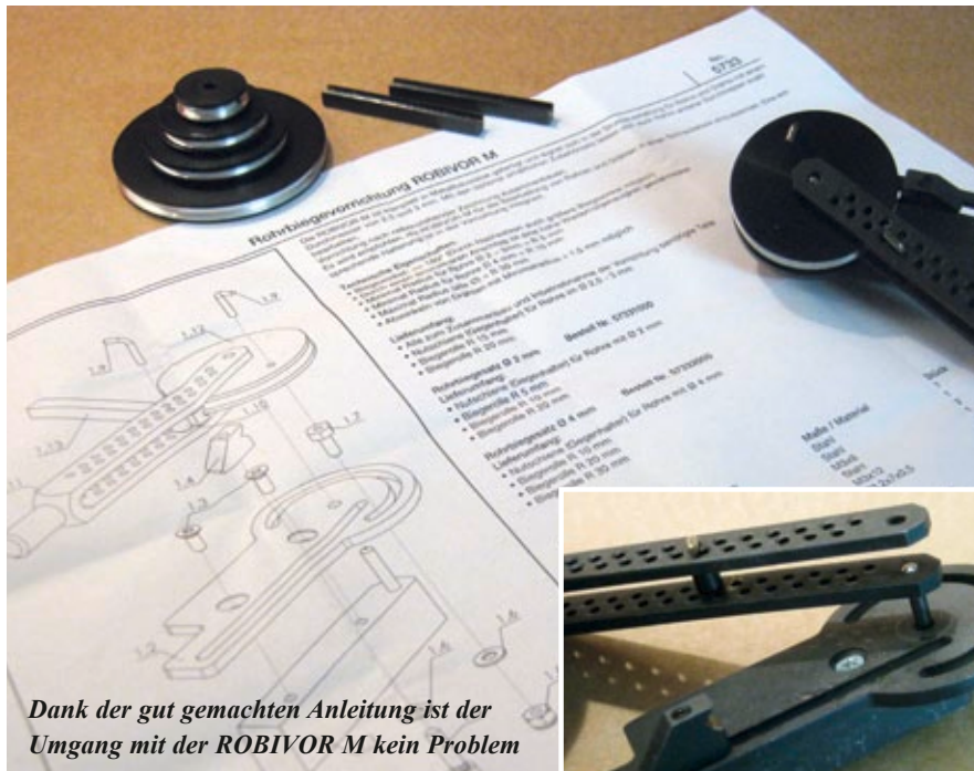
Der Biegeradius kann fein abgestuft eingestellt werden
