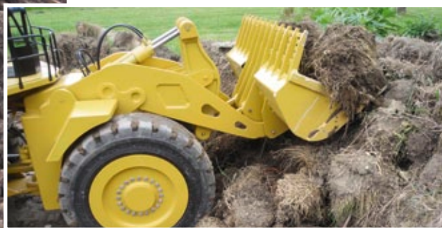
Die so genannte Z-Mechanik von CAT wird beim Modell möglichst vorbildgetreu nachgebildet
