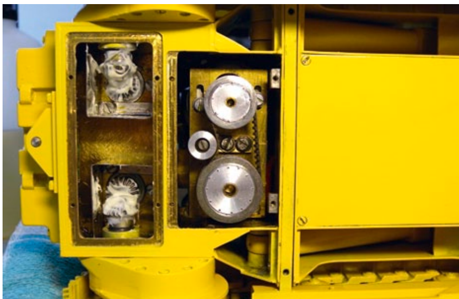
Die beiden Schmierkacheln der Kegelräder für den Fahrertrieb sowie der Riemenantrieb der Hydraulikpumpe
