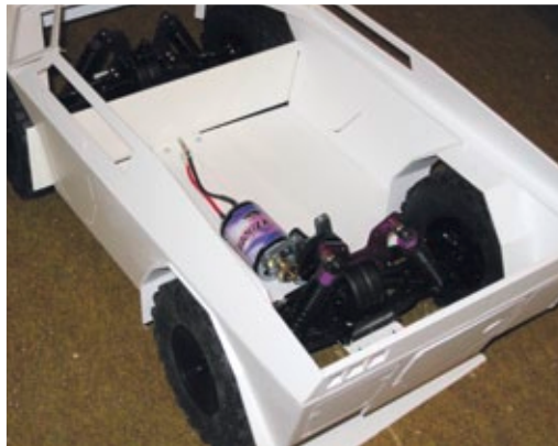
Der Antrieb der Hinterachse. Zum Einsatz kommt der Motor Rock Crawler 55
