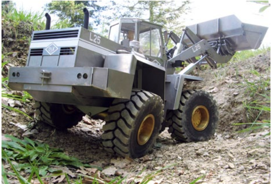
Die beachtliche Achsverschränkung und die ausgeklügelte Z-Kinematik des Schaufelarms gehören zu den konstruktiven Highlights des Modells
