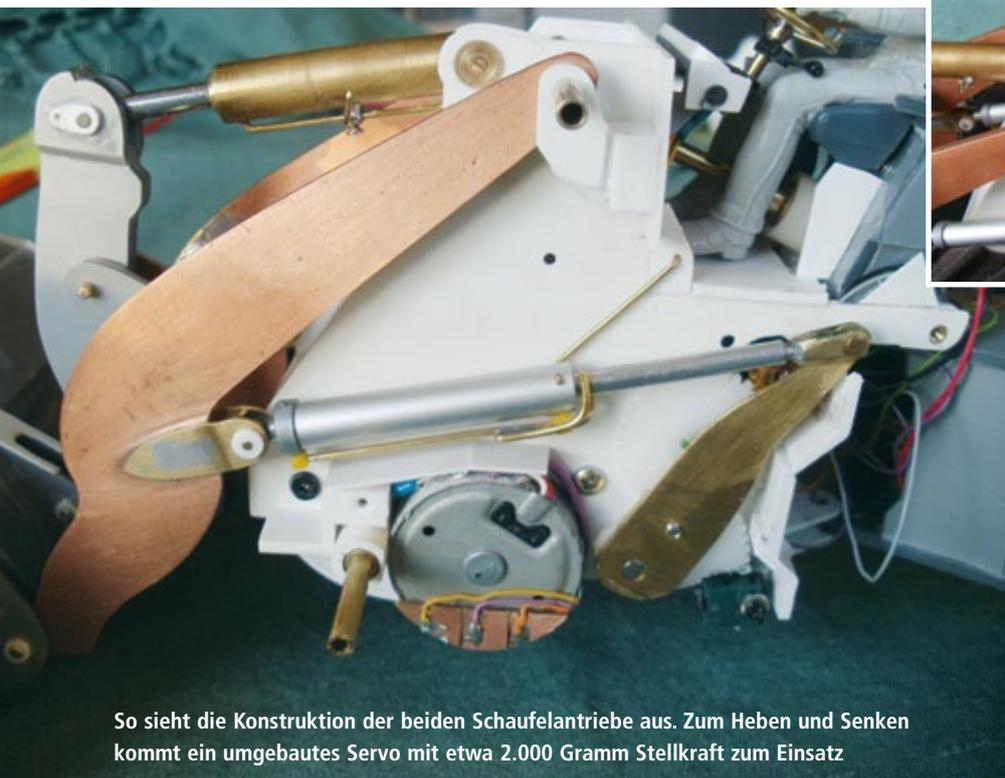
So sieht die Konstruktion der beiden Schaufelantriebe aus. Zum Heben und Senken kommt ein umgebautes Servo mit etwa 2.000 Gramm Stellkraft zum Einsatz
