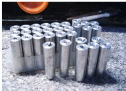
Je zwei Kunststoffplatten dienen als ein Rad. Sie werden von je zehn Aluminiumbolzen zusammengehalten
