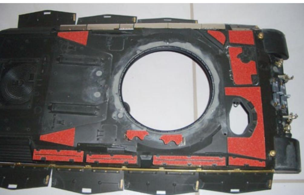
Als Grundlage für die Antirutschbeläge dient 60er-Schleifpapier, das mit einer Schablone ausgeschnitten und auf doppelseitigem Klebeband aufgebracht wurde
