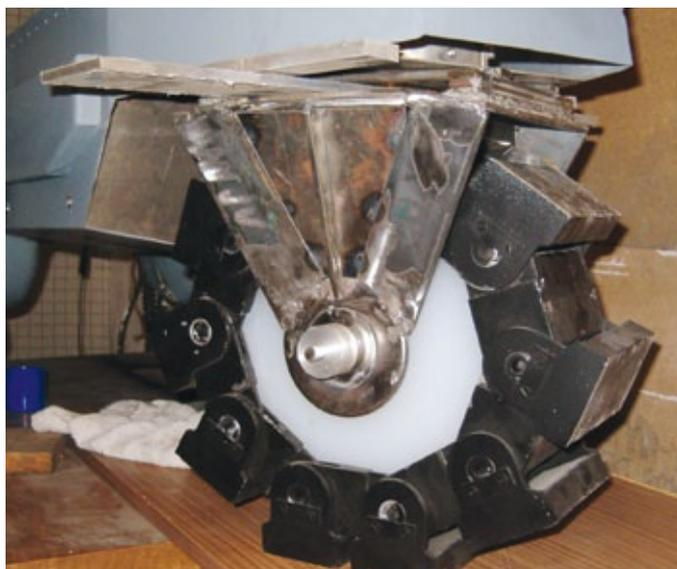
Fast fertig. An den Aluminiumbolzen sind die Kettenglieder aufgehängt. Gut zu sehen ist die Deichsel des Lenkschemels, über die der Specht gelenkt wird
