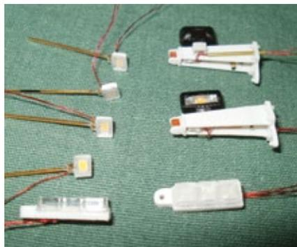
Die gesamte Beleuchtung des Laders. Die Versorgung mit Spannung erfolgt später zentral vom Vorderwagen aus
