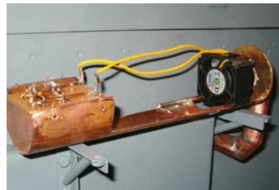
Der Smoker ist im Auspufftopf untergebracht. Durch einen alten PC-Lüfter wird der Rauch ins Freie gepustet
