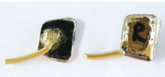
Aus weich verlötetem Messingblech und -rundmaterial entstanden die beiden Außenspiegel
