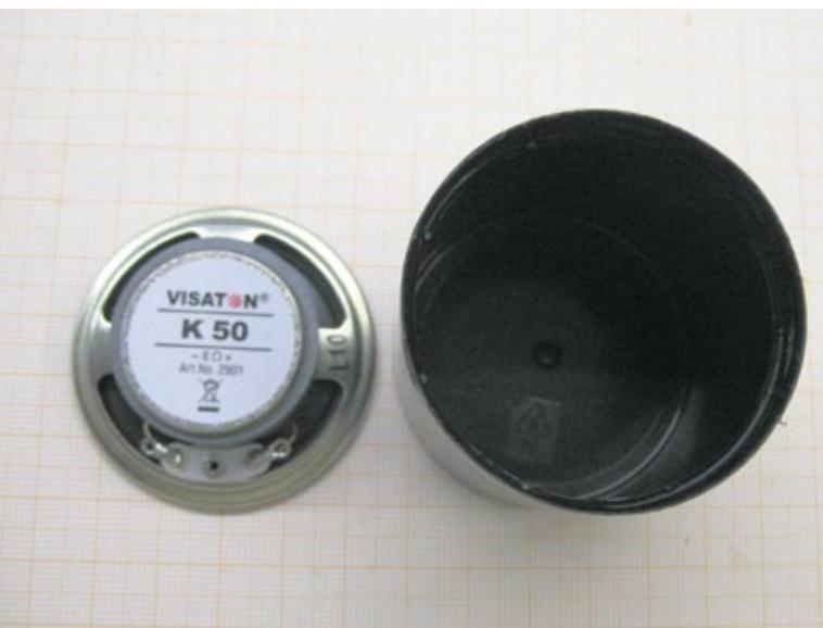
Ein handelsüblicher Dosendeckel dient als Resonanzkörper für den Lautsprecher und verleiht somit dem Soundmodul den nötigen Klang
