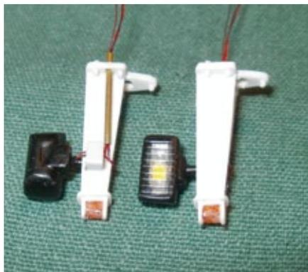
Hier sieht man den Aufbau der seitlichen Blinker. Die Scheinwerfer wurden später noch einmal neu und etwas kleiner angefertigt
