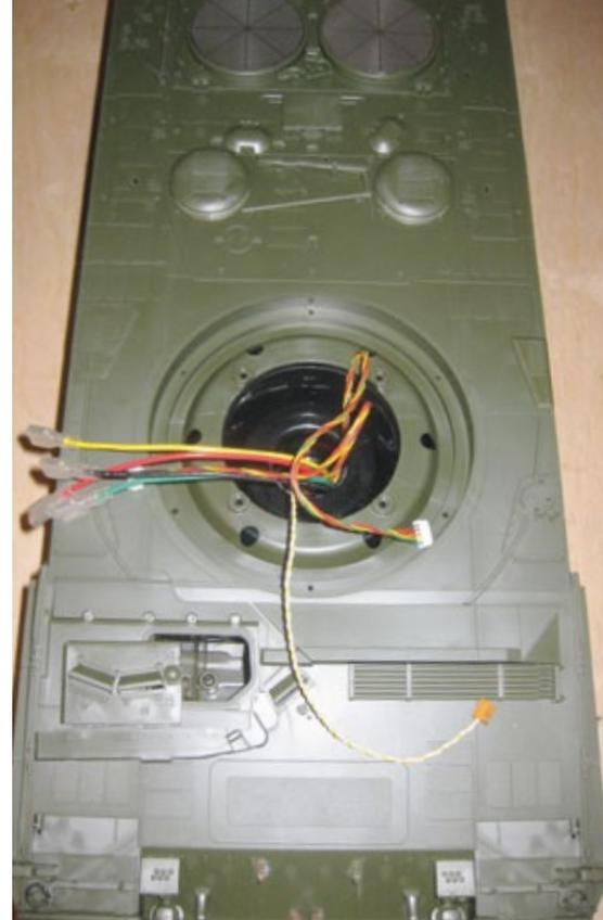
Die fertige Unterwanne: Entgegen der Anleitung sollte man diese nicht sofort auf das Fahrwerk setzen, da dieses bei der weiteren Montage erst einmal nur hinderlich ist
