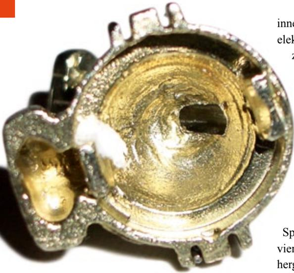
Die Kabeldurchführung in den vorderen Scheinwerfern war eine harte Aufgabe. Aber schließlich ist es doch geschafft und die Bohrungen für das Kabel durch die Scheinwerfergehäuse sind fertig
