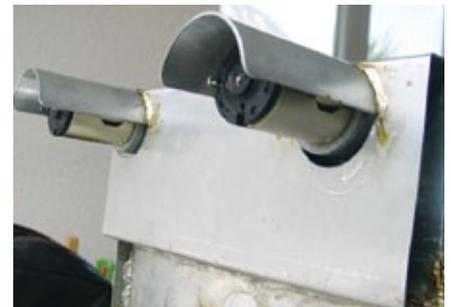
Die Motoren zum Drehen selbst liegen unter dem Einlauf und unter einem Aluminiumdach geschützt gegen patzende Lademeister
