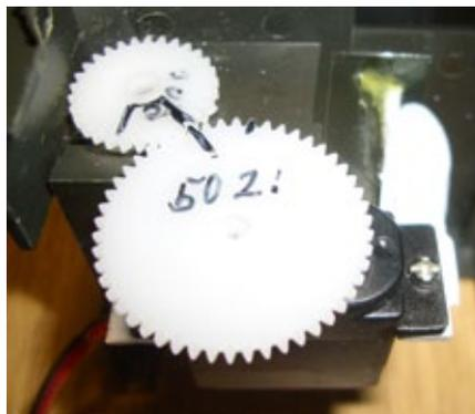
Meine Version des Ausfahrgetriebes des Heckradars: Auf dem Miniservo ist ein großes Zahnrad mit 50 Zähnen angeschraubt und ein Zahnrad mit 30 Zähnen auf der Welle des Radargehäuses
