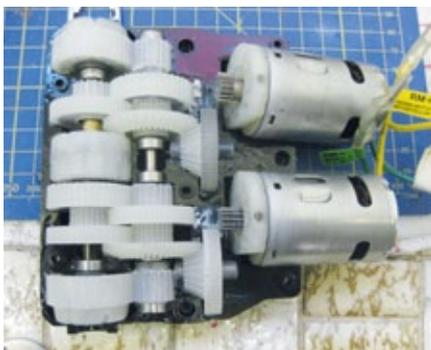
Der Fahr- und Lenkmotor werden an die Getriebebox angeschlossen. Das grüne und gelbe Fähnchen am Motorkabel zeigen, welcher Antrieb welche Aufgabe übernimmt
