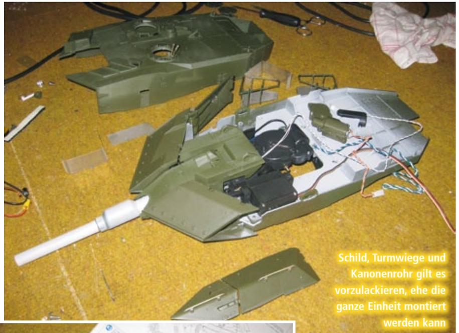
Schild, Turmwiege und Kanonenrohr gilt es vorzulackieren, ehe die ganze Einheit montiert werden kann
