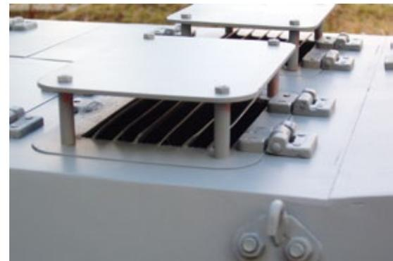
Unter den Lüftungsgittern, die beim Original den V12-Maybach-Motor mit Luft versorgen, sind im Modell die Lautsprecher der Soundanlage versteckt
