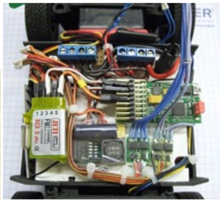
Nicht viel Platz für die benötigten RC-Bauteile. Von links nach rechts: Empfänger, BEC-, CTI-Schalt- und Soundmodul
