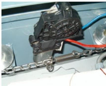
Die Kette dient jetzt nur noch der Dekoration. Damit sie stramm sitzt, wurde sie im Inneren des Lenkschemels geteilt und mit einer Feder gespannt
