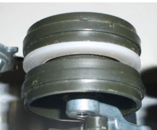
Die Führungszähne der vorbildgetreuen AFV-Ketten sind schmäler, als die in dem Bausatz enthaltenen Ketten. Damit die AFV-Kette nicht abläuft, wird eine Kunststoff-Beilagscheibe in der letzten Laufrolle vor den Kettenantriebsrädern eingeklebt
