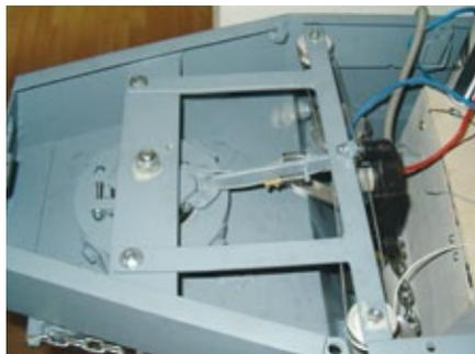
Da die Lenkung des Rollstuhls zu schwach für das Specht-Modell war, wurde aus einem alten Fensterheber-Motor eine entsprechende Alternative gefertigt
