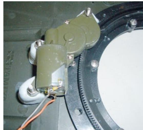
Da der Motor zur Turmdrehung beim Leopard im Turm selbst sitzt, muss die entsprechende Antriebseinheit am Dach der Oberwanne installiert werden
