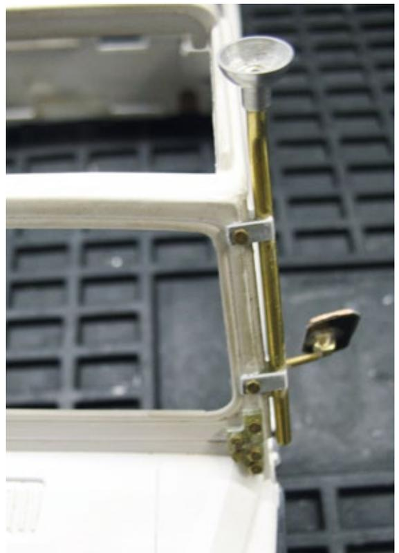
Ein passendes Messingrohr dient als Halterung für die Rundumleuchte
