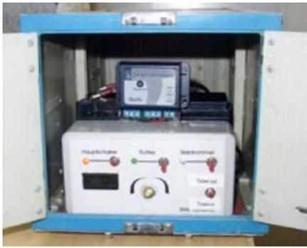
Über einen einfachen Vierkanal-Sender lässt sich die Anlage fernsteuern. Tatsächlich benötigt werden nur zwei Kanäle: Rütteln und Drehen (Trommel)
