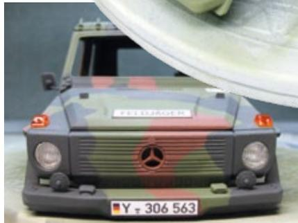
Mit Airbrush wurde die Camouflage-Optik hergestellt. Bei den Blinkern auf der Motorhaube kommen SMD-LED zum Einsatz
