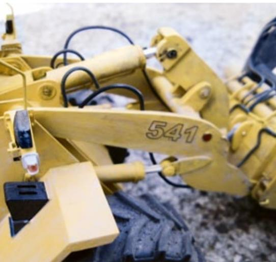
In 1,2 Millimeter dünnen Messingröhrchen werden Seilzüge zu den Zylinderimitationen geführt um dort über Umlenkrollen die Kolbenstangen zu bewegen
