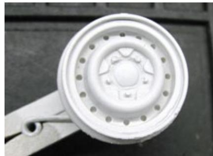
Die im Text beschriebenen M4-Hutmuttern passen perfekt in die Felgen der Hinterachse
