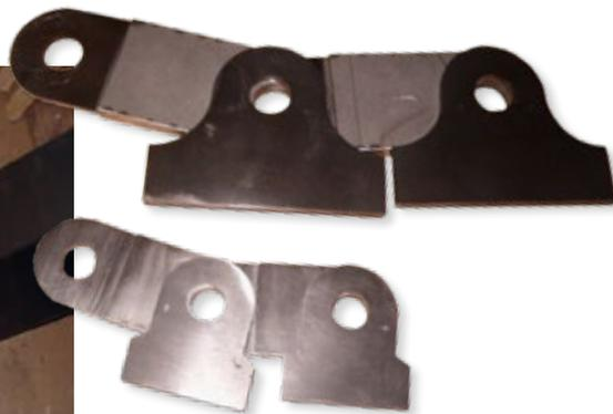
Die Einzelteile für Wanne und Kette wurden in einem CAD-Programm erstellt und anschließend gelasert
