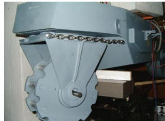
Der Lenkschemel des Hinterrads dient der Lenkung. Ursprünglich sollte über die Rollstuhlmotor-Einheit und die vorbildgetreue Kette die Lenkung erfolgen
