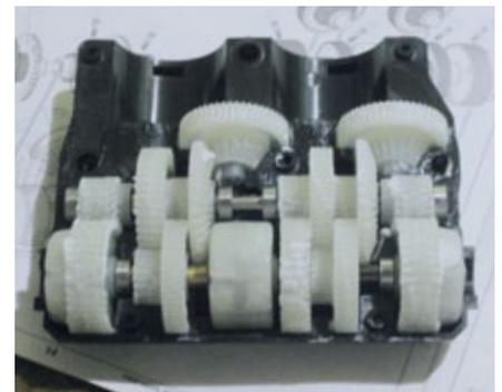
Ein Blick auf die bereits montierte Getriebebox. Hier sollte man mit dem Schmierfett nicht geizen
