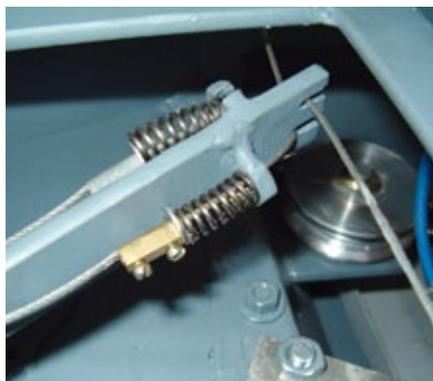
An dieser Stelle greifen die Seile des Fensterheber-Motors in die Deichsel und führen die Lenkbewegungen aus
