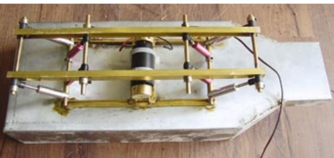
Der Einlauf in der Entstehung. Hier wird das Siebgut später eingefüllt und rutscht in die Anlage
