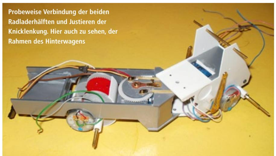
ausgebaut und durch ein 5K-Metallpoti als Achse des großen Zahnrads ersetzt. Zwei M2-Gewindebolzen sind für die Lagerung der Lenkhebel in das Zahnrad eingesetzt, diese werden dann mit dem Vorderwagen verbunden. Mit der Anfertigung der beiden Lagerböcke für die Hinterachse und den notwendigen Ausschnitten für die Motoren war dieser Rahmenteil vorläufig fertig.
