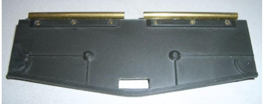
Damit die Scharniere auch an den zugeschnittenen Schürzen halten, werden diese mit 1 mm Sechskantschrauben aus Messing verschraubt
