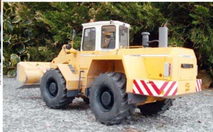
Für die Fahrerhausbefestigung habe ich zwischen Armaturenbrett und Rahmen einen 1-mm-Spalt frei gelassen, wo die Vorderkante passgenau eingeschoben wird, an der Rückseite des Fahrerhauses sind die beiden Gummipufferimitationen gleich wie beim Vorbild verschraubt. Die Beleuchtung wird über vier Federkontakte an der hinteren Unterseite des Fahrerhauses, vom Vorderwagen aus, mit Spannung versorgt.
