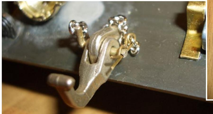
Komplett: Ein Schäkel mit Schäkelhalter, Sicherungsbolzen, Sicherungsplint und Sicherungskette
