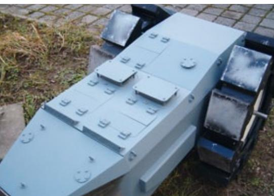
Die (fast) fertige Oberwanne, noch ohne Turm. Zu sehen sind die vielen Scharniere, die alle maßgeschneidert gegossen und anschließend mit Gewinden versehen wurden
