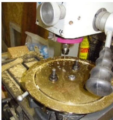
Die Entstehung der Messingkränze, wie sie an den beiden Enden der einzelnen Elemente der Siebanlage angebracht werden
