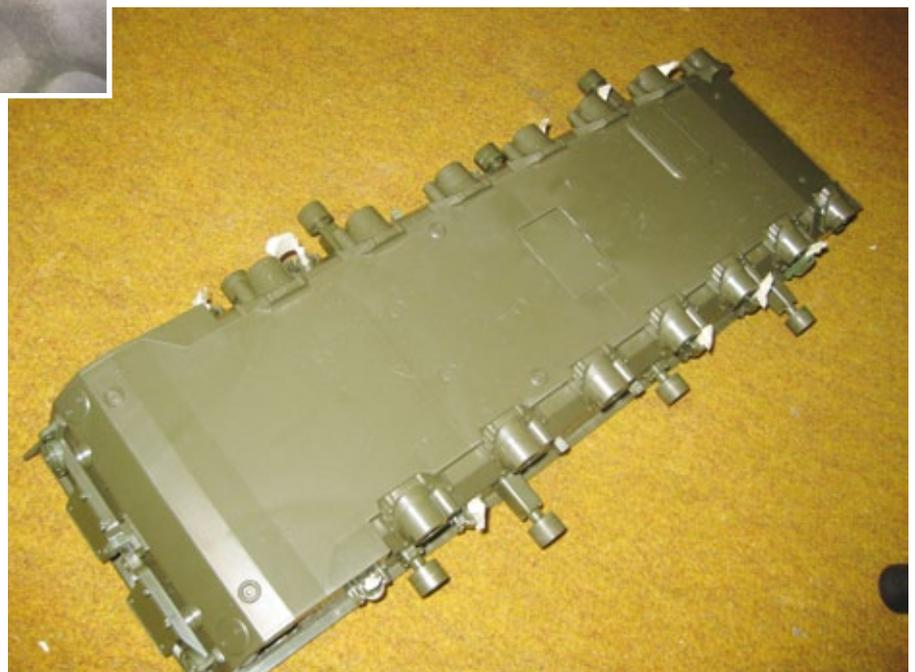
Die lackierfertige Unterwanne, noch bevor die Laufrollen und Schwingarme montiert wurden
