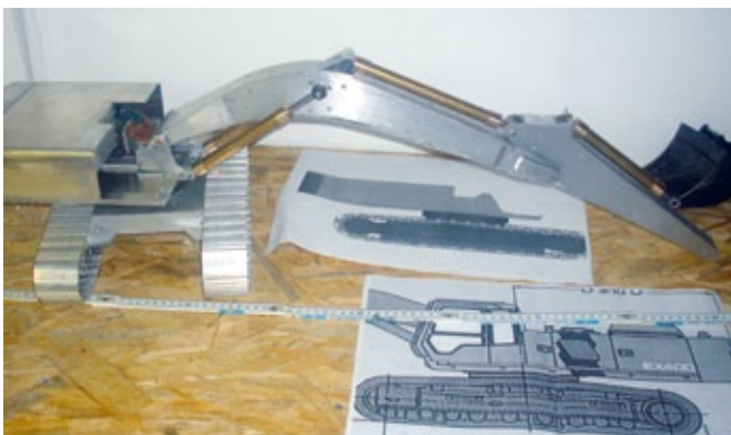
Die ausgedruckten Zeichnungen aus dem Herstellerprospekt dienten teilweise direkt als Schablonen beim Aussägen und Feilen der Blechteile des Auslegers
