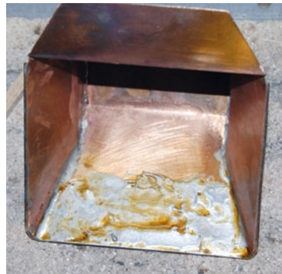
Damit der Kippvorgang auch nach Anbau etlicher Details noch sicher klappt, wurde eine Menge Lötzinn aufgetragen
