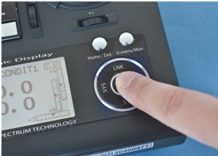
Die Menüführung erfolgt über das verschleißfreie Cap-Touch-System. Das Handling ist zunächst etwas gewöhnungsbedürftig
