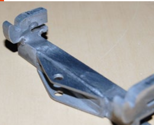
Die Lagerung für die Mulden-Entriegelungswelle wurde auf dem Rahmen ausgerichtet und verlötet
