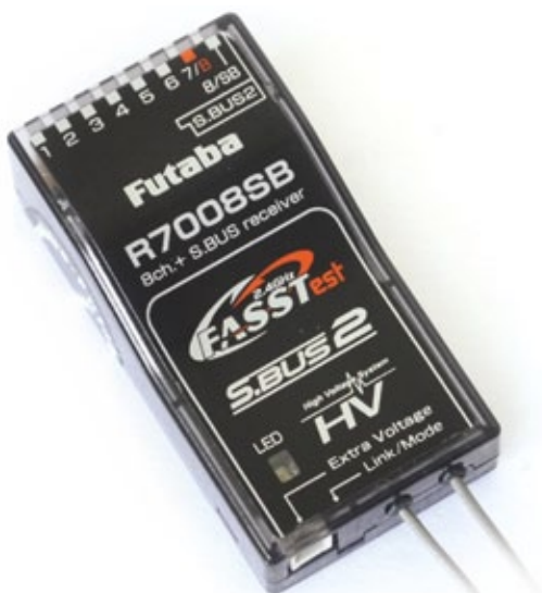
Zum Lieferumfang des Senders gehört ein R7008SB-FASSTest-Empfänger. Dieser ist telemetriefähig und wiegt lediglich 13 Gramm
