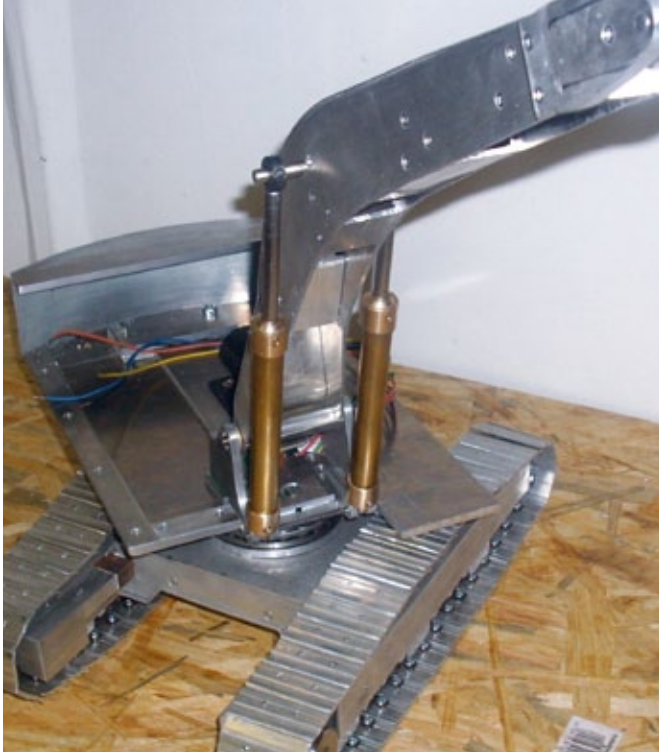
Hier erkennt man das Konstruktionsprinzip des Monoblocks mit den äußeren 2-Millimeter-Blechen und den Abstandshaltern aus Vierkant-Rohr im Inneren
