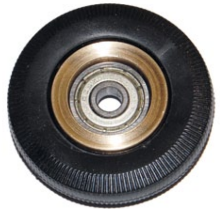
Der Reifen eines DDR-Ferlenkautos wurde auf eine selbst gedrehte Messingfelge gezogen und mit einem Kugellager versehen
