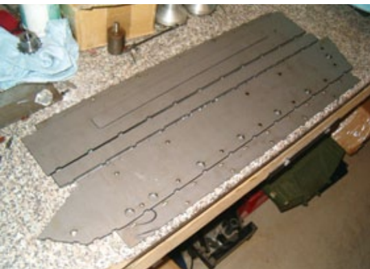
Die gelaserten Teile für die Unterwanne warten auf die Endmontage
