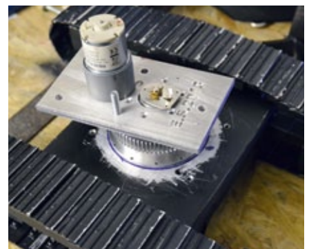
Anpassungsarbeit: der Alu- Unterwagen in erster Version mit dem Drehkranz und Schwenkantrieb in zweiter Version
