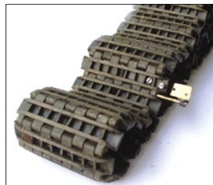
Zum schnellen Ab- und Auflegen der Ketten kommt ein Messing-Stab zum Einsatz, an dem eine kleine Messing-Lasche befestigt ist
