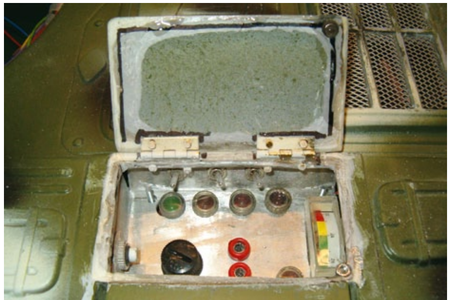
Da die Schalter unter einer Abdeckung versteckt sind, wird der gute optische Eindruck der Oberwanne nicht beeinträchtigt
