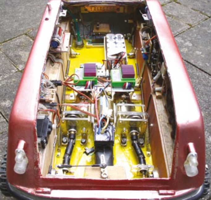
Ungewöhnliche Modelle bedürfen ungewöhnlicher Lösungsansätze: Zwischen den Antriebssträngen für die Ketten ist der Jet-Antrieb für den Vortrieb im Wasser platziert
