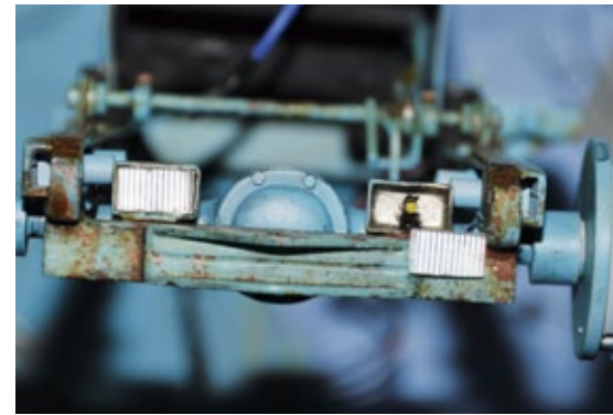
Zum Ende wurden die Scheinwerfer verklebt, deren Verglasung von CD-Hüllen stammt
