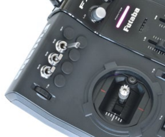
Die Bedienelemente der FX-32 sind im oberen Bereich des Senders platziert. Sie sind gut erreichbar, auch ohne die Kreuzknüppel loslassen zu müssen
