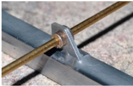
Die Lagerung für die Mulden-Entriegelungswelle wurde auf dem Rahmen ausgerichtet und verlötet
