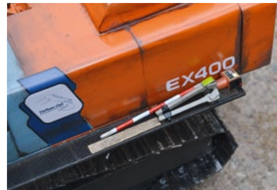
Das Nivelliergerät entstand aus einer Lüsterklemme und einem Playmobil-Kamerastativ
