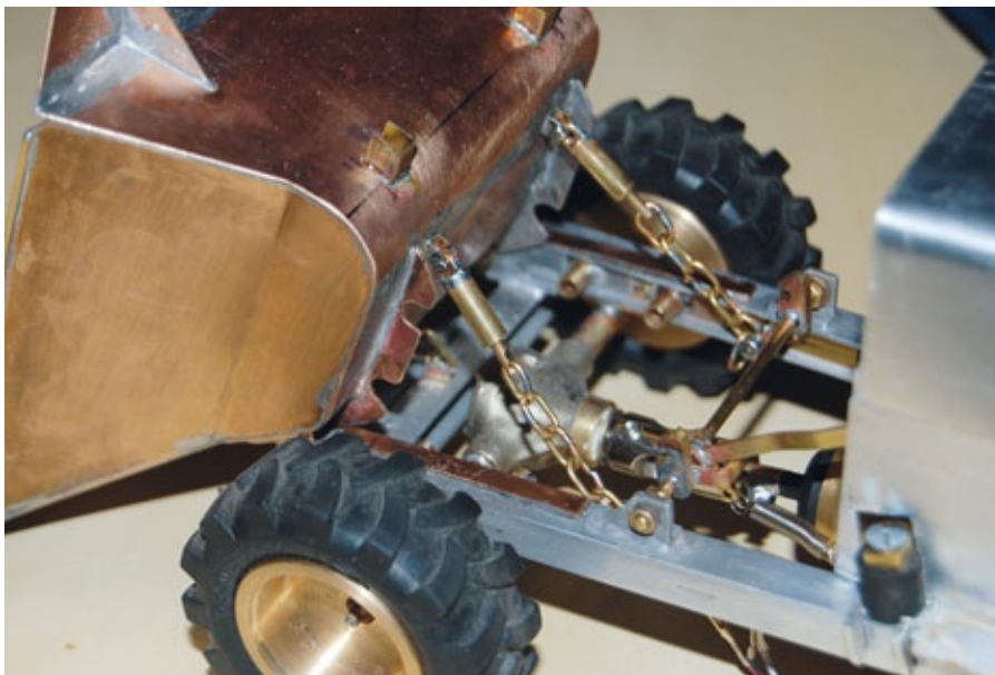
Nach dem Entriegeln der Mulde wird sie beim Kippen von Federdämpfern gebremst
