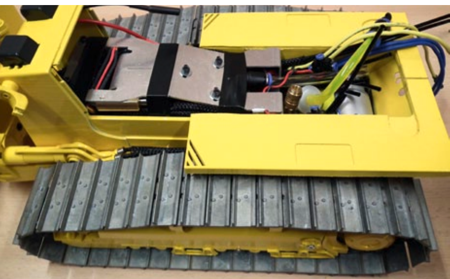
Nachdem die Einheit in die Wanne geschoben wurde, müssen nur noch die Leitungen verbunden werden
