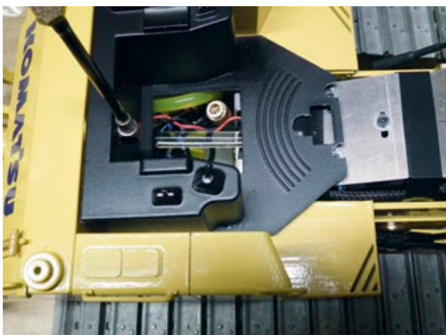
Die erforderlichen Ausschnitte für die Tankentlüftung sind bereits in den 3D-Druckteilen vorhanden
