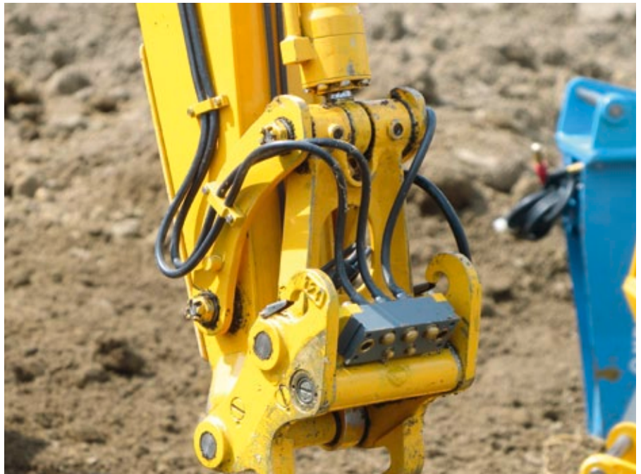
Die Modell-Version des Likufix-Systems funktioniert elektronisch. Schwarze Silikonkabel erwecken jedoch den Eindruck, das wie im Original eine Hydraulik im Einsatz ist
