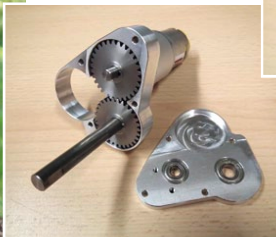
Die vormontierten Getriebe sind aus genauso hochwertigen wie passgenauen Komponenten gefertigt
