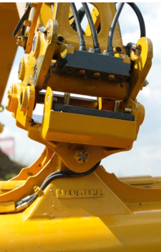
Die Silikonkabel zur Imitierung eines Hydrauliksystems mussten präzise verlegt werden, sodass weder eine zu große noch eine zu geringe Spannung herrscht
