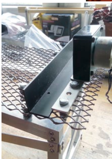
Der Motorhalter wird mit vier Schrauben am Sieb befestigt
