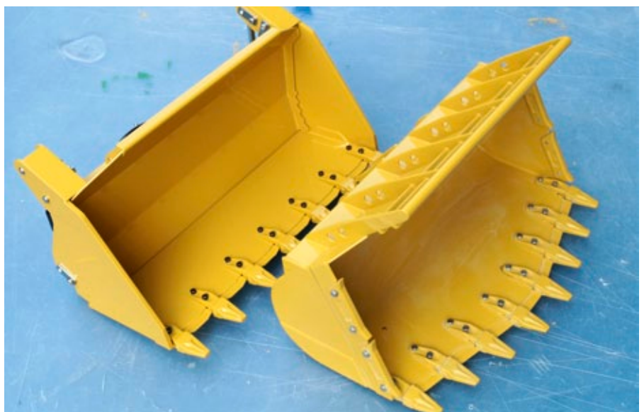
Vergleich der beiden Schaufeltypen: links Kombischaufel, rechts Felsschaufel
