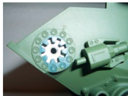
Mit Hilfe dieser sternförmigen Aufnahme im Wannenbug wird die Kettenspannung eingestellt. Eine Stahlschraube befestigt die Spannrolle mit der Aluplatte darunter
