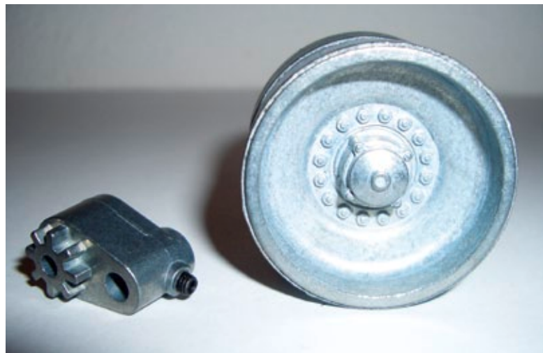
Auch bei der Spannrolle sind die Radnabe und die nachgebildeten Schrauben gut wiedergegeben
