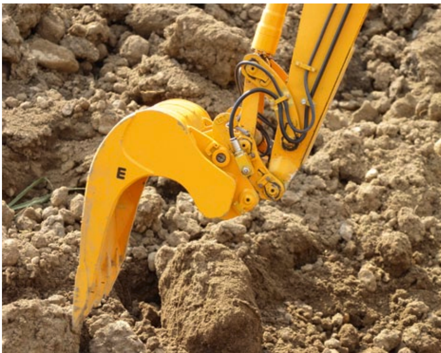
Die Anbaugeräte sind aus Messing gefertigt und in Liebherr-Gelb lackiert worden
