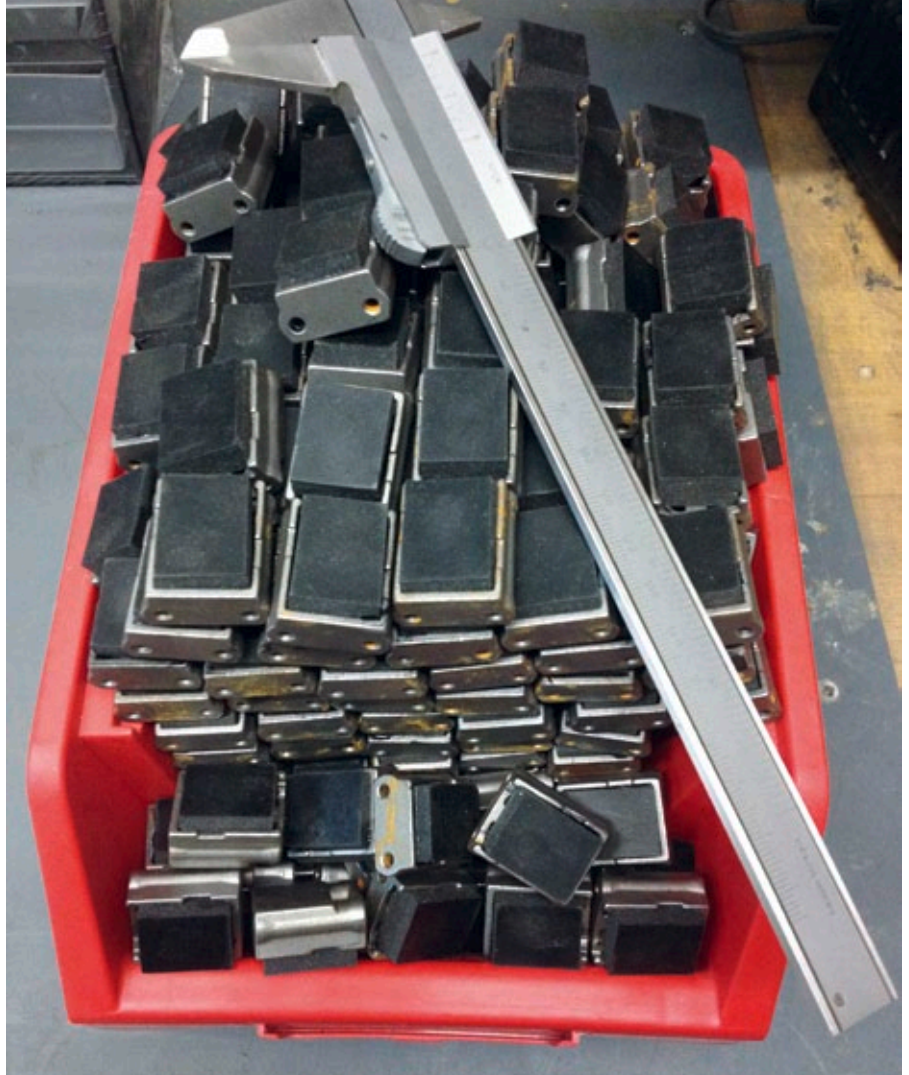
Serienfertigung: Die Kettenglieder warten auf die Montage
