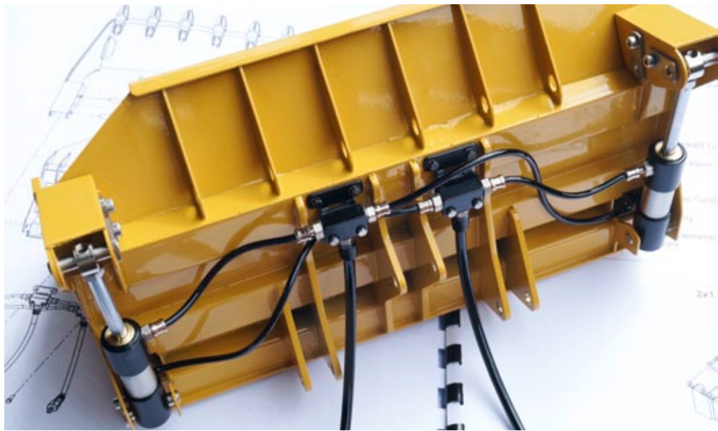
Die Kombischaufel mit der installierten Hydraulik: die beiden schwarzen Kästen in der Mitte sind die Verteiler zu den beiden Zylindern
