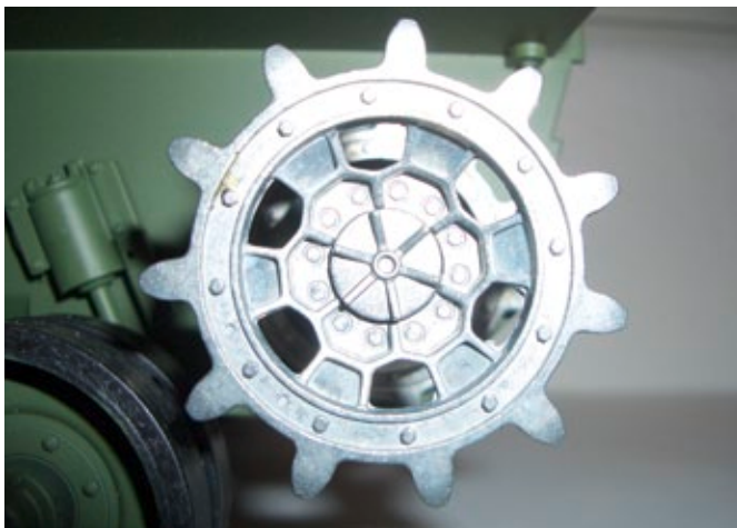
Betrachtet man das Kettenantriebsrad genau, erkennt man die angeformten Schrauben, mit welchen beim Vorbild das Kettenblatt montiert ist
