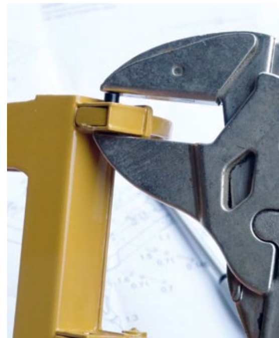
Das Einpressen der Messingbuchsen an den Zähnen des Heckaufreißers geschieht am besten mit einer hochwertigen Zange mit parallelen glatten Backen. Meine ist von Knipex, war entsprechend teuer und tut schon seit vielen Jahren ihren Dienst – nicht nur im Modellbau
