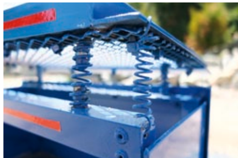
Gut zu sehen sind eine der gelagerten Hauptfedern und das Gegenstück zum Motorhalter
