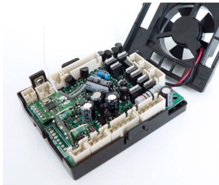
Die komplett steckbare Empfänger-, Sound- und Steuerungsplatine ist sauber verarbeitet und mit 67 x 55 x 29 mm recht kompakt. Rechts kann man gut die MOS-FETs für die Ansteuerung der 380er-Motoren erkennen
