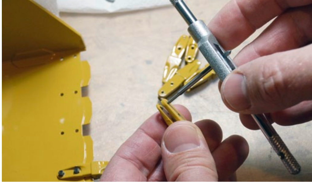
Mit einem M2-Gewindeschneider lassen sich die Gewinde in den Schaufelzähnen schnell nachbohren, sodass die feinen Schrauben ohne Gewalt eingedreht werden können
