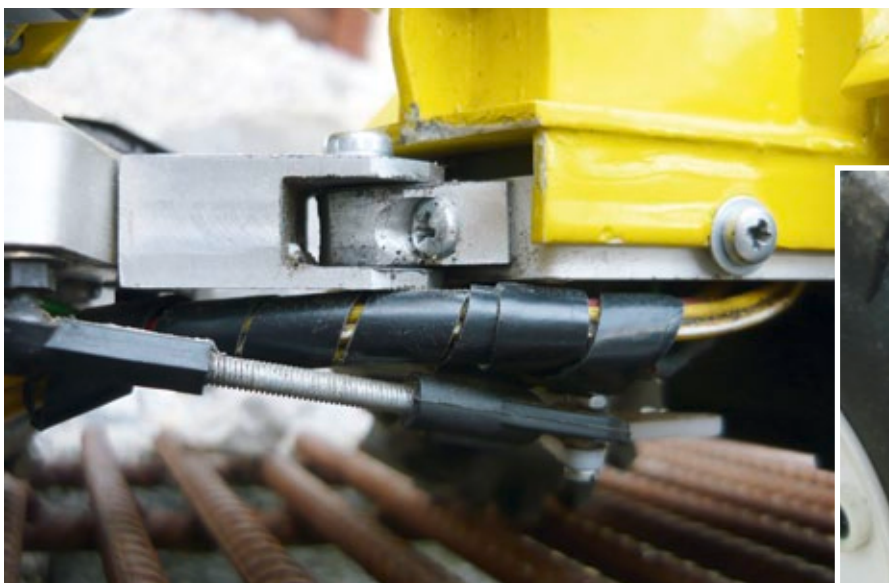
Das Kernstück des Dumpers ist das Dreh- und Knickgelenk mit Kabelführung
