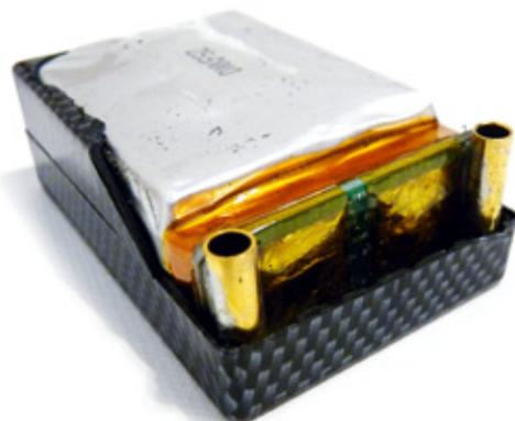
Bei billigen Zellen kommen entweder sehr dünne oder gar keine Platinen zur Stabilisierung der internen Akkuanschlüsse (Tabs) zum Einsatz. Hier sind allerdings sehr saubere Lötstellen der Tabs und der Buchsen zu erkennen
