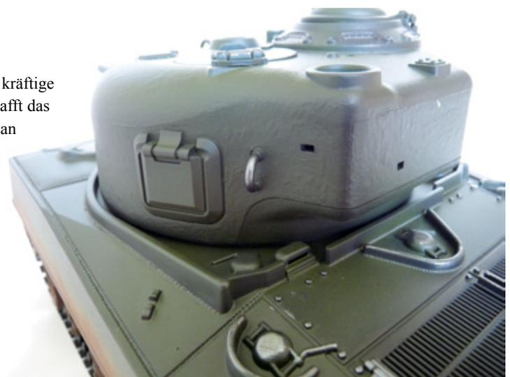
Die leicht pickelige Oberfläche des aus einem Stück gegossenen Vorbild-Turms und die Schweißnähte wurden fein detailliert wiedergegeben. Die seitliche Luke für Munitionsübernahme und Hülsenauswurf ist nicht zu öffnen
