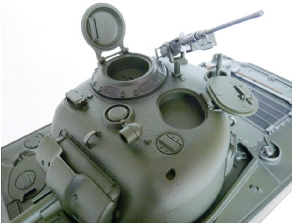
Neben dem typischen 12,7-mm-MG vom Typ Browning M2 finden sich im RTR-Set noch etliche weitere Anbauteile für den Turm
