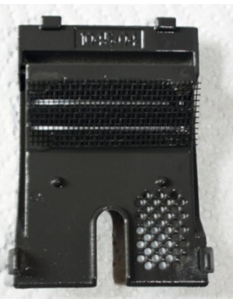
Unter den Lüftungsschlitzen der Motorhaube montierte ich ein Kunststoffnetz
