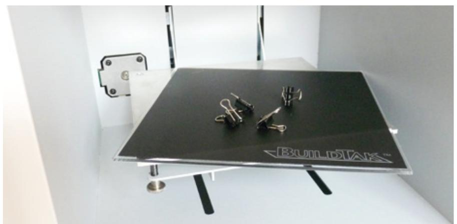
Die eigentliche Druckoberfläche besteht aus einer 2 Millimeter dicken Acrylglasplatte, die mit einer speziellen sehr stark haftenden Oberfläche versehen wurde
