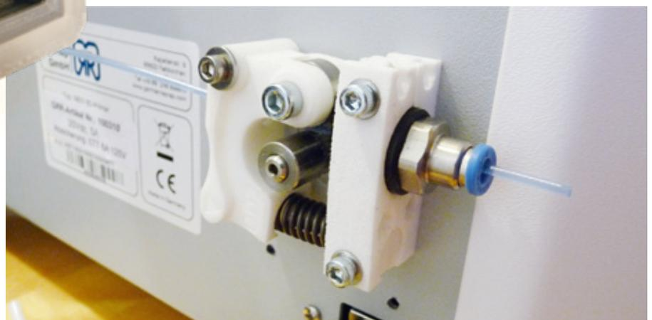
Die Extruderkonstruktion ist einfach gehalten und sorgt für einen konstanten Anpressdruck des Filaments. Je nach genutztem Filament wäre eine Einstellbarkeit des Federdrucks von Vorteil
