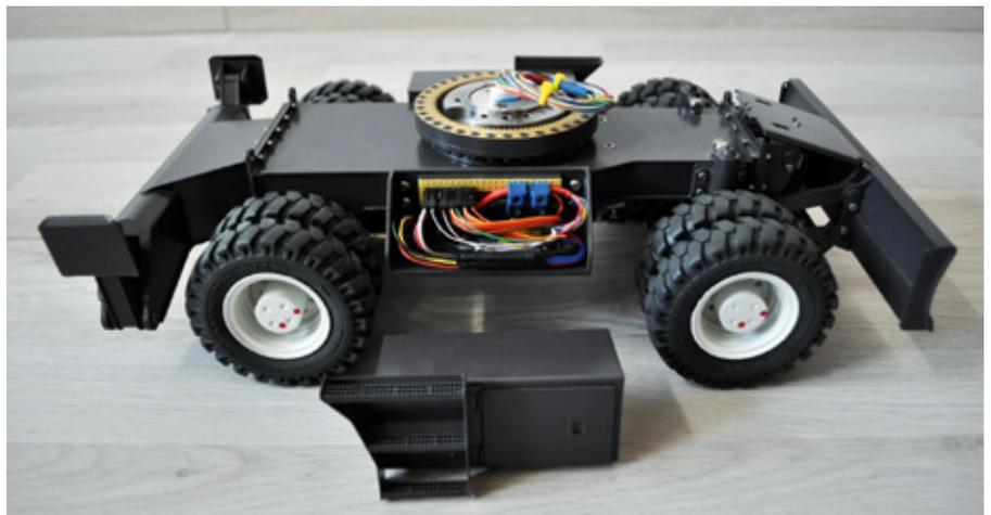
Der rechte Staukasten beherbergt die Verteilerplatte sowie den Fahrregler. Auch die beiden Drehdurchführungen für Elektronik und Hydraulik sind bereits angebracht
