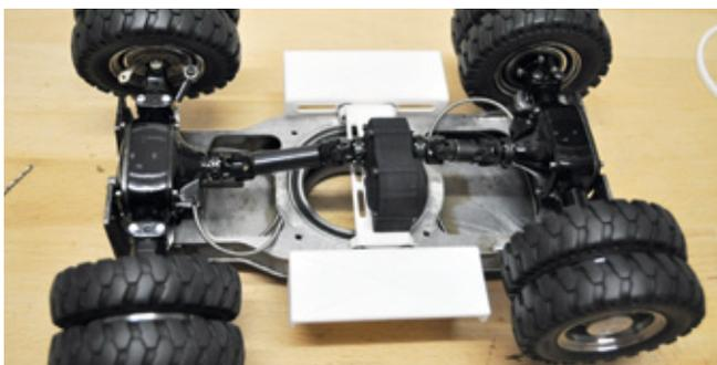
Der Antriebsstrang mit dem Verteilergetriebe ist eingesetzt
