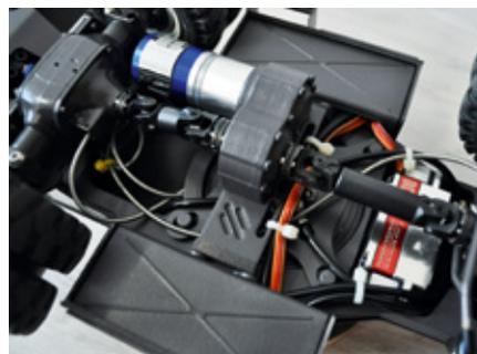
Das Getriebe wird von vier Schrauben gehalten und ist somit leicht abnehmbar
