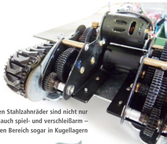
Die zwischen 5 und 6 mm breiten Stahlzahnräder sind nicht nur gut gefettet, sondern laufen auch spiel- und verschleißarm – im unteren Bereich sogar in Kugellagern
