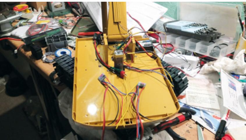
Im Hinterteil des Baggers treffen sich sämtliche Zuleitungen. Gut zu erkennen sind die Kettenlaufwerke. Sie sind auch komplett aus Metall hergestellt und sollten lange halten
