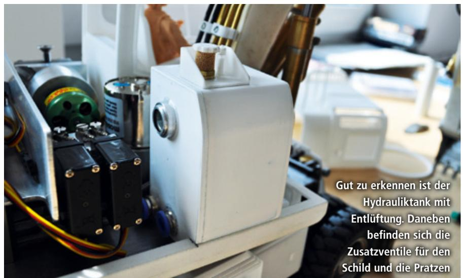
Gut zu erkennen ist der Hydrauliktank mit Entlüftung. Daneben befinden sich die Zusatzventile für den Schild und die Prätzen
