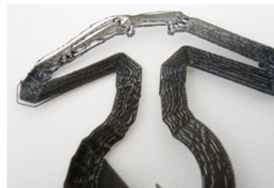
Hier kann man gut eine nicht korrekt ausgerichtete Druckplatte erkennen. Der gekräuselte Bereich lag nicht korrekt auf und erzeugte keinerlei Haftung
