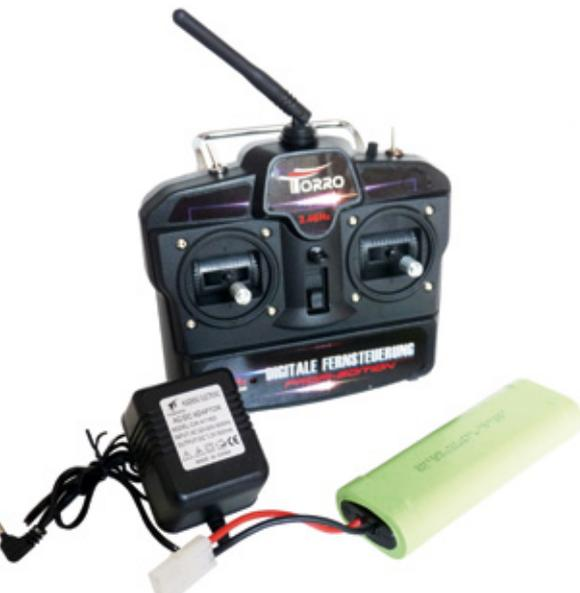
Neben dem stör-sicheren 2,4-Gigahertz-Sender liegt auch ein sechszelliger NiMH-SUB-C-Akkupack samt Steckerlader bei
