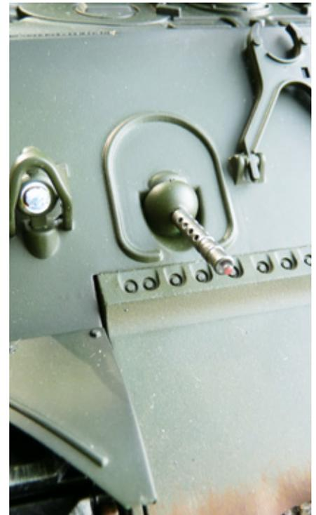
Der etwas herausstehende Fiberglasstab des 7,62-mm-Front-MGs vom Typ Browning M1919 flackert beim Betätigen des rechten Hebels oben auf der Fernsteuerung zusammen mit einem MG-Sound auf
