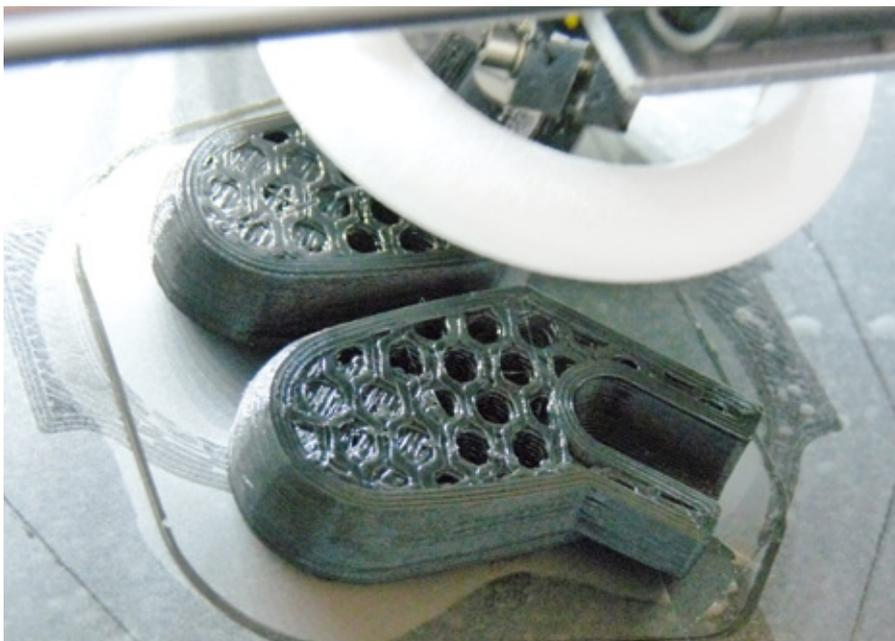
Je nach Einstellung werden die Bauteile innen mit einem auswählbarem Muster gefüllt
